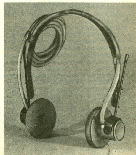
Рис. 1. Конструкция квазистереофонов: 1 — амбушюр, 2 — шайба (Д16-Т), 2 шт., 3 — основание левое (пенопласт, приклеить к детали 2), 4 — колпачок, 2 шт., 5 — оголовье, 6 — акустическая линия задержки, 7 — излучатель ТМ-2, 8 — основание правое (пенопласт, приклеить к детали 2), 9 — соединительный провод, 10 — звукоослабляющая пробка (поролон).
