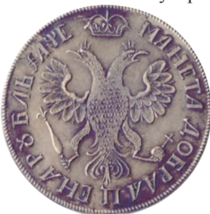
Рубль 1705 г. Cu-Zn. Серебрение. Штамповка.
