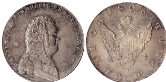
Рубль 1806 г. Cu-Zn. Серебрение. Штамповка.
