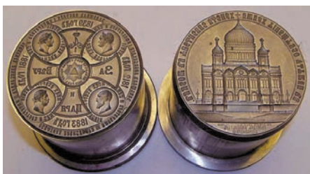
Штемпели, изготовленные на электрохимическом станке.
