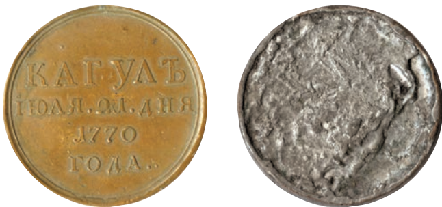
Гальванокopia одной стороны медали, залитая свинцом (до соединения с "крышкой" - гальванокopией другой стороны).
