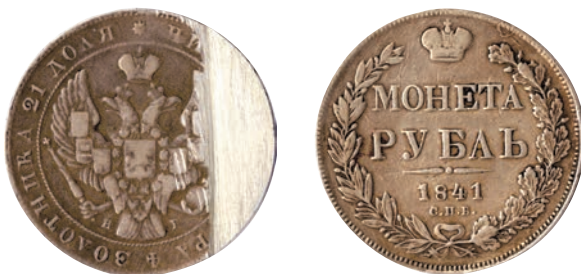
Рубль 1841 года с амальгированной поверхностью (часть металла удалена для целей экспертизы).
