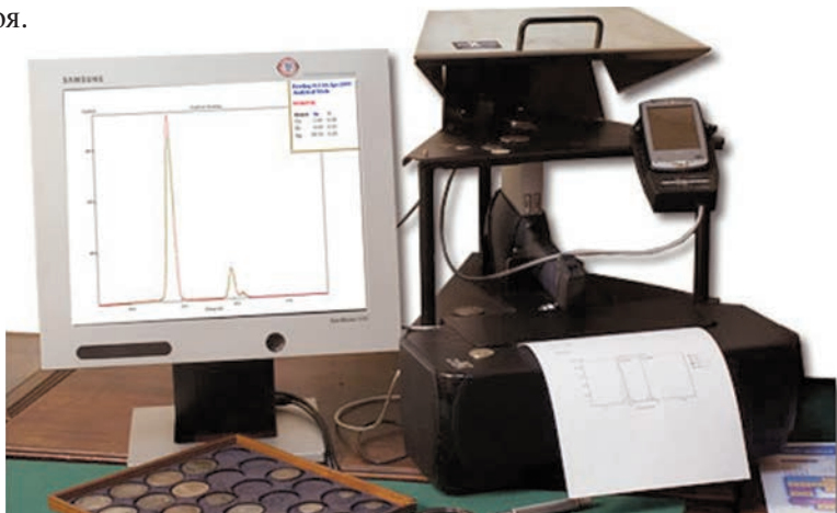
Установка для исследований состава сплава на базе рентгенофлуоресцентного спектрометра ALPHA SERIES™ Альфа-2000 с испытательным стендом ITS и компьютером с программным обеспечением для количественного анализа используемых в монетном деле металлов.
