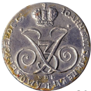
Рубль 1741 г. Sn-Sb-Cu. Хромирование.
