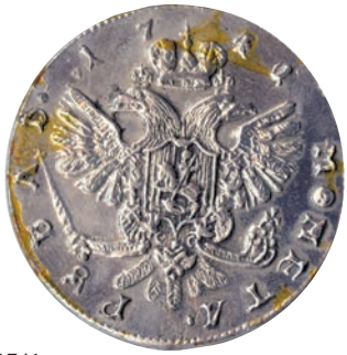
Рубль 1741 г. Sn-Sb-Cu. Хромирование.
