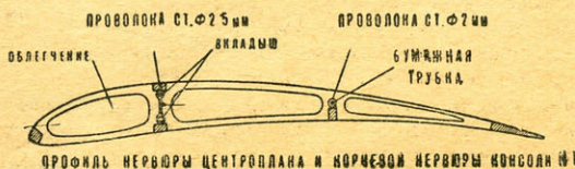
ПРОФИЛЬ НЕРВЮРЫ ЦЕНТРОПЛАНА И НОСОВОЙ НЕРВЮРЫ КОНСОЛИ № 1
