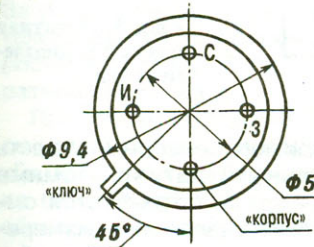
Рис. 2. Конструктивные особенности, долевка и габариты наиболее распространенных «полевиков», выпускаемых в корпусах (а — металлическом, б — пластмассовом):
