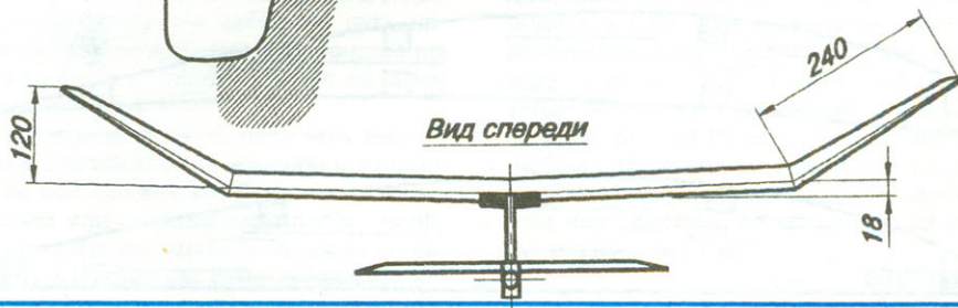
Основные геометрические параметры свободнолетающей таймерной авиамодели с двигателем внутреннего сгорания рабочим объемом 1,5 см 3 .
