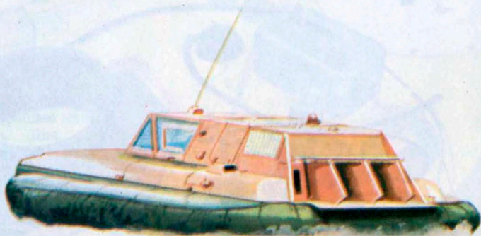
Полиция Нигерии использует СВП „Кроссбау” фирмы „Эйр Берингс”. Судно управляется с помощью реверсивного устройства в виде жалюзи, регулирующего истечение воздуха из кормовых каналов
