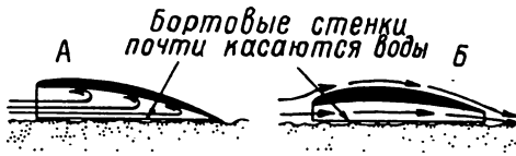
Крыло с опущенной задней кромкой (А) и туннельного типа (Б)
