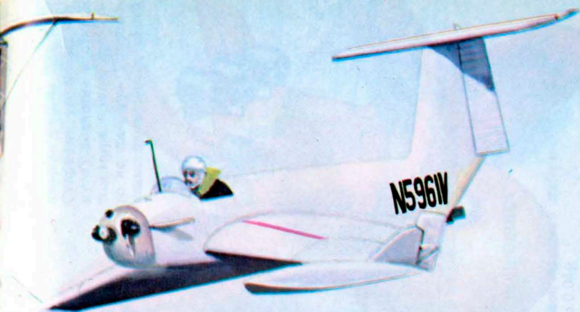
Экраноплан X-112 конструкции Липпиша, оснащенный двигателем „Рихтер” мощностью 25 л. с. (18 кВт)
