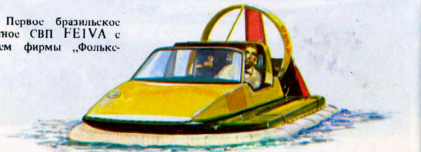
„Рейнджер 1” фирмы „Ховеркингз” — одноместное СВП, имеющее скорость 55 уз. Победитель конкурса на лучшее СВП Великобритании в 1973 г.
