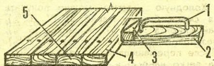
Рис. 7. Уплотнение настила: 1 — скоба, 2 — лага, 3 — клинья, 4 — поджимаемая доска, 5 — прибитая доска.
