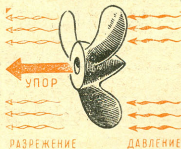
Рис. 2. Силы, действующие на лопастях работающего гребного винта.
