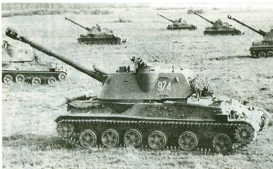
САУ 2С3 «Акация» на огневой позиции (башня развернута назад).
