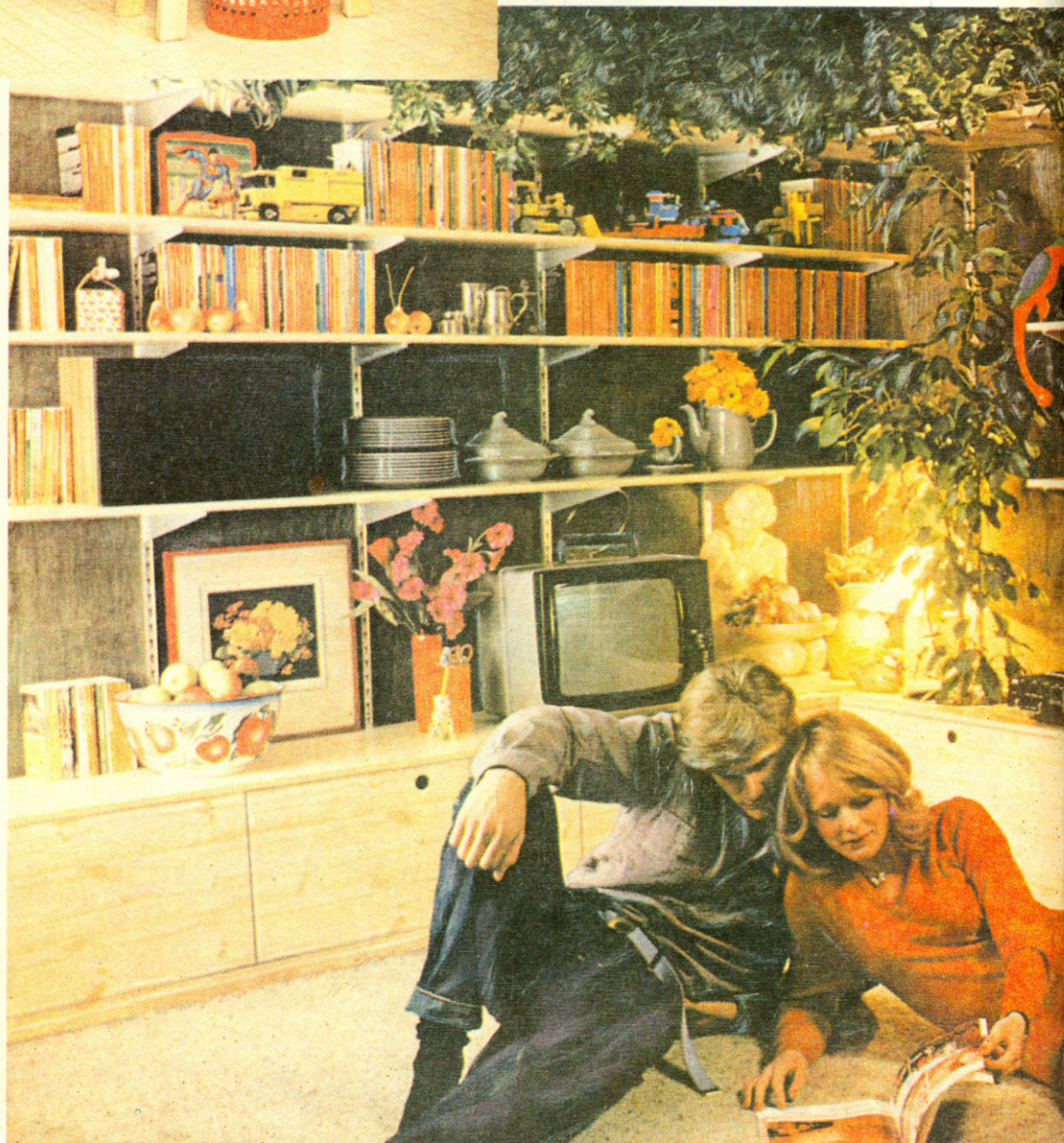
Вверху — вариант простейшего универсального стеллажа. Его стойки и полки — из деревянных реек сечением 25 \times 50 мм, поперечины — из реек сечением 20 \times 40 мм. Соединение — винтами и гайками.
