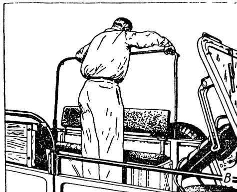
Фиг. 220. Укладка полога тента в кузове автомобиля ГАЗ-69.
