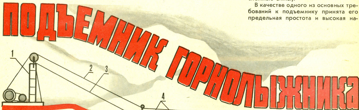
Схема горнолыжного подъемника МГП-300: 1 — приводная станция, 2 — холодная ветвь каната, 3 — рабочая ветвь каната, 4 — промежуточные опоры, 5 — бугель с фалом, 6 — нижняя опора.
