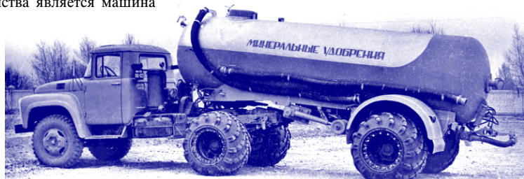
Машина для транспортировки и перегрузки пылевидных удобрений и известки АРУП-8 Машина для транспортировки и перегрузки пылевидных удобрений и известки МТП-10
