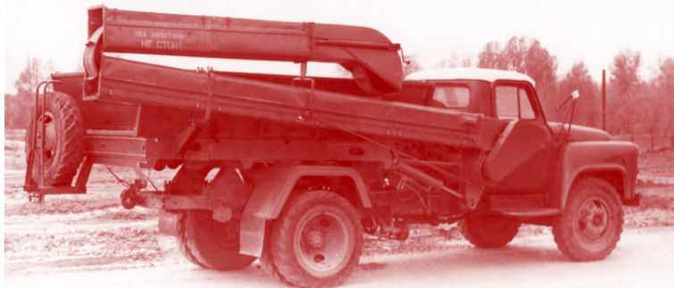
Загрузчик самолетов и вертолетов универсальный ЗСВУ-3 в транспортном положении
