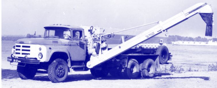
Загрузчик сеялок ЗСА-7 в рабочем положении
