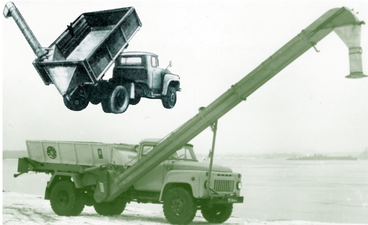
Загрузчик самолетов и вертолетов универсальный ЗСВУ-3 в рабочем положении
