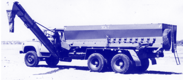
Загрузчик сеялок ЗСА-7 в рабочем положении
