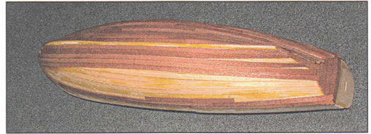
Обшивание корпуса рейками
