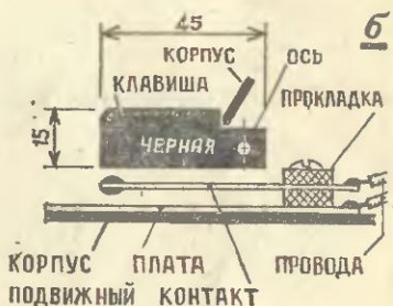
КОРПУС ПЛАТА ПРОВОДА ПОДВИЖНЫЙ КОНТАКТ
