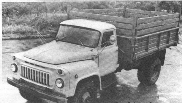
Фото 8. Автомобиль-самосвал ГАЗ-СА3-53Б с трёхсторонней разгрузкой кузова, надставными бортами и укороченной платформой. 1981
