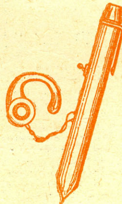
Рис. 1. Рефлексный приемник: его детали помещаются в футляре от авторучки.
