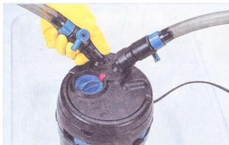
**1** Поверните краны на шлангах в положение «off» (выключено) и отсоедините резиновые шланги от корпуса фильтра. Поместите фильтр в пластиковый контейнер и слейте большую часть воды.
