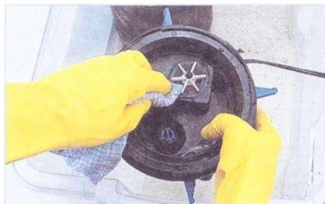
**2** Отсоедините мотор от корпуса фильтра, отжав замки и разделив его на две части. Снимите с мотора крышку и прочистите его тряпкой.
