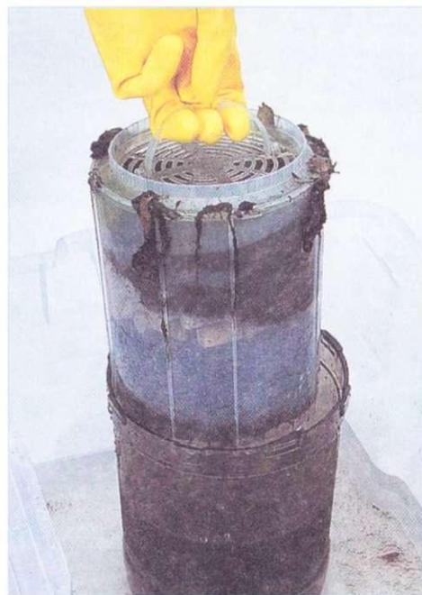
**3** Выньте кассету с наполнителями фильтра. (У этого фильтра одна кассета, но бывают фильтры с отдельными кассетами для каждого наполнителя.)
