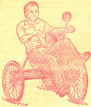
Рис. 12. Переднеприводный микровеломобиль с промежуточным валом (В. Ульяновский, Москва).
