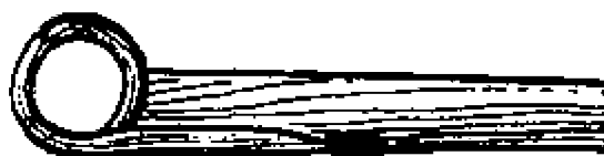
Рис. 21. Соединение деталей на косой срез
