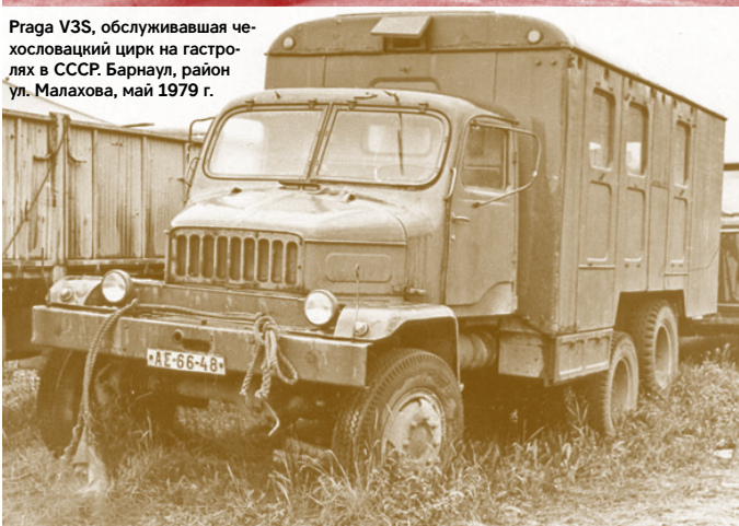
На этом кадре особенно выразительно видна необычайная полукапотная компоновка автомобиля. Барнаул, май 1979 г.
