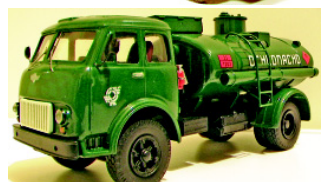
Цистерна АЦ-8 на шасси МАЗ-500А Разные годы выпуска и варианты выполнения
