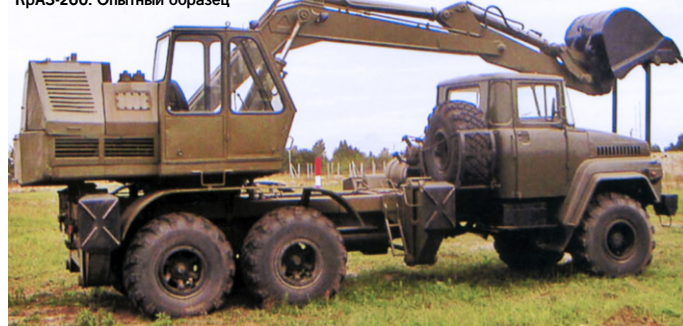
Седельный тягач КраЗ-260Д с активным полуприцепом КраЗ-9382
