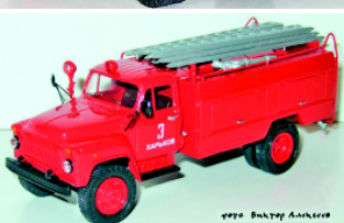
Цистерна АЦ-30(53)106Г на шасси ГАЗ-53 Разные годы выпуска и варианты выполнения
