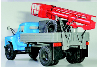
Электромонтажная вышка ТВГ-15 на шасси ГАЗ-53
