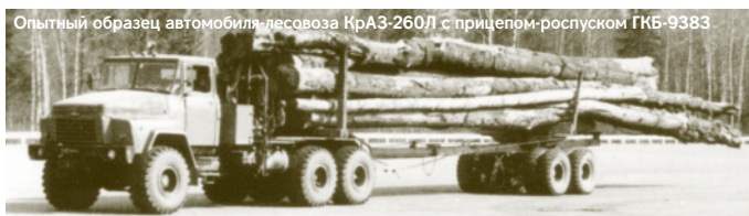
Опытный образец автомобиля-лесовоза КраЗ-260Л с прицепом-роспуском ГКБ-9383
