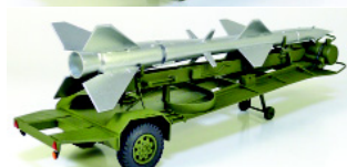
ЗИЛ-157КВ + ТЗМ ПР-11А комплекса С-75 Волхов с ракетой 13Д
