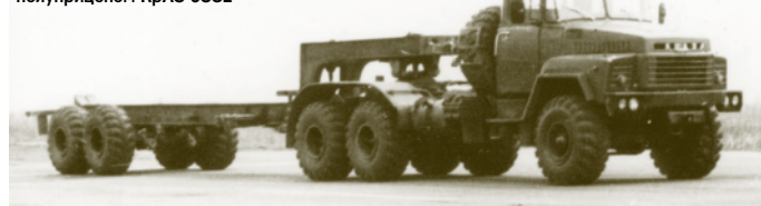
Седельный тягач КраЗ-260Д с активным полуприцепом КраЗ-9382
