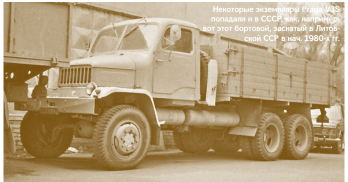
Об армейском предназначении машины говорили и люк в крыше, и зарешеченные фары, да и весь спартанский и функциональный внешний вид Чехословакия нач. 1960-х гг. Praga V3S
