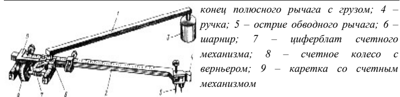
◀ Рис.2.10. Полярный планиметр: 1 - полюсный рычаг; 2 - обводной рычаг; 3 -
