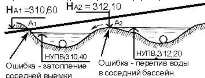
▲ Рис.П.11.4. Ошибки при размещении ИССО, вызванные несоблюдением пятого гидравлического условия; рис. из /18/ (изменен)
