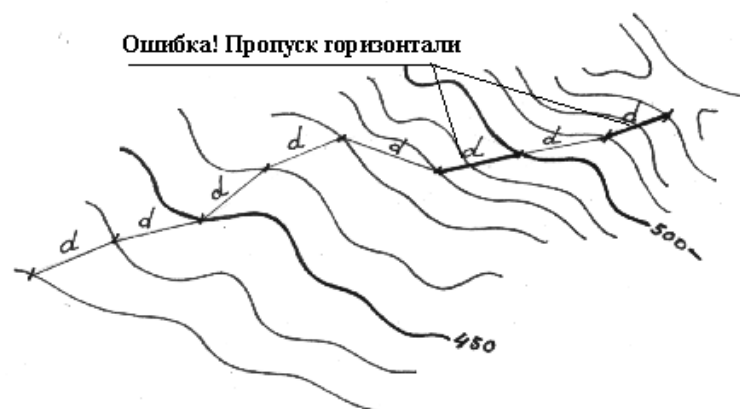
Рис. 1.28. Ошибочная укладка циркульного хода
