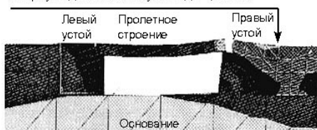
Рис.П.13.24. Фрагмент результирующих перемещений при расчетной схеме ПП-8: опускание правого угла фундамента правого устоя на 0,08 м; рис. из /54/
