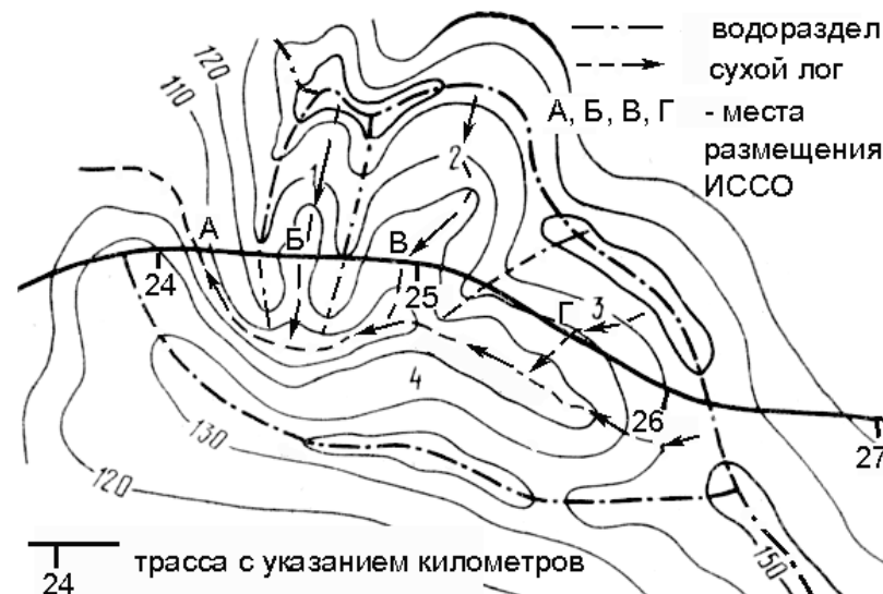
▲Рис.П.1.16. Сложный бассейн, состоящий из бассейнов 1 - 4, расположенных с противоположных сторон трассы: 1, 2, 3 - бассейны, расположенные с левой стороны трассы (по ходу километров); 4 - бассейн, расположенный с правой стороны от трассы; рис. из /7/
