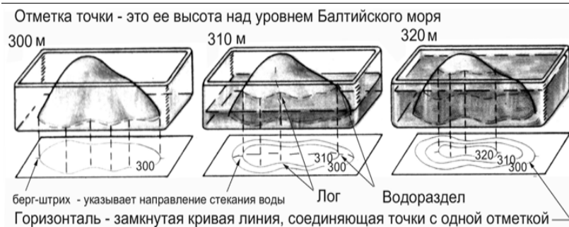
▲Рис.П.1.14. Соответствие форм рельефа и рисунка горизонталей; рис. из /35/(дополнен)
