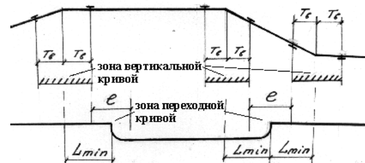
Рис. 1.26. Определение минимально допустимого расстояния L_{min} , м от точек перелома профиля до точек начала или конца круговой кривой
