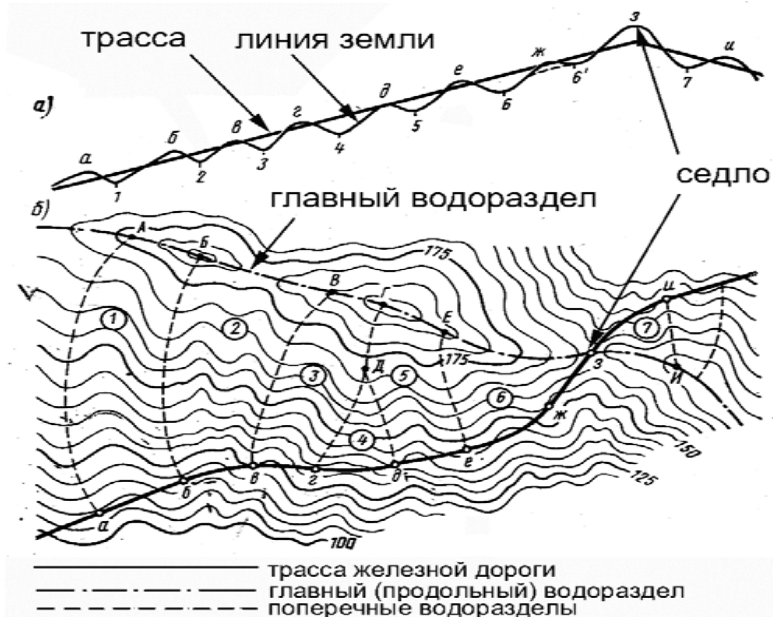
▲ Рис.2.2. Нахождение точек размещения водопропускных ИССО: а) - продольный профиль: 1 – 7 – точки размещения ИССО, а – и – водораздельные точки; б) - план в горизонталях: цифры в кружках – номера бассейнов, соответствующие точкам размещения ИССО; рис. из /15/
