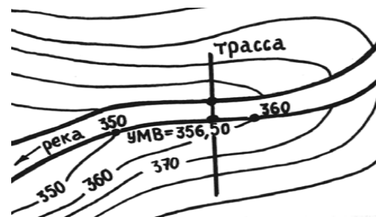
▲ Рис.2.2. Определение отметки уровня меженных вод путем интерполяции вдоль русла реки: УМВ = 356,50 м
