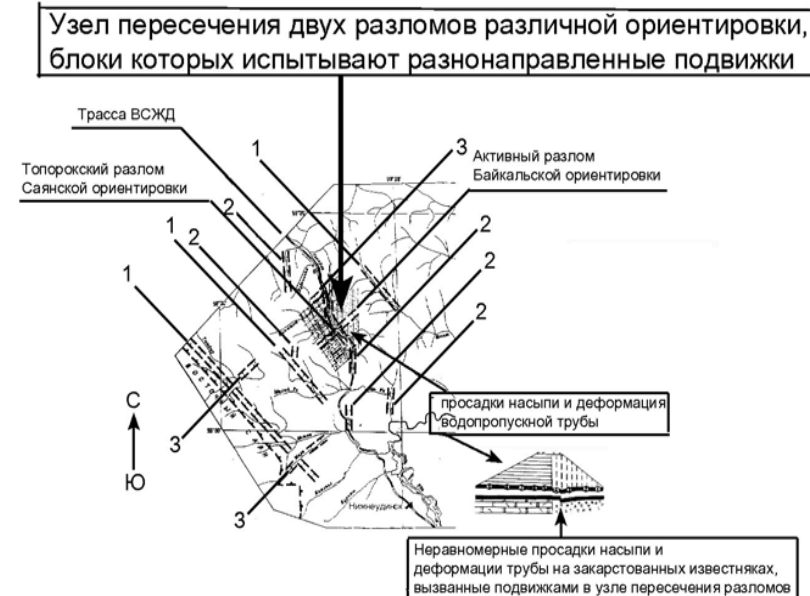
▲ Рис. П.13.30. Фрагмент карты районирования Транссибирской магистрали (Нижнеудинский участок): 1 – разломы саянской ориентировки; 2 – меридиональные разломы; 3 – разломы байкальской ориентировки; рис. из /54/
