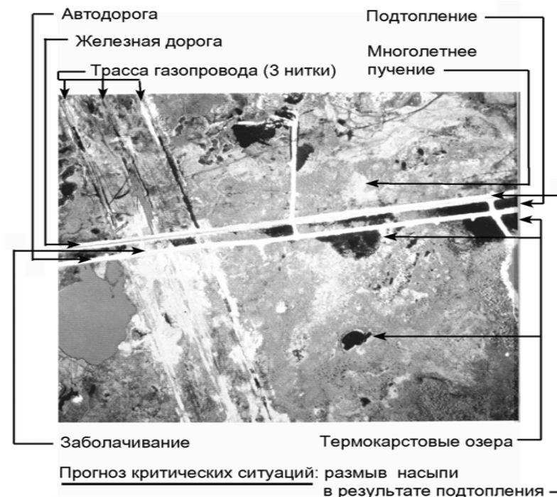
▲ Рис. П.13.15. Фрагмент синтезированного многозонального аэрофотоснимка района эксплуатации железной дороги Ягельная – Ямбург в районе пересечения с магистральным газопроводом; рис. из /9/
