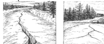
◀Рис.П.13.4. Речные наледи: а – глубокая трещина в речной наледи; б – деформация малого деревянного моста, построенного на водотоке с наледью; рис. из /20/
