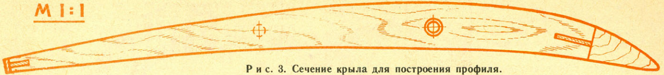
Рис. 3. Сечение крыла для построения профиля.
