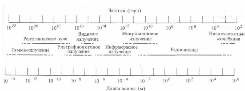
Рис. 4.8. Спектр электромагнитных волн Эти волны имеют сходные электромагнитные характеристики и представляют многие виды излучений. Все электромагнитные волны распространяются с одинаковой скоростью в вакууме, называемой скоростью света c ( c = 3 \cdot 10^8 м/с). Скорость, c = f\lambda , (4.6)
