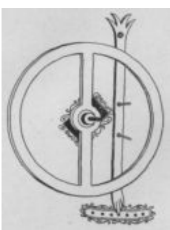
Рис. 118. Баланс, приводимый в действие растяжением и сжатием свиной щетины
