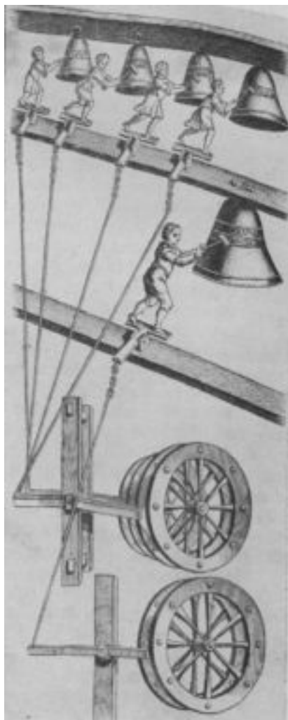
Рис. 108. Автомат для боя часов и четвертой часов из Льезжа
