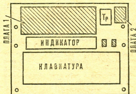
Рис. 5. Расположение основных узлов в корпусе микрокалькулятора.
