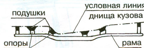
Типовой узел крепления кузова к раме Схема расположения узлов крепления кузова
