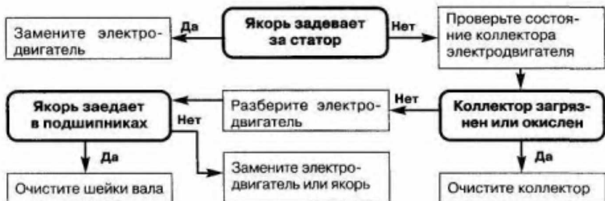
Рис. 6.18. Якорь электродвигателя вращается с низкой частотой
