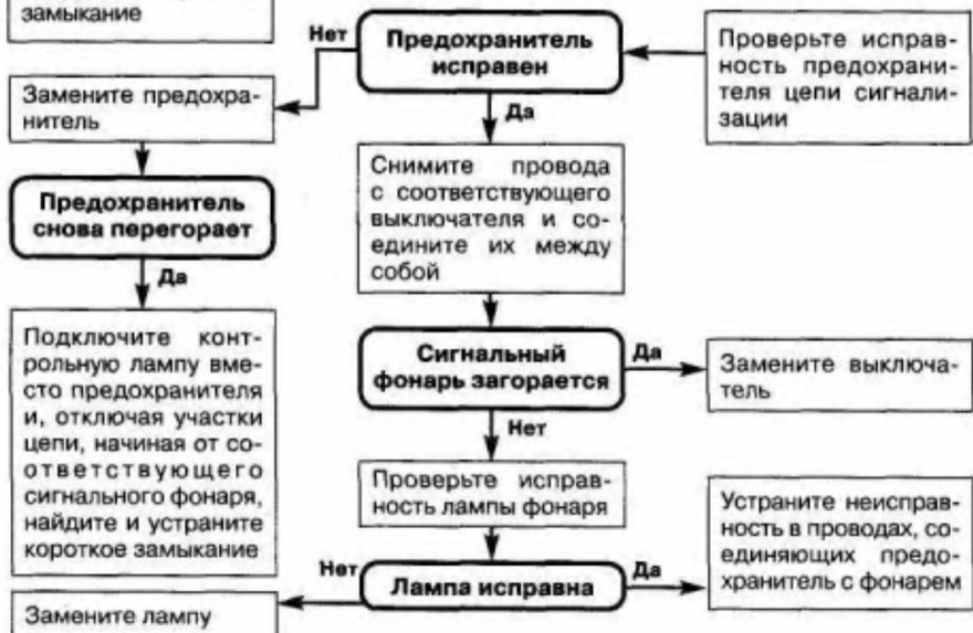
Рис. 4.28. Неисправны сигнализаторы заднего хода и торможения
