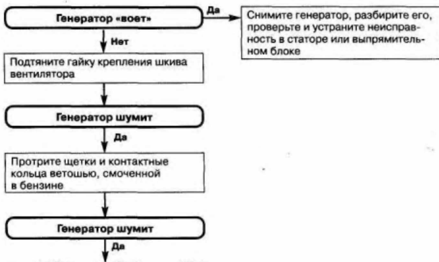
Рис. 2.14. Генератор издает сильный шум
