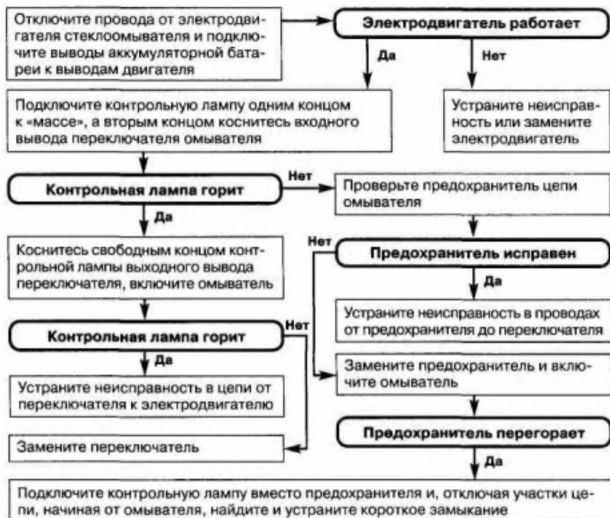
Рис.6.20. Не работает стеклоомыватель
