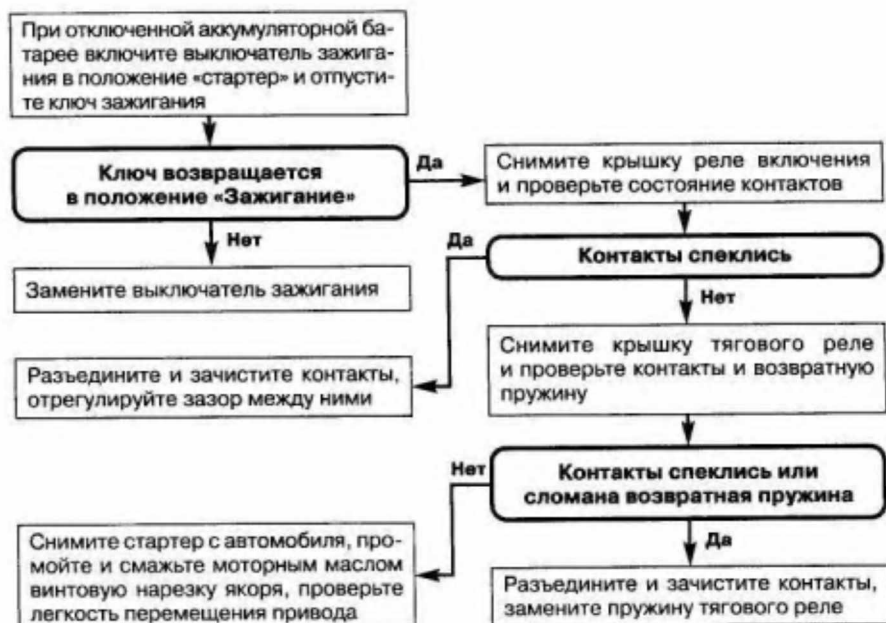
Рис. 1.11. Стартер не выключается после пуска двигателя
