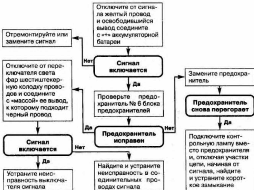
Рис. 6.15. Неисправен звуковой сигнал
