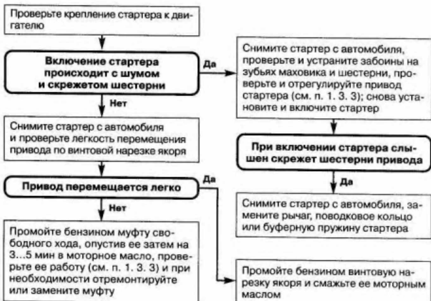
Рис. 1.10. Стартер включается, якорь его вращается, но маховик двигателя не вращается
