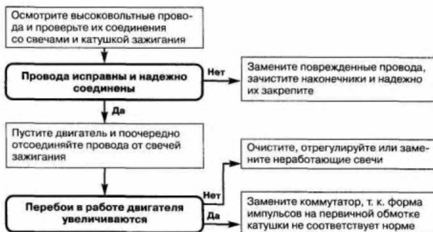
Рис. 3.13. Двигатель работает неустойчиво на всех режимах
