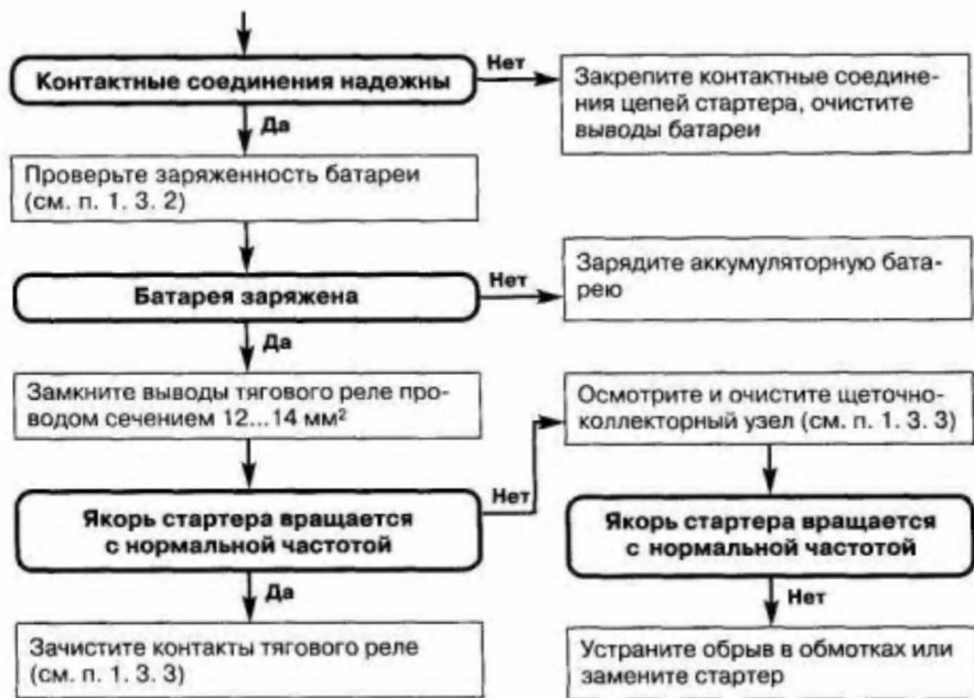
Рис. 1.9. Стартер включается, но его якорь не вращается
