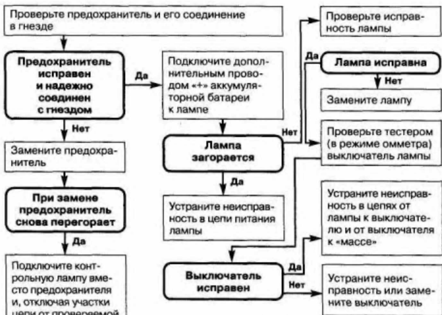
Рис. 4.27. Не работают приборы внутреннего освещения
