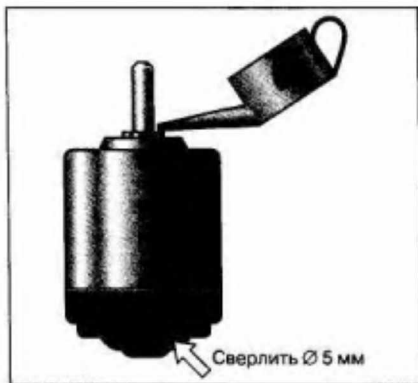
Рис. 6.27. Смазка подшипников электродвигателя отопителя
