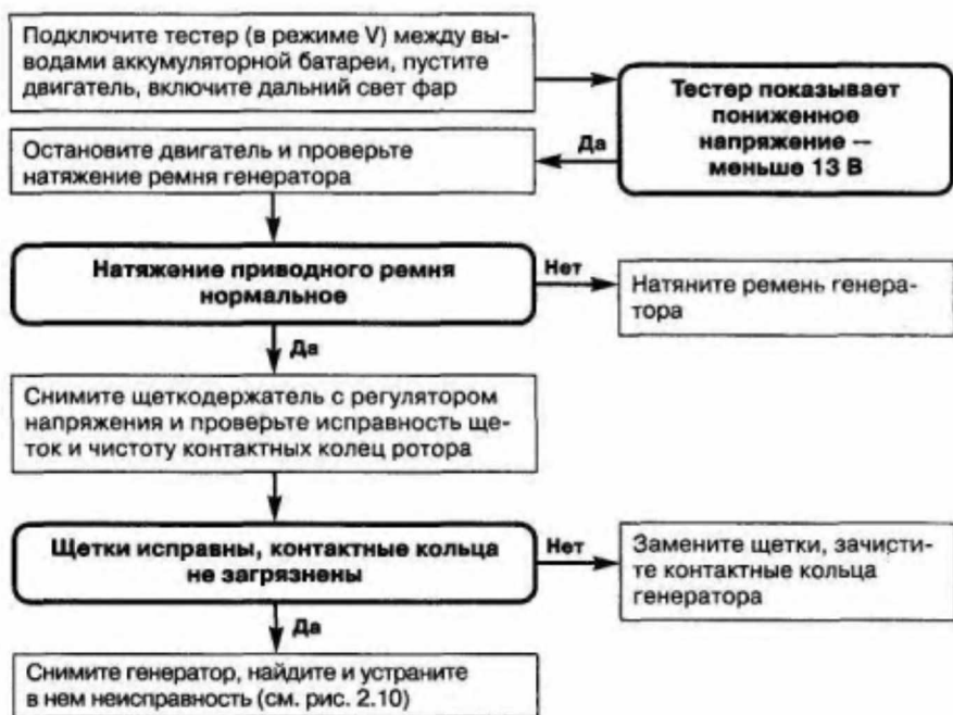
Рис. 2.9. Нет признаков заряда батареи — горит контрольная лампа разряда батареи при работающем двигателе
