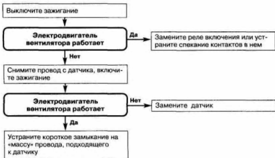
Рис. 6.25. Вентилятор системы охлаждения двигателя не выключается
