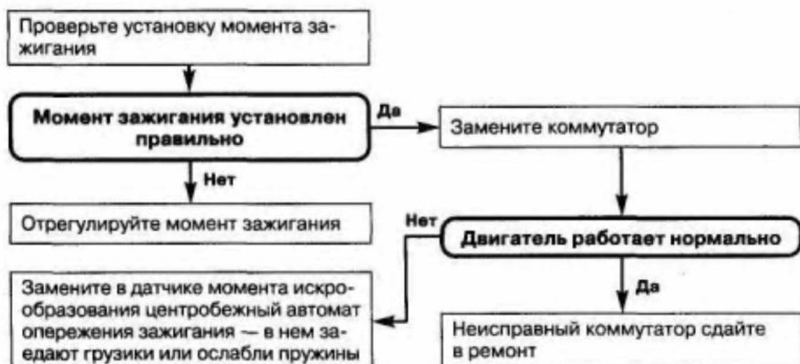
Рис. 3.14. Двигатель не развивает полной мощности и не обладает достаточной приемистостью
