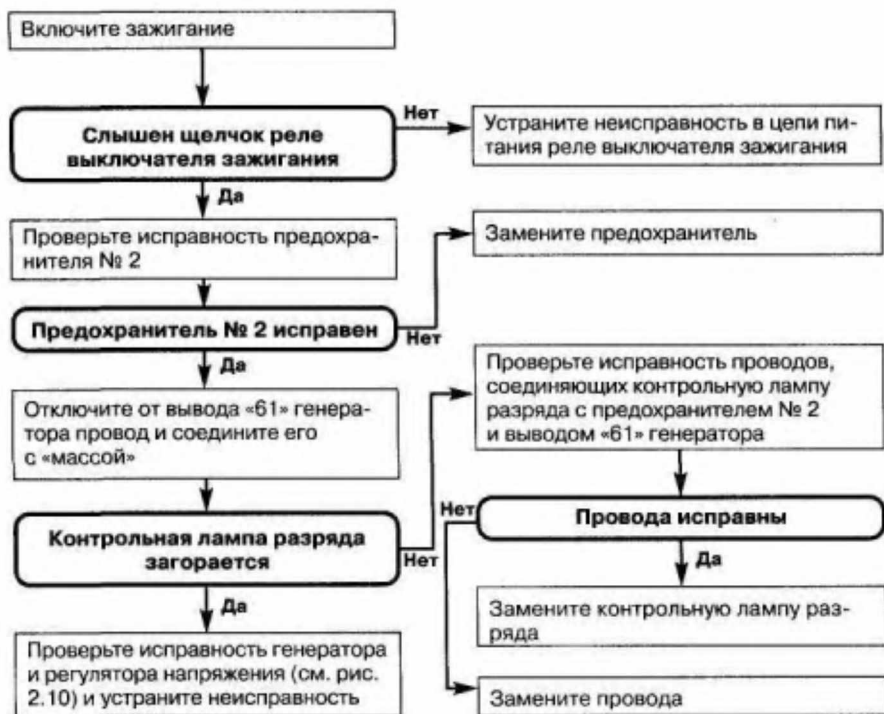
Рис. 2.13. Контрольная лампа разряда батареи не загорается при включении зажигания
