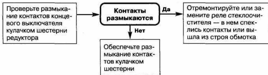
Рис. 6. 19. Двигатель стеклоочистителя не останавливается при работе в прерывистом режиме
