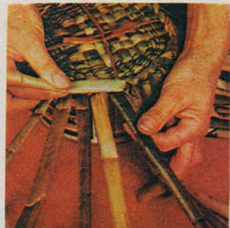
2. Выступающий бортик донышка делайте перед плетением стенки, загибая каждую стойку вокруг соседней.
