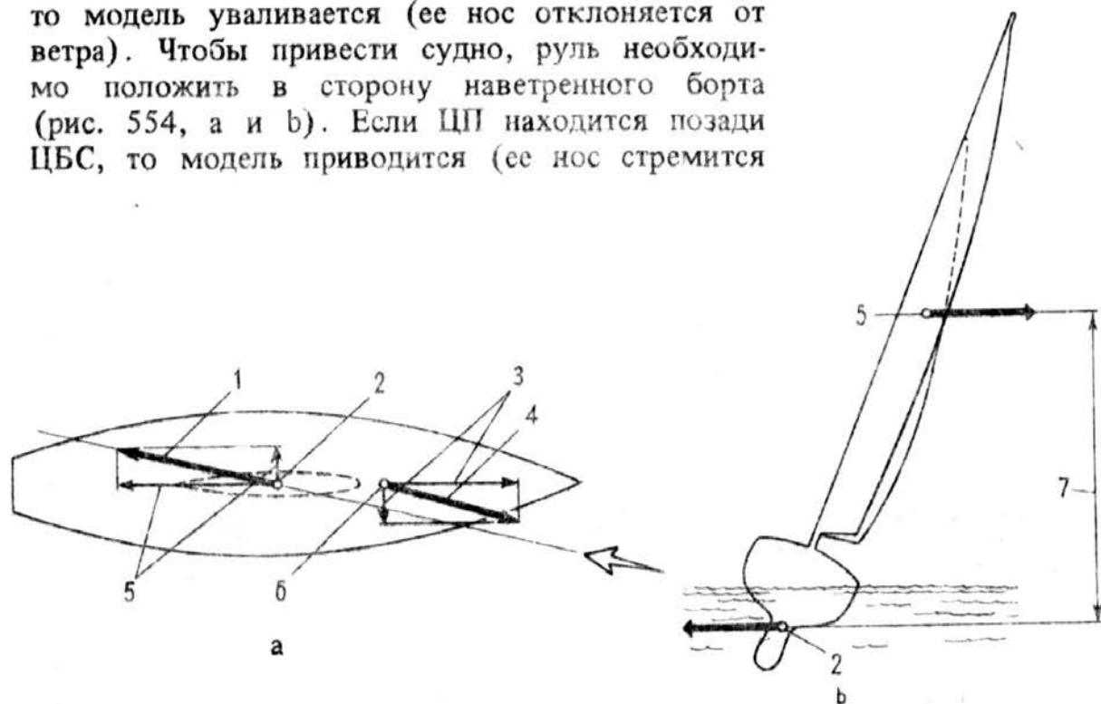
Рис. 553. Силы, вызывающие дрейф, противодействующие ему (а) и вызывающие крен (b).
