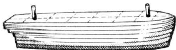
Рис. 177. Корпус трехпалубного судна, который до нижней палубы изготовлен из „цельных“ слоев.
