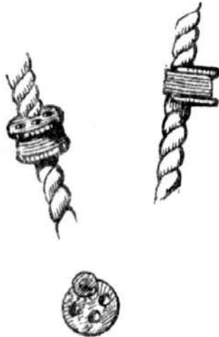
Рис. 339. Штаг-юферсы, или штаг-блоки, для обтягивания штагов: а – круглый; б – остропленный, железный; с – овальный.
