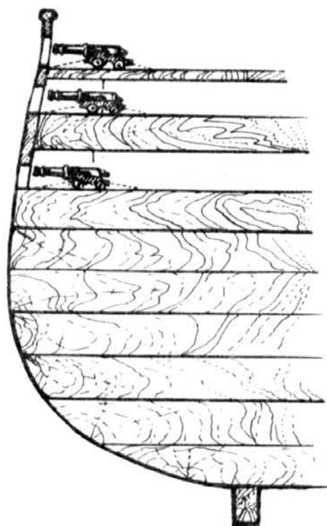
Рис. 181. Поперечное сечение готовой модели трехпалубного судна с фальшбортом.
