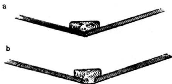
Рис. 201. Киль модели с плоскокилеватым корпусом.
