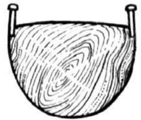
Рис. 165. Вырезы в корпусе для установки фальшборта.
