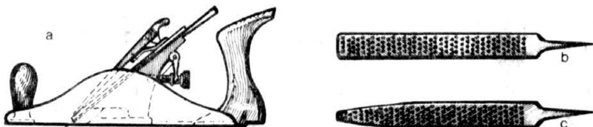
Рис. 157. Инструменты для строгания и окончательной отделки: а – металлический двойной рубанок; б – плоский четырехугольный рашпиль; с – плоский полукруглый рашпиль.
