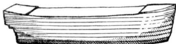
Рис. 178. Установка треугольных вставок для получения седловатости палубы.
