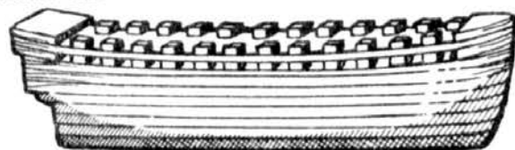
Рис. 180. Установка средней палубы и кубиков между пушечными портами.
