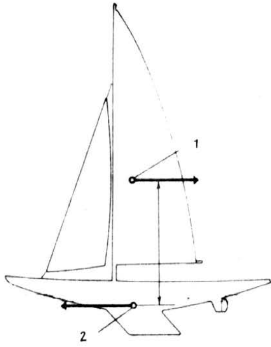
Рис. 557. Пара сил, вызывающих дифферент. 1 – ЦП; 2 – ЦБС.
