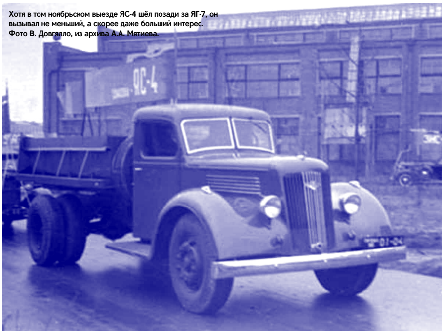
ЯС-4 имел укороченную раму, гидравлический подъёмник и цельнометаллический самосвальный кузов
