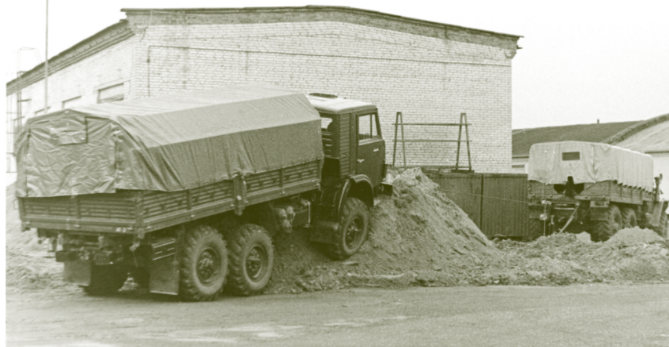
Фото 16. Два «одноклассника» — Урал-4320-01 (тягач КТ-ЛМ) и КамАЗ-4310 со спальным местом. Испытания эвакуационного тягача во дворе 38 опытного завода. г. Бронницы
