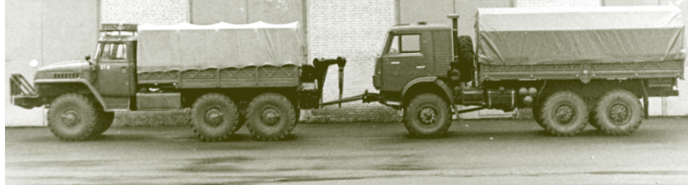
Фото 16. Два «одноклассника» — Урал-4320-01 (тягач КТ-ЛМ) и КамАЗ-4310 со спальным местом. Испытания эвакуационного тягача во дворе 38 опытного завода. г. Бронницы
