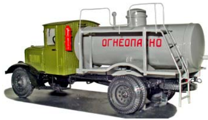
Цистерна для перевозки сжиженного газа на шасси ЯГ-6 (Волчанецкий)
