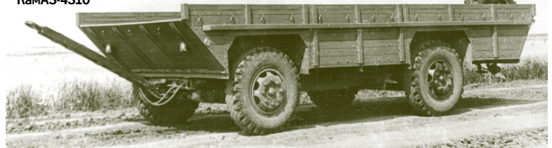
Фото 5. Низкорамный прицеп 2-ПН-4м модели СМЗ-810ПА для автомобиля КамАЗ-4310
