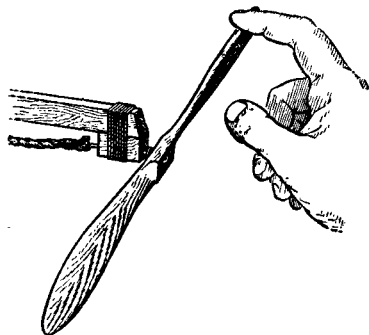
Рис. 149. Закручивание (заводка) резиномотора
