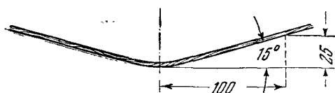
Рис. 92. Форма выгиба кромок крыла
