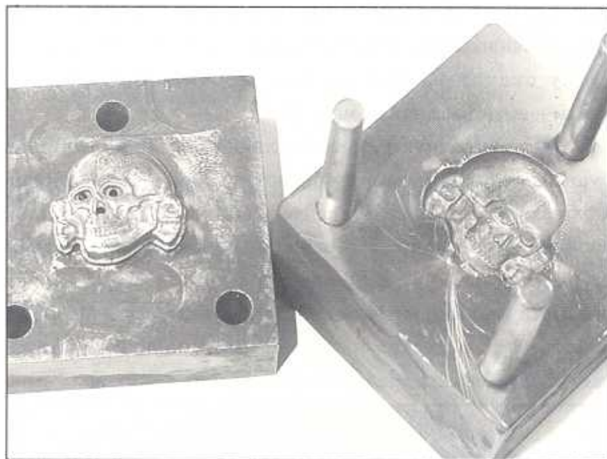
Штамп в сборе для изготовления эмблем-черепов SS для одной из киностудий. Здесь процесс штамповки и вырубки изделия - одна операция.
