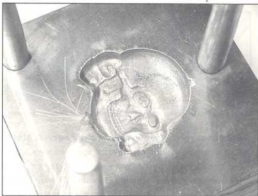
Матрица штампа с направляющими для пуансона.
