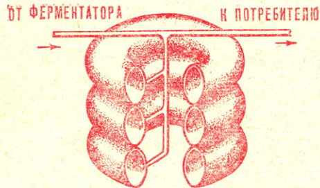
Рис. 2. Разбухающий резервуар из тракторных камер.
