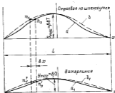
Рис. 10.12. Перестроение теоретического чертежа проекта ( \delta, k_p ) из чертежа прототипа ( \delta_1, k_{p1} ).
