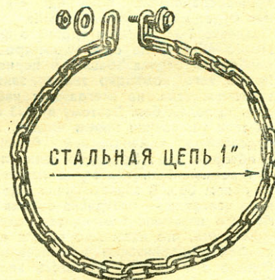
Рис. 6. Цепной браслет (звенья 25 \times 12 мм из проволоки \varnothing 6 мм).
