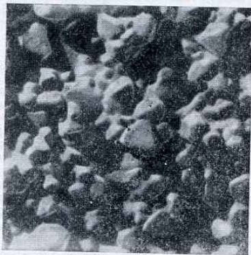
Фото 2. Электронная микрофотография слепка рельефа поверхности обычного светочувствительного фотографического слоя, не имеющего защитного покрытия
