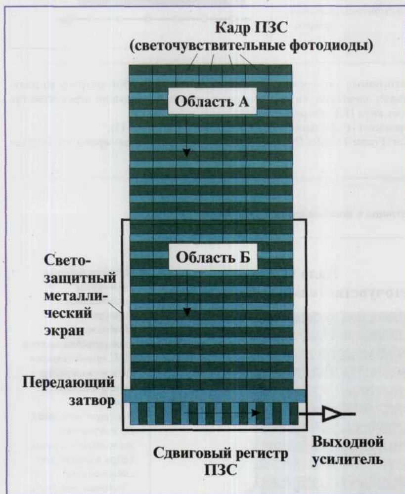
Рис. 16 Схема работы ПЗС-матрицы с кадровым переносом
