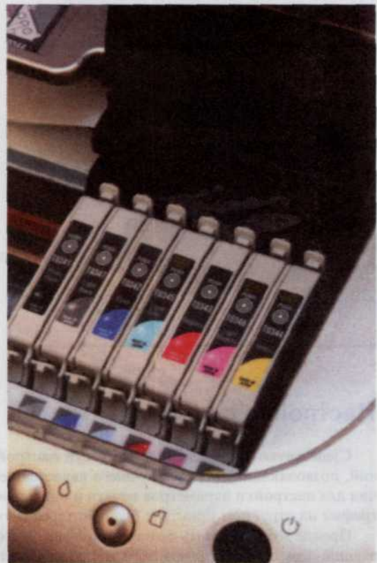
Рис. 317 Принтеры Epson с отдельными резервуарами для каждого красителя.
