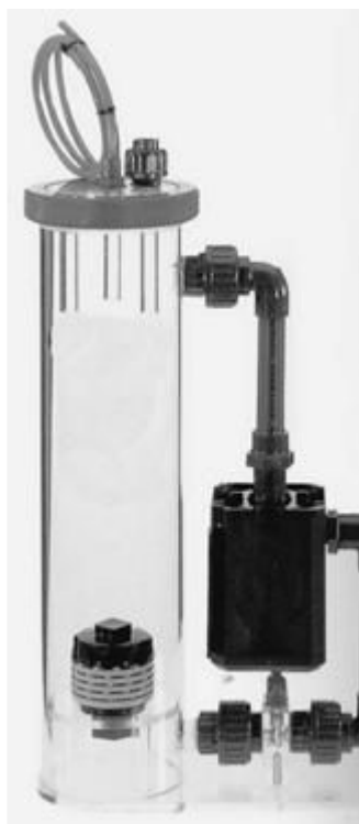
Колонка денитрификатора. Питательный раствор для фауны денитрификатора подается сверху дозирующим насосом. Циркуляция воды в контуре денитрификации осуществляется насосом, расположенным справа
