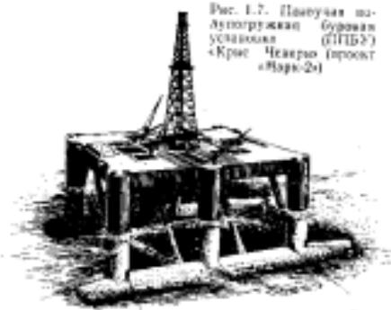
имеются ряд установок, у которых надводную часть можно звать «верхним корпусом» (см. рис. 1.7), так как он не только архитектурно составляет единое целое, но и участвует в обесцеменении общей прочности сооружения. Общая прочность установок, имеющих верхний корпус с надстройками, обеспечивается системой палубных балок, опирающихся на верхнюю часть колонн в раскосах. Эти балки служат также опорой для верхнего корпуса.
