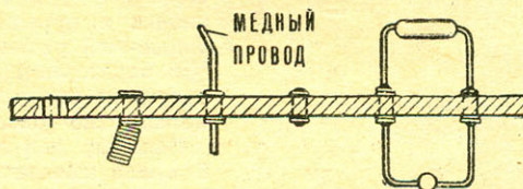
Рис. 2. Последовательность установки спирали и готовый монтаж.
