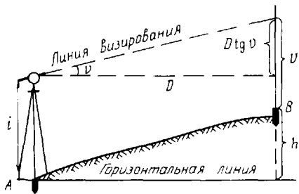
Рис. 93. Принцип тригонометрического нивелирования
