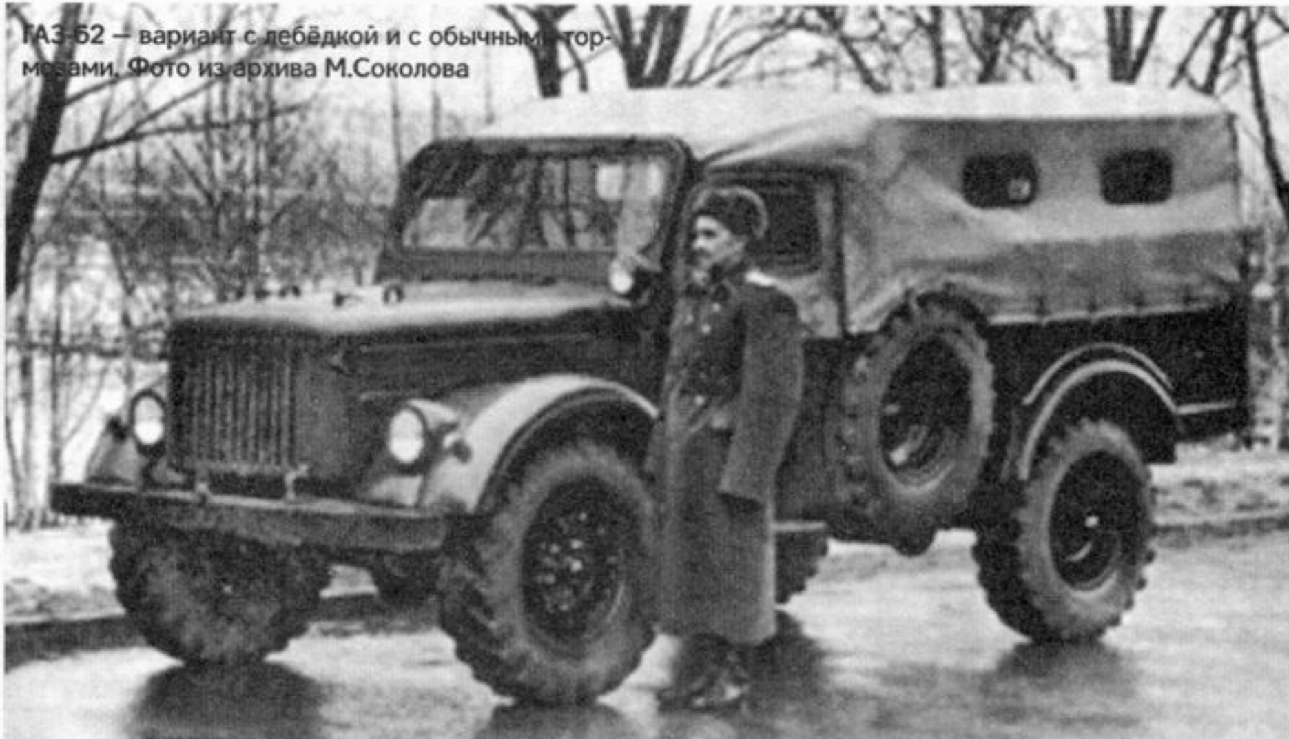
ГАЗ-62 — вариант с лебёдкой и с обычными тормозами. Рис. Захаров
