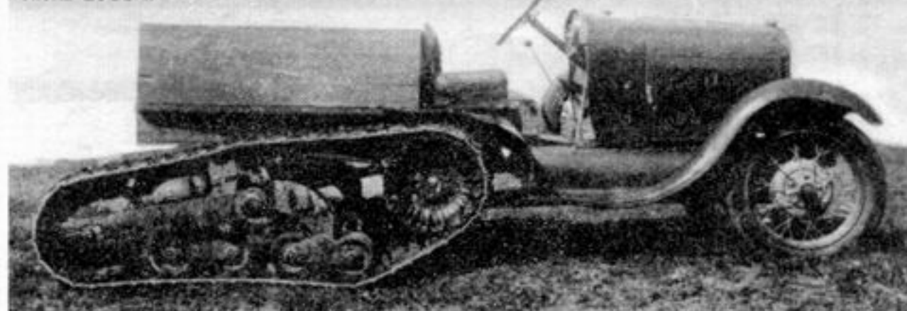
Полугусеничный автомобиль НАТИ-5, а точнее — открытый пикап с гусеничным движителем «Кегресс» на шасси Ford A образца 1927 г. Полигон УММ РККА, июль 1933 г.
