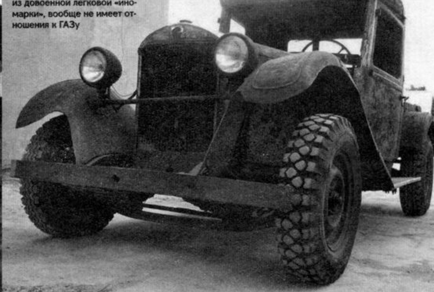
Уже изрядно переделанный ГАЗ-4 (на «волговском ходу», с грузовой платформой от ГАЗ-М415 и самодельными задними крыльями) можно было встретить в 1985 г. и в Челябинске.
