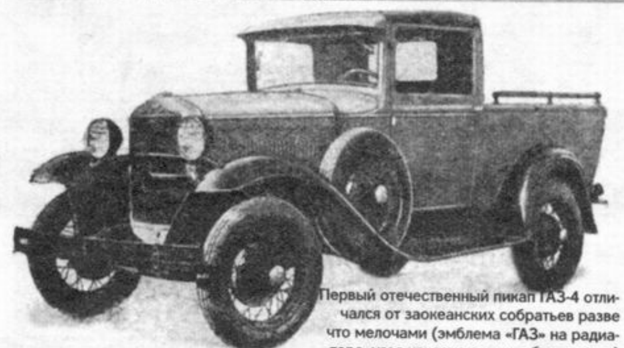
ГАЗ-4 на территории завода. Вид слева. Хорошо видно изменённое левое переднее крыло с «карманом» и запасное колесо над ним.
