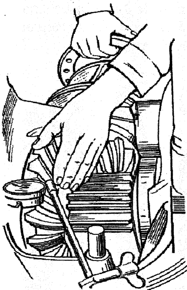
Рис. 37. Проверка бокового зазора в зацеплении конических шестерен
