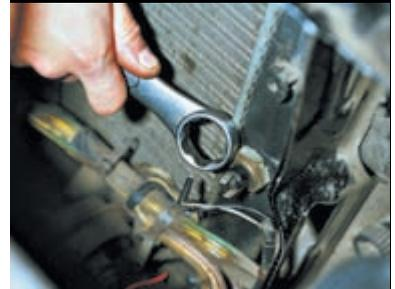
Ключом «на 30» отворачиваем датчик.
