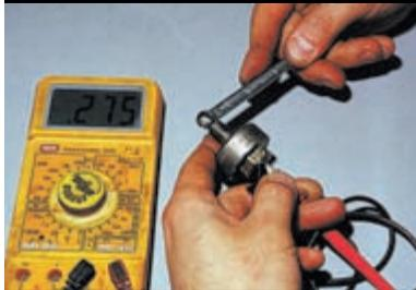
Слегка постукивая стержнем из мягкого металла по резьбовой части датчика, измеряем импульс напряжения.
