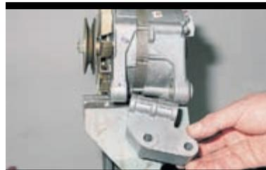
Разъединяем генератор и кронштейн.
