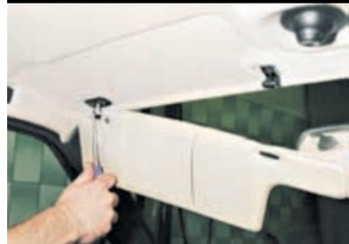
Крестообразной отверткой отворачиваем два самореза крепления петли.
