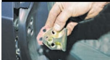
Отворачиваем еще два винта и снимаем фиксатор.
