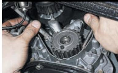
Поддеваем двумя отвертками зубчатый шкив коленчатого вала...
