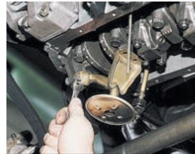
Ключом «на 10» отворачиваем еще один болт крепления к корпусу масляного насоса.
