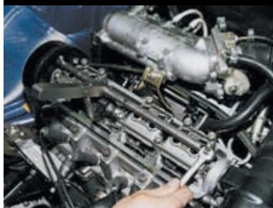
Если зазор отличается от нормы, то на шпильки корпусов подшипников распределительного вала устанавливаем приспособление для регулировки клапанов.
