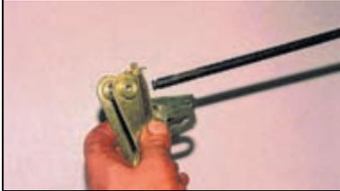
...и разъединяем рычаги привода регулятора давления.
