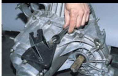
Ключом «на 17» отворачиваем болт крепления кронштейна подвески силового агрегата.
