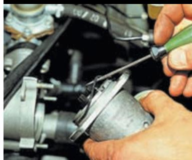
Датчик-распределитель уплотняется резиновым кольцом, которое снимаем, поддевая отверткой.
