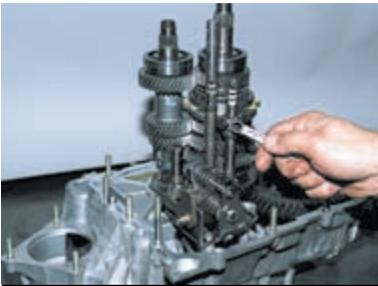
Накидным ключом «на 10» отворачиваем болт крепления вилки включения III-IV передач к штоку.
