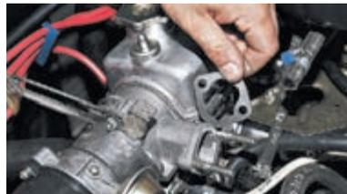
Снимаем еще одну уплотнительную прокладку.
