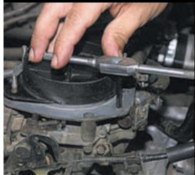
...метчиком М6 нарезаем резьбу в отверстии.
