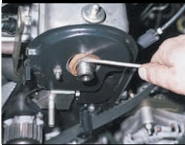
Поддеваем отверткой сальник и извлекаем его.
