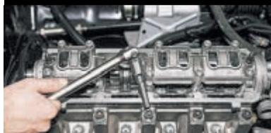
Шестигранником «на 10» отворачиваем десять винтов крепления головки блока.
