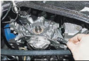
Головкой «на 10» отворачиваем шесть болтов крепления масляного насоса к блоку цилиндров.
