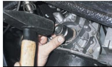
Смазываем рабочую кромку нового сальника моторным маслом и запрессовываем его головкой или отрезком трубы подходящего диаметра.
