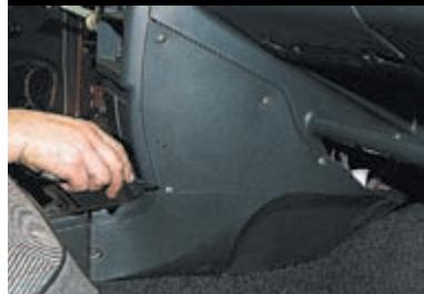
Также крестообразной отверткой отворачиваем пять саморезов крепления правого экрана центральной консоли...
