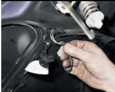
Отсоединяем разъем электропроводки подкапотной лампы. Привяжите к разъему шнур. Вытянув проводку, отвяжите шнур от разъема, оставив его в усилителе капота. Это позволит при монтаже капота легко вернуть проводку на место.
