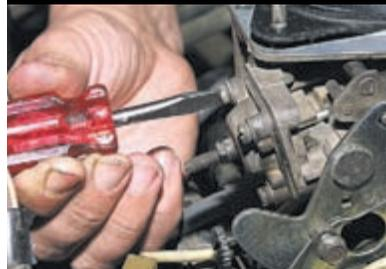
Отверткой отворачиваем четыре винта крепления крышки диафрагмы.
