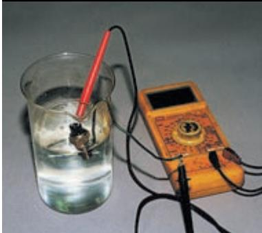
Измеряем сопротивление датчика при разных температурах.
