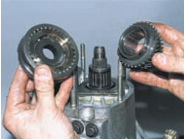
Снимаем скользящую муфту синхронизатора со ступицы.
