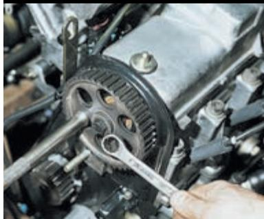
Ключом «на 17» отворачиваем болт зубчатого шкива распределительного вала. Чтобы вал не поворачивался, пропускаем через отверстие в шкиве головку
