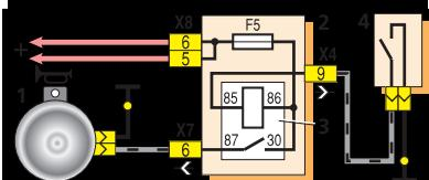
Схема включения звукового сигнала: 1 – звуковой сигнал; 2 – монтажный блок; 3 – реле включения звукового сигнала; 4 – выключатель рулевого сигнала
