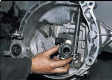
...и снимаем муфту выключения сцепления.
