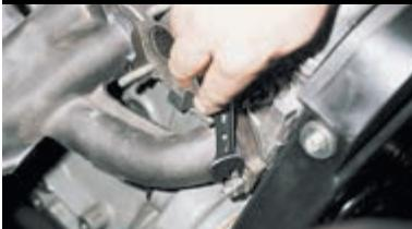
Отвернув две гайки бокового крепления,
