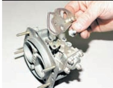
...и снимаем рычаг.
