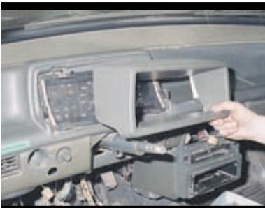
Снимаем козырек комбинации приборов (рулевое колесо и подрулевые переключатели для наглядности сняты).
