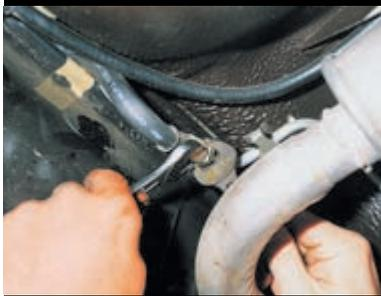
Двумя ключами «на 17» отворачиваем штуцер сливного трубопровода (возле дополнительного глушителя).
