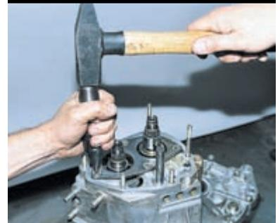
Ударной крестообразной отверткой отворачиваем четыре винта крепления упорной пластины.
