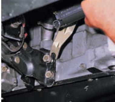
Ослабив левый верхний болт крепления кронштейна передней опоры силового агрегата, выводим из-под болта кронштейн модуля зажигания...
