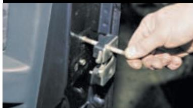
Вывернув нижний винт крепления, снимаем наружный замок. При этом шпилька не дает упасть внутреннему замку.
