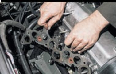
Разъем коллекторов и головки блока уплотнен двумя прокладками.
