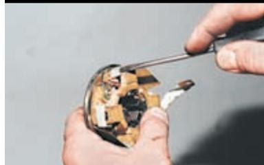
Поддеваем отверткой пластиковую скобу...
