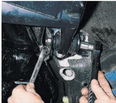
Головкой и ключом «на 19» отворачиваем болт крепления балки к кронштейну...
