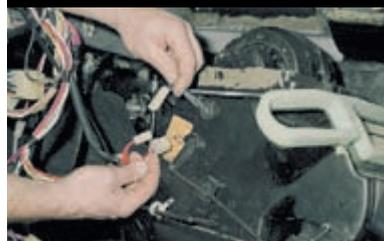
Отсоединив разъемы от резистора и провода электродвигателя вентилятора,
