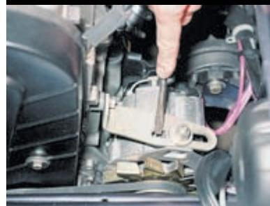
...или воздействуя отверткой как рычагом, в прорези натяжной планки (этим способом удобно сдвигать генератор и для ослабления натяжения ремня).
