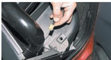
Отсоединяем колодку проводов от выключателя плафона освещения вещевого ящика (выключатель скрыт воздуховодом системы вентиляции и отопления).
