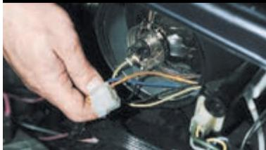
Снимаем разъем с лампы.
