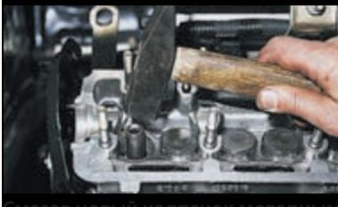
Смазав новый колпачок моторным маслом, напрессовываем его оправкой на направляющую втулку.
