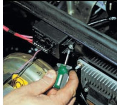
Крестообразной отверткой отворачиваем два самореза крепления блока.
