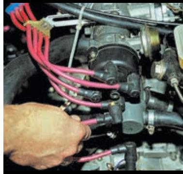
Снимаем центральную проводку из крышки.
