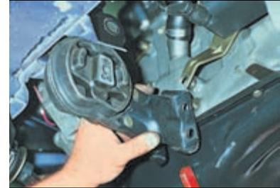
Выводим опору из проушины кузова.
