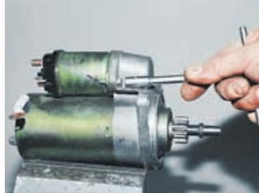
Головкой «на 8» отворачиваем два болта крепления тягового реле...
