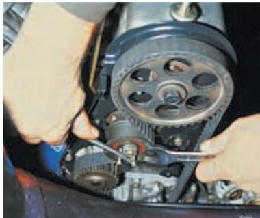
...вставив отвертку между двумя винтами или стержнями диаметром 4 мм, установленными в отверстие натяжного ролика, поворачиваем ролик против часовой стрелки, натягивая ремень.
