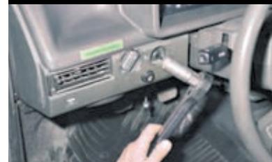
Высокой головкой «на 21» отворачиваем гайку крепления выключателя...
