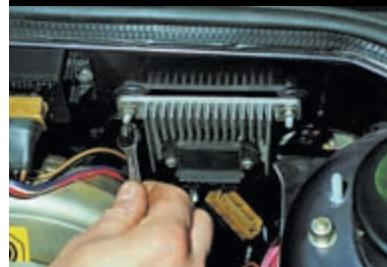
Ключом «на 8» отворачиваем две гайки, под одной из которых расположена клемма «массового» провода жгута.
