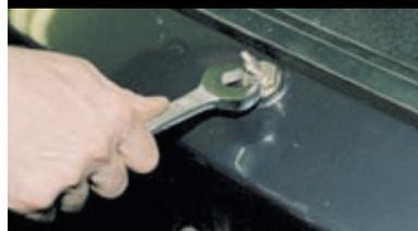
...и ключом «на 21» отворачиваем гайку.
