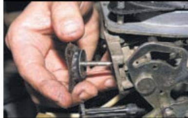
Вынимаем диафрагму со штоком. Для этого поворачиваем диафрагму, чтобы загнутый конец штока вышел из зацепления со штифтом рычага воздушной заслонки.
