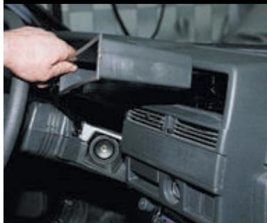
Вынимаем ящик из гнезда радиоприемника (если в автомобиле установлен радиоприемник, его необходимо снять).
