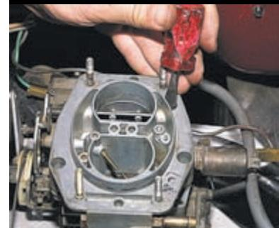
Отверткой отворачиваем пять винтов крепления крышки карбюратора.
