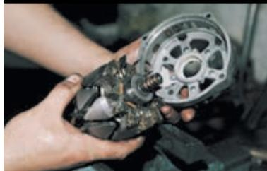
...выбиваем ротор с подшипником из задней крышки.
