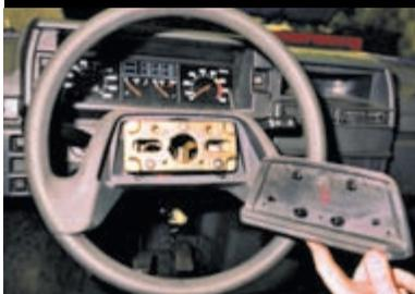
...и снимаем крышку.
