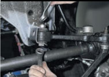
Двумя ключами «на 19» отворачиваем болт крепления рычага к кузову.
