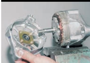
Снимаем переднюю крышку.
