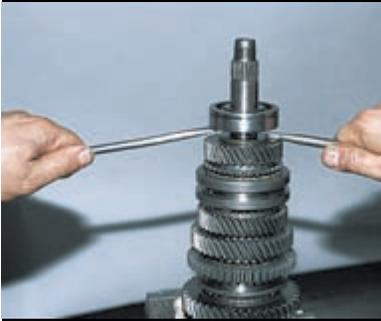
Поддев двумя мощными отвертками задний подшипник, спрессовываем его.
