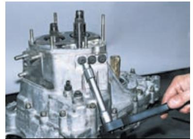
Головкой «на 13» отворачиваем три пробки фиксаторов штоков переключения передач.
