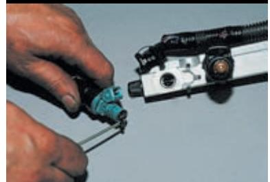
Поддев отверткой с тонким лезвием, снимаем уплотнительные кольца...
