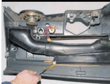
...два самореза переднего крепления воздуховода обогрева ветрового стекла...
