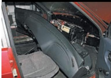
...и снимаем панель приборов вместе с поперечинами.
