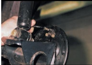
Выводим трубку из отверстия колесного цилиндра.
