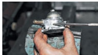
На верхней части корпуса насоса нанесена стрелка, указывающая направление потока топлива.
