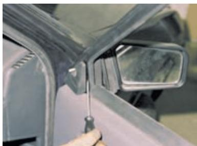
Поддеваем отверткой внутреннюю облицовку зеркала.
