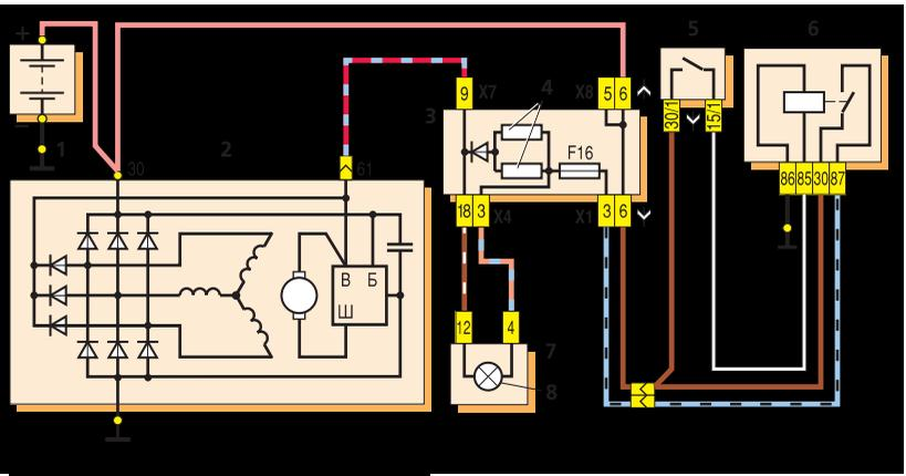
**Схема соединений генератора 37.3701 (с монтажным блоком 2114-3722010-60):** 1 — аккумуляторная батарея; 2 — генератор; 3 — монтажный блок; 4 — дополнительные резисторы по 100 Ом, 2 Вт; 5 — выключатель зажигания; 6 — реле зажигания; 7 — комбинация приборов; 8 — контрольная лампа разряда аккумуляторной батареи
