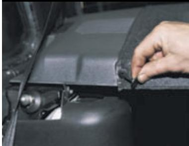
Снимаем замки пистонов...
