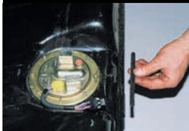
От перетирания сливного трубопровода о край бака предохраняет резиновый защитный элемент.
