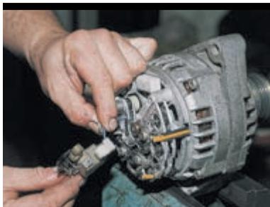
Отсоединяем провод и снимаем регулятор напряжения с щеткодержателем.
