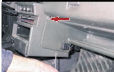
Крестообразной отверткой отворачиваем с обеих сторон консоли по одному саморезу верхнего (по стрелке) и нижнего креплений накладки консоли.
