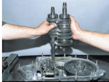
Вынимаем одновременно первичный и вторичный валы из роликовых подшипников картера сцепления.
