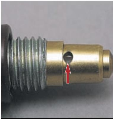
Жиклер с деформированными отверстиями следует заменить новым, с такой же маркировкой. Уплотнительное кольцо электромагнитного клапана, потерявшее упругость или с разрывами, заменяем новым.
