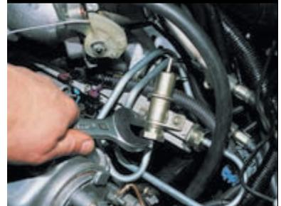
Ключом «на 24» отворачиваем гайку крепления сливной трубки, постепенно стравливая давление топлива.
