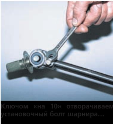
Ключом «на 10» отворачиваем установочный болт шарнира...
