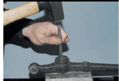
...и окончательно допрессовываем, нанося удары по выколотке диаметром 8 мм через три окна в слое резины.
