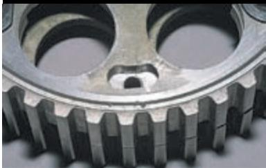
После точного совмещения шкивов видно, что резьбовое отверстие в зубчатом венце составного шкива располагается по центру прорези в ступице.
