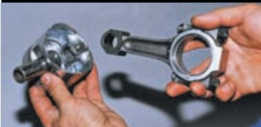
Снимаем поршень с шатуна.
