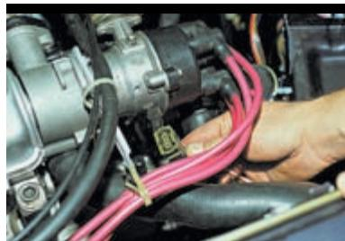
...и колодку проводов. Снимаем крышку.
