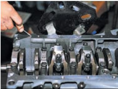
Класс цилиндра, обозначаемый буквами А, В, С, D, Е клеймится на нижней плоскости блока цилиндров.
