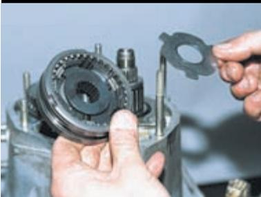
Вынимаем упорную пластину.
