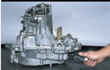
Вдавлив до упора шток выбора передач, включаем третью передачу или, вытянув шток до упора, — четвертую.
