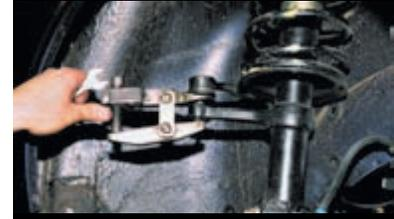
Съемником выпрессовываем палец из рычага.
