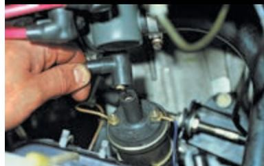
Вынимаем центральный провод.
