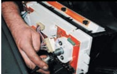
Отвернув накидную гайку, отсоединяем трос от спидометра.
