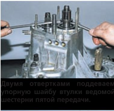
Двумя отвертками поддеваем упорную шайбу втулки ведомой шестерни пятой передачи.
