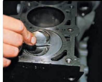
При установке поршней в цилиндры стрелка на днище поршня должна быть обращена в сторону привода ГРМ.
