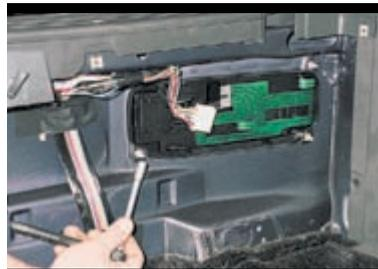
Для снятия фонаря головкой «шпатель» отворачиваем четыре гайки (под одной из гаек расположена клемма «массового» провода).
