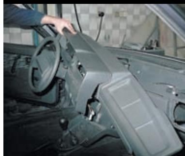
Освободив усики нижнего крепления щитка, снимаем накладку в сборе с щитком.
