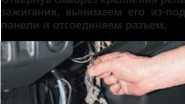
Разъединяем «массовый» провод реле.
