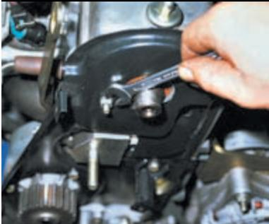
Ключом «на 10» отворачиваем гайку...
