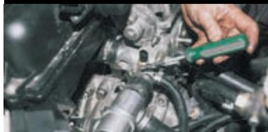
Крестообразной отверткой ослабляем хомуты и снимаем все шланги с выпускного патрубка головки блока цилиндров.
