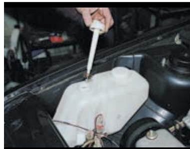
Отворачиваем против часовой стрелки и вынимаем датчик уровня жидкости.
