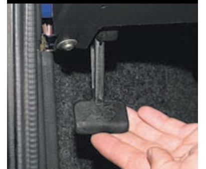
Чтобы открыть капот, тянем на себя рукоятку привода замка капота.
