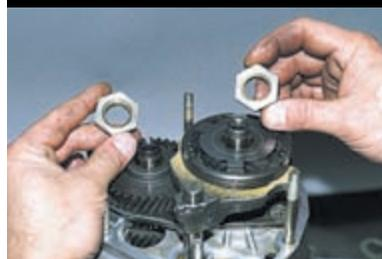
...отворачиваем гайки валов.
