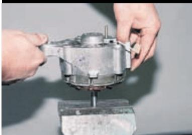
Наворачиваем на резьбу вала гайку, зажимаем ее в тиски и рывком снимаем заднюю крышку со статором.
