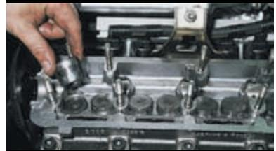
Вынимаем толкатель с регулировочной шайбой из гнезда головки блока цилиндров.
