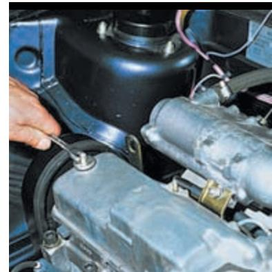
Ключом «на 10» отворачиваем две гайки крепления крышки головки блока цилиндров.
