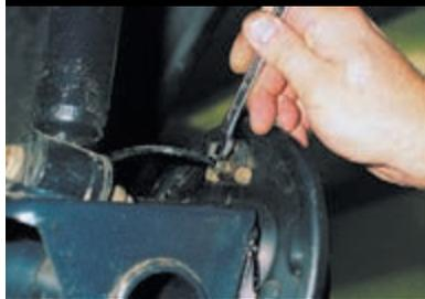
Ключом «на 10» (или специальным ключом, охватывающим пять граней гайки) отворачиваем штуцер тормозной трубки.
