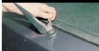
Поднимаем поводок, ключом «на 10» отворачиваем гайку его крепления...
