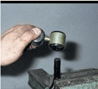
Снимаем стойку стабилизатора поперечной устойчивости,
