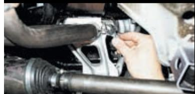
Ключом «на 13» отворачиваем две гайки хомута кронштейна крепления приемной трубы.
