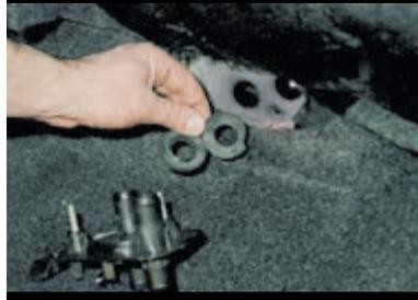
Снимаем резиновые прокладки патрубков крана с щитка передка.
