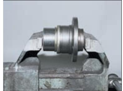
...или в тисках, причем усилие запрессовки прикладываем к наружному кольцу (это удобно делать через наружное кольцо старого подшипника). Устанавливаем стопорное кольцо.
