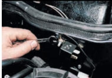
Ключом «на 8» отворачиваем гайку.
