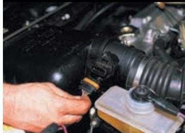
Выключив зажигание, отсоединяем электрический разъем датчика.
