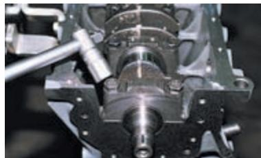
Головкой «на 17» отворачиваем десять болтов крепления крышек коренных подшипников коленчатого вала.
