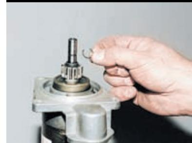
Поддев тонкой отверткой, снимаем запорное кольцо.
