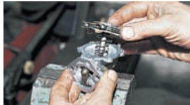
Вдавлив и повернув на 90° диафрагменный узел, вынимаем его.
