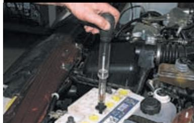
Плотность электролита измеряем ареометром.
