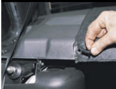
...и, поддев отверткой, снимаем пистоны.
