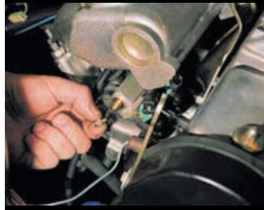
Колпачком колесного вентиля выворачиваем золотник из штуцера топливной рампы, постепенно стравливая давление топлива.
