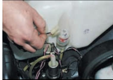
Отсоединив провода, приподнимаем бачок,
