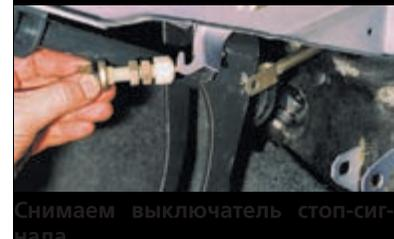
Снимаем выключатель стоп-сигнала.
