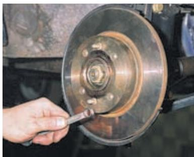
Накидным ключом «на 12» отворачиваем направляющие штифты...
