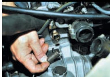
Снимаем с датчика температуры провод (для наглядности термостат снят).
