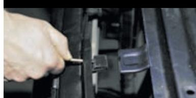
Шлицевой отверткой отжимаем вниз язычок центрального фиксатора и выводим фиксатор из кронштейна.
