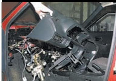
Панель приборов можно снять, не отсоединяя от нее кронштейна. Снимаем воздуховоды панели приборов.
