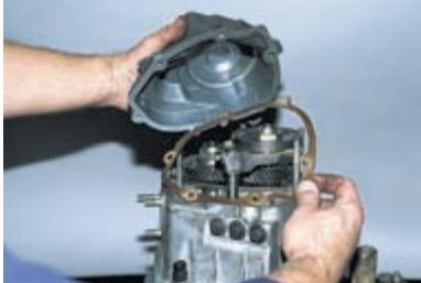
...снимаем ее вместе с уплотнительной прокладкой со шпилек.
