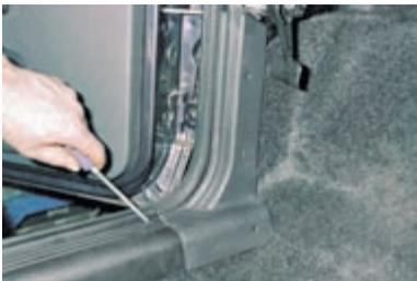
Отворачиваем по четыре самореза крепления накладки правого и левого порогов.
