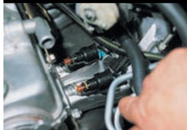
Потянув рампу вдоль оси форсунок, вынимаем все четыре форсунки из посадочных мест...
