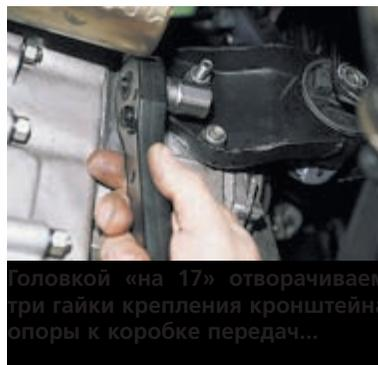
Головкой «на 17» отворачиваем три гайки крепления кронштейна опоры к коробке передач...
