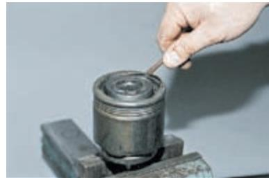
Зажав вал шарнира в тиски с накладками из мягкого металла, отверткой поддеваем стопорное кольцо...
