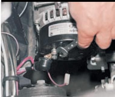
Ключом «на 10» отворачиваем гайку крепления наконечников проводов к выводу «В+»...
