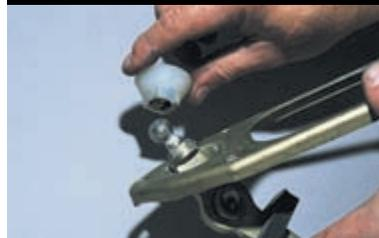
Вынимаем сферический конец рычага из шаровой опоры.
