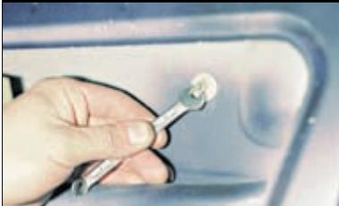
Ключом или головкой «на 8» отворачиваем внутреннюю гайку крепления ручки...
