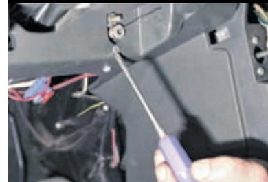
Крестообразной отверткой отворачиваем два самореза крепления к панели приборов кронштейна троса привода воздушной заслонки.
