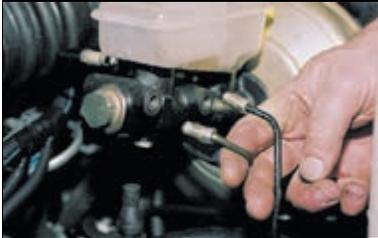
Отводим трубки от цилиндра.
