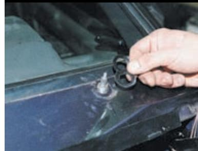
Снимаем пластиковую и резиновую шайбы.
