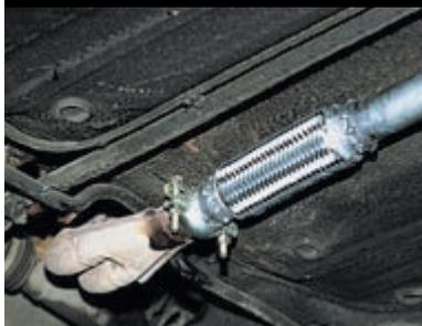
Устанавливаем дополнительный глушитель с металлокомпенсатором на автомобиль.
