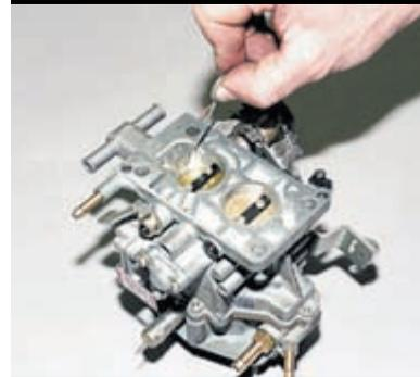
При полностью закрытой воздушной заслонке дроссельная заслонка первой камеры должна быть приоткрыта на пусковой зазор С (см. таблицу выше).
