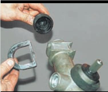
Снимаем опору и защитный колпачок с левой стороны картера.
