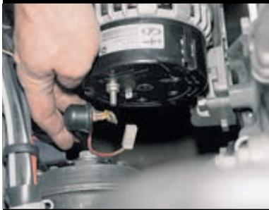
...и снимаем их. Снимаем ремень генератора, отворачиваем регулировочный болт генератора и фиксируем гайку (см. «Проверка натяжения и замена ремня привода генератора 9402.3701», с. 31).
