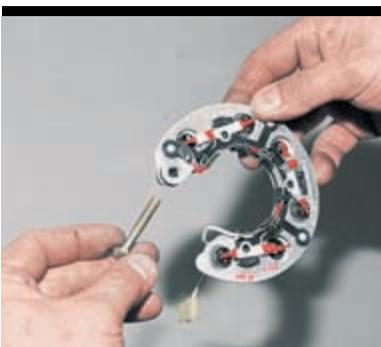
Вынимаем из выпрямительного блока контактный болт.
