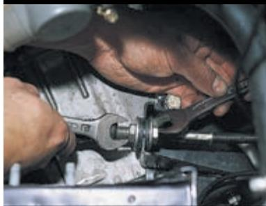
...двумя ключами «на 17» ослабляем гайки крепления нижнего наконечника оболочки троса к кронштейну (для наглядности шланг радиатора снят).
