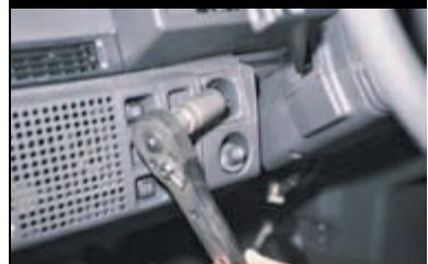
Головкой «на 21» отворачиваем гайку крепления...
