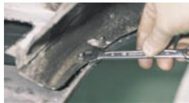
Ключом «на 10» отворачиваем с каждой стороны по две гайки бокового крепления бампера к кузову.
