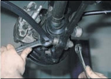
Удерживая растяжку рожковым ключом «на 24», накидным ключом того же размера отворачиваем гайку растяжки.
