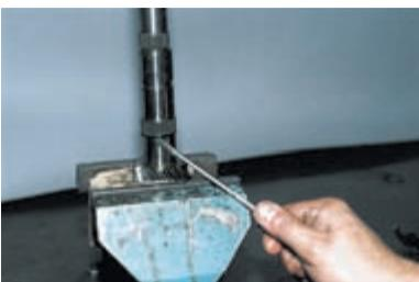
...и второе стопорное кольцо ступицы синхронизатора. Зажимаем ведомую шестерню главной передачи в тиски с мягкими губками.
