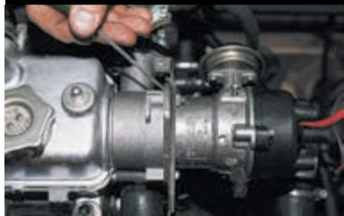
Совмещаем выступ на корпусе вспомогательных агрегатов с серединой шкалы на датчике-распределителе.
