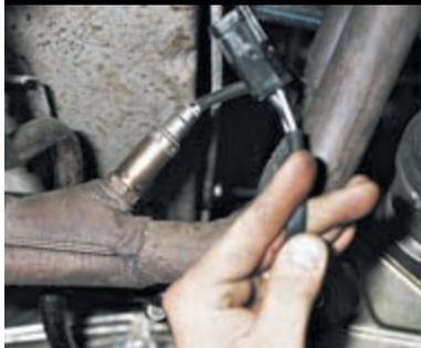
Отсоединяем разъем кислородного датчика.
