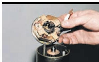
Снимаем заднюю крышку с щеткодержателем.
