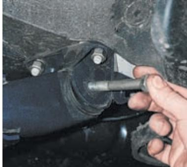
...и вынимаем его. Между кузовом и балкой вставляем деревянный брусок.
