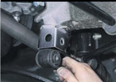
Вынимаем (или выбиваем) болт и выводим рычаг из кронштейна.
