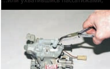
...вынимаем малые диффузоры.
