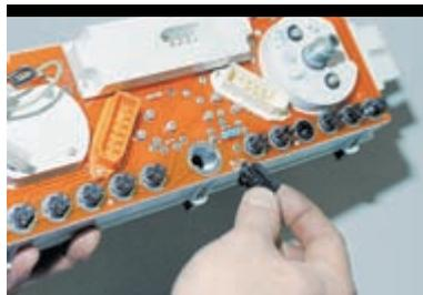
Для замены лампы поворачиваем патрон против часовой стрелки и извлекаем его из комбинации приборов.
