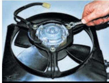
Ключом «на 10» отворачиваем три гайки крепления электродвигателя к кожуху и снимаем электродвигатель.
