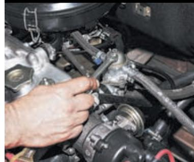
...ключом «на 10» отворачиваем болт крепления крышки.
