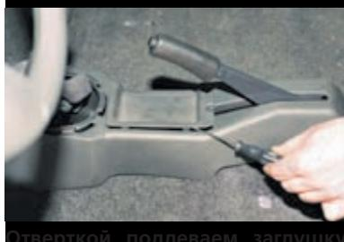
Отверткой поддеваем заглушку облицовки тоннеля ...
