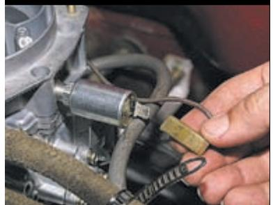
...отсоединяем колодку провода от вывода электромагнитного клапана.
