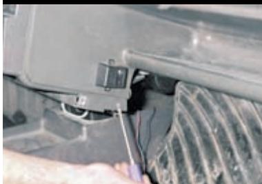
Крестообразной отверткой отворачиваем с каждой стороны по одному саморезу крепления консоли панели приборов.
