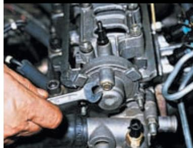
Ключом «на 10» отворачиваем болт...
