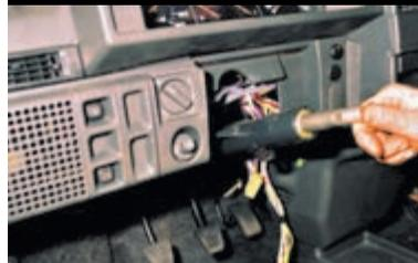
...и снимаем рулевую колонку.
