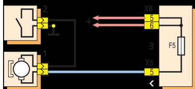
**Схема включения электродвигателя вентилятора системы охлаждения карбюраторного двигателя с новым монтажным блоком:**
