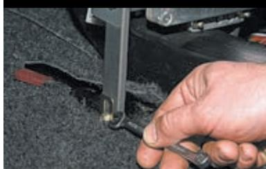
Ключом «на 8» отворачиваем саморез нижнего крепления левой стойки кронштейна панели приборов (к кронштейну пола кузова).
