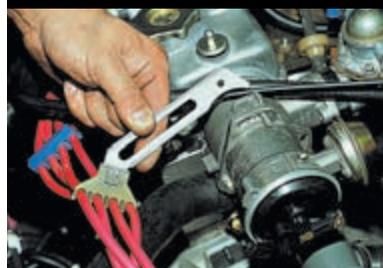
...и снимаем держатель высоковольтных проводов. Отвернув еще две гайки,...
