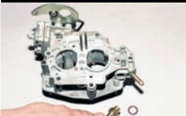
...и снимаем его вместе с уплотнительным медным кольцом.
