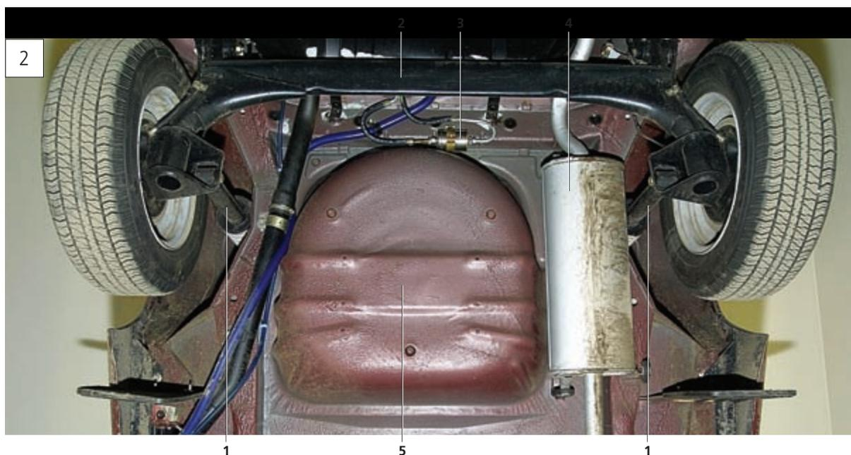
**Задняя часть днища автомобиля:** 1 – амортизатор; 2 – балка задней подвески (ходовая часть); 3 – топливный фильтр системы питания (только автомобиль с впрысковым двигателем); 4 – основной глушитель системы выпуска отработавших газов; 5 – ниша днища багажника для запасного колеса
