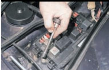
Головкой «на 10» отворачиваем две гайки крепления блока предохранителей.
