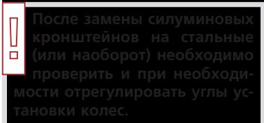
После замены алюминиевых кронштейнов на стальные (или наоборот) необходимо проверить и при необходимости отрегулировать углы установки колес.
