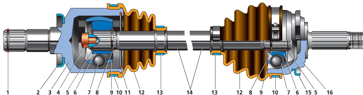
**Привод переднего колеса:** 1 – стопорное кольцо корпуса внутреннего шарнира; 2 – защитное кольцо внутреннего шарнира; 3 – корпус внутреннего шарнира; 4 – упор вала; 5 – стопорное кольцо; 6 – обойма; 7 – шарик; 8 – упорное кольцо; 9 – сепаратор; 10 – наружный хомут; 11 – фиксатор внутреннего шарнира; 12 – защитный чехол; 13 – внутренний хомут; 14 – вал привода колеса; 15 – защитное кольцо наружного шарнира; 16 – корпус наружного шарнира
