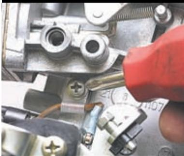
...отворачиваем винт крепления провода.
