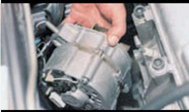
Вынимаем генератор вверх...
