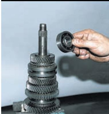
Снимаем задний подшипник.
