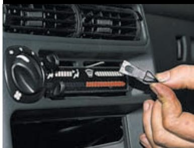
...снимаем рукоятки с рычагов управления заслонками отопителя. Для наглядности показываем эти операции на снятом блоке рычагов управления отопителем.
