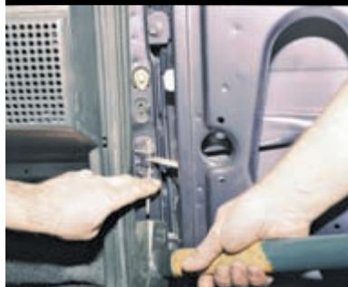
...или стержнем диаметром 5 мм выбиваем ось ограничителя...
