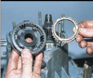
Снимаем блокирующее кольцо синхронизатора.
