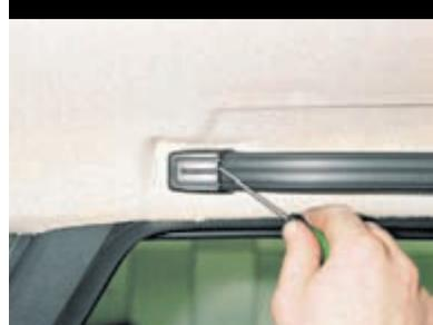
Поддеваем отверткой заглушки поручня...
