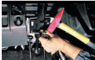
Два болта переднего крепления кронштейна вала рулевого управления имеют срезные головки, поэтому отворачиваем их, нанося удары молотком через зубило в тангенциальном направлении.
