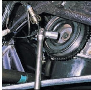
Головкой «на 19» проворачиваем коленчатый вал по часовой стрелке за болт крепления шкива...
