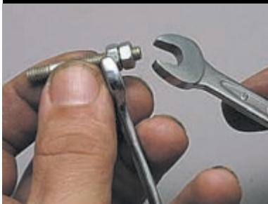
Чтобы гайки не проворачивались на шпильке, двумя ключами аккуратно законтриваем их, стараясь не сорвать резьбу.
