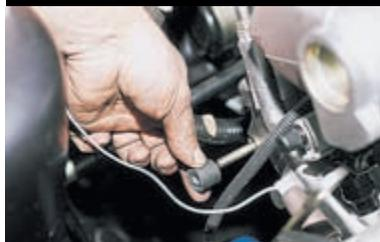
Снимаем со шпильки впускного коллектора втулку.
