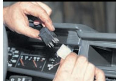
Отсоединив от выключателя разъем, проталкиваем его внутрь накладки панели приборов.
