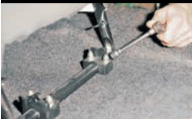
Головкой «на 13» отворачиваем четыре гайки крепления кронштейнов...
