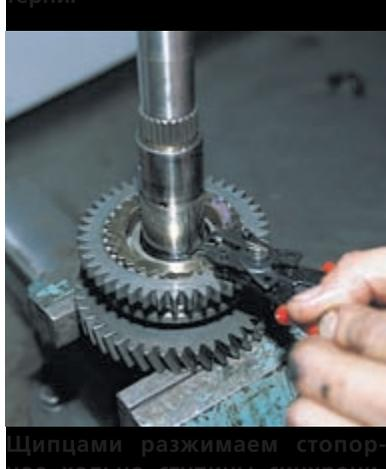
Щипцами разжимаем стопорное кольцо ступицы синхронизатора...
