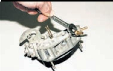
Ключом «на 13» отворачиваем топливоподводящий штуцер...
