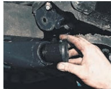
Новый сайлент-блок и отверстие в балке смачиваем мыльным раствором.
