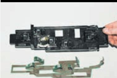
...и снимаем их (при снятии запоминаем, как заправлены ленты в ламповые патроны).
