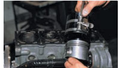
...сжимаем регулируемой оправкой поршневые кольца.
