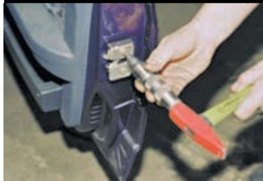
Ударной отверткой с крестообразным наконечником № 3 ослабляем два винта крепления замка.
