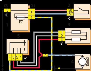
Схема включения электродвигателя вентилятора отопителя: 1 – монтажный блок; 2 – выключатель зажигания; 3 – дополнительный резистор; 4 – электродвигатель отопителя; 5 – переключатель электродвигателя отопителя
