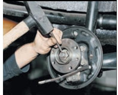
Вминаем буртик гайки в паз оси ступицы.
