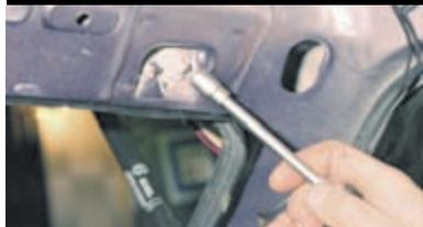
Головкой «на 10» отворачиваем по две гайки крепления каждой петли двери задка...
