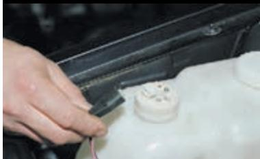
Отсоединяем разъем датчика уровня жидкости в бачке стеклоомывателя.
