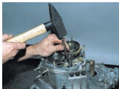
Через выколотку из мягкого металла наносим удар по вилке вниз, включая пятую передачу.
