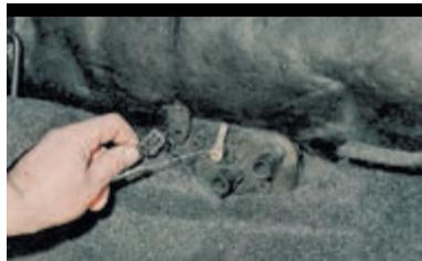
Снимаем скобу тяги и выводим тягу из отверстия рычага крана.
