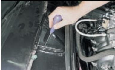
Крестообразной отверткой отворачиваем четыре самореза крепления защитного кожуха...
