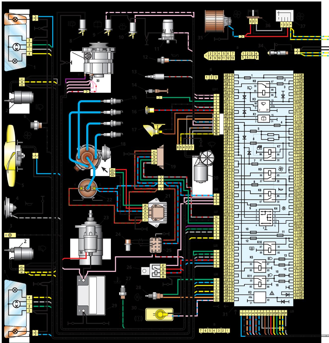
**Схема электрооборудования автомобилей ВАЗ-2108, ВАЗ-21083, ВАЗ-2109, ВАЗ-21093 и ВАЗ-21099 — исполнения «стандарт» (с панелью приборов 2108, с монтажным блоком типа 17.3722, годы выпуска 1988—1999):**
