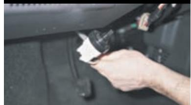
...и снимаем цилиндр гидрокорректора.
