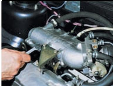
Ключом «на 10» отворачиваем две гайки крепления кронштейна троса привода дроссельной заслонки к ресиверу (только для двигателя ВА3-2111)...
