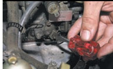
Отверткой отворачиваем три винта крепления крышки диафрагмы экономайзера.
