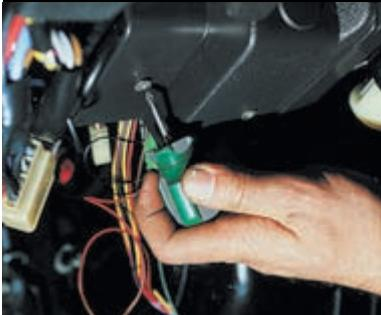
Крестообразной отверткой отворачиваем два винта крепления блока управления к нижней полке панели приборов (справа от рулевой колонки).
