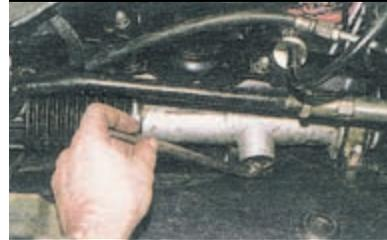
Между гайкой и упором рейки выставляем зазор 0,12 мм (регулировка показана на установленном в автомобиль рулевом механизме).
