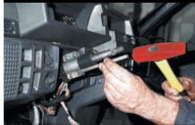
У болтов крепления выключателя зажигания головки срезаны. Поэтому отворачиваем их зубилом.
