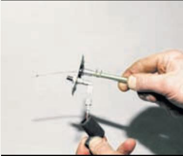
...отсоединяем клемму выключателя.
