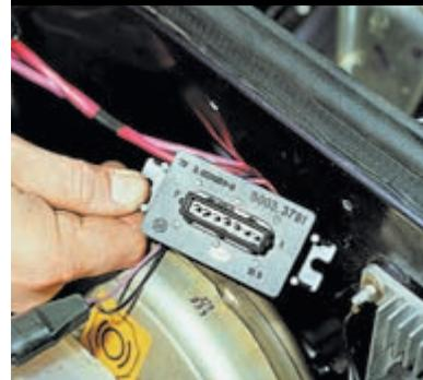
Снимаем блок управления ЭПХХ.
