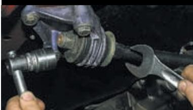
Удерживая растяжку рожковым ключом «на 24», головкой той же размерности отворачиваем гайку крепления растяжки к кронштейну.
