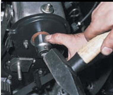
Смазав моторным маслом рабочую кромку нового сальника, запрессовываем его отрезком трубы или головкой подходящего диаметра.
