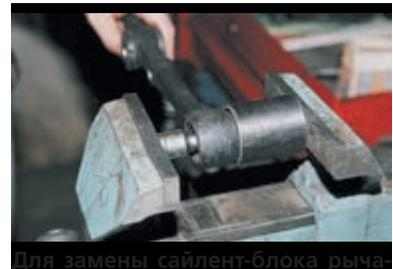
Для замены сайлент-блока рычага выпрессовываем его в тисках подходящими отрезками труб. Новый сайлент-блок смачиваем мыльным раствором и запрессовываем в рычаг.
