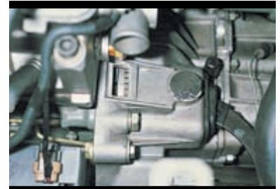
...убеждаемся, что риска на маховике расположена напротив прорези крышки картера сцепления (шланг подвода охлаждающей жидкости к радиатору для наглядности снят).
