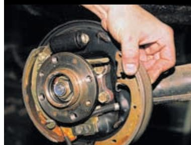
Отсоединив нижнюю стяжную пружину, снимаем переднюю колодку.
