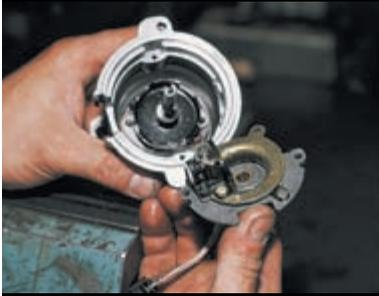
Снимаем держатель переднего подшипника с датчиком Холла.
