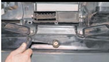
Головкой «на 8» отворачиваем гайку и снимаем воздуховод в сборе.
