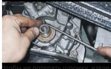
Чтобы не потерять шпонку, извлекаем ее из паза коленчатого вала.
