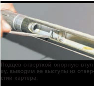
Поддев отверткой опорную втулку, выводим ее выступы из отверстий картера.
