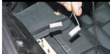
...и отсоединяем колодки двух проводов от плафона освещения вещевого ящика.
