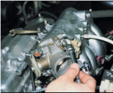
Головкой «на 13» отворачиваем две гайки крепления дроссельного узла к ресиверу.
