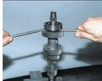
Поддеваем двумя монтажными лопатками задний шариковый подшипник...
