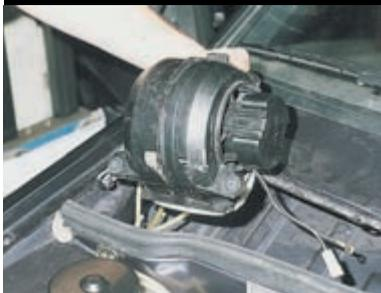
Выводим вентилятор отопителя из коробки воздухопритока.
