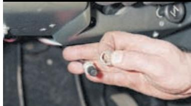
Вынимаем рукоятку с тросом из панели приборов.
