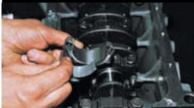
Вынимаем нижний вкладыш шатунного подшипника из крышки.
