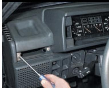
Крестообразной отверткой отворачиваем с каждой стороны по одному саморезу бокового крепления накладки.
