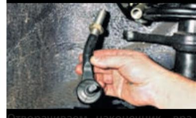
Отворачиваем наконечник, вращая его по часовой стрелке.
