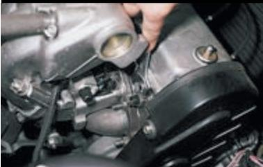
Ключом «на 21» отворачиваем датчик.
