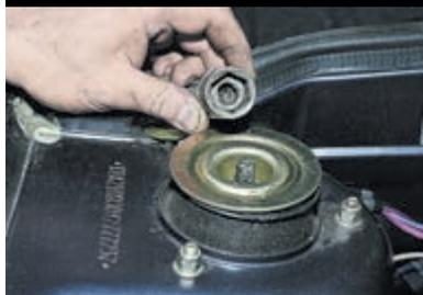
Снимаем заглушку верхней опоры и специальным ключом, позволяющим удерживать шток при отворачивании гайки,
