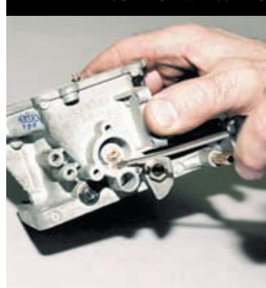
Шлицевой отверткой отворачиваем жиклер экономайзера и вынимаем его.
