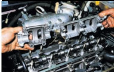
Снимаем со шпилек передний и задний корпусы подшипников распределительного вала.
