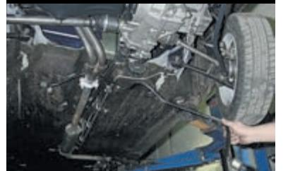
Выводим стабилизатор поперечной устойчивости из пространства между системой выпуска и днищем кузова.
