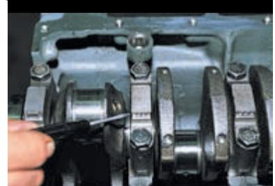
Устанавливаем крышки коренных подшипников в соответствии с метками (см. рис.), нанесенными на их наружной поверхности (счет крышек ведется со стороны привода ремня ГРМ). При этом замки верхнего и нижнего вкладышей каждого коренного подшипника должны быть расположены с одной стороны.
