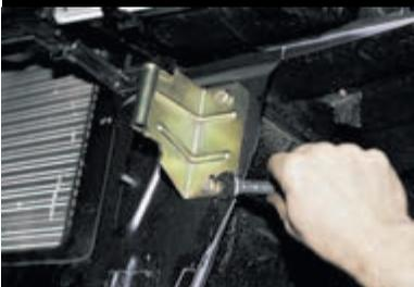
Ключом «на 13» отворачиваем два болта крепления к кузову переднего кронштейна...
