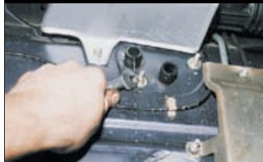
В моторном отсеке ключом «на 10» отворачиваем две гайки крепления корпуса крана к щитку передка.
