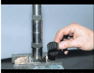
Снимаем игольчатый подшипник шестерни...
