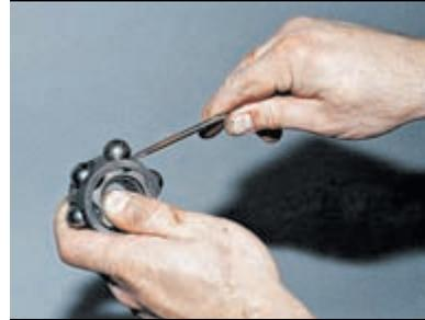
Поддевая отверткой, вынимаем шесть шариков.
