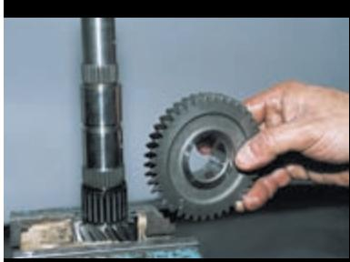
Снимаем ведомую шестерню I передачи.
