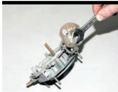
Ключом «на 14» отворачиваем болт крепления (ось) рычага управления воздушной заслонкой...
