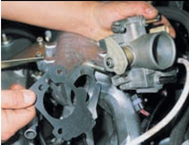
Снимаем дроссельный узел со шпилек и уплотнительную прокладку.
