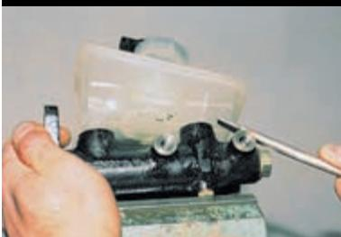
Чтобы снять бачок, поддеваем его отверткой с двух сторон. Устанавливаем главный цилиндр в обратную последовательность. Прокачиваем систему гидропривода тормозов (см. «Прокатка тормозов», с. 149).
