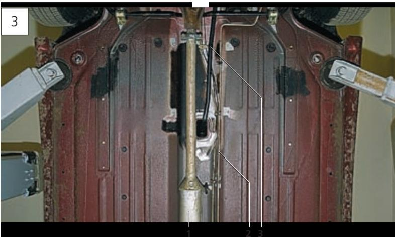
**Днище автомобиля под сиденьями водителя и переднего пассажира:** 1 – дополнительный глушитель системы выпуска; 2 – трубопроводы гидропривода тормозной системы и системы питания двигателя; 3 – тяга привода управления коробкой передач (трансмиссия)
