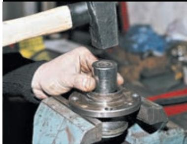
Через отрезок подходящей трубы выбиваем подшипник, опираясь на внутреннее кольцо,
