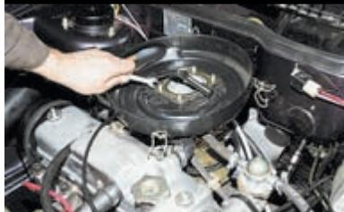
Ключом «на 8» отворачиваем четыре самоконтрящиеся гайки крепления корпуса воздушного фильтра...
