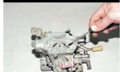
Шлицевой отверткой поддеваем распылительные трубки ускорительного насоса...
