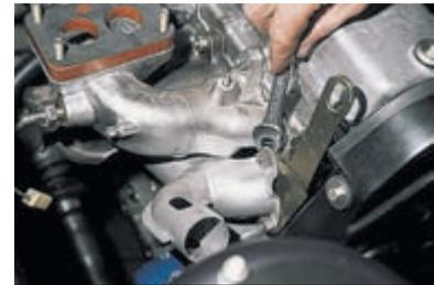
Ключом «на 13» отворачиваем две гайки крепления патрубка забор горячего воздуха и рыма.
