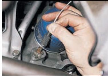
Отсоединяем провод от датчика.
