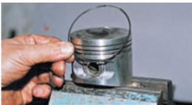
Снимаем расширитель масляного кольца.
