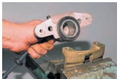
Снимаем колесный цилиндр.
