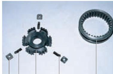
...и вынимаем из муфты 1 ступицу 5, пружины 4 с фиксаторами 3 и сухари 2 синхронизатора пятой передачи.
