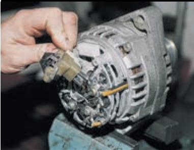
...и отводим регулятор напряжения с щеткодержателем.
