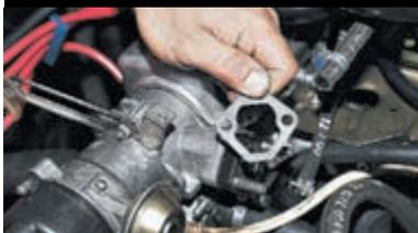
Снимаем уплотнительную прокладку.
