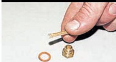
Вынимаем топливный фильтр, ...промываем его в чистом бензине и продуваем.
