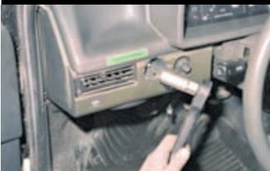
Отвернув высокой головкой «на 21» гайку крепления,
