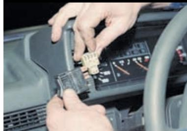
Отсоединяем от переключателя разъем и проталкиваем его внутрь накладки панели приборов.
