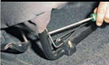
Отодвигаем сиденье назад до упора и отверткой отсоединяем торсионы от стойки основания подушки.
