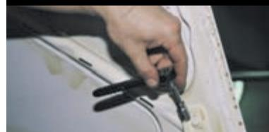
Головкой «на 10» отворачиваем по две гайки крепления петель к крышке багажника...
