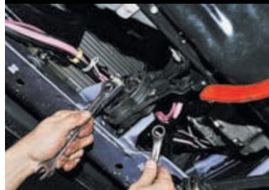
Двумя ключами «на 17» отворачиваем гайку болта крепления опоры к кузову.
