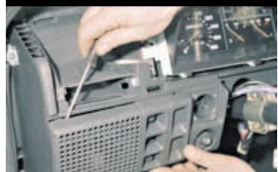
Поддев отверткой, осторожно (чтобы не сломать пластиковые защелки), отжимаем вниз левую облицовку громкоговорителя панели приборов...
