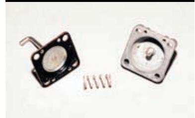
Осторожно отделив диафрагму от крышки, снимаем ее и находящуюся под ней пружину.
