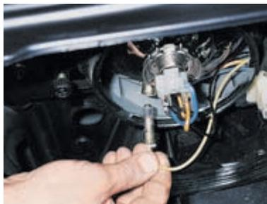
Вынимаем патрон лампы габаритного света.
