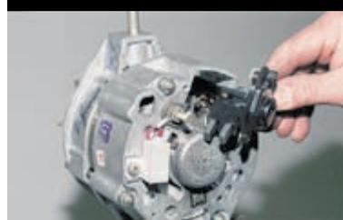
Снимаем регулятор напряжения с щеткодержателем.
