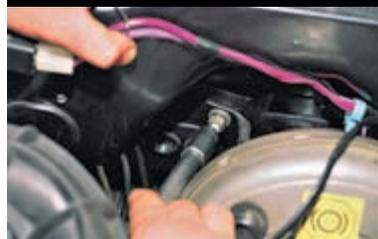
Головкой «на 13» отворачиваем четыре гайки крепления кронштейна вакуумного усилителя к кузову.
