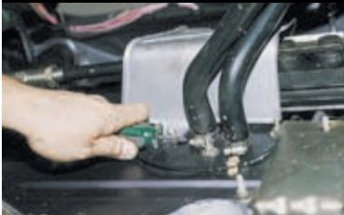
В моторном отсеке ослабляем затяжку хомутов крепления подводящего и отводящего шлангов отопителя к патрубкам крана...
