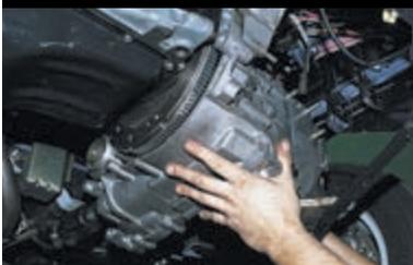
Отводим коробку передач от двигателя и снимаем ее.
