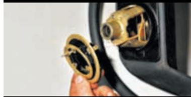
...и, отсоединив разъем провода, снимаем кольцо.
