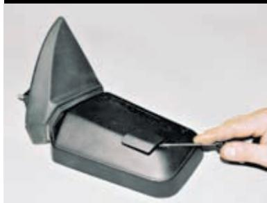
Отверткой поддеваем заглушку крепления зеркального элемента.
