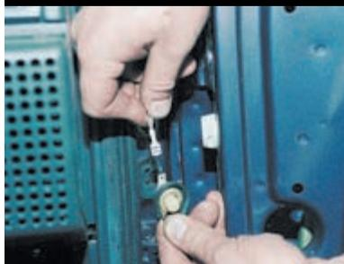
Отсоединив провод, снимаем выключатель освещения салона.
