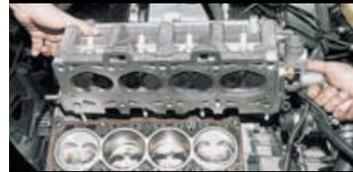
Снимаем головку блока цилиндров...
