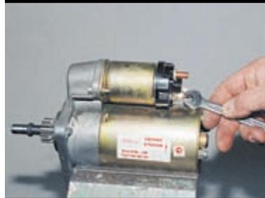
Ключом «на 10» отворачиваем гайку нижнего вывода тягового реле.
