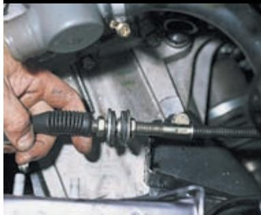
Вынимаем трос из гнезда кронштейна.
