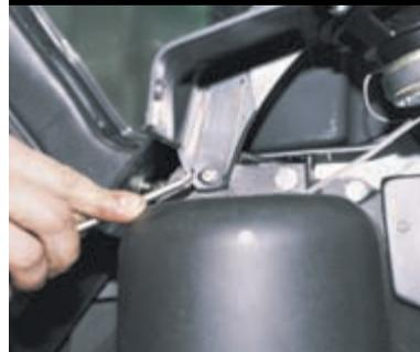
Отворачиваем саморезы крепления полок динамиков.
