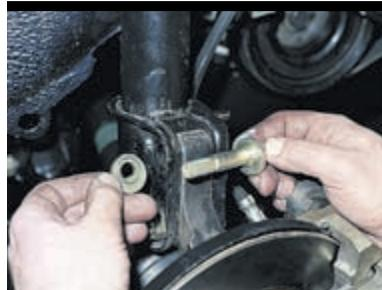
Так выглядят болт и шайба для регулировки развала. Аналогично снимаем нижний болт.
