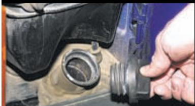
Чтобы снять пробку топливного бака, отворачиваем ее против часовой стрелки.
