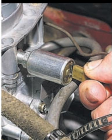
Подсоединяем наконечник к выводу клапана.
