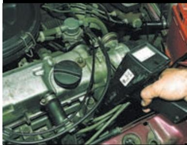
Запускаем двигатель и направляем мигающий поток света стробоскопа в люк картера сцепления.
