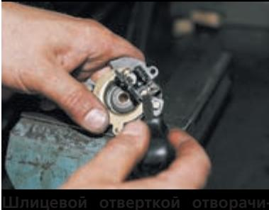
Шлицевой отверткой отворачиваем два винта...
