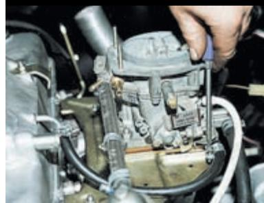
Крестообразной отверткой ослабляем хомут тонкого шланга вентиляции картера...
