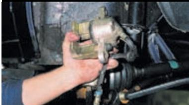
Снимаем колесный цилиндр в сборе с суппортом.
