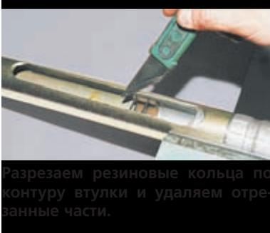
Разрезаем резиновые кольца по контуру втулки и удаляем отрезанные части.
