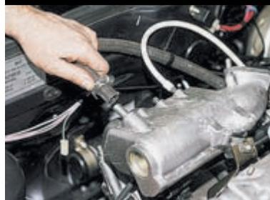
Отсоединяем от ресивера шланги вакуумного усилителя...
