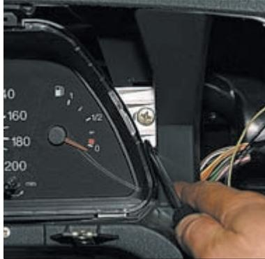
Крестообразной отверткой отворачиваем два самореза крепления комбинации приборов: один справа... и один — слева.
