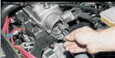
Шестигранным ключом «на 5» отворачиваем винт крепления корпуса вспомогательных агрегатов к головке блока цилиндров.
