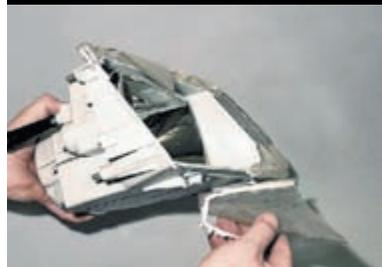
Удаляем осколки стекла. Очищаем внутреннюю поверхность фары, стараясь не повредить отражатель.
