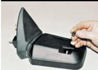
Снимаем пружину и шайбу...
