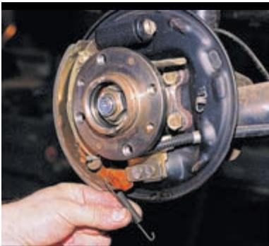
Снимаем нижнюю стяжную пружину.
