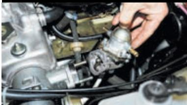
Снимаем насос со шпилек.
