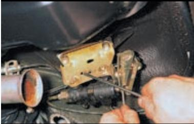
...и перемещаем кронштейн отверткой так, чтобы зазор между рычагом и пружиной рычага был в пределах 2,0–2,1 мм.
