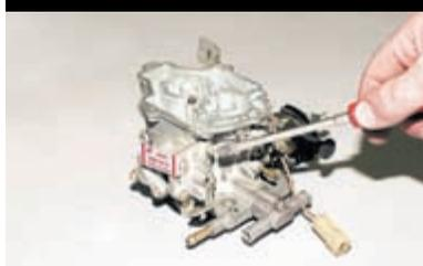
Шлицевой отверткой отворачиваем четыре винта крепления крышки ускорительного насоса...
