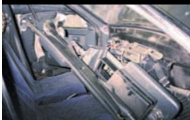
Снимаем панель приборов. Устанавливаем панель в обратной последовательности.
