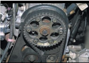
Так выглядит установленный на двигателе составной шкив с вставленной в него регулировочной шкалой.
