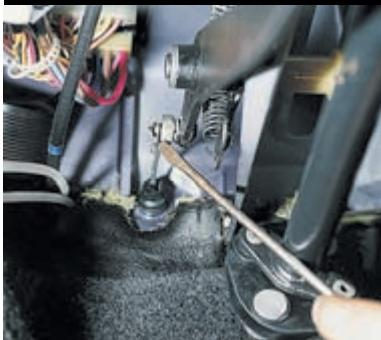
В салоне под панелью приборов отверткой поддеваем стопорную скобу пальца педали сцепления и снимаем скобу.
