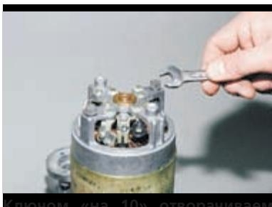
Ключом «на 10» отворачиваем два стяжных болта.
