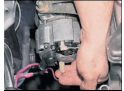
Отсоединяем провод вывода «В» генератора.
