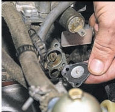
Снимаем поврежденную диафрагму.
