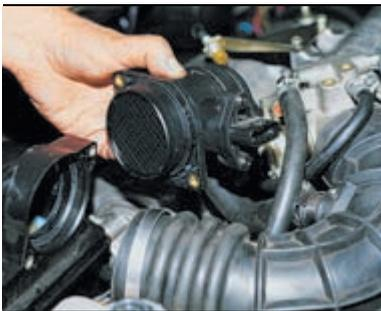
Снимаем датчик массового расхода воздуха...
