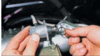
...и снимаем его уплотнительное кольцо.
