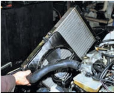
Наклонив радиатор к двигателю, снимаем его вместе с электровентилятором.
