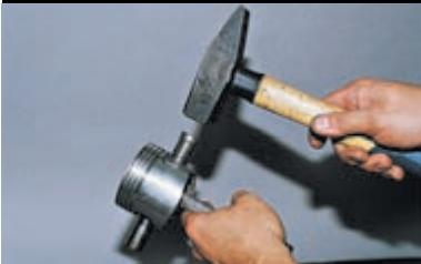
Выпрессовываем палец ударами молотка по оправке, держа шатун навесу или уложив поршень в деревянную опору с цилиндрической выемкой под юбку поршня и отверстием под палец.
