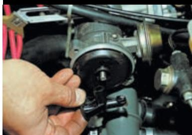
Потянув, снимаем бегунок с вала. Установка бегунка производится только в одном положении, когда прорезь на валу направлена в противоположную от контакта сторону. Для демонтажа датчика-распределителя отсоединяем...
