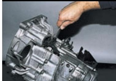
Снимаем резиновый чехол вилки выключения сцепления.
