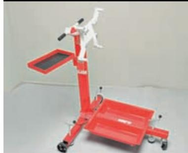
Стенд для разборки двигателя
