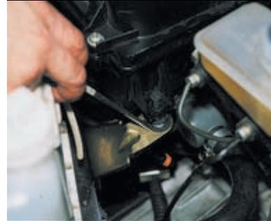
Поддеваем отверткой заднюю опору корпуса фильтра и вынимаем ее из отверстия кронштейна.
