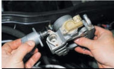
Вынимаем регулятор холостого хода (для наглядности эту операцию выполняем на демонтированном дроссельном узле)...
