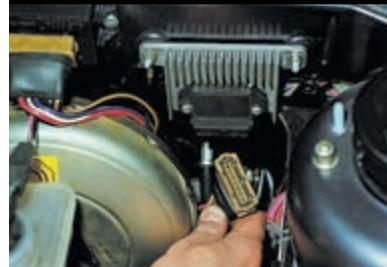
Отсоединяем разъем от коммутатора.
