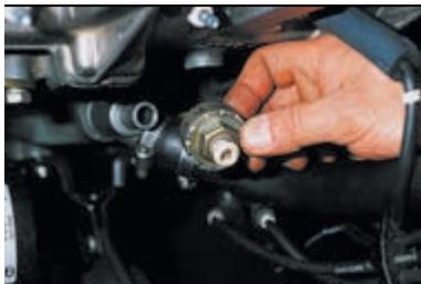
...отворачиваем датчик. Для проверки датчика подсоединяем к его контакту и корпусу щупы тестера.
