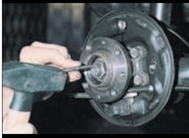
Узким зубилом выправляем замятый буртик гайки.
