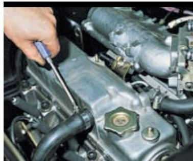
Крестообразной отверткой ослабляем хомут крепления подводящего шланга вентиляции картера.
