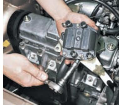
Головкой «на 10» отворачиваем три гайки крепления модуля зажигания к кронштейну.
