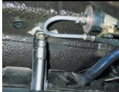
Придерживая бак снизу, головкой «на 13» отворачиваем два болта крепления прижимных лент.
