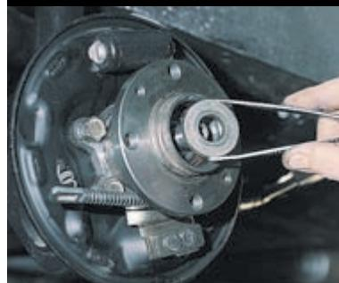
Снимаем упорную шайбу.
