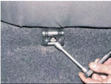
Головкой «на 10» отворачиваем два болта крепления подушки сиденья.
