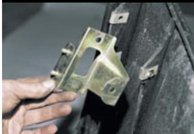
...и снимаем кронштейны. Операцию по снятию балки бампера см. в разделе «Снятие заднего бампера». Устанавливаем бампер в обратной последовательности.
