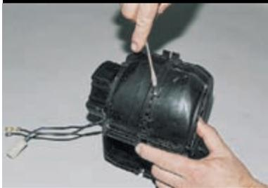
Поддеваем отверткой защелки...
