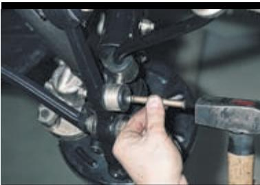
Выколоткой из мягкого металла выбиваем болт и вынимаем его.
