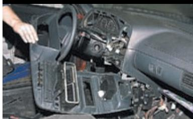
Снимаем щиток панели приборов.
