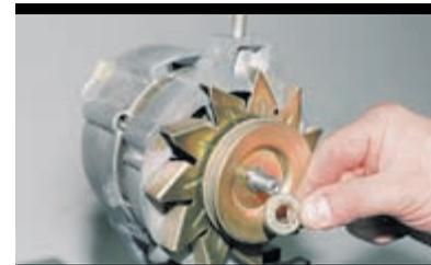
Снимаем с вала шайбу,
