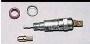
Вынимаем жиклер холостого хода, снимаем уплотнительное кольцо в чашку.
