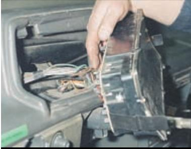
Отворачиваем накидную гайку крепления и отсоединяем трос от спидометра.
