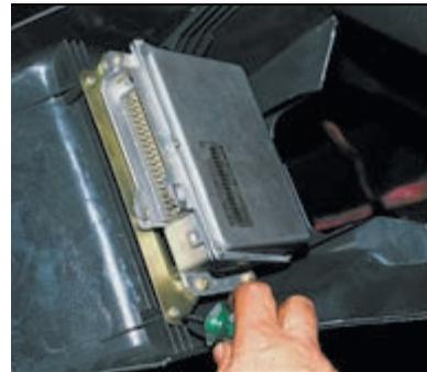
Крестообразной отверткой отворачиваем три самореза крепления контроллера к консоли...
