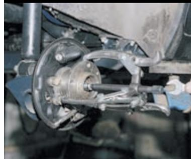
Снимаем ступицу универсальным съемником.
