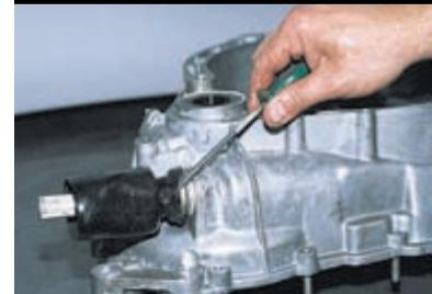
Поддев отверткой, снимаем защитный чехол штока с втулки.
