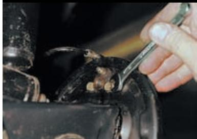
Ключом «на 10» отворачиваем два болта крепления цилиндра к шкиту тормозного механизма...
