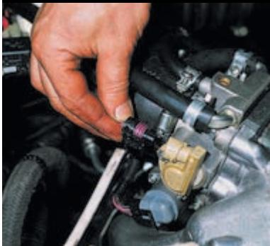
При выключенном зажигании отсоединяем электрический разъем датчика.
