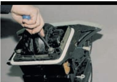
Крестообразной отверткой отворачиваем два винта крепления вентилятора к отопителю...
