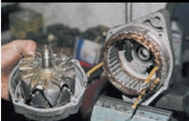
...разъединяем переднюю крышку со статором и заднюю крышку с ротором.
