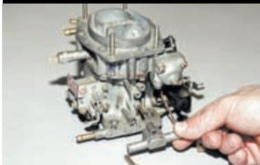
...и снимаем блок.
