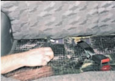
Головкой «на 10» отворачиваем два болта нижнего крепления спинки сиденья.
