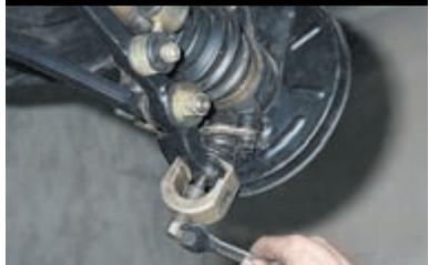
Можно использовать съемник и такой конструкции.
