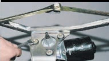
Ключом «на 10» отворачиваем три болта крепления моторедуктора к кронштейну...
