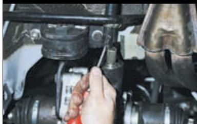
Сдвигаем тягу привода со шлицевого наконечника шарнира штока выбора передач.
