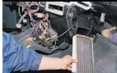
...и вынимаем радиатор отопителя. Устанавливаем радиатор в обратной последовательности. Заправляем систему охлаждения жидкостью.
