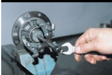
Вставив в образовавшийся зазор лопу съемника,
