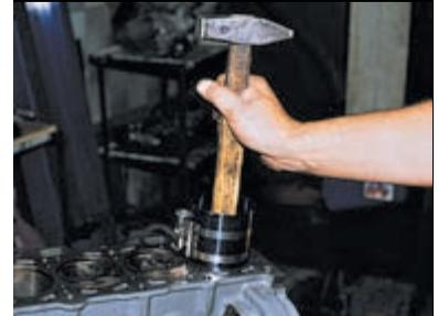
Упираясь деревянной ручкой молотка в днище поршня, вталкиваем его в цилиндр.
