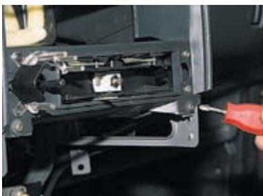
Крестообразной отверткой отворачиваем два самореза крепления кронштейна к панели приборов (под блоком рычагов управления отопителем).
