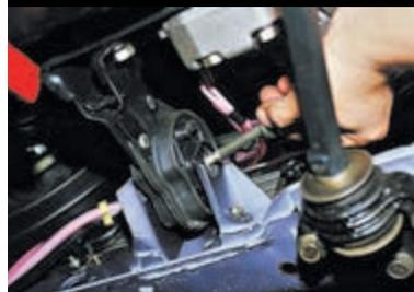
Вынимаем болт из опоры или выбиваем его выколоткой из мягкого металла.
