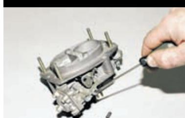
Вынимаем шарик и пружину.
