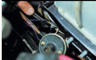
Ключом «на 10» отворачиваем две гайки крепления катушки к кронштейну...
