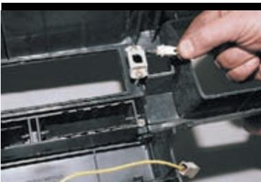
Для замены лампы подсветки выключателя аварийной сигнализации с внутренней стороны щитка панели приборов вынимаем патрон с лампой, повернув его в держателе.
