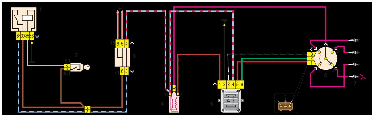
Схема бесконтактной системы зажигания: 1 – реле зажигания; 2 – выключатель зажигания; 3 – монтажный блок; 4 – катушка зажигания; 5 – коммутатор; 6 – датчик-распределитель; 7 – свечи
