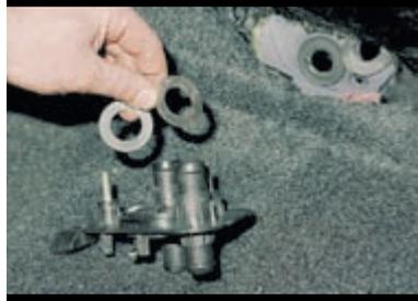
Снимаем с крана прижимные шайбы (металлические).
