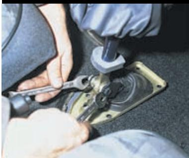
Ключом «на 13» отворачиваем гайку болта крепления рычага переключения передач к тяге привода, удерживая болт ключом того же размера.
