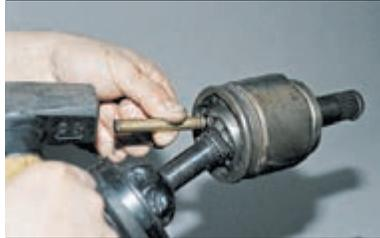
...шарнир нужно сдвинуть наружу по валу до упора.
