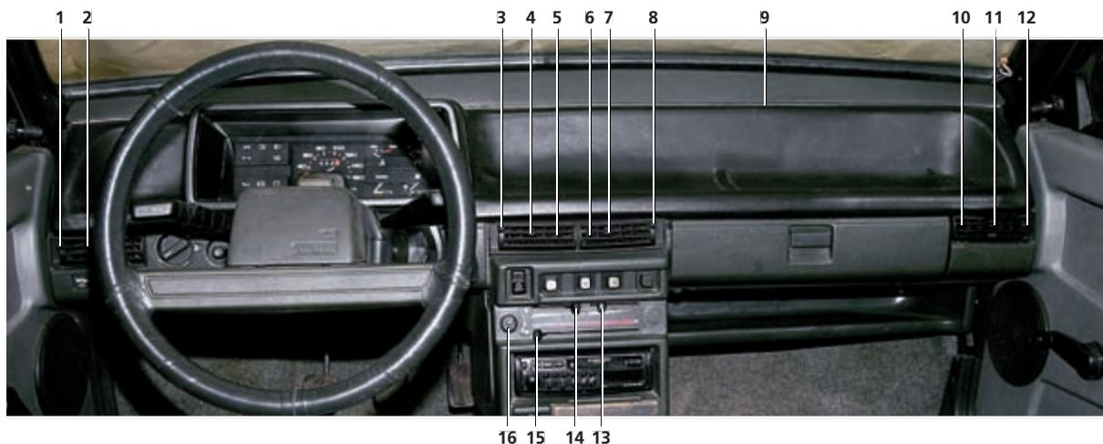
**Система отопления и вентиляции с панелью приборов 2108:** 1, 3, 8, 12 – рычаг заслонки дефлектора; 2, 10 – боковые дефлекторы панели приборов; 4, 7, 11 – рычаг поворота направляющих лопаток дефлектора; 5, 6 – центральные дефлекторы панели приборов; 9 – дефлектор обдува ветрового стекла; 13, 14 – рычаги распределения воздушных потоков; 15 – рычаг управления краном и заслонкой отопителя; 16 – выключатель электровентилятора
