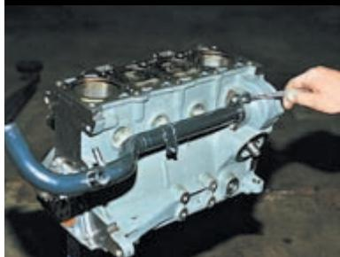
Ключом «на 10» отворачиваем два болта крепления подводящей трубы насоса охлаждающей жидкости.
