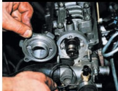
Снимаем заглушку и ее уплотнительное кольцо.
