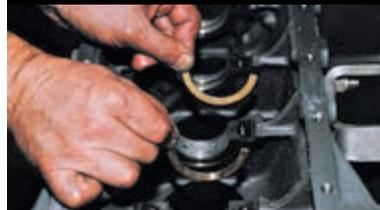
Вынимаем из проточек опоры среднего коренного подшипника упорные полукольца.
