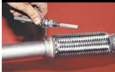
Нарезаем в отверстиях резьбу М5.
