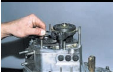
Ключом «на 10» отворачиваем болт крепления вилки пятой передачи.
