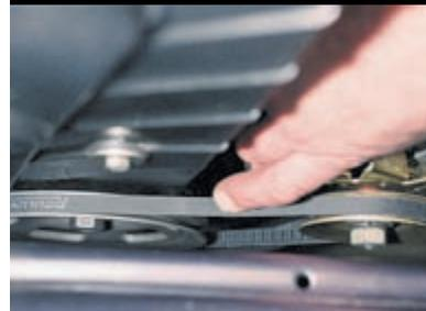
Нормальный прогиб ремня должен быть в пределах 10–15 мм при усилии 98 Н (10 кгс). При необходимости подтягиваем ремень, как описано ниже. Ослабляем затяжку гайки болта крепления генератора к кронштейну.
