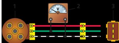
Схема проверки датчика Холла на автомобиле: 1 – датчик-распределитель зажигания; 2 – вольтметр, имеющий предел шкалы не менее 15 В и внутреннее сопротивление не менее 100 кОм; 3 – вид на штатный разъем датчика-распределителя зажигания.
