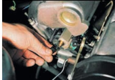
Отворачиваем пробку штуцера на топливной рампе.
