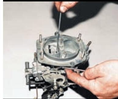
При полностью закрытой воздушной заслонке нажимаем вручную (можно отверткой, палочкой и т.п.) на шток пускового устройства до упора. При этом воздушная заслонка должна быть приоткрыта на пусковой зазор В (см. таблицу).
