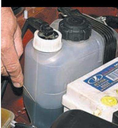
**Уровень жидкости должен быть между метками «MIN» и «MAX», на расширительном бачке.**
