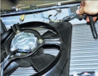
Головкой «на 10» отворачиваем верхнюю гайку крепления электровентилятора к радиатору.
