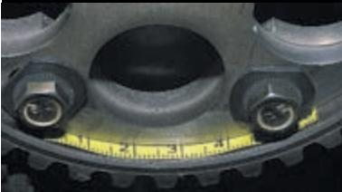
Регулировочную шкалу (отрезок ленты) устанавливаем встык между ступицей и зубчатым венцом шкива привода распределительного вала только на время регулировки фаз.
