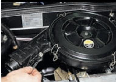
Ключом «на 10» ослабляем болт крепления корпуса терморегулятора к корпусу воздушного фильтра...
