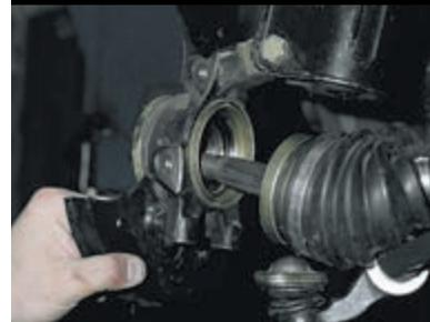
...и выводим наружный шарнир из отверстия подшипника.
