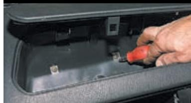
...и два средних самореза внутри верхнего вещевого ящика.
