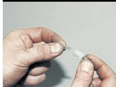
Вынимаем лампу из патрона.
