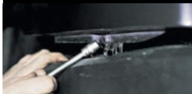
Головкой «на 10» отворачиваем саморез переднего нижнего крепления...
