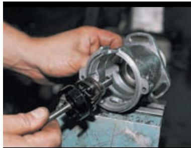
Вынимаем центробежный регулятор.
