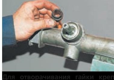
Для отворачивания гайки крепления подшипника шестерни применяем специальный ключ с восьмигранной головкой «на 24» (диаметр отверстия под вал шестерни — не менее 18,5 мм).
