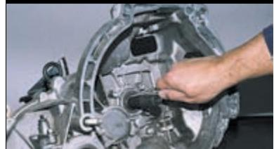
Крючком поддеваем сальник и снимаем его.
