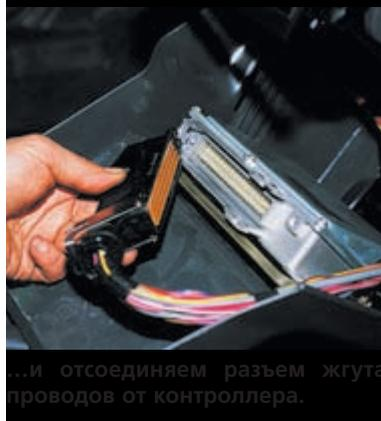
...и отсоединяем разъем жгута проводов от контроллера.
