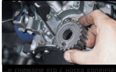
...и снимаем его с носка коленчатого вала.
