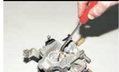
Шлицевой отверткой отворачиваем главные воздушные жиклеры с эмульсионными трубками...
