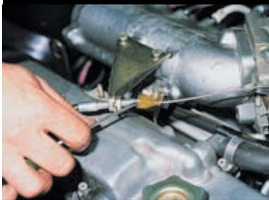
Сдвигаем защитный силиконовый колпачок.
