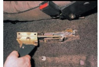
Сдвинув рычаг вперед, снимаем его.
