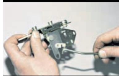
Отстегнув пластмассовый фиксатор, снимаем тягу кнопки выключения замка.
