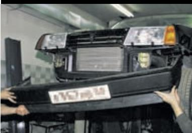
...и снимаем бампер с передних кронштейнов кузова.
