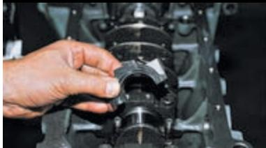
Снимаем крышку шатуна.
