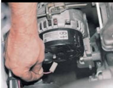
Отсоединяем колодку проводов от вывода «D» генератора.
