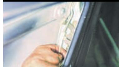
Поддев отверткой, снимаем тягу курка наружной ручки.
