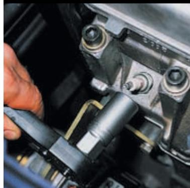
Надеваем на свечу штатный свечной ключ или высокую головку ключа 21».
