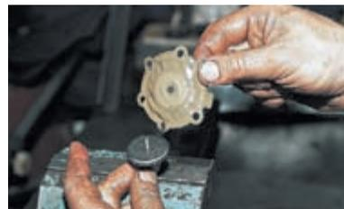
Снимаем предохранительную диафрагму.
