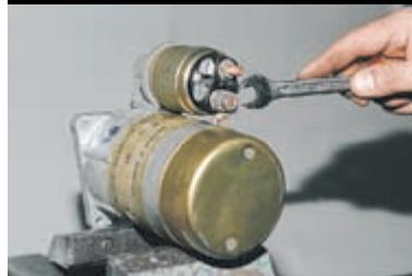
Ключом «на 13» отворачиваем гайку нижнего контактного болта.
