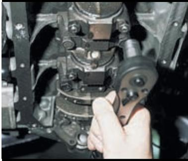
Головкой «на 14» отворачиваем две гайки крепления крышки шатуна...
