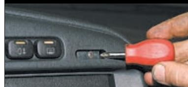
Крестообразной отверткой отворачиваем расположенный под заглушкой саморез.
