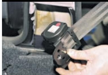
...и снимаем катушку.
