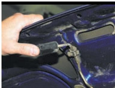
...отводим вверх лапку предохранительного крючка и поднимаем капот.
