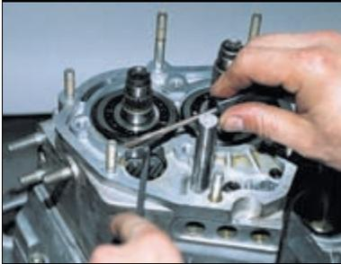
Двумя отвертками разжимаем на подшипнике первичного вала стопорное кольцо...
