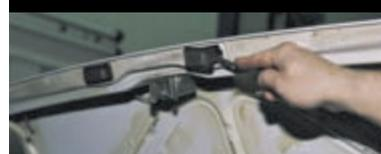
Поддеваем отверткой и снимаем плафоны освещения номерного знака.
