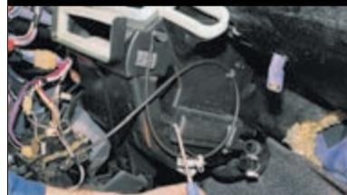
Крестообразной отверткой отворачиваем три самореза крепления радиатора отопителя.
