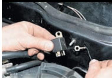
Снимаем «минусовый» провод и реле.
