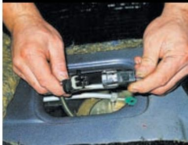
Разъединяем электрический разъем.
