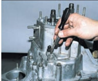
Вставляем в гнездо фиксатора отвертку и, приложив к ней магнит, извлекаем шарик.
