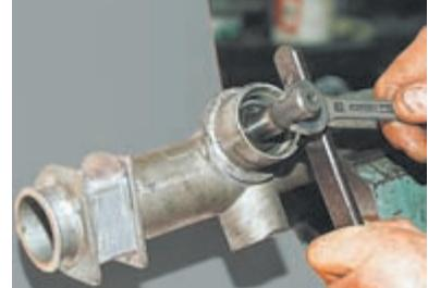
Захватив лыску шестерни ключом «на 14» и опираясь им о монтажную лопатку,
