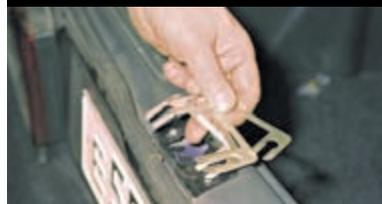
Снимаем регулировочные шайбы фиксатора замка.
