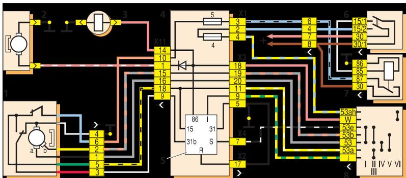
**Схема включения очистителя и омывателя ветрового стекла:** 1 – электродвигатель очистителя; 2 – электродвигатель омывателя; 3 – электромагнитный клапан включения омыва ветрового стекла; 4 – монтажный блок; 5 – реле стеклоочистителя; 6 – выключатель зажигания; 7 – реле зажигания; 8 – переключатель очистителей и омывателя
