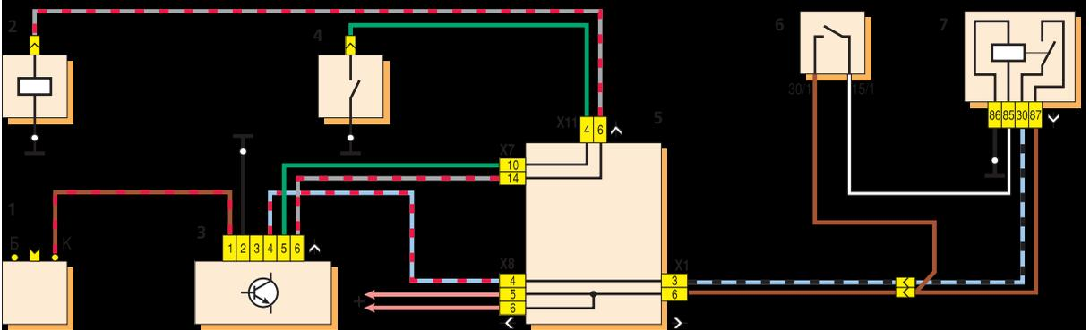
Схема системы управления электромагнитным клапаном карбюратора: 1 – катушка зажигания; 2 – электромагнитный клапан; 3 – блок управления; 4 – концевой выключатель карбюратора; 5 – монтажный блок; 6 – выключатель зажигания; 7 – реле зажигания
