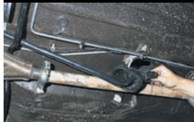
Снизу автомобиля вынимаем тягу привода переключения передач. Сборку и установку привода переключения передач проводим в обратной последовательности. В шаровую опору и во втулки оси перед сборкой закладываем смазку.
