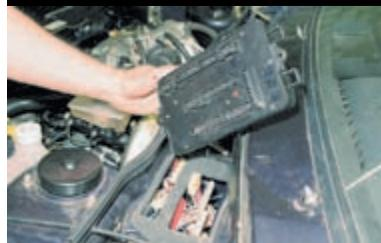
Вынимаем монтажный блок.
