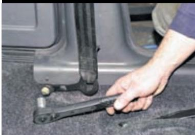
Головкой «на 17» отворачиваем болты нижнего...
