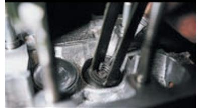
Сжимаем пружины и извлекаем пинцетом сухари.
