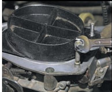
Заворачиваем шпильку в крышку до упора, вращая ее ключом за верхнюю гайку.
