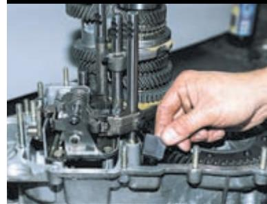
Вынимаем магнит и очищаем его от частиц металла.
