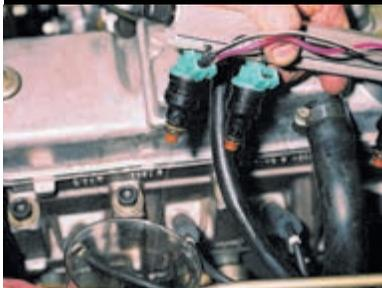
Из распылителя форсунки должны идти струи с характерным факелом распыла.
