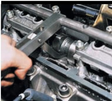
Нажимая вниз рычаг приспособления, утапливаем «клым» толкатель (рис. 1) и устанавливаем между краем толкателя и распределительным валом фиксатор (рис. 2),
