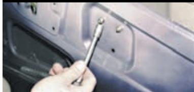
Головкой «на 10» отворачиваем две гайки среднего крепления направляющей механизма стеклоподъемника,
