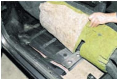
Поднимаем шумоизоляционный материал.
