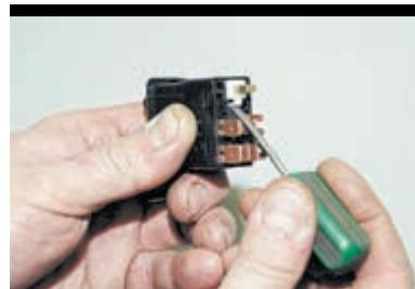
Для замены лампы подсветки переключателя сжимаем отверткой усик патрона...
