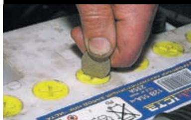
При отсутствии такой отвертки пробку можно вывернуть монетой.
