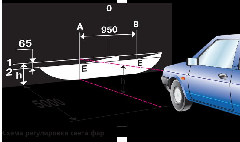
Схема регулировки света фар
