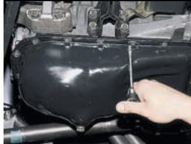
Головкой «на 10» отворачиваем 16 болтов крепления поддона картера.
