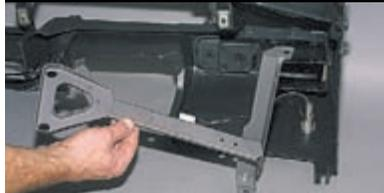
Левую поперечину можно снять только вместе с ее кронштейном.
