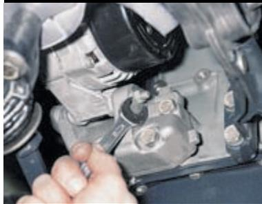
Ключом «на 13» ослабляем затяжку гайки болта крепления генератора к кронштейну.
