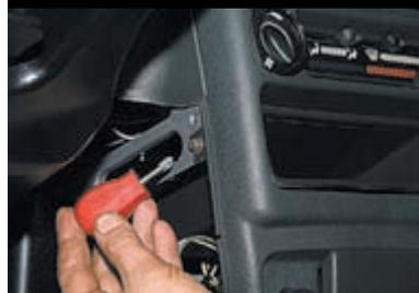
...саморез крепления щитка панели приборов к кронштейну слева...
