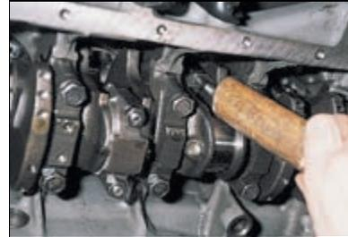
Упираясь деревянной ручкой молотка в разъем нижней головки шатуна, проталкиваем его вверх до выхода поршня из цилиндра...
