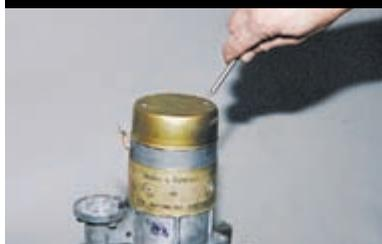
Крестообразной отверткой отворачиваем два винта защитного кожуха.
