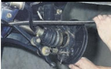
Отжав монтажной лопаткой подвеску вниз, выводим шаровой палец из отверстия рычага.
