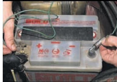
...прижимаем корпус клапана к «минусовому», а оголенный конец провода — к «плюсовому» выводам аккумулятора.
