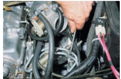
Крестообразной отверткой отворачиваем винт прижимной планки...
