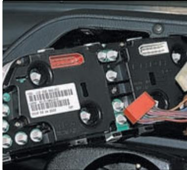
Отсоединяем колодки жгутов проводов: красную — от колодки красного цвета, белую — от белой (рулевое колесо для наглядности снято).
