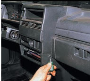
Крестообразной отверткой отворачиваем два самореза крепления консоли панели приборов.
