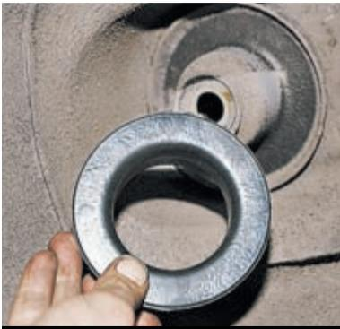
Прокладка пружины обычно прилипает к кузову, откуда ее необходимо извлечь и убедиться в отсутствии деформаций и разрывов.
