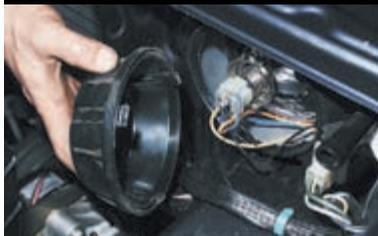
Снимаем колпак фары, повернув его против часовой стрелки.
