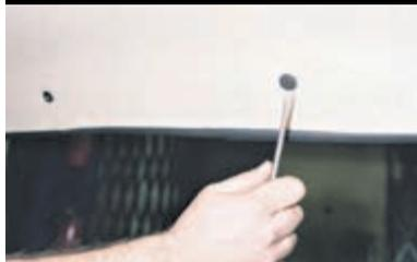
Поддеваем отверткой пистоны обивки потолка...
