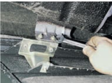
Ключом «на 10» отворачиваем по две гайки с каждой стороны крепления бампера к боковым кронштейнам кузова.
