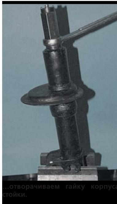
...отворачиваем гайку корпуса стойки.
