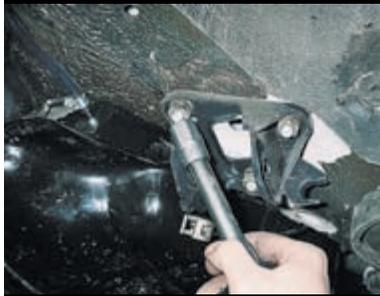
Головкой «на 17» отворачиваем три гайки крепления кронштейна к кузову...
