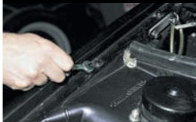
Ключом «на 10» отворачиваем четыре верхних самореза крепления крыла к кузову,
