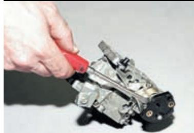
Поддевая отверткой сектор (необходимо приложить значительное усилие), ...снимаем его.
