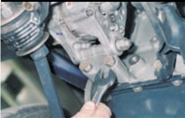
Ключом «на 17» отворачиваем два болта крепления нижнего кронштейна генератора к блоку цилиндров двигателя.
