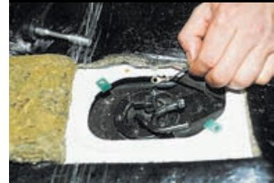
Снимаем со шпильки «массовый» провод датчика уровня.
