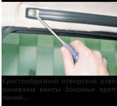
Крестообразной отверткой отворачиваем винты боковых креплений...
