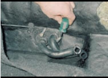
В салоне крестообразной отверткой ослабляем затяжку хомутов крепления шлангов радиатора отопителя к патрубкам крана...
