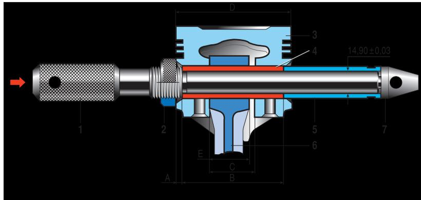
Запрессовка пальца в верхнюю головку шатуна: 1 — оправка; 2 — регулировочная гайка; 3 — поршень; 4 — поршневой палец; 5 — направляющая втулка; 6 — шатун; 7 — винт
