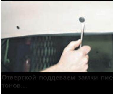
Отверткой поддеваем замки пистонов...
