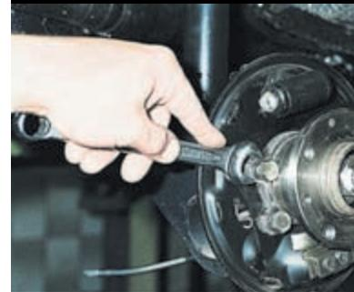
Ключом «на 17» отворачиваем четыре болта крепления оси ступицы к балке задней подвески.
