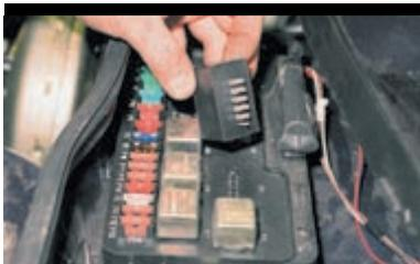
Снимаем реле контроля исправности ламп.
