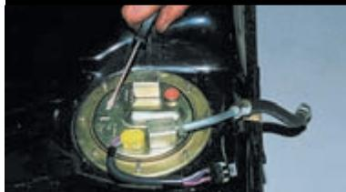
Устанавливаем узел бензонасоса в бак так, чтобы стрелка на фланце указывала на заднюю часть автомобиля.
