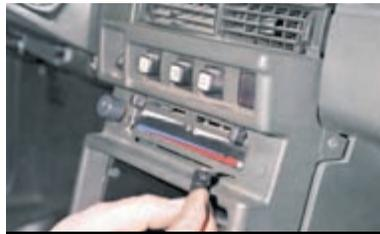
Снимаем рукоятки с рычагов управления отопителем.
