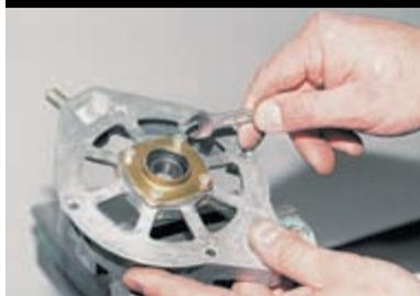
Для замены подшипника ключом «на 8» с наружной стороны крышки отворачиваем четыре гайки.
