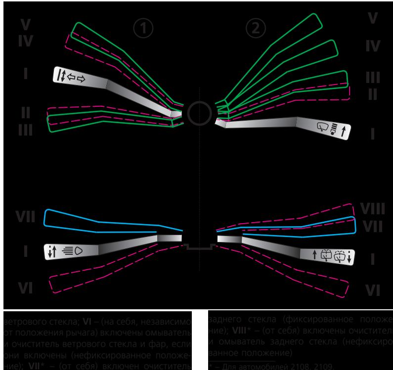
ветрового стекла; VI – (на себя, независимо от положения рычага) включены омыватель и очиститель ветрового стекла и фар, если они включены (нефиксированное положение); VII\* – (от себя) включен очиститель
