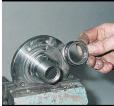
Снимаем кольцо и при необходимости надфилем зачищаем забоины на ступице.
