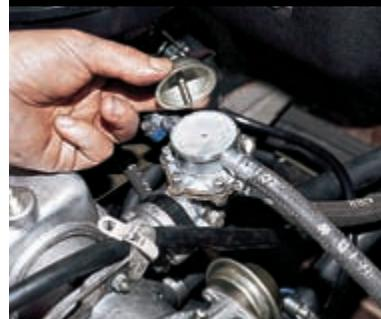
Снимаем крышку насоса...
