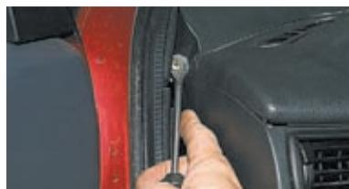
Крестообразной отверткой отворачиваем саморез левого верхнего...
