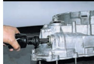
Вынимаем шток выбора передач. Заменить шарнир штока выбора передач можно на коробке передач, установленной на автомобиле. Для наглядности проводим эту операцию на снятом штоке.
