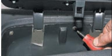
...крестообразной отверткой отворачиваем два самореза (верхних) внутри верхнего вещевого ящика...
