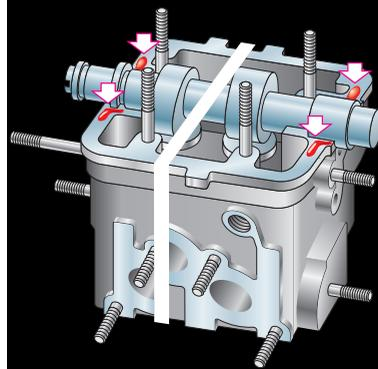
Рис. 2. Нанесение герметика на поверхность головки блока цилиндров
