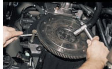
Головкой «на 17» отворачиваем шесть болтов крепления маховика. Коленчатый вал от поворота удерживаем отверткой, вставленной в зубья маховика и опирающейся на болт, ввернутый в отверстие блока цилиндров.
