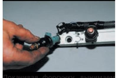
Покачивая форсунку, вынимаем ее из рамп.
