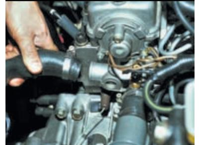
...снимаем его с выпускного патрубка головки блока цилиндров. Аналогично отсоединяем отводящий шланг радиатора от термостата. Отклоняем радиатор к двигателю...
