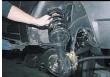
Отвернув гайки крепления верхней опоры, снимаем амортизаторную стойку.
