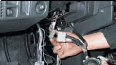
Отсоединяем электрический разъем.
