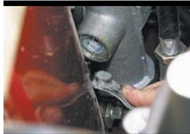
Специальным ключом с восьмигранной головкой «на 17» заворачиваем гайку упора рейки до полного исчезновения люфта. Затем отпускаем гайку приблизительно на половину грани ключа.
