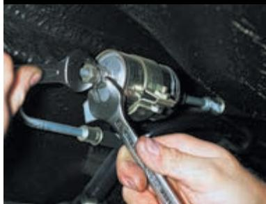
Удерживая фильтр ключом «на 19», ключом «на 17» отворачиваем штуцер, постепенно стравливая давление топлива. Сливаем бензин в подставленную емкость.
