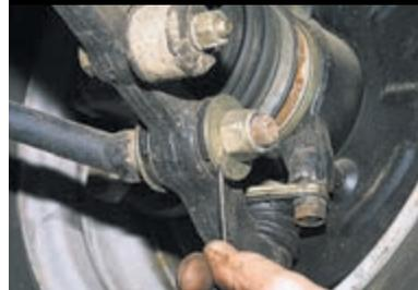
На передний конец растяжки устанавливаем такую же шайбу, как на заднем ее конце. Затягиваем гайку на переднем конце растяжки моментом 160–176 Н·м, опустив автомобиль на колеса.
