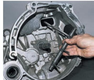
Приподнимаем вилку и выводим ее из картера сцепления. Сжав концы пружинного фиксатора, снимаем его с вилки. При сильном износе лапок вилки или повреждении рычага заменяем его.
