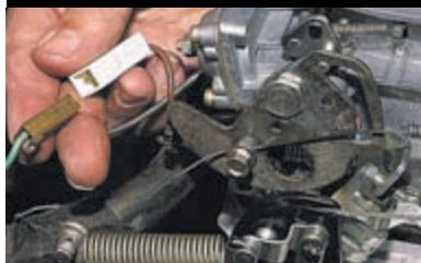
...разъединяем колодку провода наконечника винта «количества». Замыкаем на «массу» наконечник провода, соединенного с блоком управления. Если после повышения частоты вращения коленчатого вала выше 2100 мин<sup>-1</sup> напряжение падает до 0,5 В и ниже,
