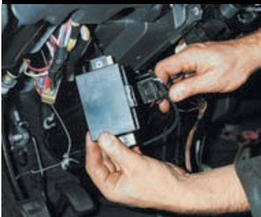
...и отсоединяем разъем блока. Устанавливаем блок управления и индикатор в обратной последовательности.
