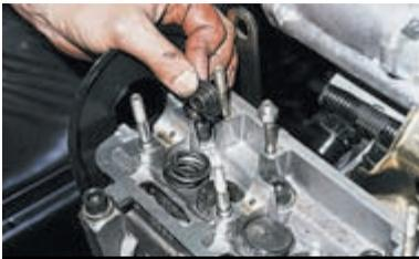
Вынимаем тарелку пружин...
