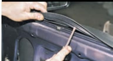
Поддев отверткой, снимаем с двери внутренний уплотнитель стекла.
