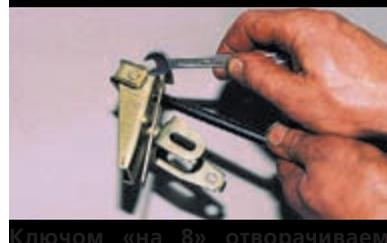
Ключом «на 8» отворачиваем болт крепления фиксатора упругого рычага.
