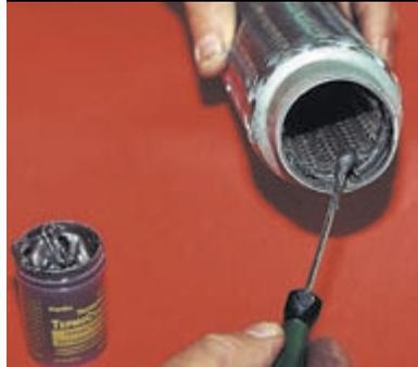
...и внутреннюю поверхность втулки металлокомпенсатора.
