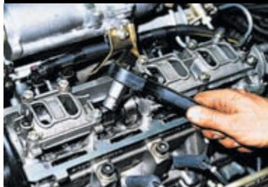
Головкой «на 13» равномерно в несколько приемов (до снятия давления пружин клапанов) отворачиваем десять гаек крепления корпусов подшипников распределительного вала.
