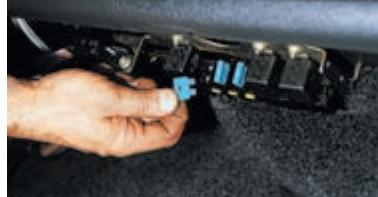
Снимаем предохранители системы управления двигателем.
