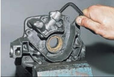
Зажимаем насос в тиски с накладками из мягкого металла и шестигранником «на 8» отворачиваем пробку редукционного клапана (уплотняется алюминиевым кольцом).
