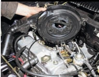
Ослабив посадку гофрированного шланга заборника подогретого воздуха на патрубке корпуса воздушного фильтра, снимаем корпус с резиновой прокладкой.
