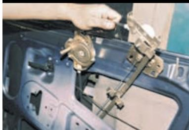
Вынимаем механизм стеклоподъемника через окно в панели двери.
