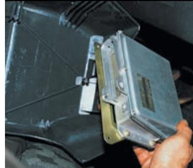
...и снимаем контроллер. Устанавливаем контроллер в обратной последовательности.
