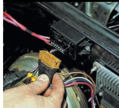
Отсоединяем разъем блока управления ЭПХХ.
