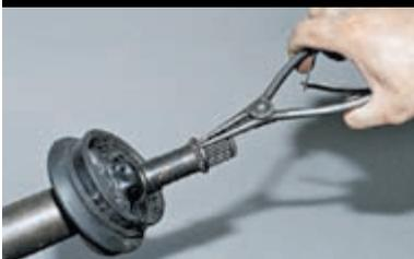
Разжимаем его щипцами и снимаем.
