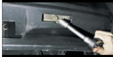
Головкой «на 17» отворачиваем снизу два болта переднего крепления бампера. Вынимаем болты.
