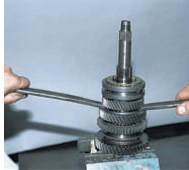
Поддев монтажными лопатками ведомую шестерню третьей передачи,
