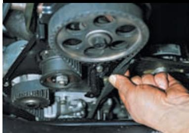
При нормальном натяжении ремня его передняя ветвь должна закручиваться на 90° большим и указательным пальцами руки с усилием 15–20 Н (1,5–2,0 кгс).
