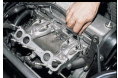
Ключом «на 13» отворачиваем две гайки крепления рыма.
