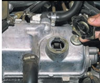
...поворачиваем против часовой стрелки пробку маслозаливной горловины и снимаем ее.
