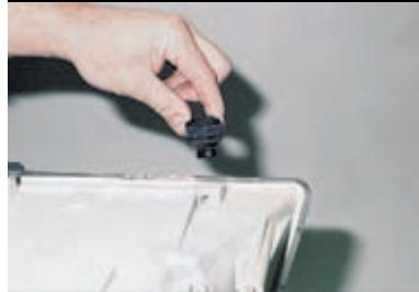
Снимаем ограничитель хода щетки фарочистителя.
