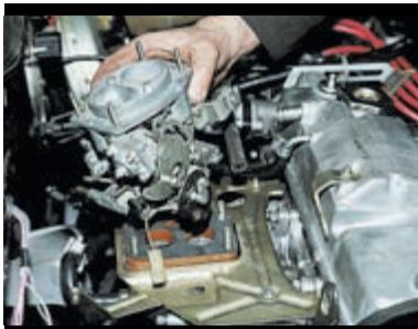
...и снимаем карбюратор с двигателя.
