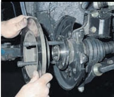
Звворачиваем болты в отверстия ступицы на глубину, равную ее толщине.
