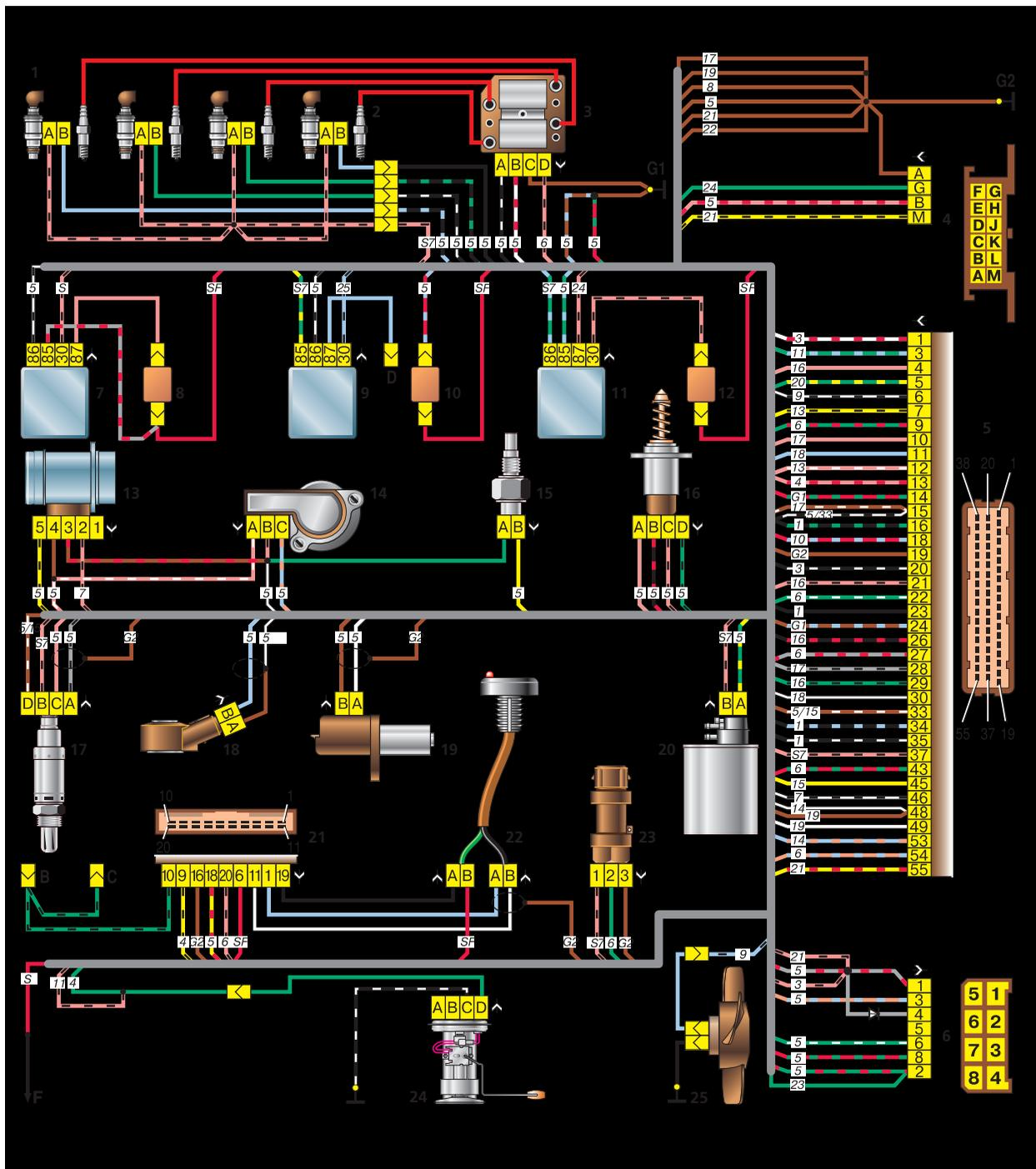
**Схема соединений системы управления двигателем ВАЗ-2111 с распределенным впрыском топлива под нормы токсичности ЕВРО-2 (контроллеры М1.5.4N, «Январь 5.1») автомобилей ВАЗ-21083, -21093, -21099:**
