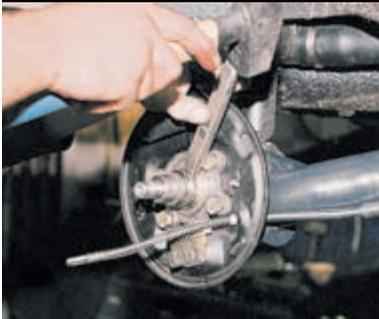
Зубилом немного сдвигаем кольцо с оси.
