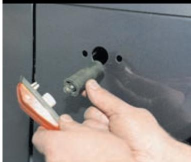
Потянув, отсоединяем патрон с лампой.
