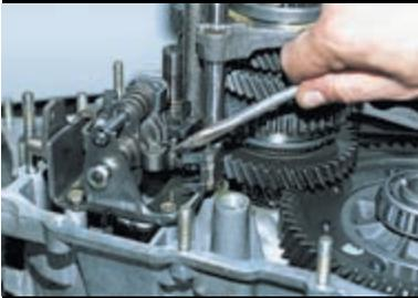
Отверткой выводим шток из механизма выбора передач.
