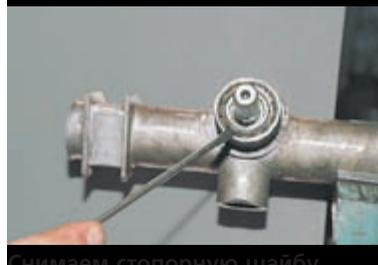
Снимаем стопорную шайбу.
