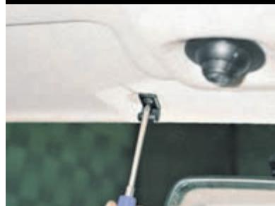
Отворачиваем саморез крепления держателя и снимаем его.
