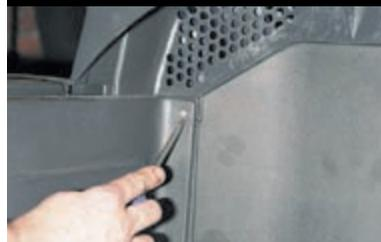
Крестообразной отверткой отворачиваем верхний...
