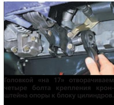
Головкой «на 17» отворачиваем четыре болта крепления кронштейна опоры к блоку цилиндров.
