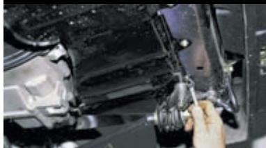
Отворачиваем четыре самореза крепления брызговика к нижней поперечине рамки радиатора.
