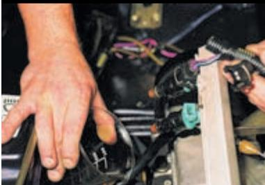
Расположив под форсунками мерные стаканы, проворачиваем двигатель стартером.
