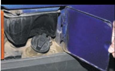
Для доступа к пробке топливного бака открываем крышку лючка.
