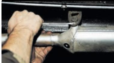
Отсоединяем две подушки подвески дополнительного глушителя...
