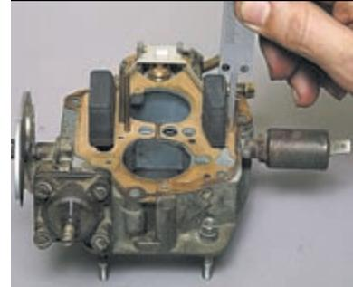
Линейкой-глубиномером проверяем расстояние от прокладки крышки до верхней кромки каждого поплавка.
