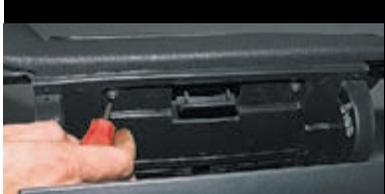
...крестообразной отверткой отворачиваем два самореза в верхней его части...
