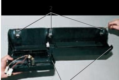
Пластиковые усики 1 и пружинные скобы 2 крепления щитка к накладке панели приборов.
