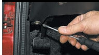
...и саморез левого нижнего крепления панели приборов.
