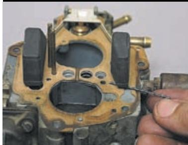
Хвостовиком сверла или отрезком проволоки диаметром 1 мм проверяем зазор между выступом каждого поплавка и прокладкой крышки.
