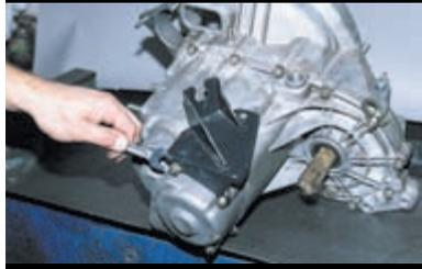
Ключом «на 13» отворачиваем шесть гаек крепления задней крышки картера.
