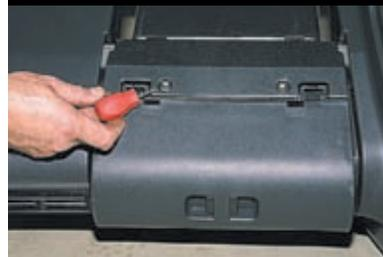
...отворачиваем два самореза крепления облицовки нижнего вещевого ящика...
