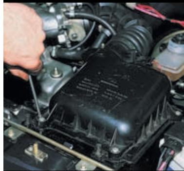
...крестообразной отверткой отворачиваем четыре винта крепления крышки корпуса.
