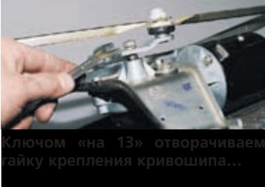
Ключом «на 13» отворачиваем гайку крепления кривошипа...
