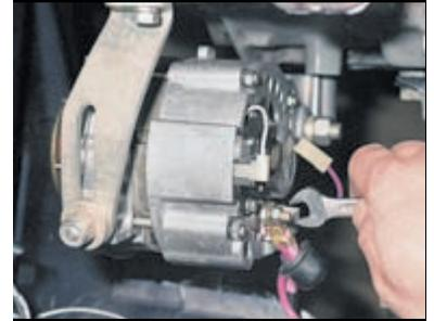
Ключом «на 10» отворачиваем гайку крепления проводов к выводу «30» генератора...
