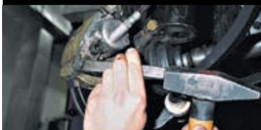
Отгибаем края стопорной пластины нижнего болта крепления колесного цилиндра к направляющему пальцу.
