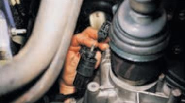
...и снимаем его. Устанавливаем датчик в обратной последовательности. Момент затяжки 8–10 Н·м.
