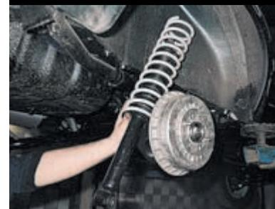
Вынимаем амортизатор вместе с пружиной.
