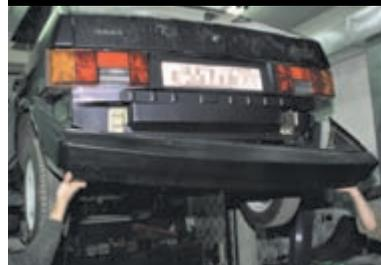
Выводим с обеих сторон шпильки боковых кронштейнов бампера из отверстий кузова и снимаем бампер.
