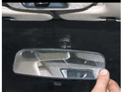
Положение внутрисалонного зеркала регулируем поворотом корпуса зеркала на шарнире.
