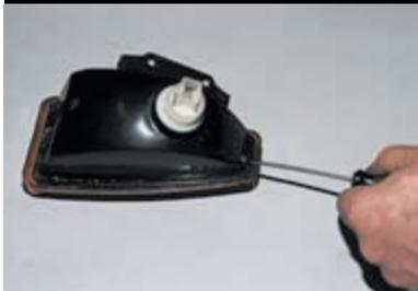
...отворачиваем шлицевой отверткой два винта...
