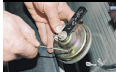
Винт регулировки звука.
