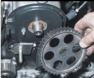
Снимаем шкив распределительного вала.
