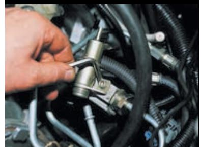
Шестигранником «на 5» отворачиваем два винта крепления регулятора к топливной рампе.
