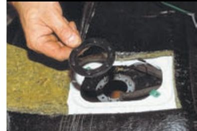
Снимаем прокладку бензоприемника.
