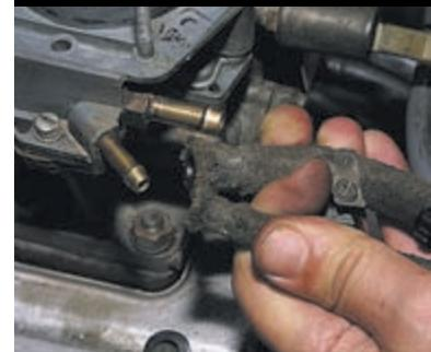
...снимаем со штуцеров карбюратора топливоподводящий и топливоотводящий шланги.
