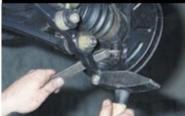
Создаем натяг монтажной лопаткой и наносим удары молотком по рычагу до момента распрессовки пальца.
