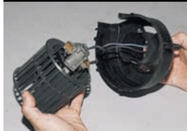
...и извлекаем электродвигатель в сборе с колесом.
