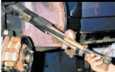
...и вынимаем его через отверстие в левом брызговике.
