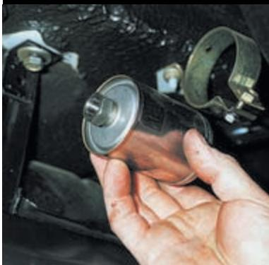
...и вынимаем топливный фильтр.
