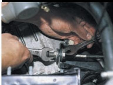
...двумя ключами на «17» ослабляем гайки крепления нижнего наконечника оболочки троса к кронштейну.
