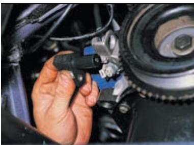
Вынимаем датчик из кронштейна крышки масляного насоса.
