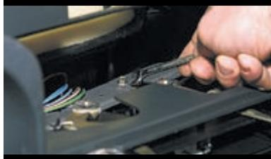
Ключом «на 8» отворачиваем два самореза верхнего крепления кронштейна (к правой поперечине панели приборов): один справа...
