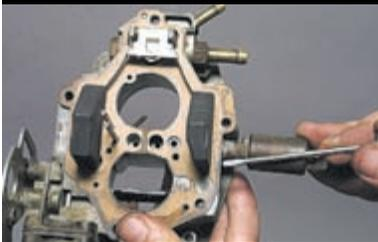
Положение поплавков удобно проверить по отпечатку привалочной плоскости корпуса карбюратора на прокладке крышки.
