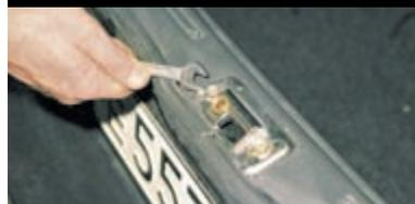
Ключом «на 10» отворачиваем два болта крепления фиксатора...
