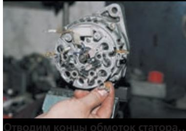
Отводим концы обмоток статора...
