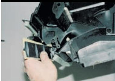
Выводим рычаг заслонки обогрева ветрового стекла из отверстия наружного рычага привода и снимаем заслонку.
