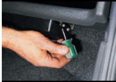
Крестообразной отверткой отворачиваем два самореза крепления пластиковой крышки блока с правой стороны и один с левой.
