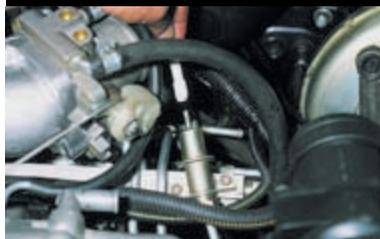
Отсоединяем вакуумный шланг от регулятора давления топлива.
