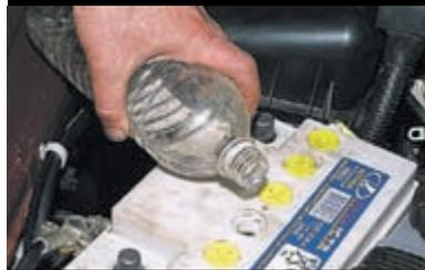
При понижении уровня электролита доливаем только дистиллированную воду.
