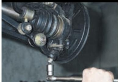
Головкой «на 19» отворачиваем гайку крепления шаровой опоры к рычагу.
