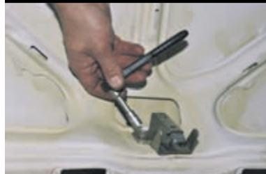
Головкой «на 10» отворачиваем две гайки крепления замка.
