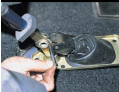
Вынимаем болт и выводим рычаг из проушины тяги.
