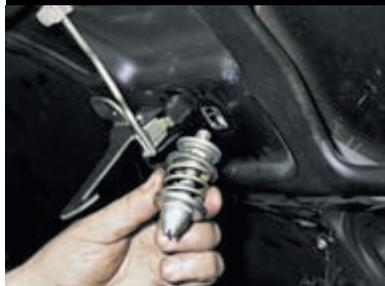
...и снимаем фиксатор капота. Для замены пружины страховочного крючка...
