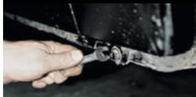
...и один саморез нижнего заднего крепления.
