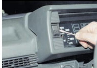
Поддев отверткой, вынимаем переключатель наружного освещения.
