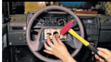
Если рулевое колесо сидит очень плотно, помощник тянет рулевое колесо на себя, а по торцу рулевого вала наносим удары через выколотку из мягкого металла.
