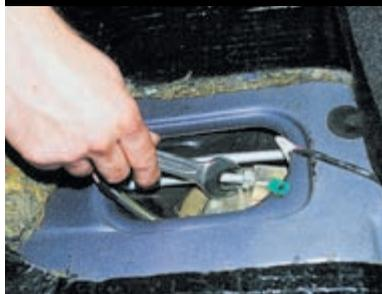
Ключом «на 17» отворачиваем штуцер трубки подачи топлива...
