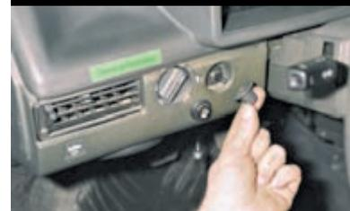
Снимаем ручку выключателя освещения приборов.
