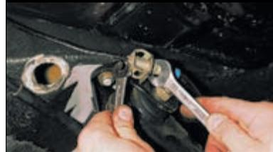
Удерживая ключом «на 15» наконечник гибкого шланга, ключом «на 10» отворачиваем штуцер тормозной трубки.
