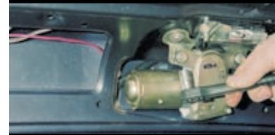
Головкой «на 10» отворачиваем два болта крепления моторедуктора...
