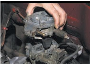
Аккуратно, стараясь не повредить поплавки и прокладку, снимаем крышку.
