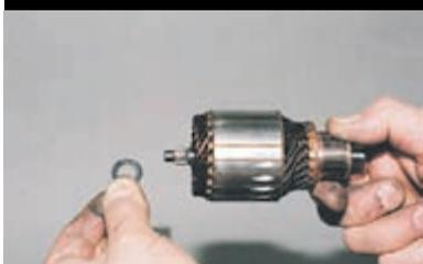
Снимаем с якоря шайбу.
