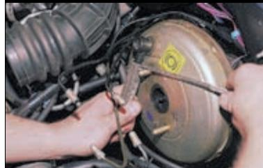
Снимаем шланг со штуцера обратного клапана.
