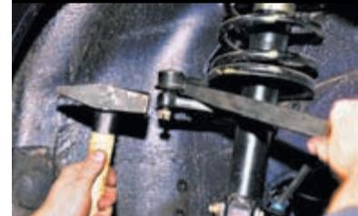
При отсутствии съемника гайку отворачиваем не до конца, вставляем монтажную лопатку в распор между рулевой тягой и рычагом стойки и молотком наносим удары по торцу рычага стойки до выпрессовки пальца из рычага, после чего окончательно отворачиваем гайку пальца.
