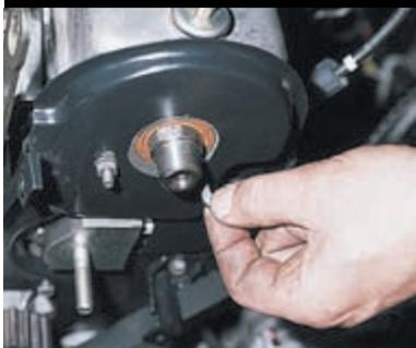
Чтобы не потерять шпонку шкива, извлекаем ее из паза распределительного вала.
