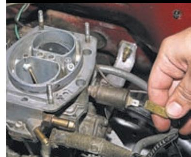
Снимаем наконечник провода с вывода электромагнитного клапана ЭПХХ.
