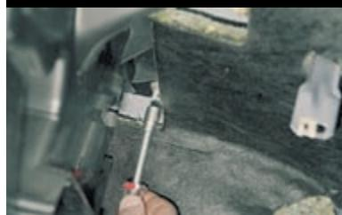
Головкой «на 10» отворачиваем четыре гайки крепления кожуха отопителя к кузову.
