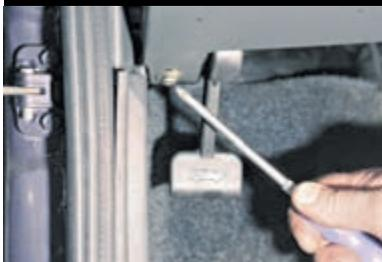
Отворачиваем по одному саморезу нижнего крепления панели с левой...
