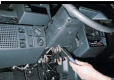
...и саморез, ввернутый в кронштейн рулевой колонки.
