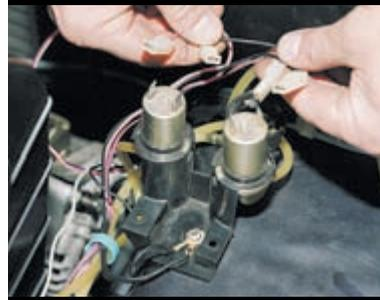
Отсоединяем провода от клапанов.
