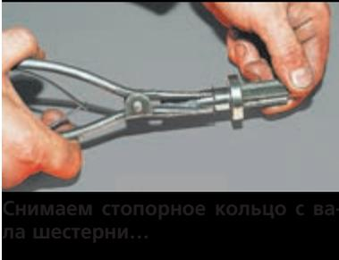
Снимаем стопорное кольцо с вала шестерни...
