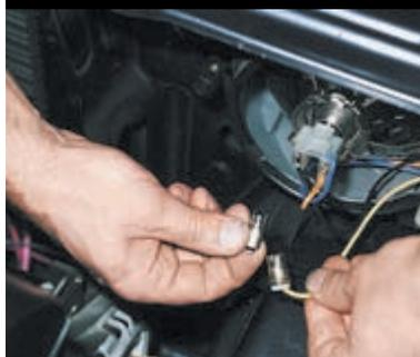
Нажав и повернув против часовой стрелки, снимаем лампу.
