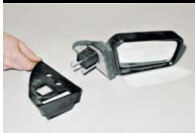
Снимаем наружную прокладку зеркала.
