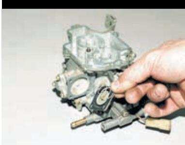
...снимаем ее вместе с возвратной пружиной.
