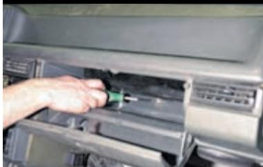
Открыв вещевого ящик, отворачиваем еще один саморез крепления панели.
