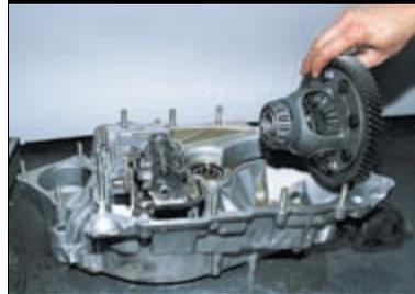
Вынимаем дифференциал в сборе.
