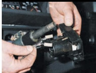
...и, отсоединив провода звукового сигнала, снимаем соединитель.
