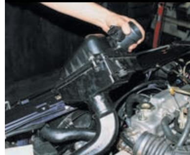
Снимаем корпус фильтра с датчиком массового расхода воздуха, заборником холодного воздуха и кронштейнами передних опор.
