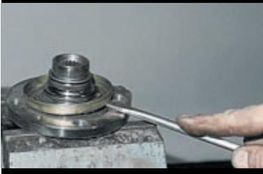
...поддеваем отверткой и снимаем грязезащитное кольцо.
