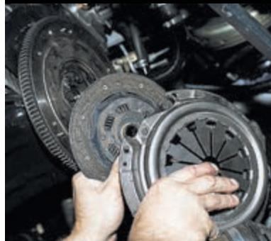
Снимаем ведомый диск и кожух сцепления.
