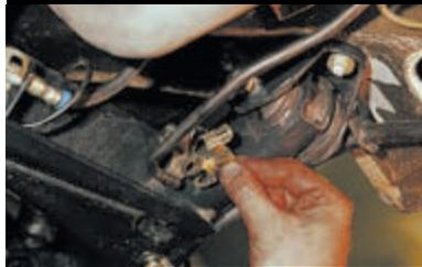
Выводим конец рычага из отверстия серьги и снимаем скобу.
