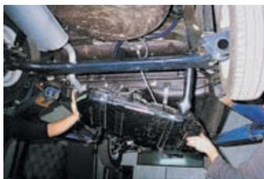
Отцепляем ленты и снимаем топливный бак.
