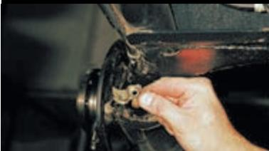
Снимаем скобу крепления троса.
