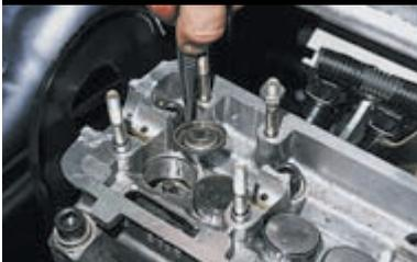
Вынимаем опорную шайбу пружин.
