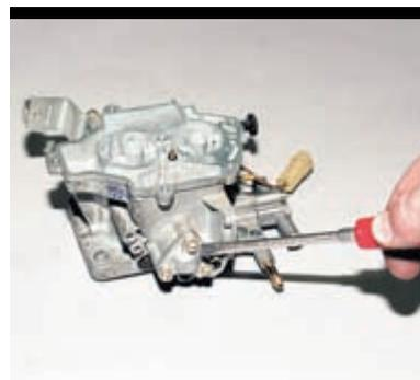
Шлицевой отверткой отворачиваем три винта крепления крышки экономайзера мощностных режимов...
