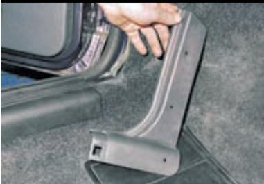
Снимаем передние накладки порогов.
