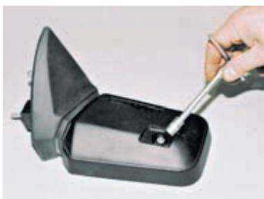
Головкой «на 10» отворачиваем гайку крепления.
