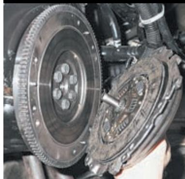
Устанавливая сцепление, ориентируем ведомый диск выступающей частью в сторону кожуха и вставляем центрирующую оправку через шлицевое отверстие диска.
