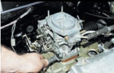
Ключом «на 13» отворачиваем четыре гайки крепления...
