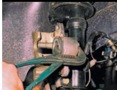
Раздвижными пассатижами или газовым ключом вдавливаем поршень в цилиндр.
