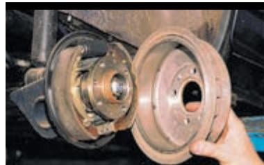
Снимаем тормозной барабан.
