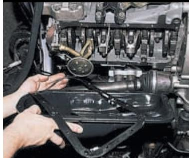
**Снимаем поддон и прокладку.**
