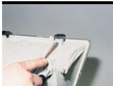
...шлицевой отверткой отворачиваем два винта крепления ограничителей хода фарочистителя.
