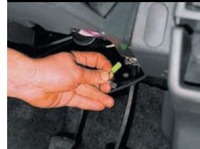
Выводим из-под панели приборов провода индикатора состояния системы и отсоединяем два разъема (зеленого и черного цвета).
