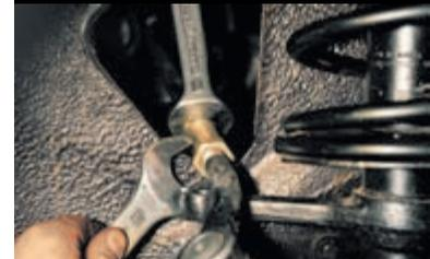
Удерживая ключом «на 24» муфту, отворачиваем гайку по часовой стрелке ключом «на 27» (резьба на наружном наконечнике левая).
