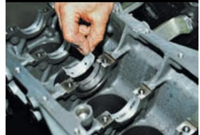
В первую, вторую, четвертую и пятую опоры блока цилиндров устанавливаем вкладыши с проточками, а в третью постель — вкладыш без проточки (такой же, как и в крышке).
