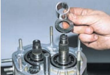
...и спрессовываем втулку подшипника шестерни и упорную шайбу.
