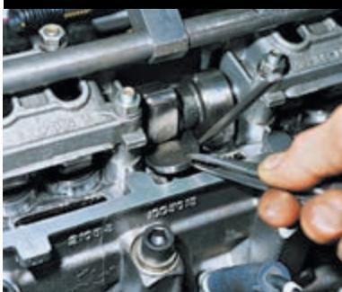
Пинцетом через прорезь в толкателе поддеваем и извлекаем регулировочную шайбу.
