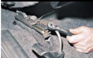
...головкой «на 8» отворачиваем два болта передних креплений салазок...
