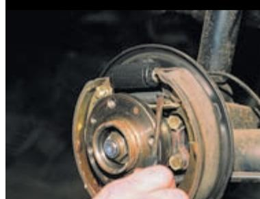
Отверткой отсоединяем конец верхней стяжной пружины от колодки...
