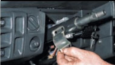
С рулевой колонки снимаем скобу...
