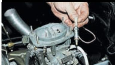
Клапан с подсоединенным проводом прижимаем к корпусу карбюратора и включаем зажигание — игла должна со щелчком втянуться в корпус клапана.
