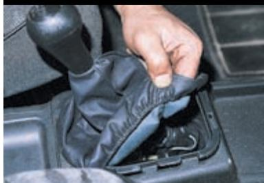
В салоне снимаем чехол рычага переключения передач с кожуха тоннеля пола и сдвигаем вверх по рукоятке.
