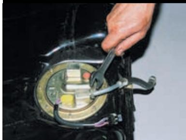
Ключом «на 17» отворачиваем штуцер сливного трубопровода.
