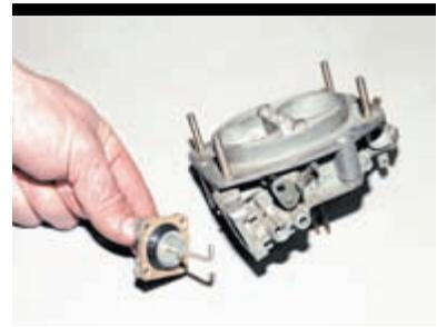
...снимаем диафрагму с крышкой и тягой.
