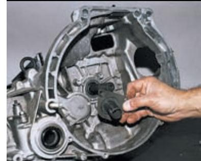
...и снимаем ее. Устанавливаем детали в обратной последовательности, при этом выступ на пластмассовой втулке должен войти в паз, выполненный на картере сцепления.
