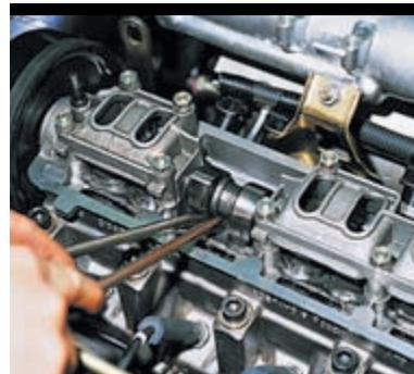
Мощной отверткой, опираясь на кулачок, отжимаем толкатель вниз. Вставив ребро другой отвертки (с лезвием шириной не менее 10 мм) между краем толкателя и распределительным валом, фиксируем толкатель.
