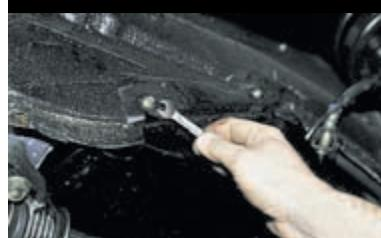
Ключом или головкой «на 8» отворачиваем четыре самореза крепления брызговика двигателя к левому и правому брызговикам крыла.
