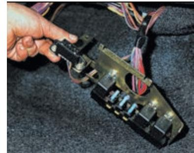
Снимаем кронштейн блока.
