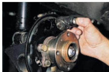
...и снимаем цилиндр.
