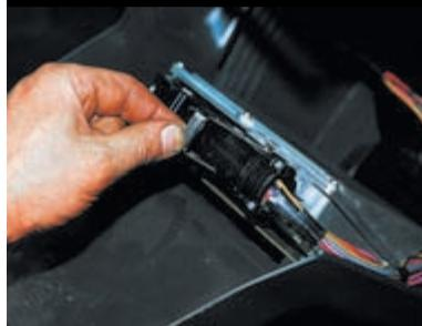
Отстегиваем запорную скобу разъема контроллера...
