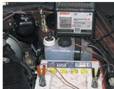
Зажим плюсового провода зарядного устройства подсоединяем к положительному выводу батареи, зажим отрицательного провода — к отрицательному выводу.
