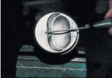
Классы диаметров поршня и отверстия под поршневой палец, а также группа по массе поршня маркируются на его днище.
