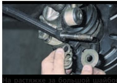
На растяжке за большой шайбой расположены шайбы регулировки угла продольного наклона оси поворота (в нашем случае их три).
