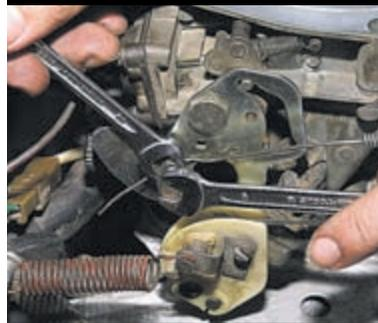
Двумя ключами «на 8» ослабляем крепление тяги привода к рычагу управления воздушной заслонкой.
