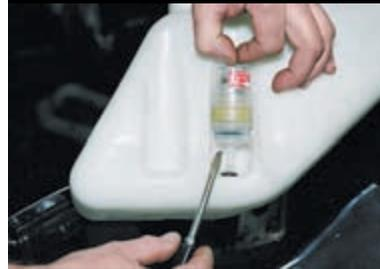
Поддев отверткой электродвигатель, отделяем его от бачка.
