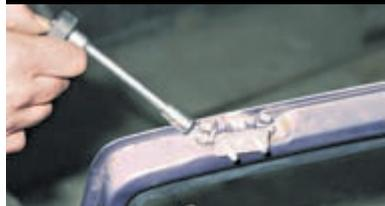
Головкой «на 10» отворачиваем два болта крепления петли.
