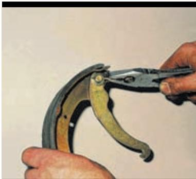
Расшплинтовываем ось рычага ручного привода колодок.
