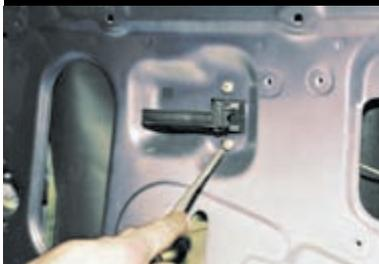
Крестообразной отверткой отворачиваем два винта крепления внутренней ручки двери.
