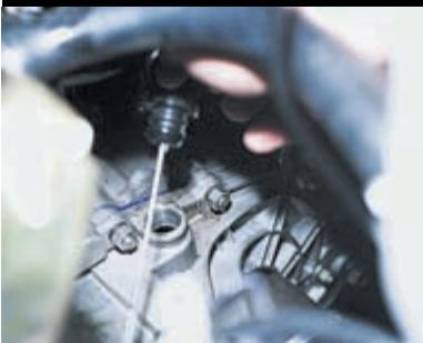
Перед заливкой масла вынимаем указатель уровня из картера коробки передач модели 2109.
