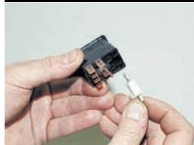
...и вынимаем патрон с лампой из переключателя.
