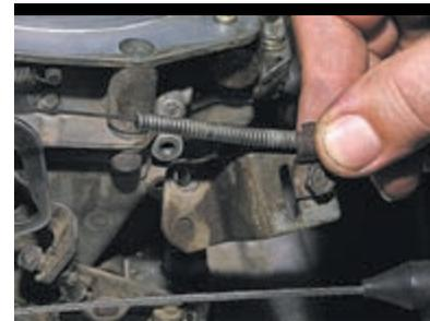
...снимаем кронштейн крепления оболочки тяги вместе с тягой привода.
