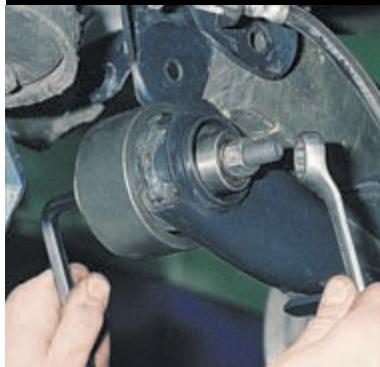
Съемником подшипников ступиц или подходящими отрезками труб выпрессовываем сайлент-блок в сторону порога кузова.
