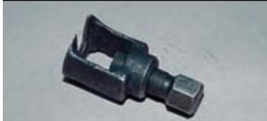
Съемник наконечников рулевых тяг
