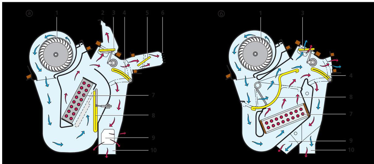
**Схема работы отопителя:** а – ВА3-2108; б – ВА3-2108-01; 1 – рабочее колесо вентилятора; 2 – воздуховод обогрева ветрового стекла; 3 – заслонка обогрева ветрового стекла; 4 – заслонка обогрева ног; 5 – заслонка центрального сопла; 6 – центральное сопло; 7 – радиатор; 8 – заслонка управления отопителем; 9 – окно обогрева ног водителя; 10 – воздуховод внутренней вентиляции
