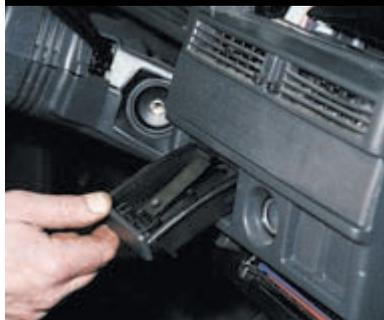
Вынимаем нагревательный элемент прикуривателя и пепельницу из гнезда.
