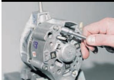
Головкой «на 10» отворачиваем четыре гайки стяжных болтов.
