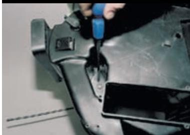
Крестообразной отверткой отворачиваем саморез крепления кожухов, находящийся с правой стороны в углублении.
