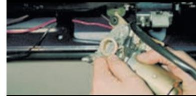
Снимаем упорную шайбу.
