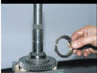
Снимаем блокирующее кольцо синхронизатора I передачи.
