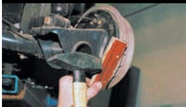
Поворачивая тормозной барабан, наносим удары по его торцу через брусок...
