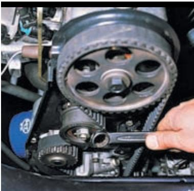
Ключом «на 17» ослабляем гайку крепления натяжного ролика. Поворачиваем натяжной ролик в такое положение, при котором ремень будет максимально ослаблен.
