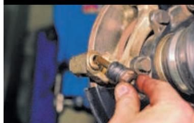
...и вынимаем направляющий палец тормозного механизма.
