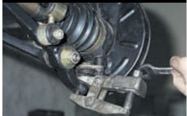
Съемником выпрессовываем палец шаровой опоры из рычага.
