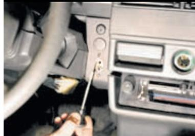
В салоне вынимаем рукоятку привода воздушной заслонки и отсоединяем от нее тягу.
