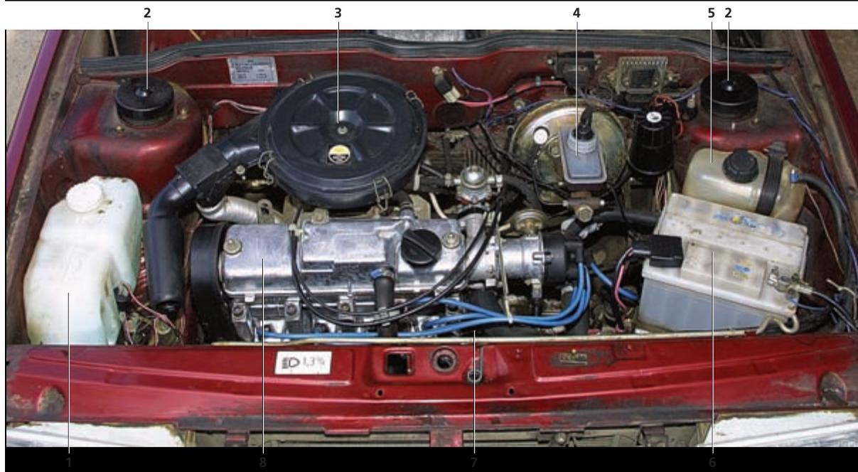
Подкапотное пространство автомобиля ВАЗ-2109 с карбюраторным двигателем: 1 – бачок омывателя ветрового стекла и стекла двери задка; 2 – верхняя опора стойки; 3 – корпус воздушного фильтра; 4 – бачок гидропривода тормозной системы; 5 – расширительный бачок системы охлаждения; 6 – аккумуляторная батарея; 7 – коробка передач (не видна); 8 – двигатель
