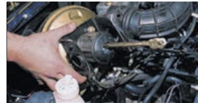
Снимаем вакуумный усилитель вместе с кронштейном.
