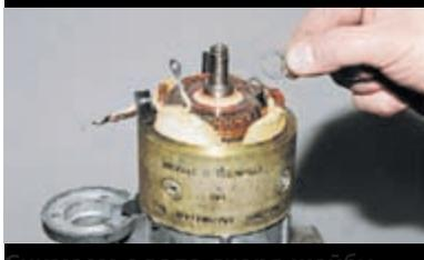
Снимаем с вала якоря шайбу.
