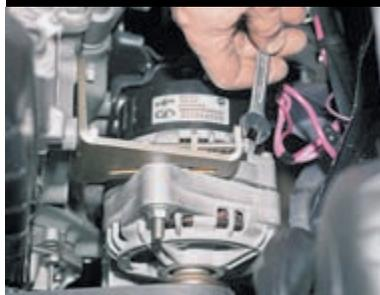
Вращая ключом «на 10» регулировочный болт по часовой стрелке, натягиваем ремень привода генератора.
