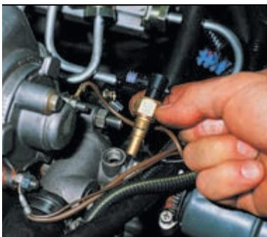
Снимаем датчик вместе с уплотнительным кольцом.
