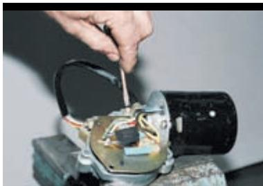
Отвернув шлицевой отверткой винт крепления хомута проводов,
