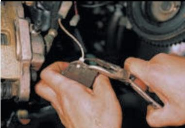
...вставляем наконечник датчика в отверстие внутренней колодки. Устанавливаем колодки в обратной последовательности. Законтриваем болты крепления колесного цилиндра к направляющему пальцу.
