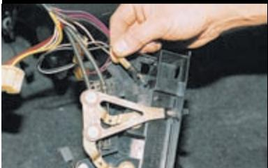
Вынимаем патрон с лампой подсветки пульта управления отопителем.
