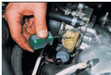
Крестообразной отверткой отворачиваем два винта крепления датчика к дроссельному узлу...
