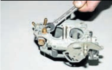
Ключом «на 11» выворачиваем корпус игольчатого клапана.
