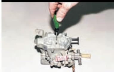
Шлицевой отверткой с лезвием шириной 4 мм (проходящей в эмульсионный колодец) отворачиваем главные топливные жиклеры.
