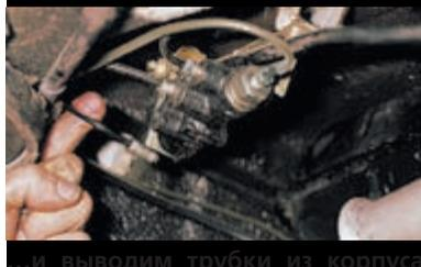
...и выводим трубки из корпуса регулятора.
