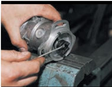
Поддев отверткой, снимаем пружину.
