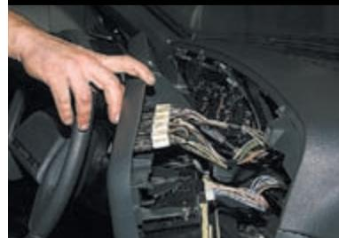
Отводим щиток панели приборов назад (в сторону рулевого колеса)...
