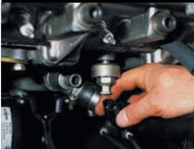
Чтобы снять одноконтатный датчик детонации, отсоединяем электрический разъем при выключенном зажигании.
