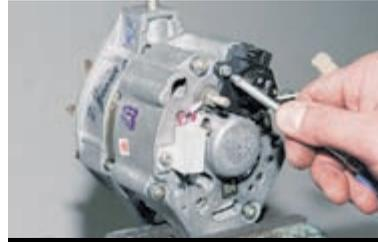
Крестообразной отверткой отворачиваем два винта крепления регулятора напряжения и щеткодержателя.
