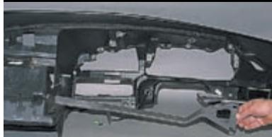
...выводим правую поперечину из панели приборов...
