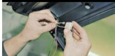
Пометив провода, вынимаем их из колодки.
