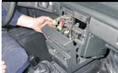
Отводим назад накладку консоли и отсоединяем разъемы проводов от выключателей: обогрева заднего стекла, задних противотуманных фонарей, аварийной сигнализации, наружного освещения.
