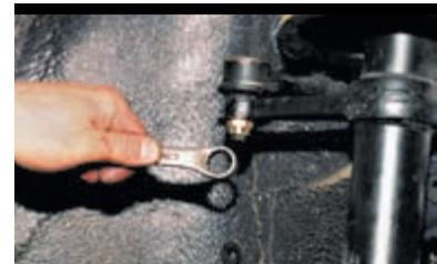
...и ключом «на 19» отворачиваем гайку крепления наконечника к рычагу стойки.
