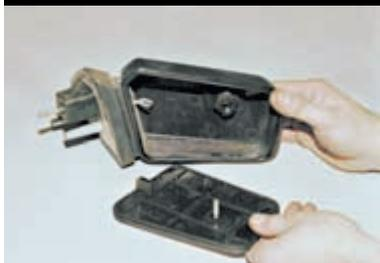
...и вынимаем зеркальный элемент.
