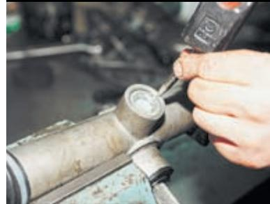
Отрегулировав зазор рейки, закерниваем гайку упора, обмяв резьбу картера.
