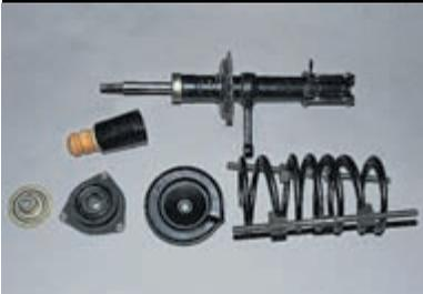
...верхнюю опору, верхнюю опорную чашку, пружину со стяжками, буфер хода сжатия и защитный чехол.
