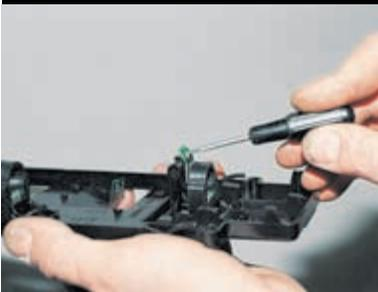
При необходимости замены контактных дорожек поддеваем отверткой...
