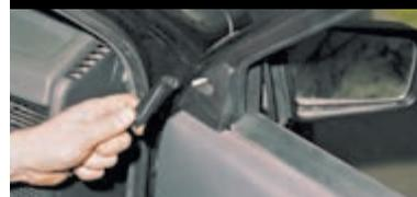
Снимаем ручку управления зеркалом.
