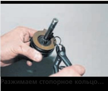
Разжимаем стопорное кольцо...
