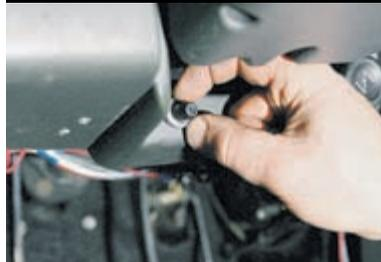
Отворачиваем гайку крепления рукоятки установки на ноль суточного счетчика спидометра.
