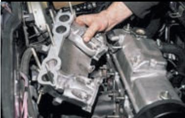
...снимаем впускной коллектор.
