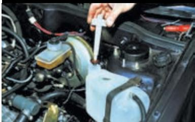
...отворачиваем и вынимаем датчик.
