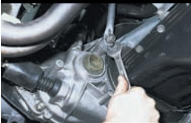
...и одну гайку крепления картера сцепления к блоку цилиндров.
