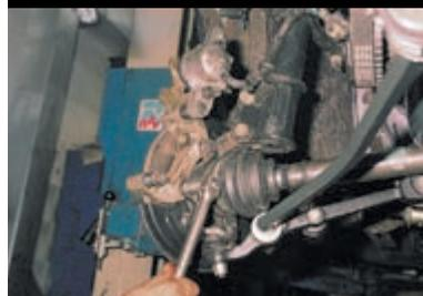
Головкой «на 17» отворачиваем два болта крепления направляющей колодки к поворотному кулаку.
