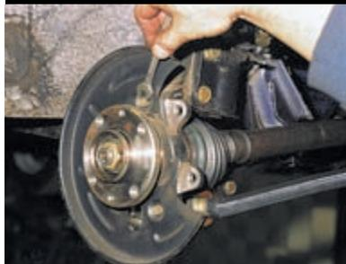
Для снятия защитного кожуха тормозного диска ключом «на 10» отворачиваем три болта его крепления к поворотному кулаку.
