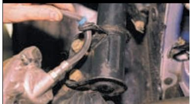
Выводим муфту шланга из держателя амортизаторной стойки.
