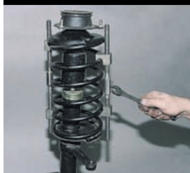
Равномерно вращая винты, сжимаем пружину.
