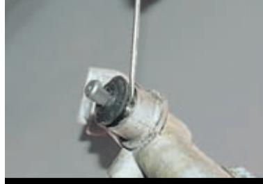
Поддев отверткой, снимаем пыльник шестерни.
