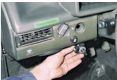
...и вынимаем выключатель освещения приборов из панели.
