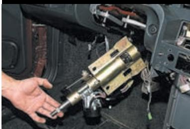
...опускаем рулевую колонку, не отсоединяя ее от шестерни рулевого механизма.
