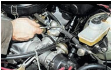
...крестообразной отверткой ослабляем хомуты крепления всасывающего и нагнетательного шлангов...
