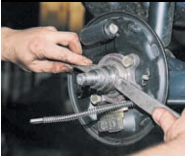
Снимаем кольцо двумя монтажными лопатками.
