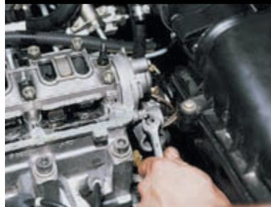
На двигателе ВАЗ-2111 ключом «на 10» отворачиваем две гайки крепления «массовых» проводов к шпилькам заглушки головки блока цилиндров и снимаем провода со шпилек.
