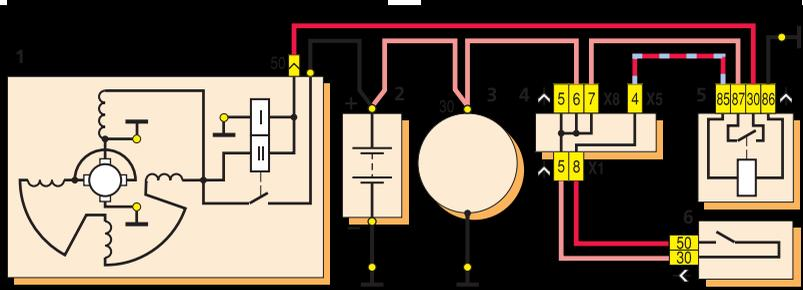
Схема соединений стартера 29.3708: 1 – стартер; 2 – аккумуляторная батарея; 3 – генератор; 4 – монтажный блок; 5 – реле включения стартера; 6 – выключатель зажигания; 7 – удерживающая обмотка; 8 – втягивающая обмотка
