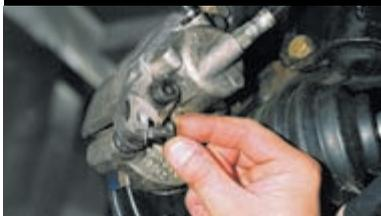
...и вынимаем его вместе с пластиной.
