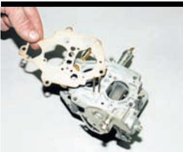
Снимаем прокладку крышки.
