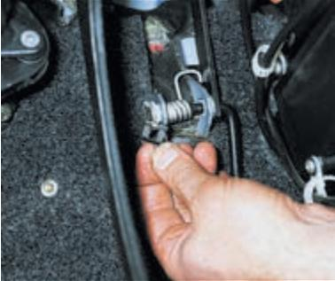
...снимаем стопорную скобу.
