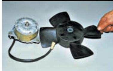
Снимаем крыльчатку. На новый электродвигатель надеваем крыльчатку, обеспечив попадание штифта вала в паз крыльчатки. Дальнейшую сборку ведем в обратной последовательности.
