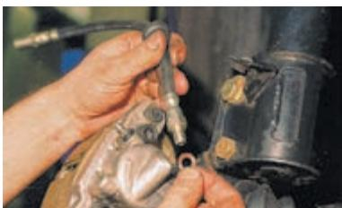
Между цилиндром и штуцером установлено медное уплотнительное кольцо, подлежащее замене. После установки шланга прокачиваем тормозную систему (см. «Прокачка тормозов», с. 149).
