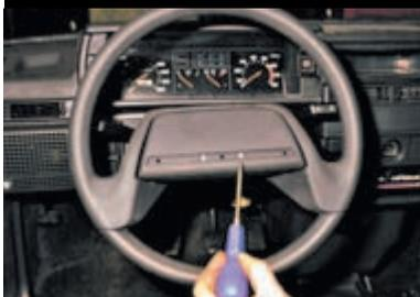
Крестообразной отверткой отворачиваем два самореза...
