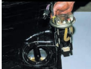
Аккуратно приподнимаем узел и выводим поплавков из отверстия бака, снимаем электробензонасос с датчиком уровня топлива.
