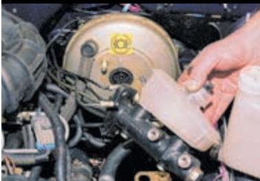
Снимаем цилиндр в сборе с бачком.
