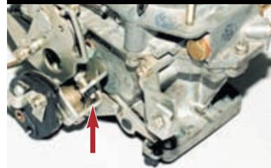
Этот зазор регулируем, поворачивая шлицевой отверткой или ключом на «7» винт (по стрелке) на рычаге привода дроссельной заслонки.
