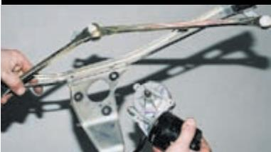
...и снимаем его.
