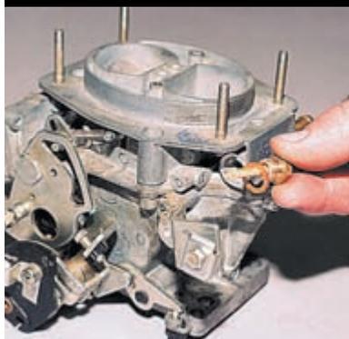
...и извлекаем ее вместе с фильтром и уплотнительным медным кольцом (это можно сделать и после снятия крышки карбюратора).
