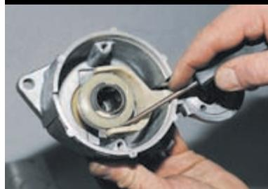
Отжав отверткой пружину,
