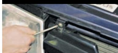
Крестообразной отверткой отворачиваем два самореза.
