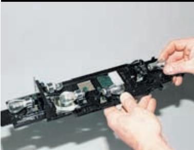
Нажав и повернув против часовой стрелки, снимаем лампу.
