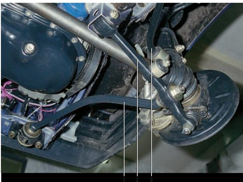
Передняя подвеска (вид снизу): 1 — растяжка рычага подвески; 2 — рычаг подвески; 3 — штанга стабилизатора поперечной устойчивости
