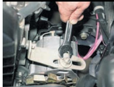
Ключом «на 17» ослабляем гайку крепления генератора к натяжной планке.
