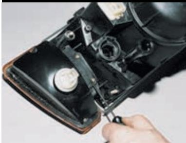
Шлицевой отверткой отворачиваем два винта...
