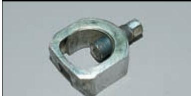
Съемник шаровых опор
