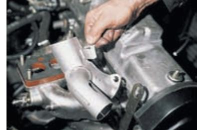
Снимаем патрубок забор горячего воздуха...
