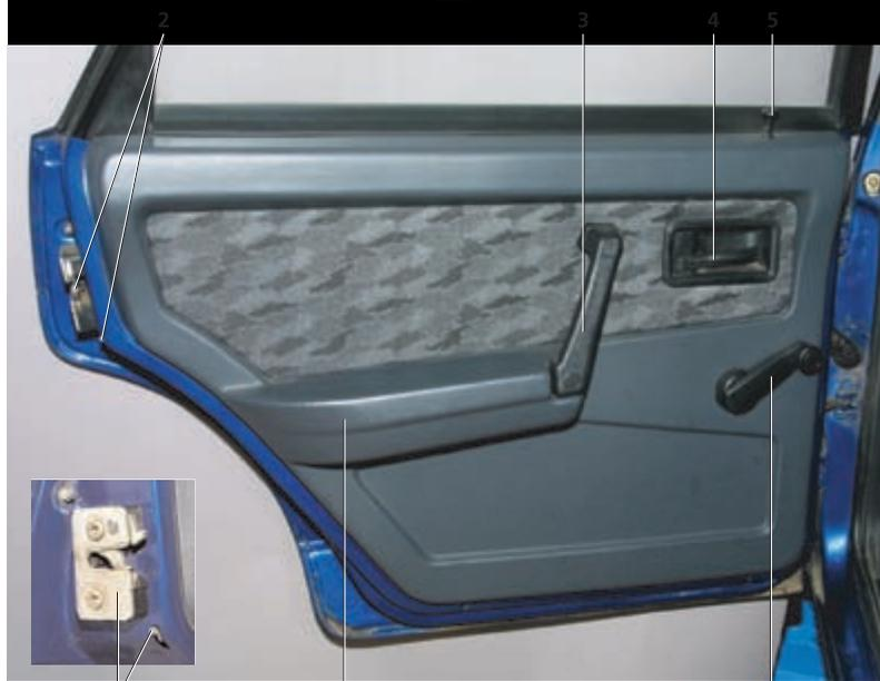
**Задняя дверь:** 1 – подлокотник; 2 – замок двери и рычажок замка; 3 – ручка двери; 4 – внутренняя ручка замка двери; 5 – кнопка блокировки замка; 6 – ручка стеклоподъемника
