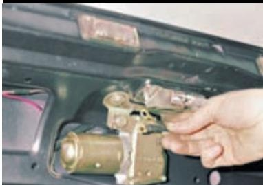
Снимаем две «минусовых» клеммы проводов плафонов освещения номерных знаков и моторедуктора стеклоочистителя...
