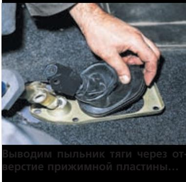
Выводим пыльник тяги через отверстие прижимной пластины...
