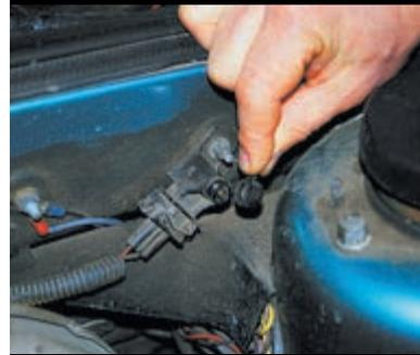
Для регулировки уровня СО в отработавших газах снимаем колпачок с потенциометра.
