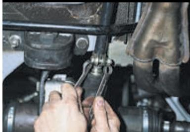
Снизу автомобиля двумя ключами «на 13» ослабляем стяжной болт хомута тяги привода.
