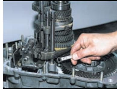
Накидным ключом «на 10» отворачиваем болт крепления вилок включения I-II передач к штоку.
