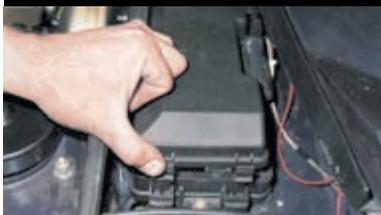
Нажав четыре защелки крышки монтажного блока,
