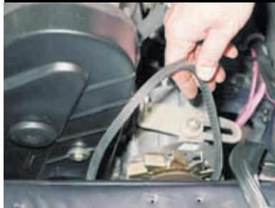
...смещаем генератор к блоку цилиндров двигателя и снимаем ремень. Надев новый ремень на шкивы, натягиваем его, как было описано выше.
