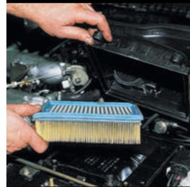
...извлекаем сменный элемент фильтра.
