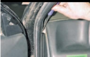
Крестообразной отверткой отворачиваем с каждой стороны панели по одному саморезу верхнего крепления панели.
