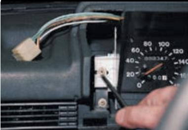
Крестообразной отверткой отворачиваем два самореза крепления комбинации приборов к панели.
