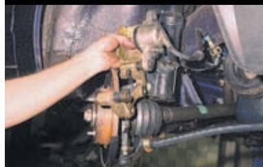
Снимаем передний тормозной механизм в сборе (не разъединяя гидропривод) и привязываем его к амортизаторной стойке.
