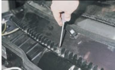
Крестообразной отверткой отворачиваем пять саморезов крепления решеток воздухопритока (капот для наглядности снят).
