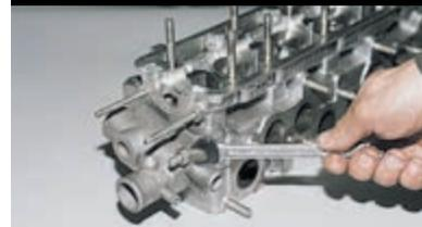
Ключом «на 13» отворачиваем две гайки крепления выпускного патрубка.
