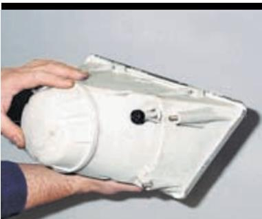
Соединяем корпус фары и стекло. Кладем фару стеклом вниз до полимеризации герметика. Устанавливаем фару на автомобиль в обратной последовательности.
