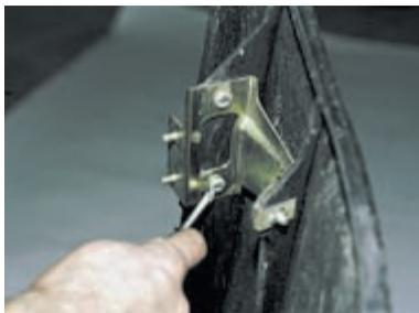
Для снятия бокового кронштейна бампера крестообразной отверткой отворачиваем три самореза крепления...
