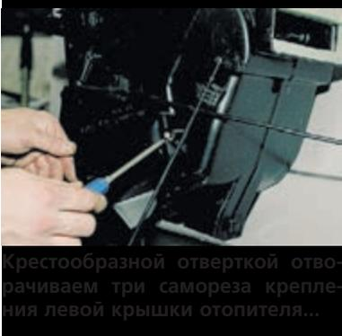
Крестообразной отверткой отворачиваем три самореза крепления левой крышки отопителя...
