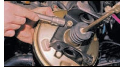
Головкой «на 17» отворачиваем две гайки крепления усилителя к кронштейну...
