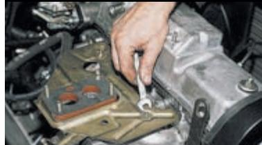
Отворачиваем ключом «на 10» две гайки крепления теплозащитного экрана...
