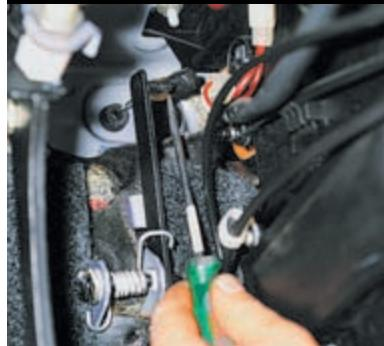
В салоне поддеваем отверткой наконечник троса и снимаем его с пальца рычага привода. Вынимаем трос из щита передка.
