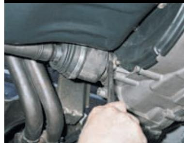
...и опираясь монтажной лопаткой на прилив картера сцепления,
