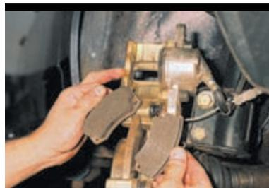
Извлекаем из направляющей тормозные колодки.
