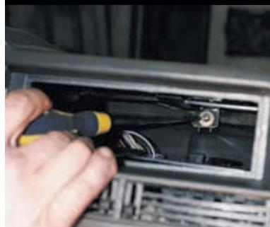
Через гнездо радиоприемника отворачиваем один саморез центрального крепления накладки.
