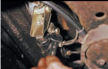
Ключом «на 13» ослабляем болт крепления регулятора давления к кронштейну рычага привода регулятора...
