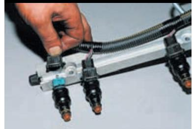
Сжав пружинную скобу, отсоединяем электрический разъем форсунки.
