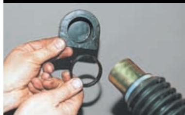
Снимаем опору и распорное кольцо с правой стороны картера рулевого механизма.
