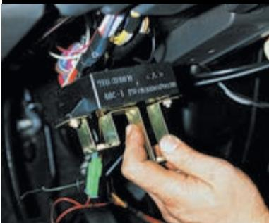
Осторожно вынимаем блок управления из полости панели приборов, стараясь не зацепить жгуты проводов.
