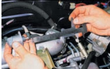
При установке нового регулятора проверяем расстояние между концом иглы клапана и монтажным фланцем: оно должно быть не более 23 мм.
