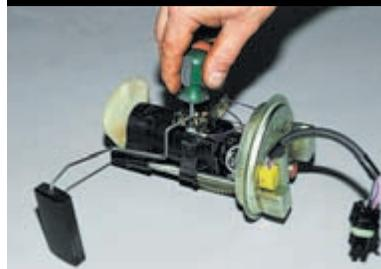
Отворачиваем крестообразной отверткой два самореза...
