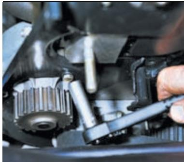
Головкой «на 10» отворачиваем три болта крепления насоса охлаждающей жидкости.
