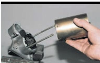
Снимаем статор вместе с якорем со шпилек крышки.
