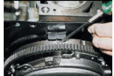
Так должна быть расположена риска на маховике двигателя (при снятой коробке передач и головке блока цилиндров).
