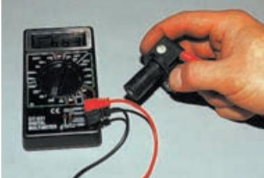
Сопротивление исправного датчика должно быть в пределах 550–750 Ом.
