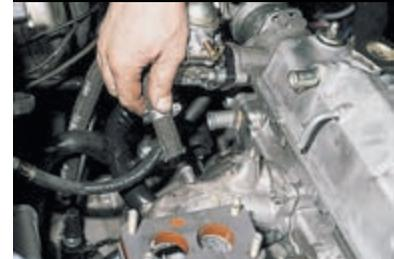
Отсоединяем шланг вакуумного усилителя тормозов и шланг эконометра (если он есть).
