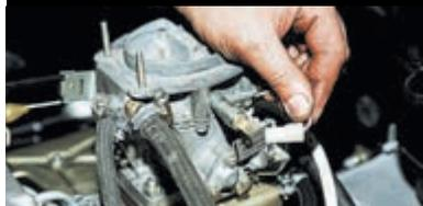
Снимаем провод с электромагнитного клапана.
