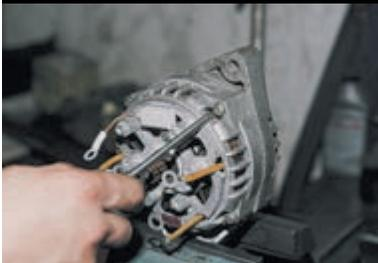
Крестообразной отверткой отворачиваем четыре винта, стягивающих крышки.
