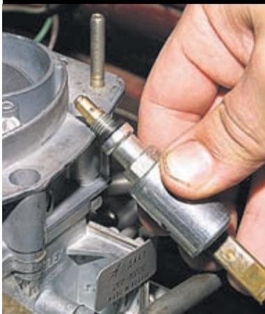
С исправным блоком управления в момент замыкания корпуса клапана на «массу» должен быть слышен характерный щелчок.
