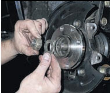
Отворачиваем до конца гайку подшипника ступицы и снимаем шайбу.
