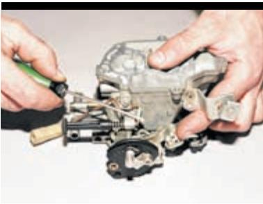
Поддев отверткой, отсоединяем контакт провода от наконечника винта...
