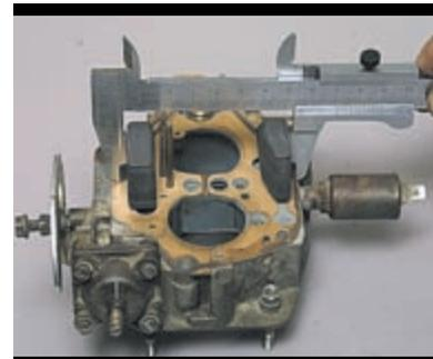
...проверяем положение поплавков. Между губками и боковыми поверхностями поплавков должен быть зазор не более 1 мм.
