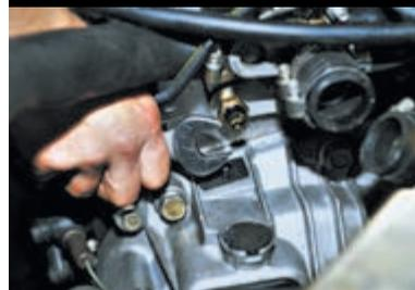
Ключом «на 21» отворачиваем датчик температуры...
