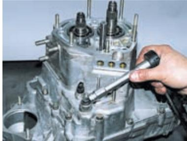
Головкой «на 13» отворачиваем пробку фиксатора задней передачи и вынимаем пружину.
