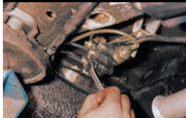
Ключом «на 10» отворачиваем четыре штуцера тормозных трубок...
