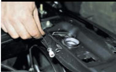
...отсоединяем трос привода замка от пружины.
