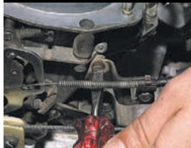
Отверткой отворачиваем винт и...
