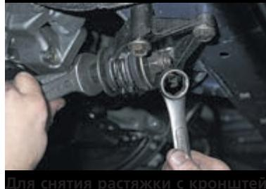
Для снятия растяжки с кронштейна крепления двумя ключами «на 24» отворачиваем гайку,
