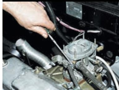
Крестообразной отверткой ослабляем хомуты на подводщем и отводящем топливных шлангах...
