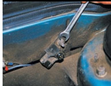
Ключом «на 8» отворачиваем гайку крепления потенциометра к щитку передка и снимаем его.
