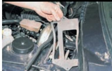
Соединение монтажного блока с кузовом уплотнено прокладкой. Устанавливаем монтажный блок в обратной последовательности.
