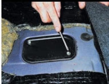
Крестообразной отверткой отворачиваем два самореза крепления крышки лючка...
