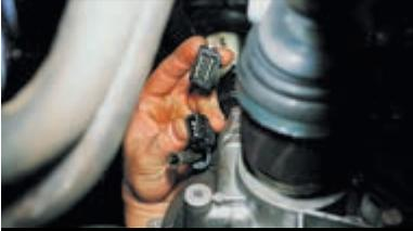
При выключенном зажигании отсоединяем разъем проводов от датчика.
