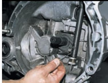
Выводим пружину из-под вилки выключения сцепления и снимаем ее.
