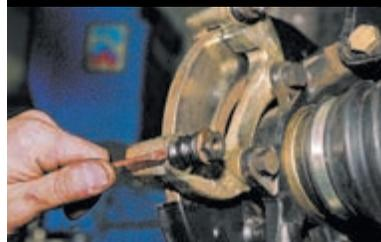
Поддеваем отверткой защитный чехол...
