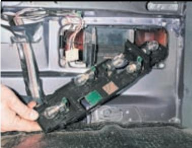
...снимаем плату заднего фонаря.
