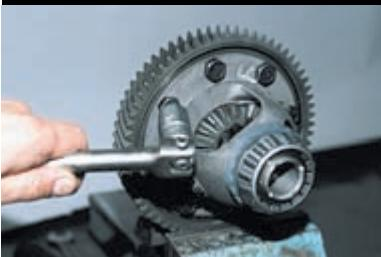
Головкой «на 17» отворачиваем восемь болтов крепления шестерни к коробке дифференциала.
