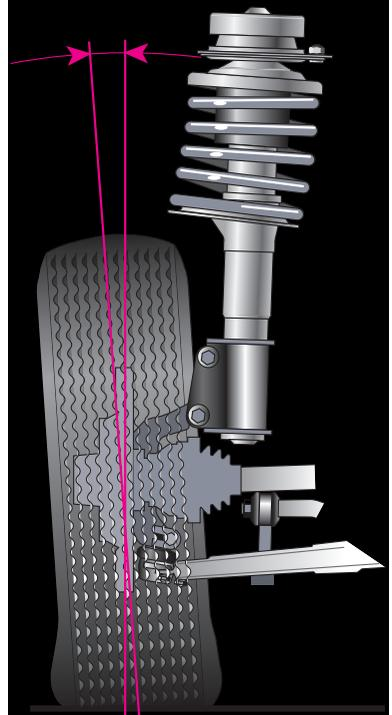
Рис. 2. Угол развала колеса
