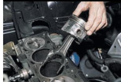
...и вынимаем поршень с шатуном.
