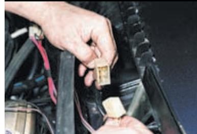
Отсоединяем разъем моторедуктора стеклоочистителя.
