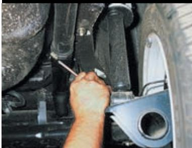
Ослабляем хомут наливной трубы...
