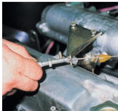
Отвернув гайку, выводим трос из прорези кронштейна.
