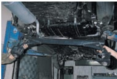
Вынув болты, снимаем балку.
