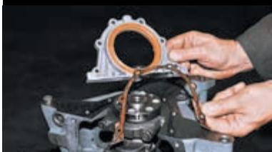
Снимаем держатель и прокладку.
