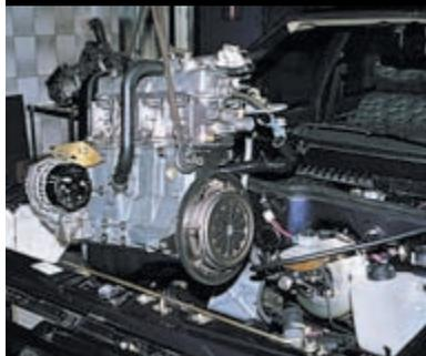
...и вынимаем двигатель из моторного отсека.
