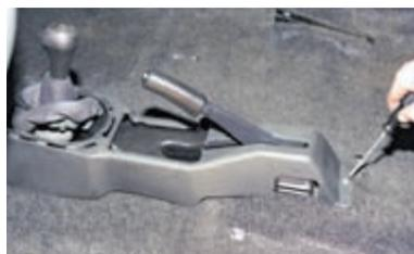
Крестообразной отверткой отворачиваем саморез заднего крепления облицовки тоннеля.
