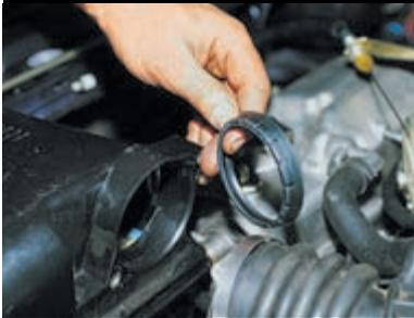
...и уплотнитель датчика. Устанавливаем датчик в обратной последовательности. Момент затяжки болтов 8–11 Н·м.
