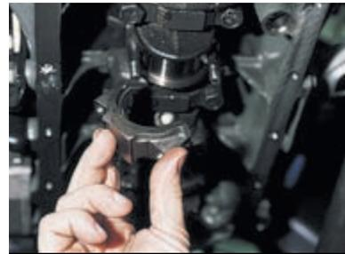
...и снимаем крышку.
