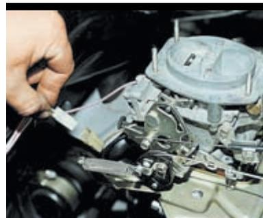
Разъединяем колодку провода наконечника винта «количества». Снимаем провод с электромагнитного клапана.
