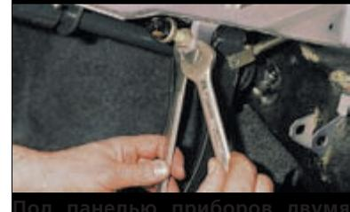
Под панелью приборов двумя ключами «на 17» ослабляем гайки крепления выключателя стоп-сигнала.
