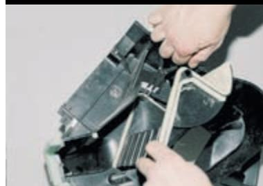
Сжимаем усики крепежного элемента привода заслонки и управления отопителем...
