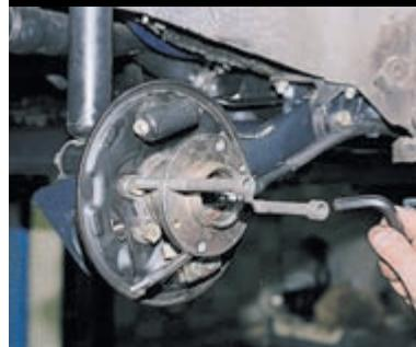
Равномерно затягивая винты, выпрессовываем ступицу.
