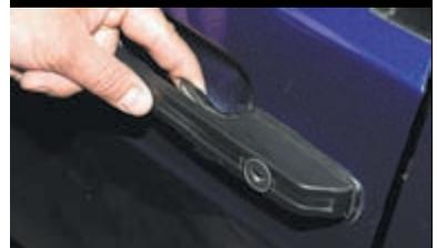
Чтобы открыть дверь снаружи, нажимаем клавишу наружной ручки двери и открываем дверь. Одновременно с открыванием любой двери включается центральный плафон освещения салона. Замок передней двери можно заблокировать и разблокировать снаружи ключом.
