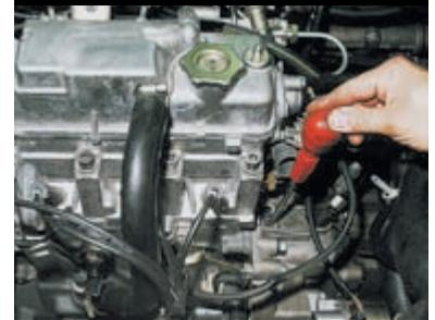
Фиксируем коленчатый вал от проворачивания, вставив через отверстие в картере сцепления отвертку между зубьями маховика.
