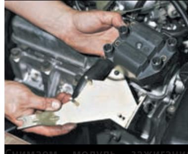
Снимаем модуль зажигания со шпилек кронштейна.
