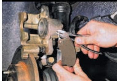
...бокорезами перекусываем провод старого датчика.
