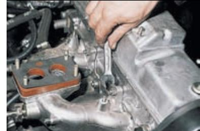
Ключом «на 13» отворачиваем шесть гаек крепления впускного коллектора.
