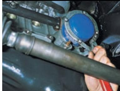
Отворачиваем съемником масляный фильтр.
