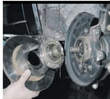
Резко ударяя тормозным диском по головкам болтов, выпрессовываем ступицу.
