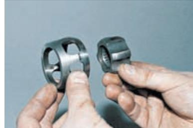
Вынимаем обойму из сепаратора. При сборке шарнира вкладываем в его полость 80 см<sup>3</sup> смазки.
