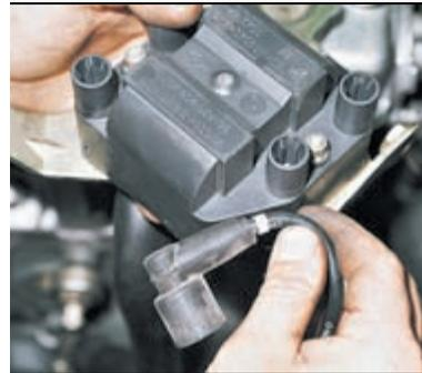
Нумерация проводов нанесена на их белых колечках, а на модуле отлиты номера цилиндров.
