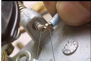
...значит нарушен контакт наконечника винта «количества» (1) с рычагом привода дроссельных заслонок, поврежден или окислился наконечник провода (2) или оборван сам провод.
