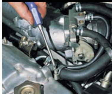
Крестообразной отверткой ослабляем хомуты крепления двух отводящих шлангов вентиляции картера.
