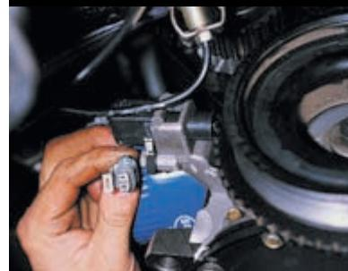
Выключив зажигание, отсоединяем разъем датчика.
