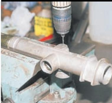
Если такового нет, сверлом диаметром 2 мм в торце картера сверлим два отверстия так, чтобы они выходили на торец кольца игольчатого подшипника.
