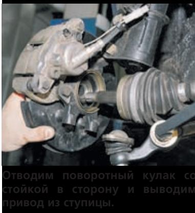
Отводим поворотный кулак со стойкой в сторону и выводим привод из ступицы.
