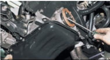
Поддеваем отверткой сальник и извлекаем его из держателя.
