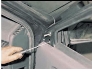
Крестообразной отверткой отворачиваем три винта крепления зеркала...
