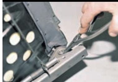
Аналогично снимаем стопорную шайбу и вынимаем втулку крепления наружных салазок к сиденью.
