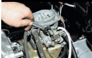
Ключом «на 13» отворачиваем электромагнитный клапан...
