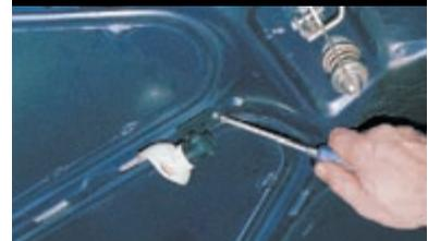
Крестообразной отверткой отворачиваем саморез крепления подкапотной лампы...
