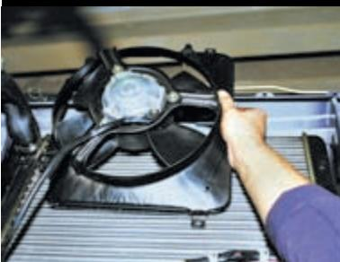
Вынимаем электровентилятор в сборе с кожухом.
