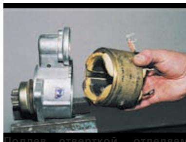
Поддев отверткой, отделяем корпус.
