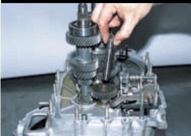
Вынимаем ось промежуточной шестерни заднего хода.
