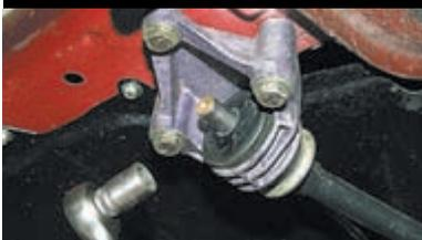
Головкой «на 17» отворачиваем три болта крепления кронштейна к нижней поперечине рамки радиатора...
