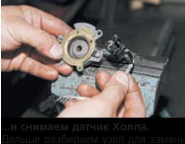
...и снимаем датчик Холла. Далее разбираем узел для замены центробежного регулятора или сальника.
