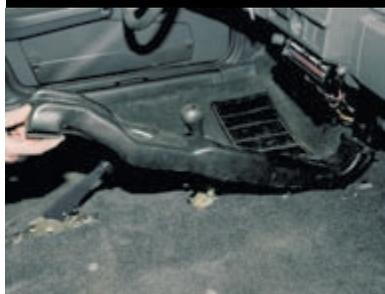
Вынимаем воздуховод внутренней вентиляции салона (для наглядности сиденья сняты).
