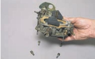
...крышку переворачиваем поплавками вверх над столом или крышкой корпуса воздушного фильтра.
