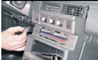
Снимаем ручку переключателя вентилятора отопителя.
