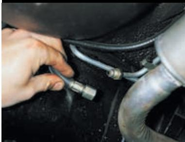
Разъединяем сливной трубопровод.
