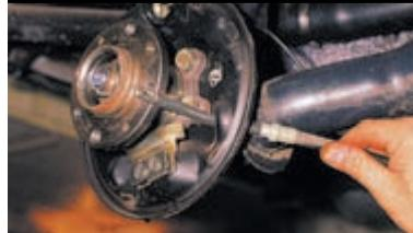
Вынимаем трос из щита тормозного механизма.
