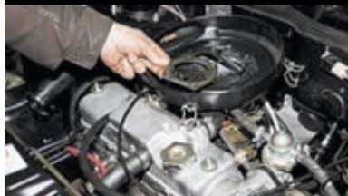
...и снимаем прижимную пластину.
