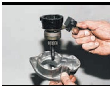
Снимаем вал привода с рычагом.
