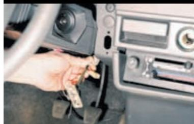
Отсоединив электрический разъем выключателя сигнализатора прикрытия заслонки, вынимаем оболочку тяги привода в сборе через отверстие в щитке передка.
