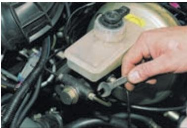
Ключом «на 10» отворачиваем штуцеры тормозных трубок от цилиндра.
