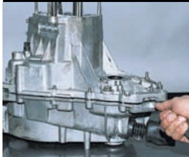
Вставив в паз на стыке привалочных плоскостей картеров отвертку, аккуратно приподнимаем картер коробки...
