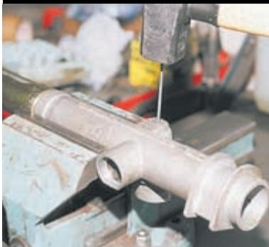
Через отверстия выбиваем подшипник из картера.
