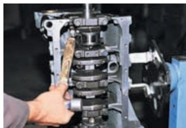
Упираемся деревянной ручкой молотка в разъем нижней головки шатуна...
