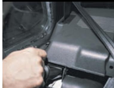
Отверткой поддеваем и вынимаем пистоны.
