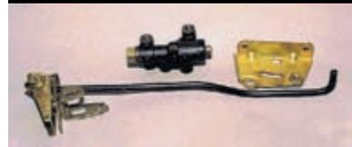
Отсоединяем от регулятора давления кронштейн и рычаги привода.
