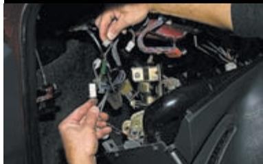
Отсоединяем колодку жгута проводов патрона переносной лампы...
