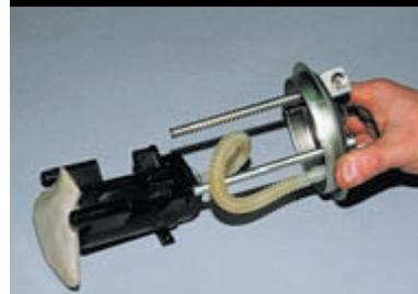
...и снимаем с направляющих корпус бензонасоса.
