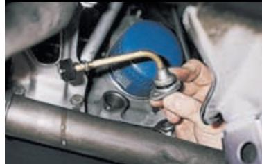
Слегка покачивая, выводим датчик из гнезда в блоке цилиндров, стараясь не повредить поплавков. Устанавливаем датчик в обратной последовательности.
