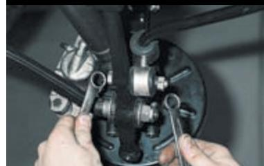
Двумя ключами «на 17» отворачиваем гайку болта крепления стойки стабилизатора поперечной устойчивости к рычагу.
