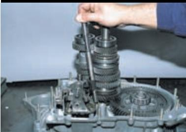
Поворачивая шток включения IV передачи, выводим его из механизма выбора передач.
