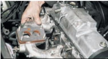
**Снимаем впускной коллектор.**
