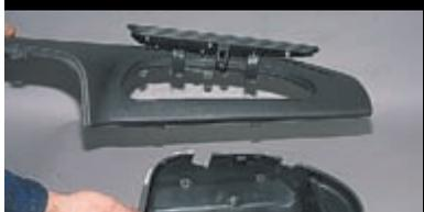
...и отсоединяем корпус верхнего вещевого ящика от накладки панели приборов.
