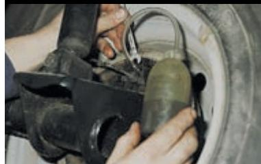
Прокачиваем колесные цилиндры задних тормозов.
