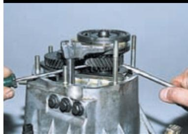
Поддев двумя отвертками шестерню пятой передачи, снимаем узел пятой передачи в сборе.
