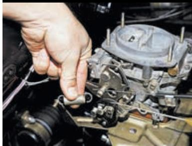
Снимаем возвратную пружину.
