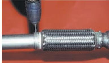
...и сверлим по окружности восемь отверстий диаметром 4,2 мм.
