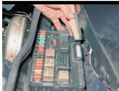
...и один сзади. Из салона отсоединяем пять разъемов жгутов проводов.
