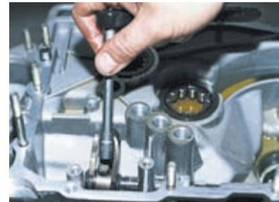
Головкой «на 10» отворачиваем установочный болт рычага выбора передач.
