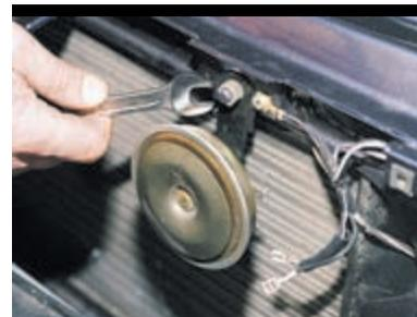
Ключом «на 13» отворачиваем гайку крепления сигнала.
