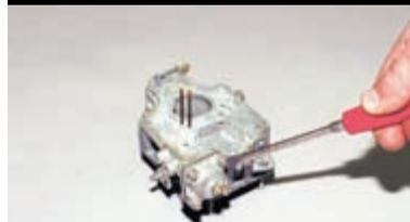
Шлицевой отверткой отворачиваем четыре винта крепления крышки пускового устройства.
