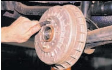
Ключом «на 12» отворачиваем два направляющих штифта.
