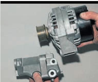
Разъединяем генератор и кронштейн.
