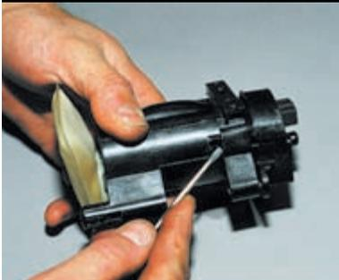
Освобождаем три фиксатора крышки.
