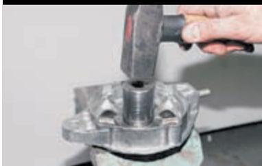
Выпрессовываем старый и запрессовываем новый подшипник подходящим отрезком трубы, передавая усилие только на наружное кольцо.
