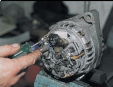
Крестообразной отверткой отворачиваем два винта...
