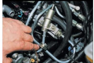
Отводим трубку от регулятора.
