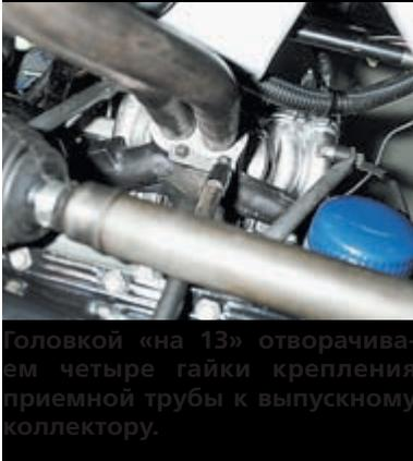
Головкой «на 13» отворачиваем четыре гайки крепления приемной трубы к выпускному коллектору.
