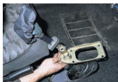
...и снимаем рычаг переключения передач в сборе с прижимной пластиной.
