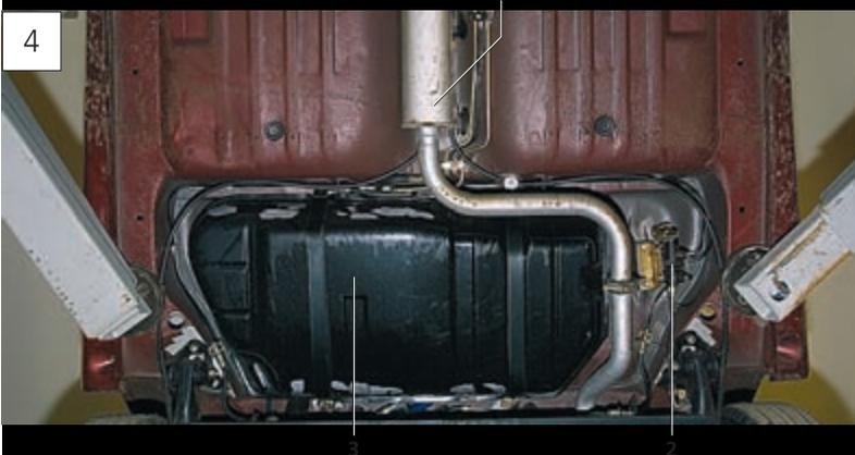
**Днище автомобиля под сиденьями задних пассажиров:** 1 – дополнительный глушитель системы выпуска; 2 – регулятор давления жидкости в тормозных механизмах задних колес; 3 – топливный бак
