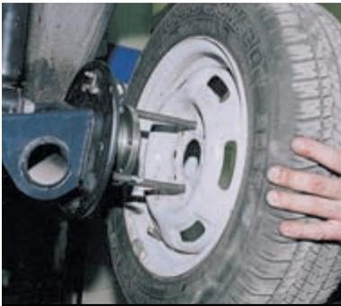
Демонтировать ступицу можно также, используя колесо в качестве ударного съемника. Заворачиваем два болта длиной 100–150 мм в отверстия ступицы, пропустив их через отверстия колеса,
