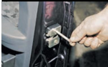
Выворачиваем верхний винт крепления замка и вворачиваем на его место шпильку М8 длиной 70–80 мм.
