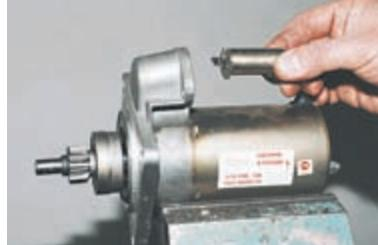
Снимаем якорь тягового реле.
