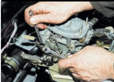
Двумя ключами «на 8» ослабляем болт крепления тяги привода к рычагу управления воздушной заслонкой карбюратора.
