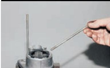
Выворачиваем из передней крышки шпильки.
