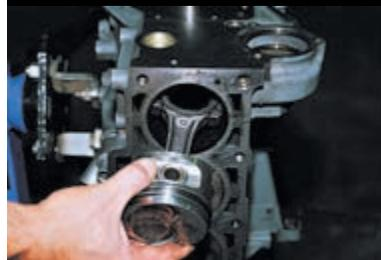
...и выталкиваем поршень с шатуном из цилиндра.
