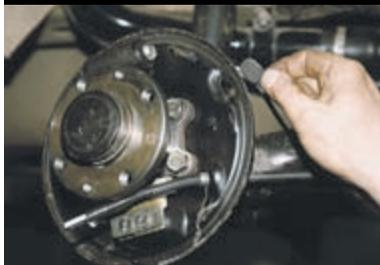
...и извлекаем ее из щита (барабан и колодки для наглядности сняты).
