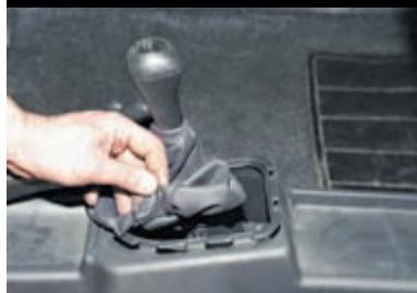
Снимаем чехол рычага переключения передач.
