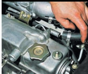
Снимаем шланги со штуцеров клапанной крышки.
