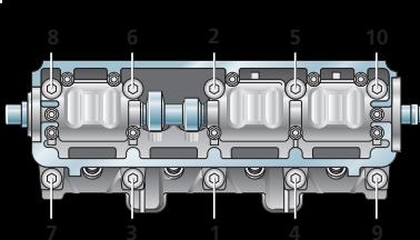
**Порядок затягивания винтов головки цилиндров**
