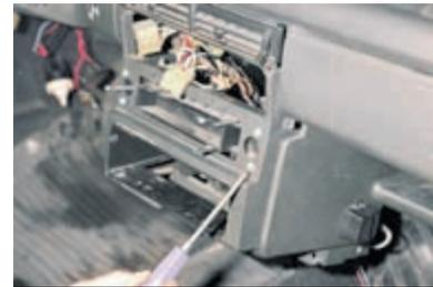
Крестообразной отверткой отворачиваем четыре самореза крепления блока управления отопителем.
