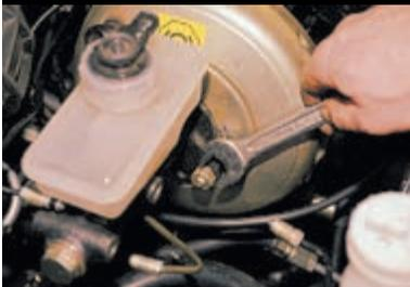
Ключом «на 17» отворачиваем две гайки крепления цилиндра к вакуумному усилителю.
