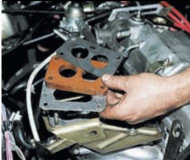
При необходимости снимаем прокладку, находящуюся под карбюратором (с двумя большими круглыми отверстиями), теплоизолирующую проставку и прокладку между ней и впускным коллектором (с одним большим овальным отверстием).
