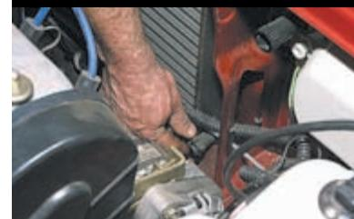
Отворачиваем пробку, расположенную в нижнем правом углу радиатора, и сливаем жидкость в емкость объемом не менее 8 л.
