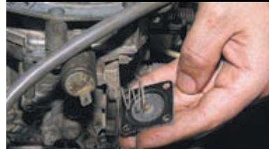
Вынимаем диафрагму и пружину. Устанавливаем новую диафрагму, проверяем подвижность толкателя. Для удобства устанавливаем диафрагму с толкателем в крышку, а пружину — в корпус карбюратора. После этого закрепляем крышку диафрагмы винтами, сжимая пружину.
