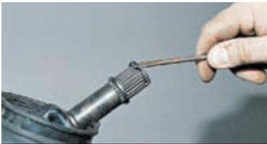
Поддеваем стопорное кольцо отверткой...
