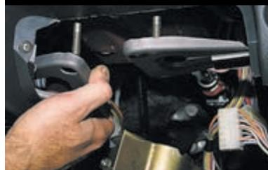
Снимаем «ушки» левой и правой поперечин панели приборов со шпилек крепления рулевой колонки.
