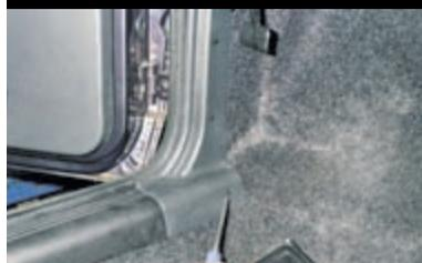
Крестообразной отверткой отворачиваем по три самореза крепления передней накладки порога, правой и левой дверей.
