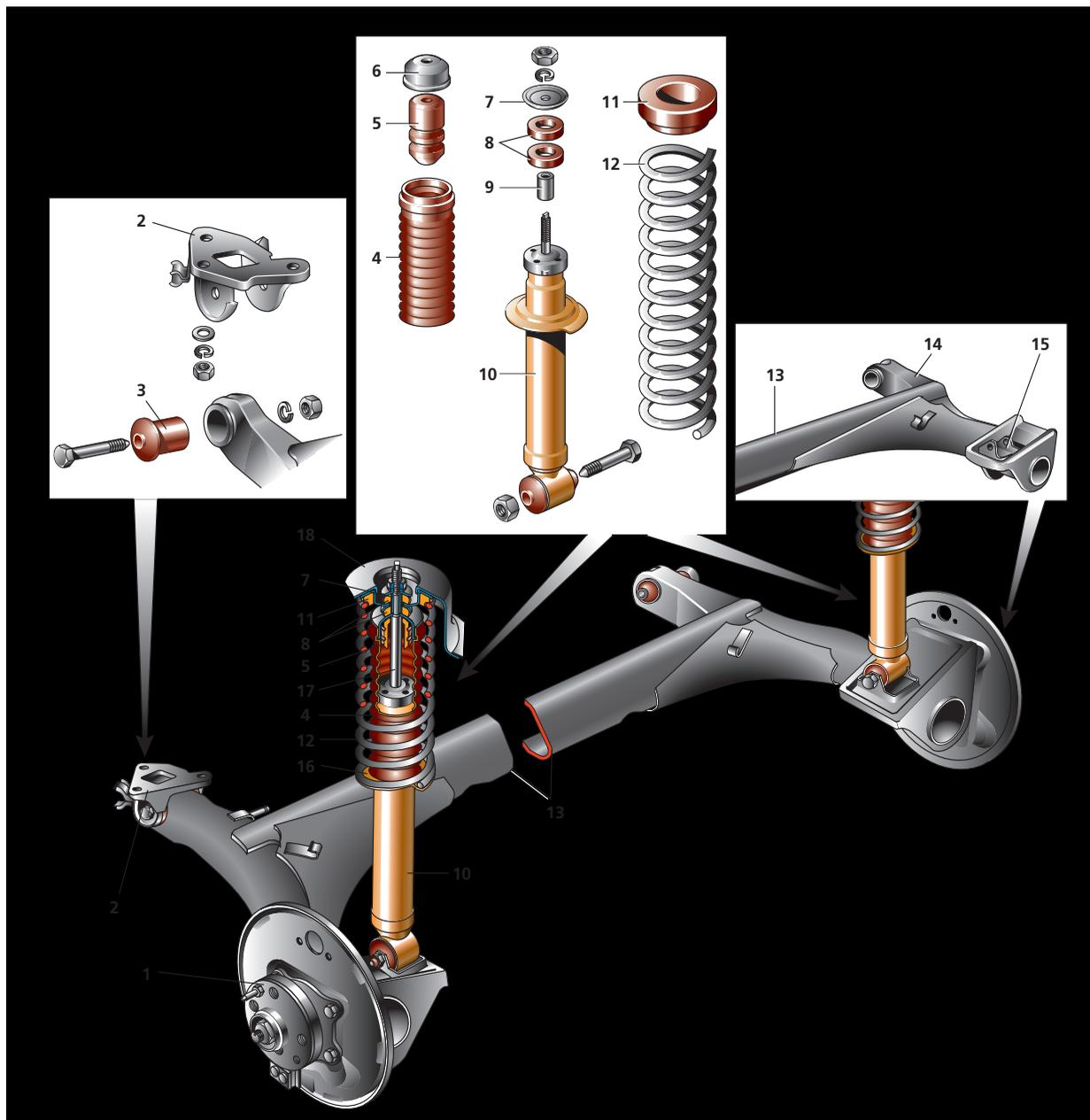
**Детали задней подвески:** 1 – ступица колеса; 2 – кронштейн крепления рычага подвески; 3 – сайлент-блок; 4 – кожух амортизатора; 5 – буфер хода сжатия; 6 – крышка кожуха; 7 – опорная шайба; 8 – подушки амортизатора; 9 – распорная втулка; 10 – амортизатор; 11 – резиновая прокладка; 12 – пружина задней подвески; 13 – соединитель рычагов; 14 – рычаг балки задней подвески; 15 – кронштейн крепления амортизатора; 16 – нижняя опорная чашка пружины; 17 – шток; 18 – верхняя опорная чашка пружины
