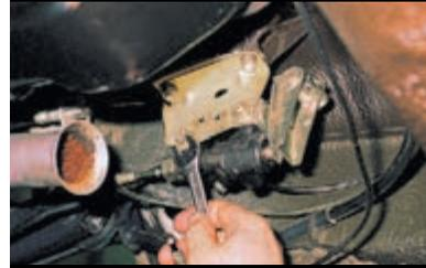
Ключом «на 13» отворачиваем два болта крепления корпуса регулятора к кронштейну.
