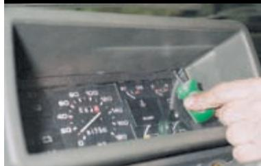
Короткой крестообразной отверткой отворачиваем два самореза крепления козырька комбинации приборов.
