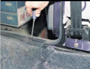
Отворачиваем по три самореза крепления накладок порогов задних дверей и снимаем накладки.
