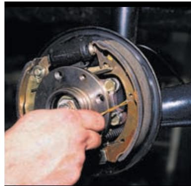
Натягивая пружину, вставляем ее конец в отверстие колодки. Вытягиваем проводок.
