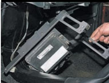
Отводим в сторону кронштейн панели приборов вместе с прикрепленными к нему контроллером и держателями реле и предохранителей системы впрыска топлива.
