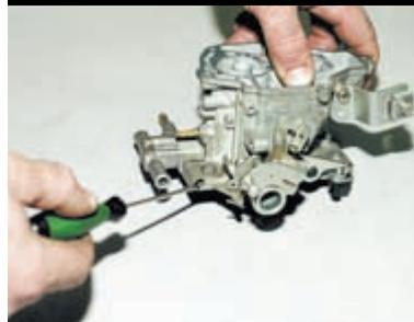
Узкой шлицевой отверткой отворачиваем винт регулировки «качества» смеси...
