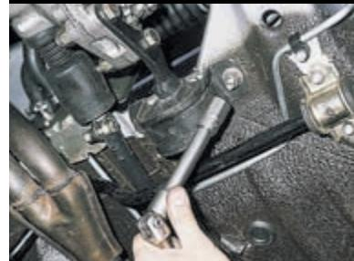
Подставив упор под коробку передач, головкой «на 17» отворачиваем две гайки крепления кронштейна опоры к кузову.
