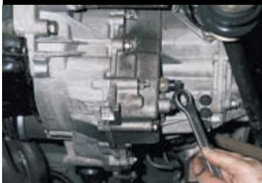
Под коробку передач подставляем емкость и ключом «на 22» отворачиваем выключатель фонарей заднего хода...
