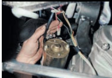
Отсоединяем провод управления тяговым реле.
