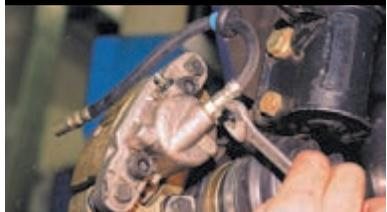
Ключом «на 15» отворачиваем штуцер шланга от колесного цилиндра.
