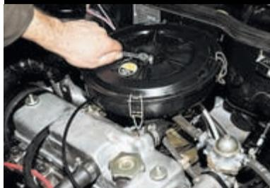
...ключом «на 10» отворачиваем гайку крепления крышки фильтра...
