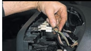
Отсоединяем колодки жгутов проводов от клавишных выключателей, расположенных на щитке панели приборов,
