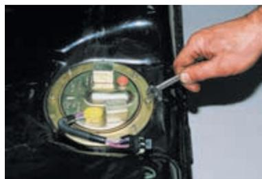
Ключом «на 7» отворачиваем восемь гаек крепления прижимного кольца...
