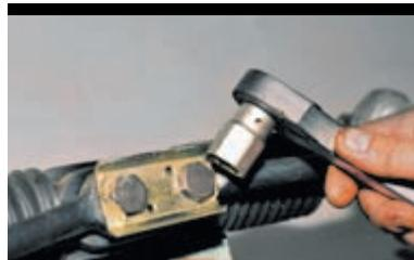
Отворачиваем болты головкой «на 22».
