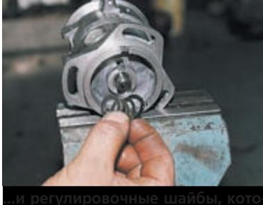
...и регулировочные шайбы, которые должны обеспечивать осевой люфт валика не более 0,35 мм.
