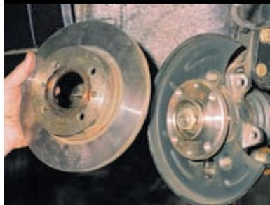
...и снимаем тормозной диск.
