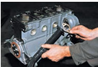
Снимаем трубу и прокладку.
