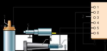
Схема подключения ЭПХХ: 1 – катушка зажигания; 2 – соединительная колодка блока управления; 3 – изолированный наконечник винта «количества»; 4 – винт «количества»; 5 – электромагнитный клапан
