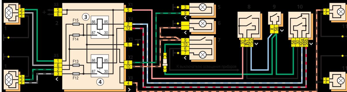
Схема включения фар и противотуманного света: 1 – блок-фара; 2 – монтажный блок; 3 – реле включения дальнего света фар; 4 – реле включения ближнего света фар; 5 – комбинация приборов с контрольной лампой дальнего света фар; 6 – контрольная лампа включения заднего противотуманного света; 7 – выключатель противотуманного света в задних фонарях; 8 – выключатель зажигания; 9 – выключатель наружного освещения; 10 – переключатель света фар; 11 – лампа противотуманного света в задних фонарях
