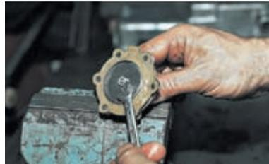
Ключом «на 8» отворачиваем гайку крепления штока. Снимаем верхнюю тарелку.
