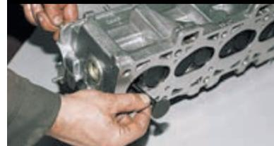
И вынимаем его из направляющей втулки головки блока.
