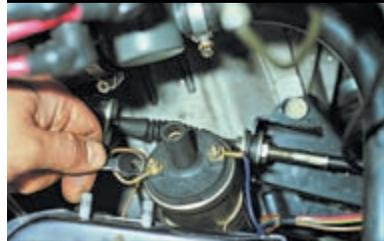
Ключом «на 8» отворачиваем две гайки крепления наконечников проводов к катушке зажигания...
