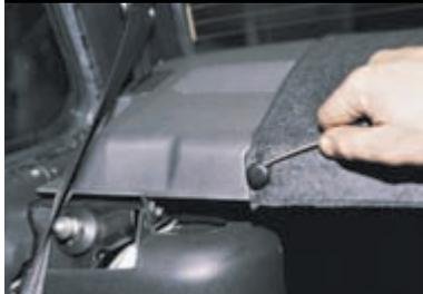
Поддеваем отверткой замки двух пистонов крепления полки.
