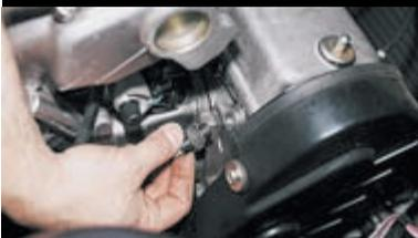
Соединение уплотняется алюминиевым кольцом. Устанавливаем датчик в обратной последовательности.
