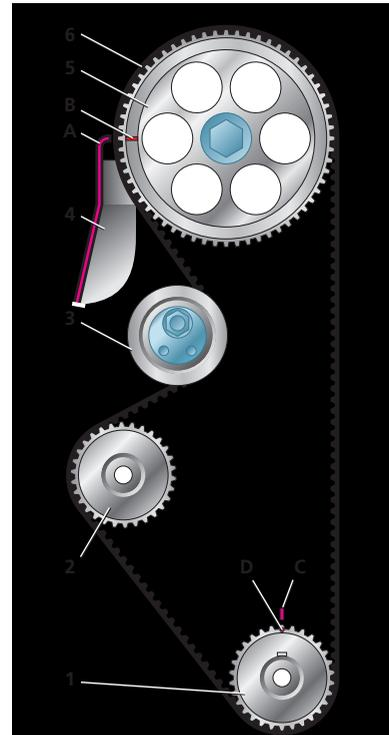
Схема привода распределительного вала: 1 – зубчатый шкив коленчатого вала; 2 – зубчатый шкив насоса охлаждающей жидкости; 3 – натяжной ролик; 4 – задняя защитная крышка; 5 – зубчатый шкив распределительного вала; 6 – зубчатый ремень; А – установочный выступ на задней защитной крышке; В – метка на шкиве распределительного вала; С – метка на крышке масляного насоса; D – метка на шкиве коленчатого вала
