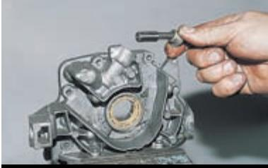
Извлекаем пружину и поршень редукционного клапана.
