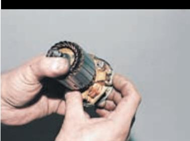
Ставим пружины и защелкиваем скобы.
