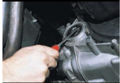
Поддев отверткой, вынимаем сальник.
