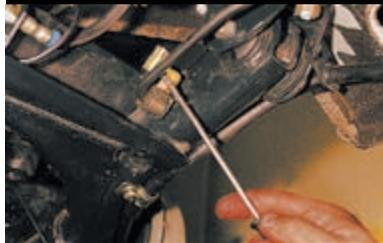
Отверткой приподнимаем верхнюю скобу серьги рычага привода регулятора.
