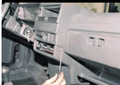
Крестообразной отверткой отворачиваем два самореза...
