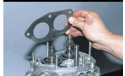
Снимаем упорную пластину.
