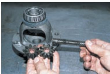
Извлекаем из коробки ось сателлитов и сателлиты. Для снятия подшипников дифференциала зажимаем коробку в тиски.
