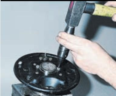
При необходимости ось ступицы и щит тормозного механизма разъединяем, отвернув ударной крестообразной отверткой два винта.
