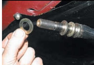
...надеваем на растяжку дополнительные регулировочные шайбы. При установке левого кронштейна буксирная проушина будет мешать монтажу, поэтому напильником или наждаке делаем на кронштейне выборку.
