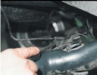
Отгнув скобу крепления, снимаем тормозную трубку.
