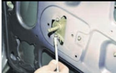
Головкой «на 8» отворачиваем три гайки крепления механизма стеклоподъемника.
