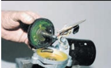
Снимаем шестерню моторедуктора.
