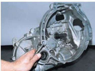
Для удобства разборки выворачиваем шпильку крепления коробки передач к двигателю.
