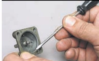
Крышку устанавливаем так, чтобы сквозной канал в ней совпал с латунной трубкой канала подвода разрежения на корпусе карбюратора и отверстием диафрагмы.
