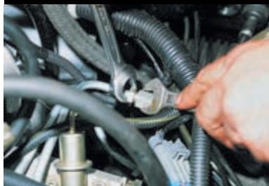
Двумя ключами «на 17» отворачиваем штуцеры топливных трубок, стравливая давление топлива.
