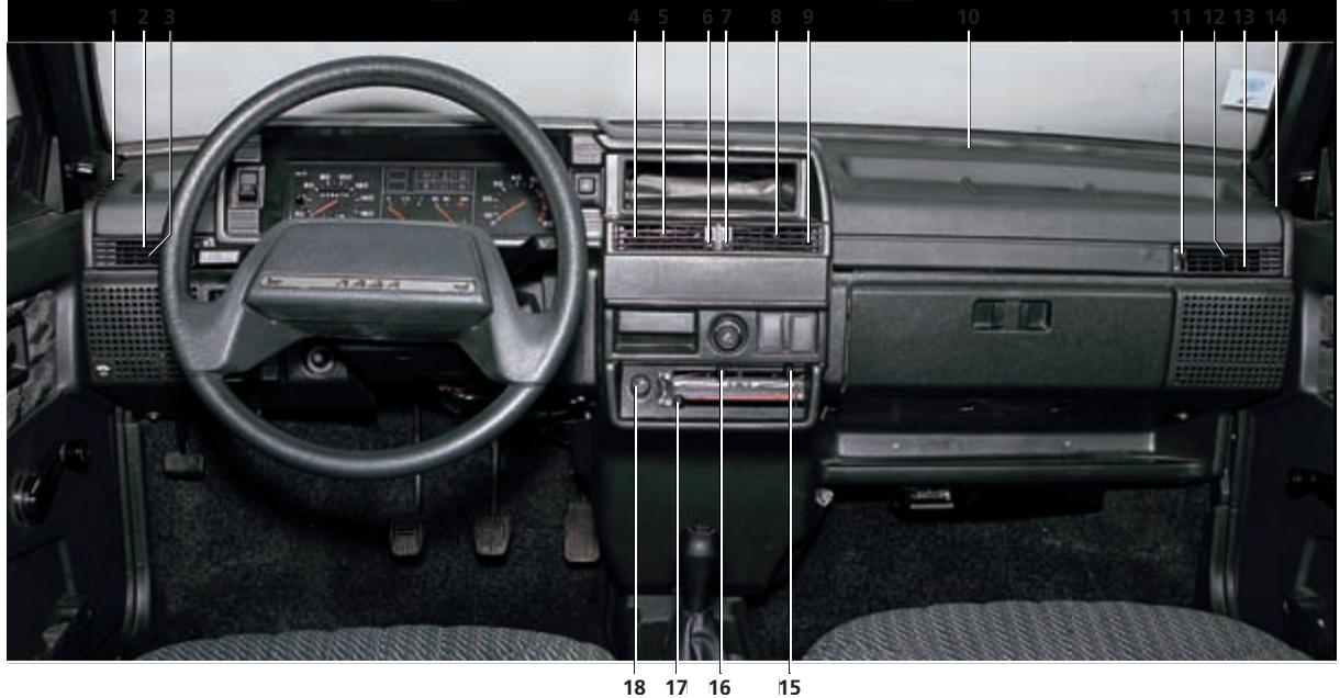
**Система отопления и вентиляции с панелью приборов 21083:** 1, 14 – дефлектор обдува стекла передней двери; 2, 5, 8, 12 – рычаг поворота направляющих лопаток дефлектора; 3, 13 – боковой дефлектор панели приборов; 4, 9 – центральные дефлекторы панели приборов; 10 – дефлектор обдува ветрового стекла; 6, 7, 11 – рычаг заслонки дефлектора; 15, 16 – рычаги распределения воздушных потоков; 17 – рычаг управления краном и заслонкой отопителя; 18 – выключатель электровентилятора отопителя
