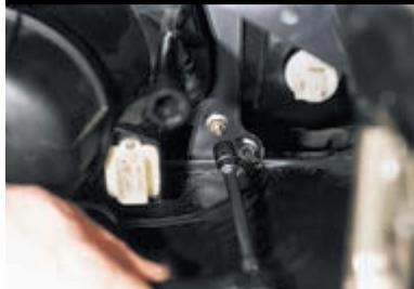
Головкой «на 10» отворачиваем четыре гайки крепления фары...
