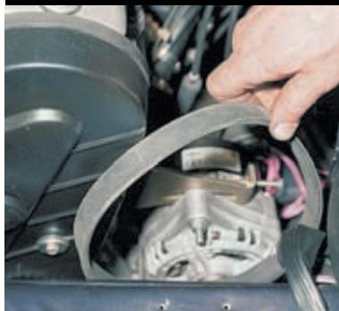
Сдвинув генератор к блоку цилиндров, снимаем ремень. Устанавливаем ремень в обратной последовательности и натягиваем его, вращая регулировочный болт.
