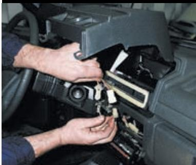
Отсоединив разъемы прикуривателя, его подсветки и лампы подсветки выключателя аварийной сигнализации, снимаем щиток панели приборов.
