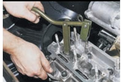
Устанавливаем рассухариватель клапанов.
