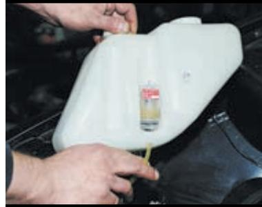
...снимаем шланг подачи жидкости со штуцера.
