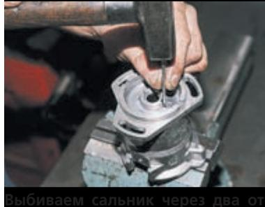
Выбиваем сальник через два отверстия в корпусе.
