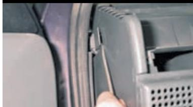
С двух сторон панели приборов поддеваем отверткой и снимаем пластиковые заглушки верхнего крепления.
