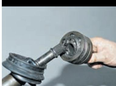
Снимаем шарнир. Шарнир на валу крепится стопорным кольцом, расположенным в проточке на конце вала.
