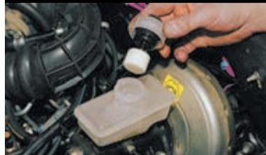
Отворачиваем крышку бачка. Резиновой грушей или шприцом откачиваем из него тормозную жидкость.
