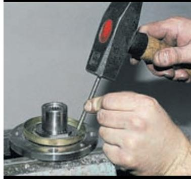
Устанавливаем грязезащитное кольцо и закерниваем его на ступице.
