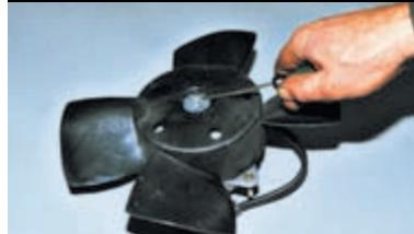
Поддеваем отверткой стопорную шайбу...
