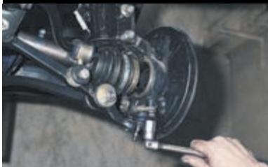
Головкой «на 17» отворачиваем два болта крепления шаровой опоры к поворотному кулаку.
