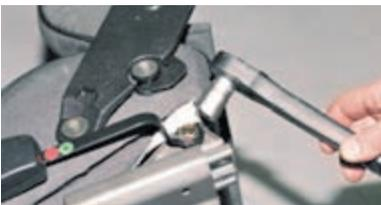
Для снятия замка ремня безопасности головкой «на 17» отворачиваем от сиденья болт крепления (показано на снятом сиденье)...
