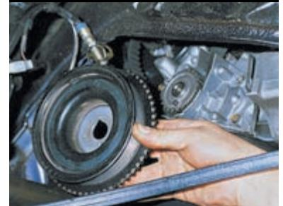
Снимаем шкив привода генератора.
