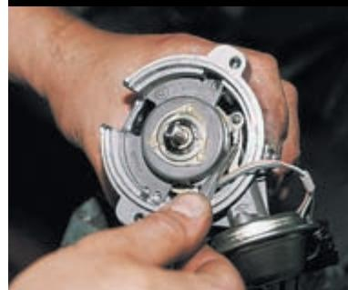
Снимаем стопорную шайбу тяги вакуумного регулятора...
