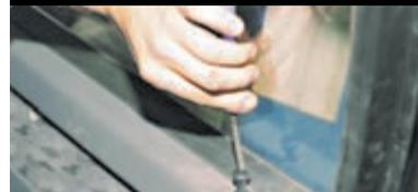
Крестообразной отверткой отворачиваем кнопку блокировки двери...
