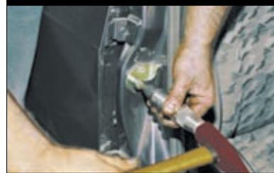
...ударной отверткой отворачиваем специальный винт...
