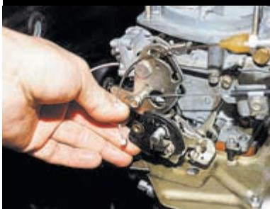
Выводим наконечник троса из прорези сектора привода дроссельных заслонок.
