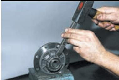
Вставив зубило в зазор между торцом внутреннего кольца подшипника и коробкой дифференциала, наносим удары по зубилу и отодвигаем подшипник.
