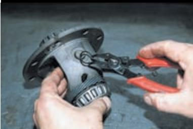
Щипцами снимаем стопорное кольцо с оси сателлитов.
