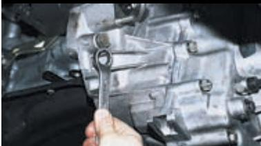
Ключом «на 19» отворачиваем три болта...
