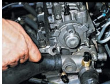
...и две гайки крепления заглушки.
