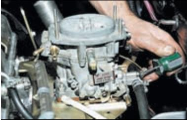
Крестообразной отверткой отворачиваем винт крепления блока подогрева дроссельных заслонок к корпусу карбюратора...
