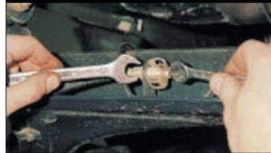
Ключами «на 10» и «на 15» разъединяем шланг и тормозную трубку, закрепленные в проушине балки задней подвески.
