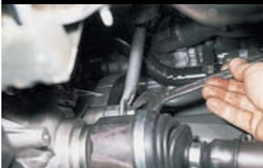
Ключом «на 19» отворачиваем гайку нижнего крепления кронштейна к картеру коробки передач.
