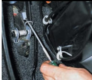
Для снятия педали привода отверткой ослабляем возвратную пружину рычага.
