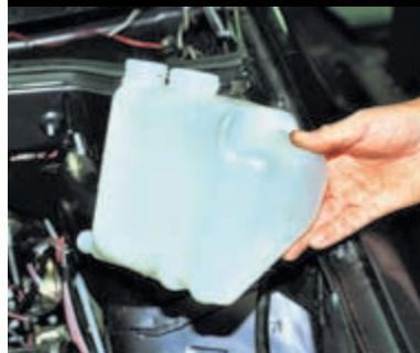
Снимаем расширительный бачок.
