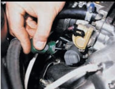
Крестообразной отверткой отворачиваем два винта крепления регулятора к дроссельному узлу.
