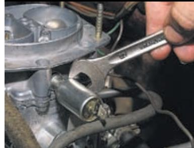
Ключом «на 13» отворачиваем клапан и...
