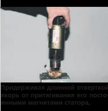
Придерживая длинной отверткой якорь от притягивания его постоянными магнитами статора,
