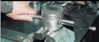
Оправкой выталкиваем поршневой палец и снимаем поршень с верхней головки шатуна.
