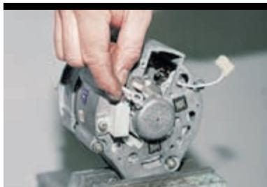
Снимаем клемму и, отвернув крестообразной отверткой винт, демонтируем конденсатор. Остро заточенной чертилкой или краской помечаем взаимное расположение крышек и статора для последующей сборки.
