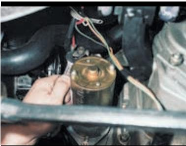
Ключом «на 13» отворачиваем гайку «плюсового» провода стартера...
