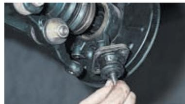
Снимаем шаровую опору.
