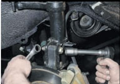
Головкой и ключом «на 19» отворачиваем гайку верхнего болта и выбиваем его выколоткой из мягкого металла.
