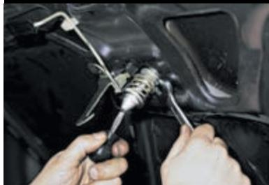
Удерживая отверткой фиксатор капота, ключом «на 19» ослабляем контргайку.
