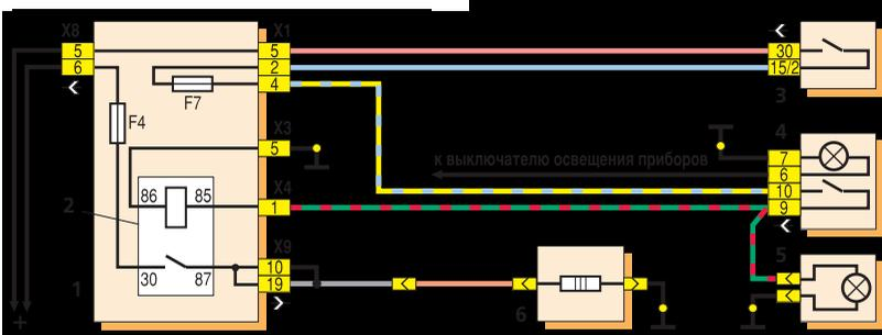
Схема включения элемента обогрева заднего стекла: 1 – монтажный блок; 2 – реле включения обогрева заднего стекла; 3 – выключатель зажигания; 4 – выключатель обогрева заднего стекла; 5 – контрольная лампа обогрева заднего стекла; 6 – элемент обогрева заднего стекла
