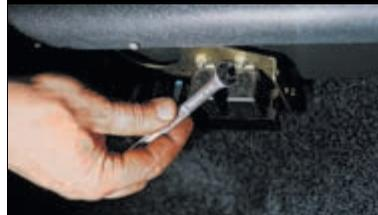
Ключом «на 8» отворачиваем гайку крепления реле системы управления...
