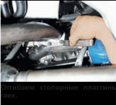
Отгибаем стопорные пластины гаек.
