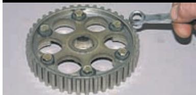
Для того чтобы было удобнее контролировать взаимное положение ступицы и зубчатого венца шкива привода распределительного вала, ключом «на 10» ослабляем затяжку шести болтов и любой из них полностью выворачиваем.
