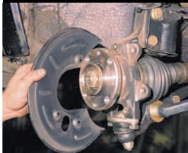
Снимаем защитный кожух.
