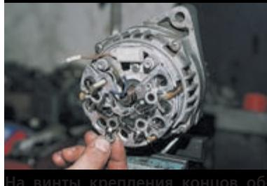
На винты крепления концов обмоток статора надеты изолирующие шайбы.
