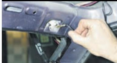
...и снимаем «минусовый» провод.
