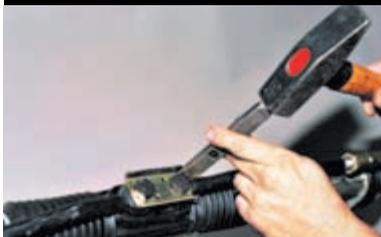
Для снятия рулевых тяг расконтриваем болты, отгибая края стопорной пластины.
