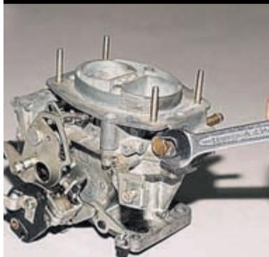
Ключом «на 13» отворачиваем пробку топливного фильтра...
