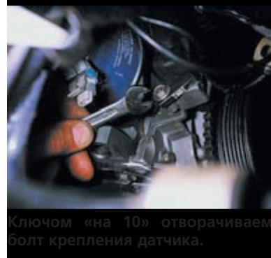
Ключом «на 10» отворачиваем болт крепления датчика.
