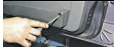
Крестообразной отверткой отворачиваем два самореза кармана двери.
