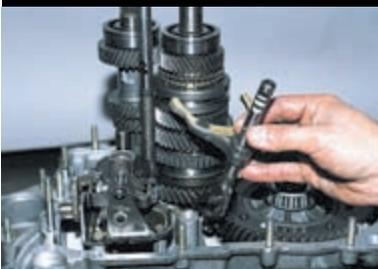
Поднимаем шток вверх и выводим вилку из проточки скользящей муфты синхронизатора.
