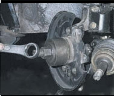
Съемником выпрессовываем подшипник в чашку приспособления, расположенную снаружи поворотного кулака, при этом болт давит на внутреннее кольцо подшипника через шайбу изнутри кулака.
