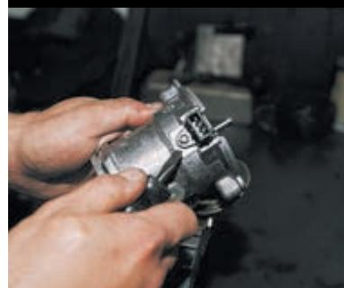
...и винт крепления колодки.
