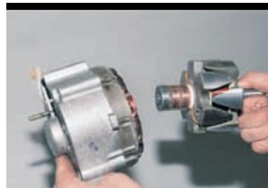
Разъединяем ротор и статор.
