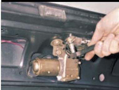
Головкой «на 8» отворачиваем две гайки крепления замка.
