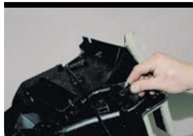
Сжав усики крепежного элемента, снимаем рычаг привода заслонки обогрева ног...
