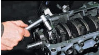
Головкой «на 14» отворачиваем гайку крепления крышки шатуна (шатун при этом должен находиться в НМТ).
