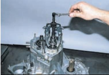
В образовавшийся зазор между торцом заднего подшипника и упорной шайбой вводим лапу съемника...
