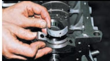
Вынимаем из крышки нижний вкладыш коренного подшипника.
