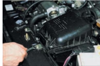
Ключом «на 8» отворачиваем два болта крепления кронштейнов передних опор корпуса фильтра.
