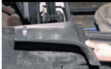
Отворачиваем два самореза крепления нижней накладки средней стойки и снимаем накладку.
