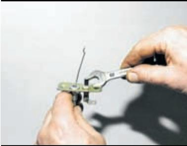
Ключом «на 11» отворачиваем выключатель...
