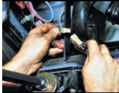
Отсоединяем разъем электровентилятора и жгут проводов от кожуха электровентилятора.
