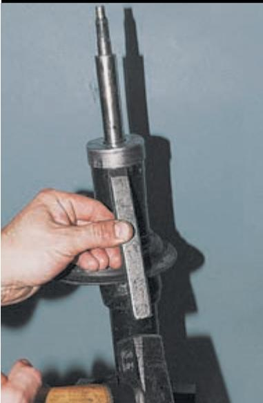
Зубилом сбиваем опору буфера сжатия.
