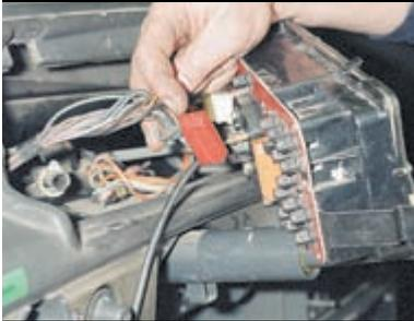
Отсоединяем разъемы проводов от комбинации приборов.
