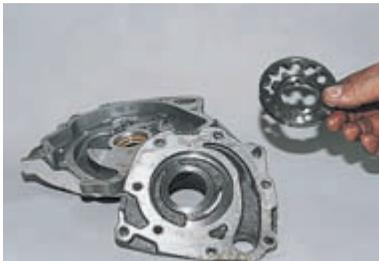
Снимаем корпус насоса и извлекаем ведомую и ведущую шестерни.
