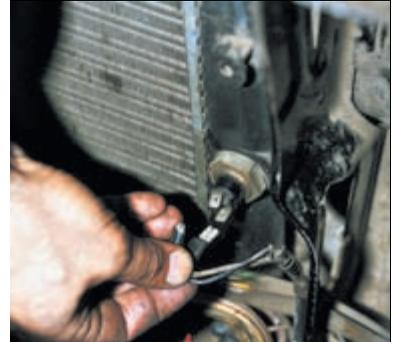
Отсоединяем провода от датчика включения электровентилятора.
