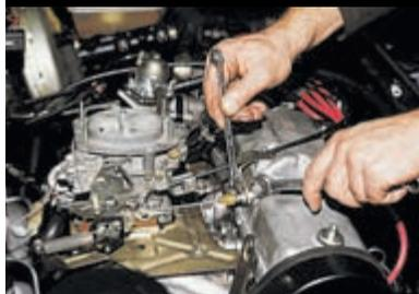
Двумя ключами «на 13» ослабляем гайки крепления оболочки троса привода заслонок к кронштейну.
