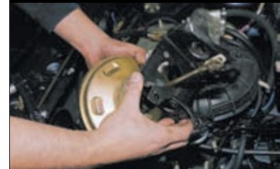
...и отсоединяем вакуумный усилитель.
