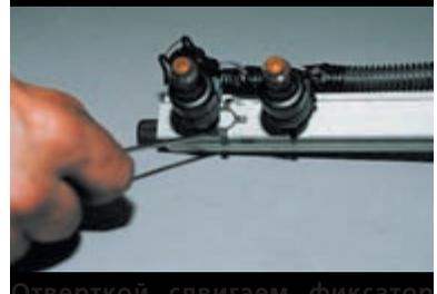
Отверткой сдвигаем фиксатор форсунки вдоль рамп.
