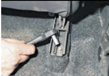
...отворачиваем два болта задних креплений салазок.
