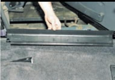
Снимаем накладки порогов передних дверей.
