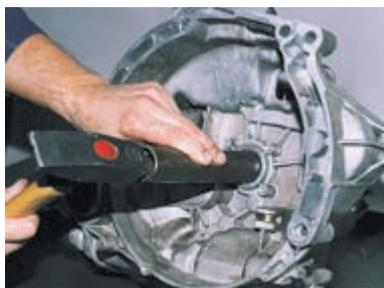
Новый сальник запрессовываем подходящим отрезком трубы. Глубина запрессовки сальника от торца гнезда картера сцепления должна составлять  $3,5 \pm 0,2$  мм. Замена сальника штока выбора передач приведена в разделе «Разборка и сборка коробки передач».
