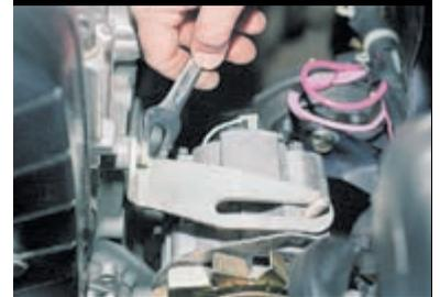
Ключом «на 13» отворачиваем болт крепления натяжной планки...
