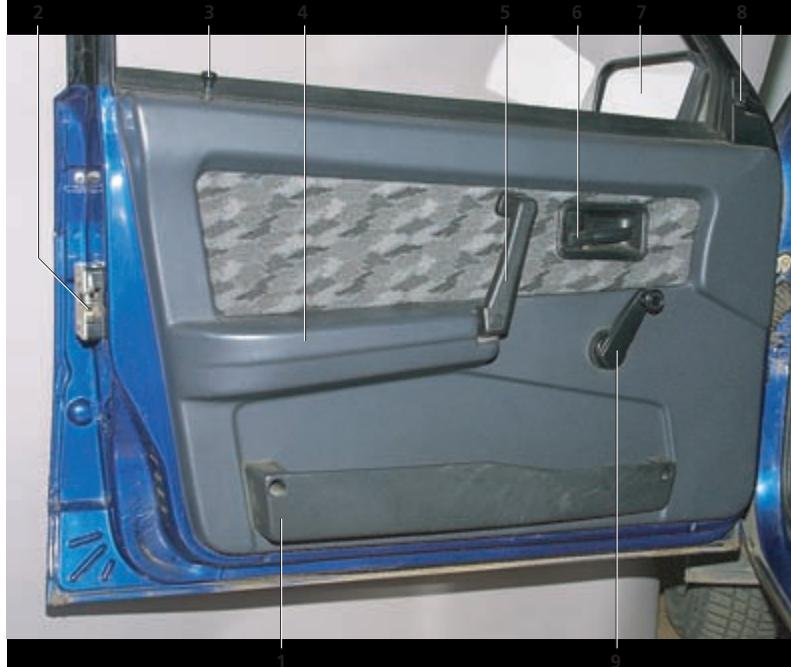
**Передняя дверь:** 1 – карман для мелких вещей; 2 – замок двери; 3 – кнопка блокировки замка; 4 – подлокотник; 5 – ручка двери; 6 – внутренняя ручка замка двери; 7 – наружное зеркало заднего вида; 8 – ручка регулировки положения наружного зеркала; 9 – ручка стеклоподъемника
