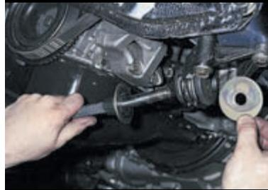
...снимаем шайбу и вынимаем растяжку из сайлент-блока.
