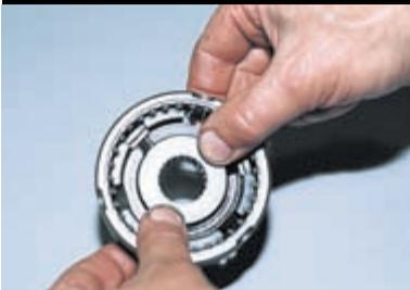
Сдвигаем ступицу внутри скользящей муфты синхронизатора...
