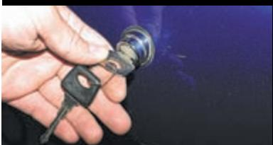
...вставляем ключ в личинку замка и поворачиваем его по часовой стрелке на 90°.
