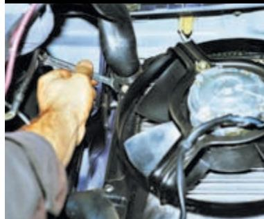
Ключом «на 10» отворачиваем два болта крепления электровентилятора к левому бачку...
