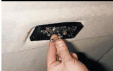
Вынимаем лампу. Для снятия плафона...
