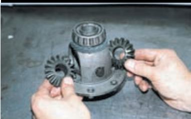
Проворачивая, вынимаем из коробки шестерни приводов (полуосевые).
