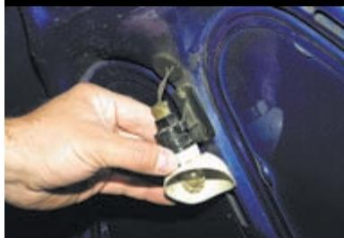
Поворачивая колпачок лампы, можно изменять направление пучка света.
