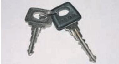
В состав каждого комплекта входит ключ зажигания (большей длины с пластмассовой рукояткой) и ключ для замков передних дверей и крышки багажника (или двери задка).
