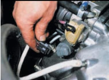
Выключив зажигание, отсоединяем разъем регулятора.
