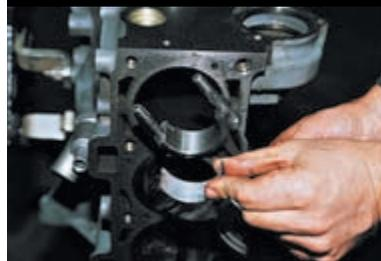
Вынимаем верхний вкладыш подшипника из головки шатуна.
