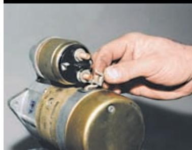
Снимаем наконечник провода.
