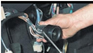
...крестообразной отверткой отворачиваем саморез,
