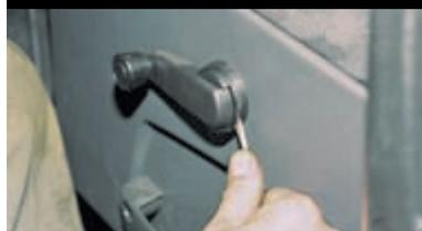
Поддеваем отверткой защелку ручки стеклоподъемника (отвертку вставляем между защелкой и шайбой).
