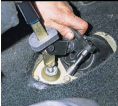
Головкой «на 13» отворачиваем пять болтов крепления к кузову прижимной пластины привода.
