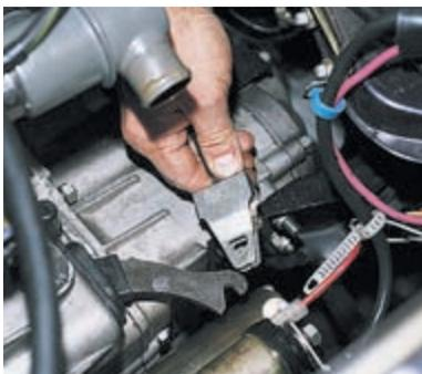
Выводим поводок троса из вилки выключения сцепления.
