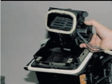
...и снимаем вентилятор.
