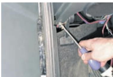
Крестообразной отверткой отворачиваем по одному саморезу нижнего крепления панели с левой...
