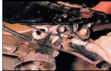
Вынимаем шланг из проушины кронштейна крепления балки задней подвески к кузову.
