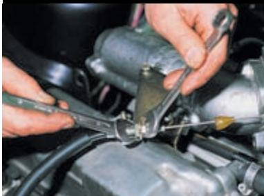
Двумя ключами «на 13» ослабляем гайки крепления оболочки троса привода заслонки к кронштейну.
