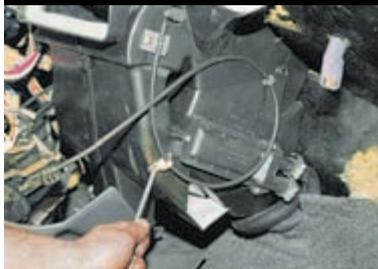
С правой стороны отопителя крестообразной отверткой отворачиваем саморез крепления пластикового хомута тяги заслонки обогрева стекла.
