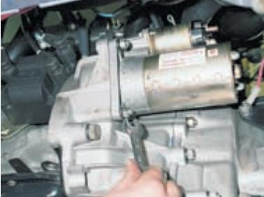
Ключом «на 13» отворачиваем три гайки крепления стартера к картеру сцепления.
