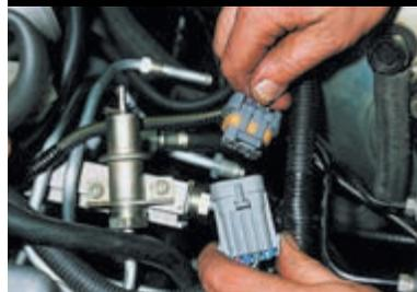
Отсоединяем электрический разъем рамп.
