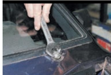
Ключом «на 24» отворачиваем гайку.
