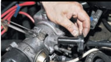
Вынимаем теплоизоляционную проставку с толкателем.
