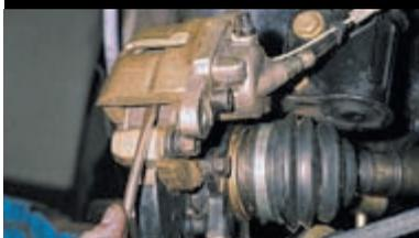
Поддев отверткой, поднимаем суппорт с цилиндром вверх.
