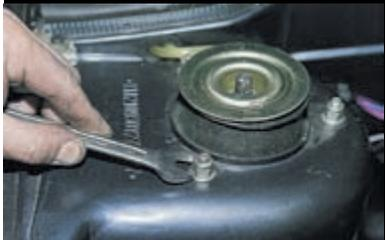
Ключом «на 13» отворачиваем три гайки крепления верхней опоры к кузову...
