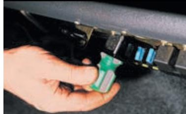
Крестообразной отверткой отворачиваем два самореза нижнего крепления кронштейна блока к журнальной полке,
