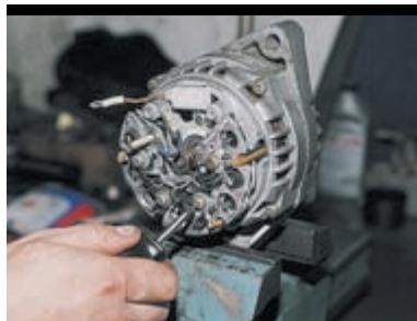
Крестообразной отверткой отворачиваем винт крепления выпрямительного блока и три винта крепления концов обмоток статора.
