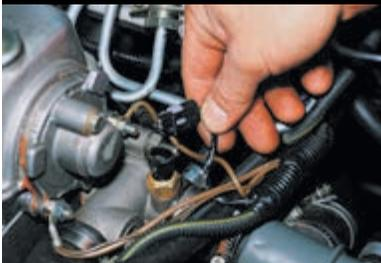
Выключив зажигание, отсоединяем разъем датчика.
