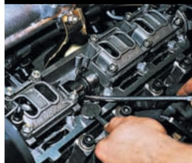
Вынимаем пинцетом регулировочную шайбу.
