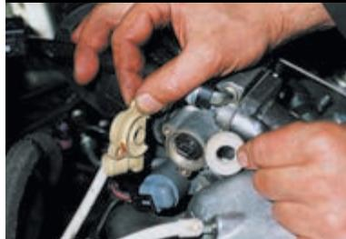
...и снимаем датчик с прокладкой.
