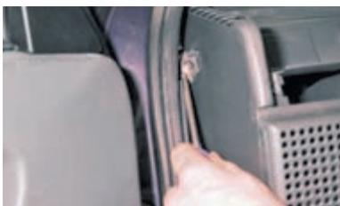
Крестообразной отверткой отворачиваем с каждой стороны по одному саморезу верхнего крепления панели.
