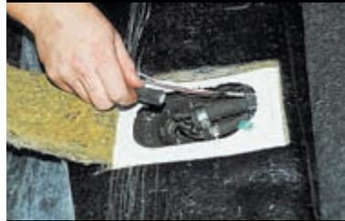
Отсоединяем разъем датчика уровня топлива.
