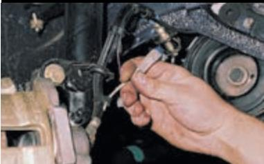
Вынимаем провод датчика из резиновых колец, охватывающих тормозной шланг.
