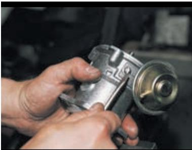
...и отворачиваем два винта его крепления.
