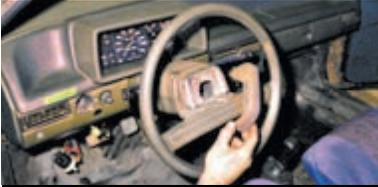
Снимаем накладку звукового сигнала.
