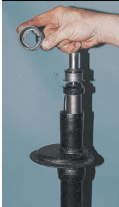
Снимаем ее и вынимаем шток с рабочим цилиндром.
