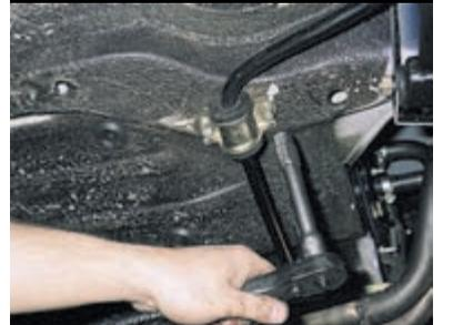
Головкой «на 13» отворачиваем гайки крепления скоб подушек...
