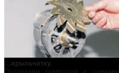
...крыльчатку. Поддеваем отверткой и снимаем сегментную шпонку...
