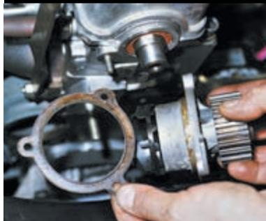
...и снимаем его уплотнительную прокладку.
