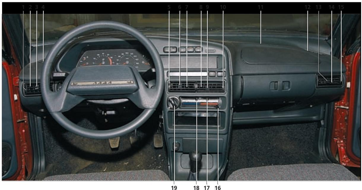
**Система отопления и вентиляции с панелью приборов 2114:** 1, 5, 10, 15 – рычаг заслонки дефлектора; 2, 14 – боковой дефлектор панели приборов; 3, 6, 9, 13 – рычаг поворота направляющих лопаток дефлектора; 4, 12 – дефлекторы обдува стекол передних дверей; 7, 8 – центральные дефлекторы панели приборов; 16 – рычаг управления краном и заслонкой отопителя; 17, 18 – рычаги распределения воздушных потоков; 19 – выключатель электровентилятора отопителя
