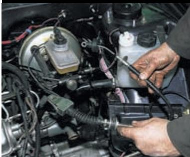
Вынимаем трос сцепления через отверстие в щитке передка кузова. Установку троса сцепления проводим в обратной последовательности, предварительно смазав поводок троса смазкой Литол-24.
