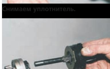
Сдвигаем по валу привод с рычагом.
