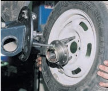
...и резким ударом снимаем ступицу.
