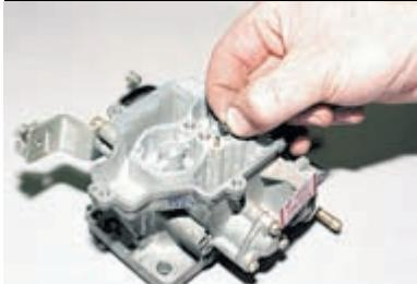
Заменяем резиновое уплотнительное кольцо на трубке канала системы холостого хода.
