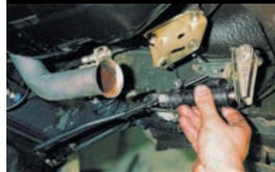
Снимаем регулятор давления и рычаги его привода.
