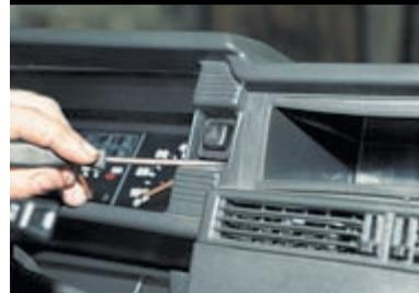
Поддев отверткой, вынимаем выключатель аварийной сигнализации.
