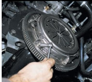
Головкой «на 8» отворачиваем шесть болтов крепления кожуха сцепления к маховику.
