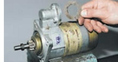
Соединение тягового реле и передней крышки уплотнено прокладкой.
