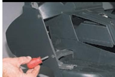
Крестообразной отверткой отворачиваем два самореза крепления кронштейна правой поперечины.
