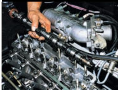
Немного отведя от головки блока цилиндров заднюю крышку ремня привода ГРМ, снимаем распределительный вал.
