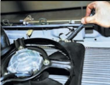
Головкой «на 8» отворачиваем две гайки прижимной пластины...
