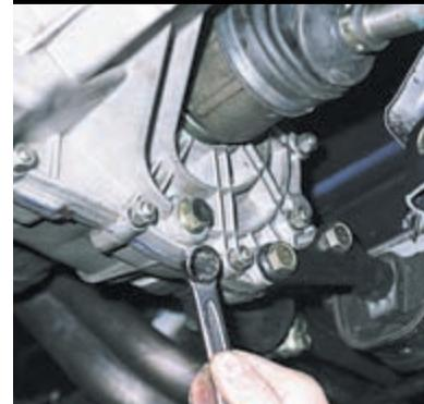
Ключом «на 17» отворачиваем пробку... и сливаем масло в емкость (объемом 4 л).
