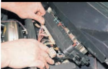
Приподнимаем монтажный блок и отсоединяем четыре разъема спереди...
