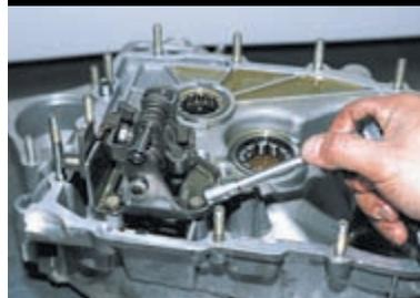
Головкой «на 10» отворачиваем три болта крепления механизма выбора передач...
