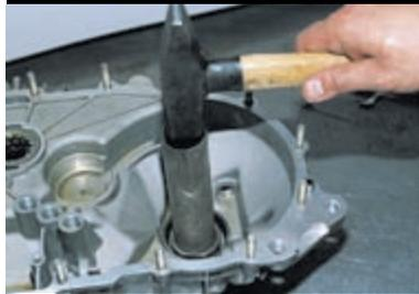
Подходящим отрезком трубы выбиваем из картера сцепления...
