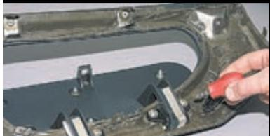
Крестообразной отверткой отворачиваем четыре самореза крепления петель крышки верхнего вещевого ящика...
