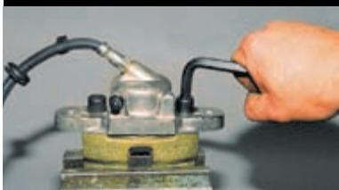
Зажав суппорт в тиски с накладками из мягкого металла, шестигранником «на 10» отворачиваем два винта крепления цилиндра к суппорту.
