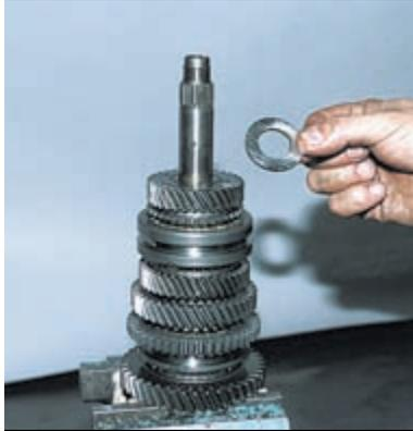
Снимаем упорную шайбу,
