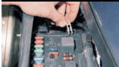
Для замены предохранителя вынимаем щипцы...
