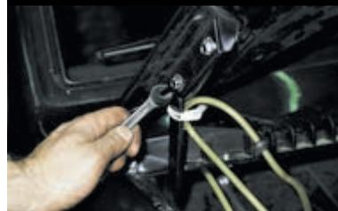
Ключом «на 10» отворачиваем болты крепления капота к петлям...
