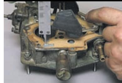
...проверяем их ход, который при измерении по нижнему углу поплавка должен составлять 15 мм. Для регулировки хода...
