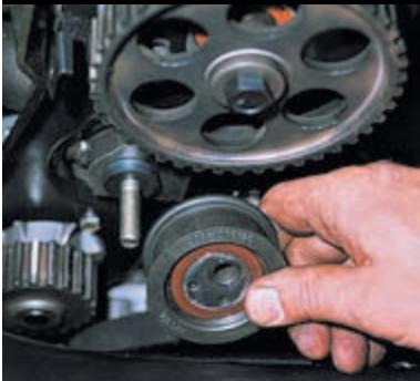
При замене натяжного ролика отворачиваем гайку его крепления и снимаем ролик со шпильки.
