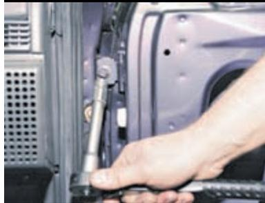
Головкой «на 13» отворачиваем два болта крепления петель двери к кузову.
