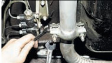
...двумя ключами «на 13» отворачиваем два болта хомута.
