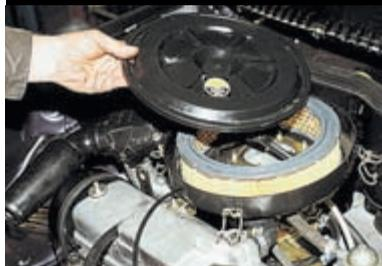
Снимаем крышку фильтра.
