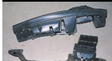
Отсоединяем от панели приборов ее накладку с корпусом верхнего вещевого ящика.
