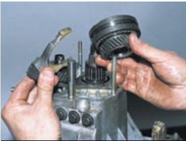
Вынимаем вилку включения пятой передачи.
