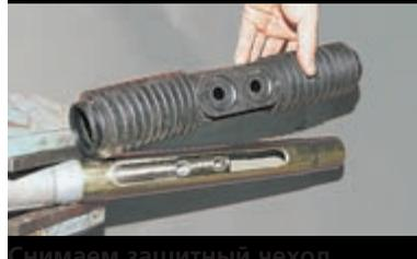
Снимаем защитный чехол.
