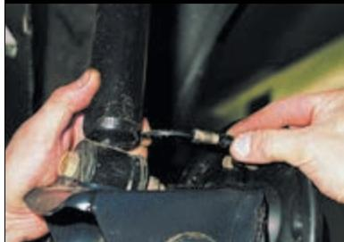
Во избежание потерь жидкости, надеваем на конец трубки защитный колпачок штуцера прокачки.
