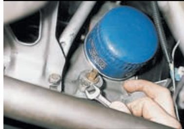
Ключом «на 10» отворачиваем болт крепления датчика.
