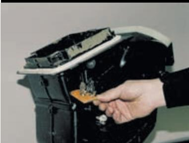
...снимаем резистор электродвигателя (резистор можно заменить, не снимая отопителя).
