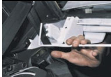
Отсоединяем торсионы петель крышки багажника.
