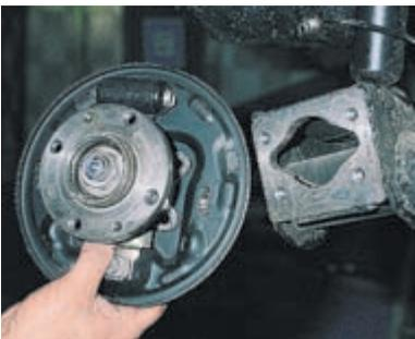
Снимаем ось ступицы вместе с щитом тормозного механизма.
