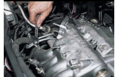
Ключом «на 13» отворачиваем две гайки крепления к ресиверу кронштейна топливных трубок.
