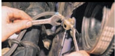
Придерживая ключом «на 15» наконечник тормозного шланга, ключом «на 10» отворачиваем штуцер трубки.
