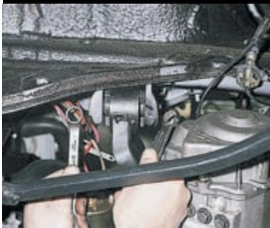
Двумя ключами «на 17» отворачиваем гайку болта крепления опоры к кузову.
