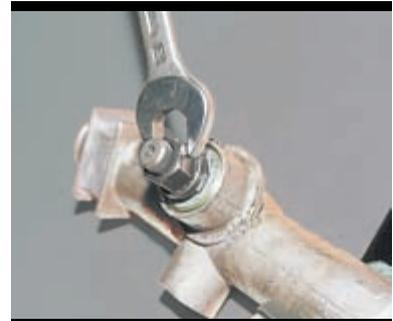
Отворачиваем гайку крепления подшипника шестерни...
