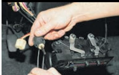
Для снятия переключателя пинцетом отворачиваем пластиковую гайку крепления к кронштейну
