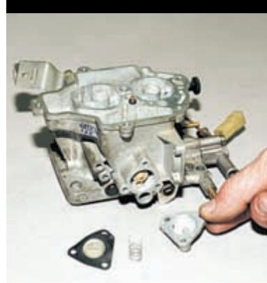
...вынимаем пружину и диафрагму.
