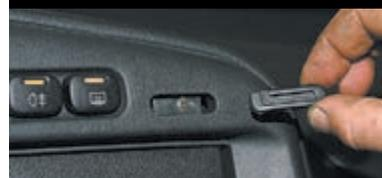
...и вынимаем заглушку справа от выключателя обогрева заднего стекла.
