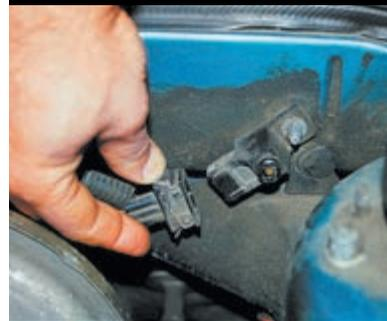
Отсоединяем разъем СО-потенциометра.
