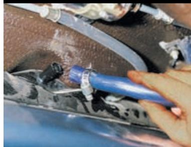
Отсоединяем шланг наливной трубы...
