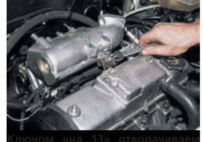
Ключом «на 13» отворачиваем гайку крепления ресивера к кронштейну...
