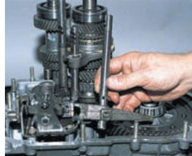
Приподнимаем шток вверх и выводим вилку из зацепления.
