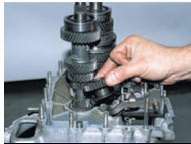
Вынимаем промежуточную шестерню заднего хода.
