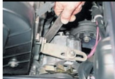
Натягиваем ремень, сдвигая генератор монтажной лопаткой...
