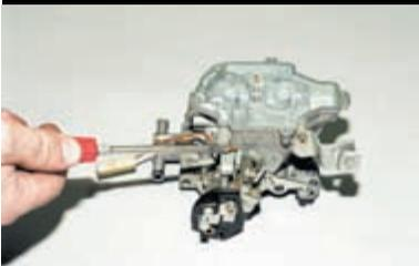
Шлицевой отверткой отворачиваем винт пластмассового держателя провода...
