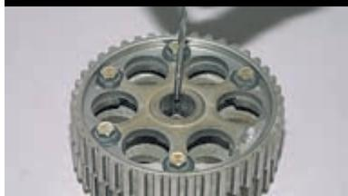
Для совмещения шпоночных пазов можно воспользоваться в качестве направляющей сверлом диаметром 4 мм.
