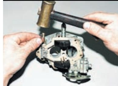
Через выколотку диаметром 2,5 мм молотком выбиваем ось поплавков.
