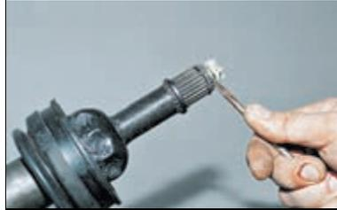
Поддеваем отверткой пластмассовый упор...
