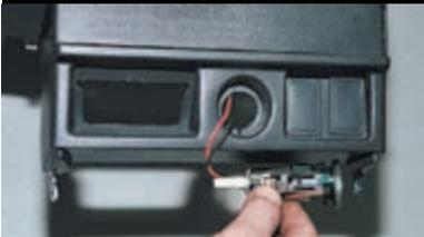
...выдвигаем его наружу и вынимаем из накладки панели приборов.
