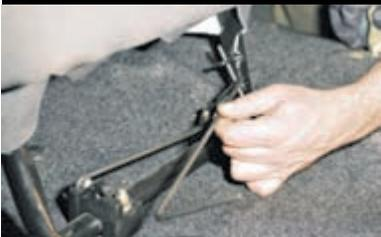
Выводим торсионы из кронштейнов и снимаем их.
