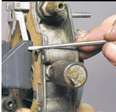
...линия от пресс-формы на боковой поверхности поплавков параллельна привалочной плоскости крышки.
