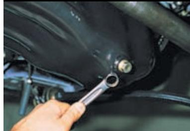
Накидным ключом «на 17» отворачиваем пробку сливного отверстия поддона картера...
