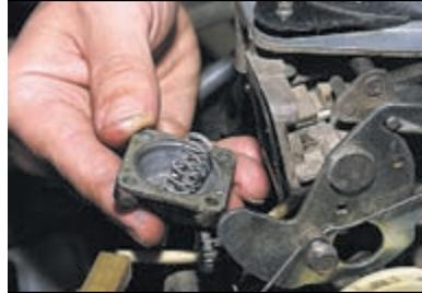
Снимаем крышку с пружиной.
