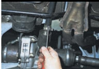
Отверткой разводим концы хомута и сдвигаем его назад по тяге.
