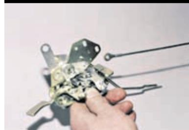
...отсоединяем тягу внутреннего привода.
