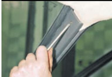
Крестообразной отверткой отворачиваем саморезы крепления накладок передних стоек...
