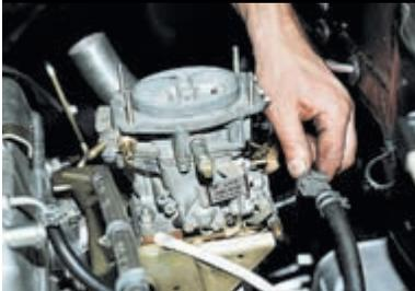
...и отсоединяем блок подогрева со шлангами от карбюратора.
