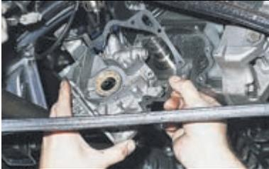
Поддев отверткой прилив крышки, снимаем масляный насос и уплотнительную прокладку.
