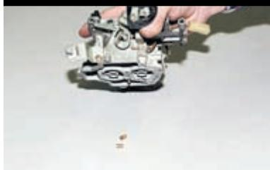
На снятом карбюраторе главные топливные жиклеры можно просто вытряхнуть из колодцев, перевернув корпус.
