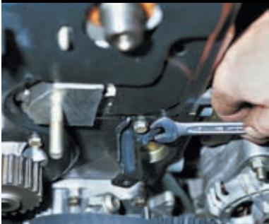
...и болт крепления задней крышки ремня привода ГРМ.
