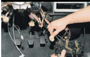
Отсоединяем разъем от переключателя электродвигателя вентилятора (для наглядности панель приборов снята).
