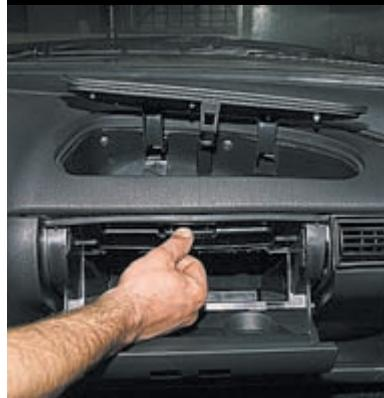
Нажатием рычажка, расположенного в верхней части нижнего ящика, открываем крышку верхнего ящика.
