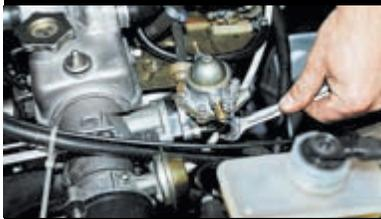
Ключом «на 13» отворачиваем две гайки крепления насоса к корпусу вспомогательных агрегатов.
