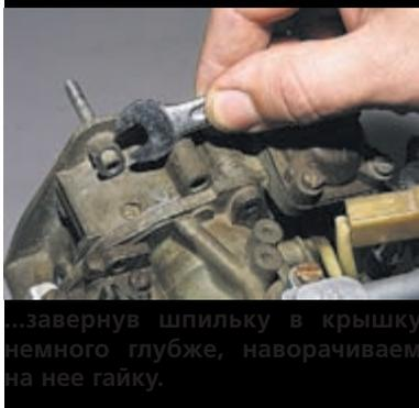
...завернув шпильку в крышку немного глубже, наворачиваем на нее гайку.
