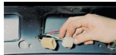
Отсоединяем разъем электропитания мотора стеклоочистителя.
