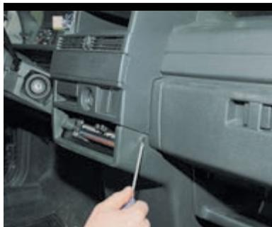
Крестообразной отверткой отворачиваем два самореза крепления накладки консоли панели приборов...
