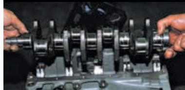
Вынимаем коленчатый вал.
