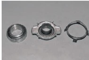
...и снимаем подшипник с фланца муфты.
