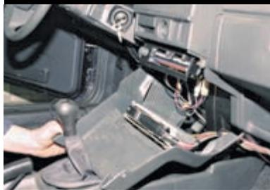
...и отсоединив разъем жгута проводов от контроллера, снимаем накладку консоли.
