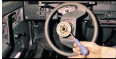
Для замены контактного кольца крестообразной отверткой отворачиваем три винта...
