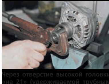
Через отверстие высокой головки «на 21» (удерживаемой трубным ключом) вставляем шестигранный ключ «на 8» и отворачиваем гайку.
