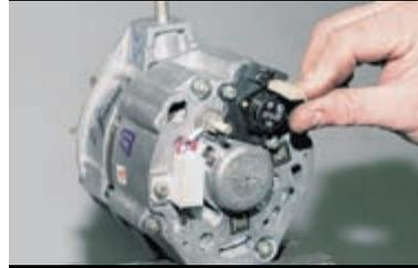
Отсоединяем провод от регулятора напряжения.
