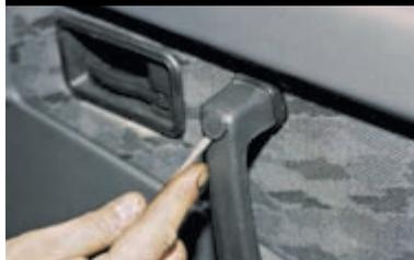
Отверткой поддеваем две заглушки ручки двери.
