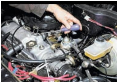
Крестообразной отверткой ослабляем хомут крепления шланга вентиляции картера на патрубке крышки головки блока и снимаем шланг.
