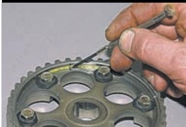
Для контроля перемещения частей шкива при регулировке наносим на боковые поверхности зубчатого венца и ступицы метки «нулевого» положения.
