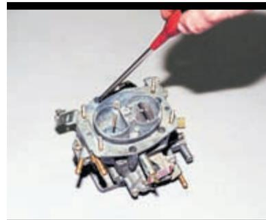
Крестообразной отверткой отворачиваем пять винтов крепления крышки...
