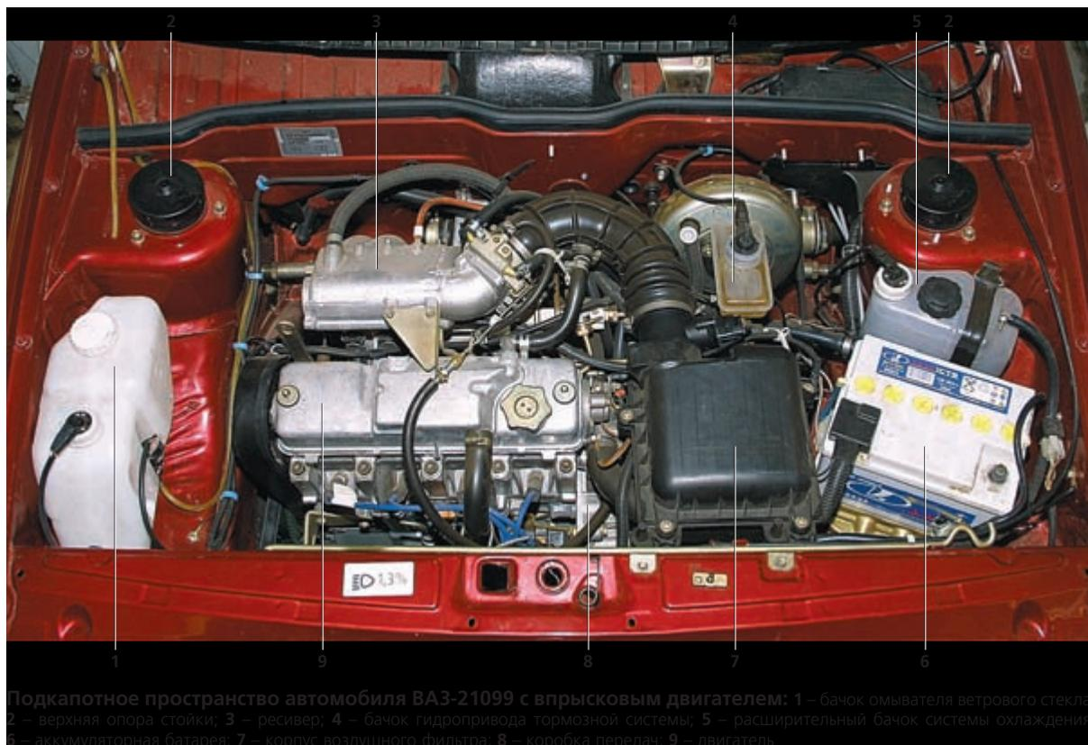
Подкапотное пространство автомобиля ВАЗ-21099 с впрысковым двигателем: 1 – бачок омывателя ветрового стекла; 2 – верхняя опора стойки; 3 – ресивер; 4 – бачок гидропривода тормозной системы; 5 – расширительный бачок системы охлаждения; 6 – аккумуляторная батарея; 7 – корпус воздушного фильтра; 8 – коробка передач; 9 – двигатель
