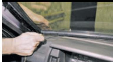
...перетягиваем край уплотнителя через ребро проема.
