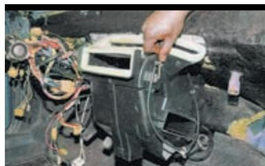
Освобождаем скобу крепления к кожуху отопителя оболочки тяги заслонки обогрева ветрового стекла.
