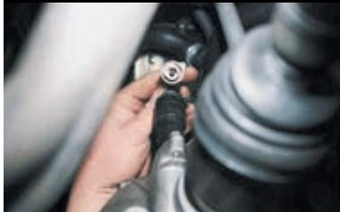
Отворачиваем накидную гайку троса спидометра от датчика скорости (на автомобиле с двигателем -2111) или от редуктора спидометра (на автомобиле с карбюраторным двигателем).
