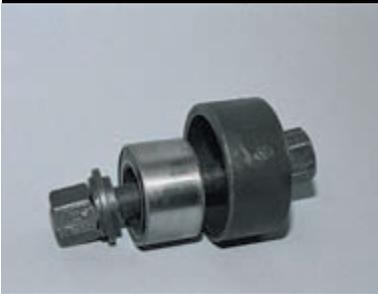
Подшипник и съемник. Практически всегда при выпрессовке ступицы на ней остается кольцо подшипника, которое трудно снять из-за плотной посадки на ступице.
