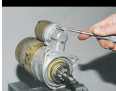
Отворачиваем три винта крепления тягового реле.
