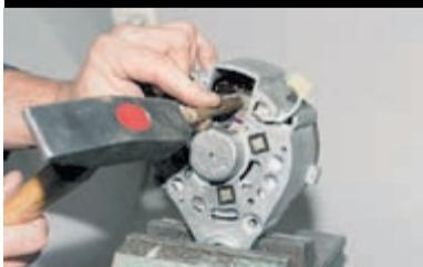
При затруднении в снятии ротора постукиваем по его торцу выколоткой из мягкого металла через окно регулятора напряжения.
