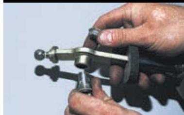
Для замены втулок оси вынимаем их из бобышки рычага.
