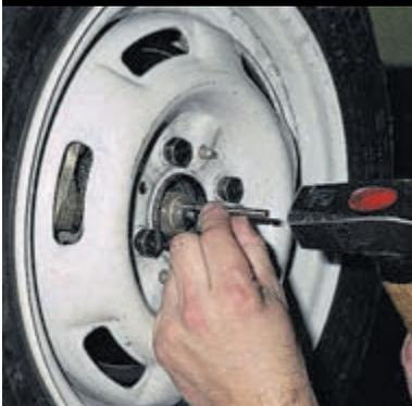
Узким зубилом расправляем мягкий буртик гайки подшипника ступицы в двух местах.
