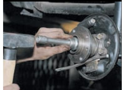
Осторожно, легкими ударами по внутреннему кольцу напрессовываем подшипник на ось ступицы до глубины, позволяющей надеть гайку.
