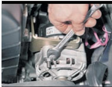
...ключом «на 13» ослабляем гайку крепления генератора к установочной планке.
