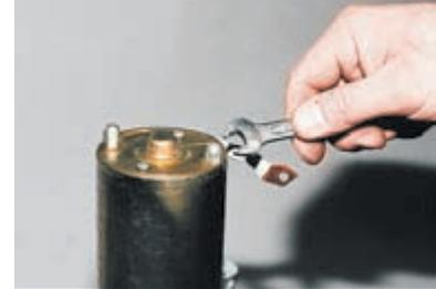
Ключом «на 10» отворачиваем две гайки стяжных шпилек.
