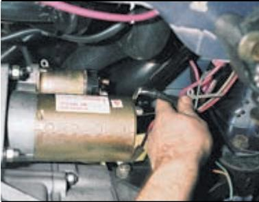
...и снимаем провод.
