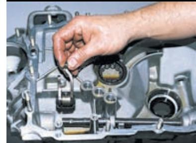
Снимаем рычаг выбора передач со штока.
