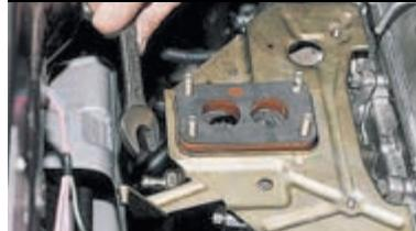
Ключом «на 22» ослабляем гайку крепления теплозащитного экрана.
