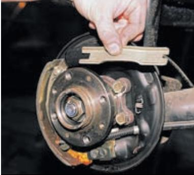
Снимаем разжимную планку.
