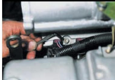
Шестигранником «на 5» отворачиваем два винта крепления рамп.
