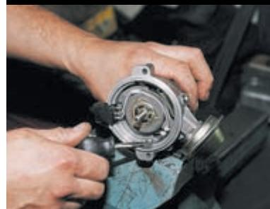
Отворачиваем два винта крепления держателя переднего подшипника...
