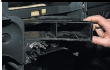
Вынимаем из гнезда панели приборов промежуточный корпус центральных сопел системы отопления и вентиляции.
