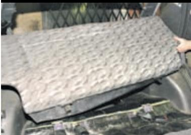
Снимаем спинку сиденья вместе с ковром пола багажного отсека.
