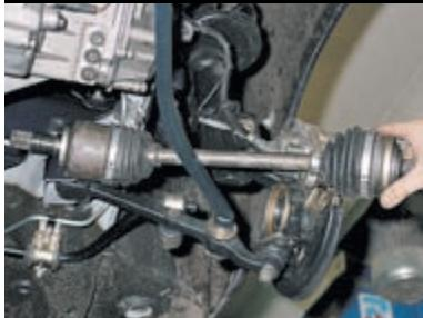
Выпрессовываем корпус внутреннего шарнира и снимаем левый привод.
