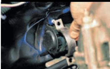
Снимаем скобы крепления рулевого механизма.
