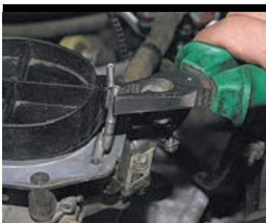
...пассатижами выворачиваем шпильку из крышки.
