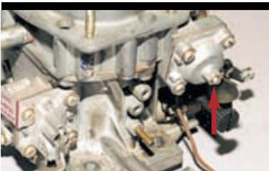
Для регулировки зазора ключом «на 8» ослабляем контргайку винта, расположенного на крышке пускового устройства. Вставив в прорезь (по стрелке) шлицевую отвертку, отворачиваем (для увеличения зазора) или заворачиваем (для уменьшения зазора) винт, после чего затягиваем контргайку.
