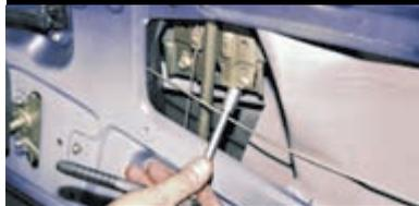
Головкой «на 10» отворачиваем два болта крепления стекла к механизму стеклоподъемника.
