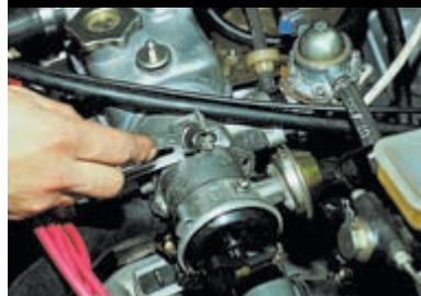
Ключом «на 10» отворачиваем гайку верхнего крепления датчика-распределителя...
