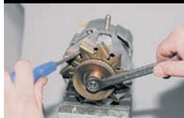
Ключом «на 19» отворачиваем гайку шкива генератора. Ротор от проворачивания можно застопорить отверткой.
