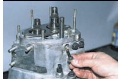
Вынимаем из гнезд пружины и шарики фиксаторов.
