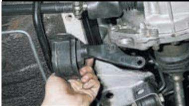
Вынимаем болты и снимаем заднюю опору. Установку опоры проводим в обратной последовательности.
