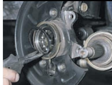
Щипцами снимаем стопорное кольцо.
