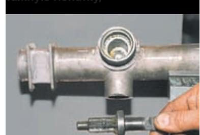
...вынимаем из картера шестерню в сборе с подшипником,
