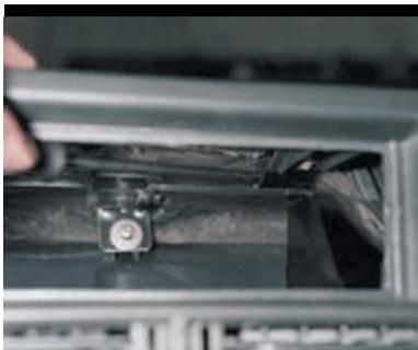
Через гнездо радиоприемника отжимаем отверткой две (из трех) пружинные скобы крепления щитка к накладке панели и тянем щиток на себя.
