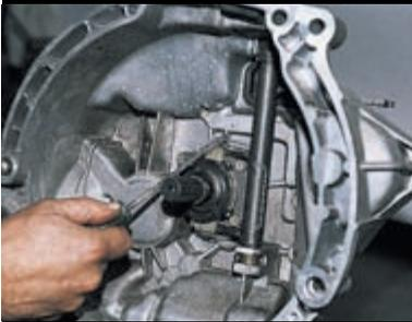
...отверткой отводим концы пружины...
