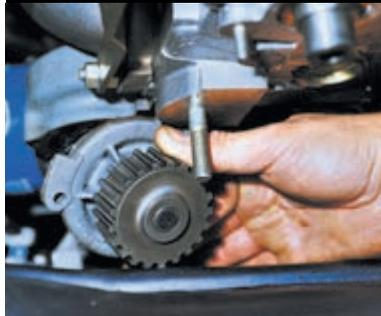
Вынимаем насос охлаждающей жидкости...
