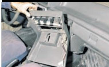
Отсоединив разъемы прикуривателя и подсветки прикуривателя, снимаем накладку консоли.
