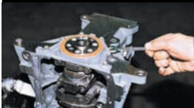
Ключом «на 10» отворачиваем шесть болтов крепления держателя заднего сальника коленчатого вала.
