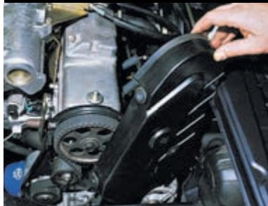
Снимаем крышку ГРМ. Для регулирования натяжения ремня поворачиваем коленчатый вал против часовой стрелки так, чтобы метка на шкиве распределительного вала переместилась вниз от усика задней крышки на два зуба.
