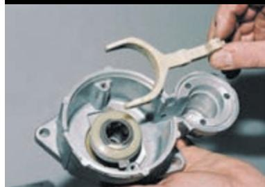
...снимаем рычаг привода.
