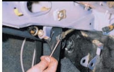
Отверткой снимаем стопорную скобу пальца толкателя...
