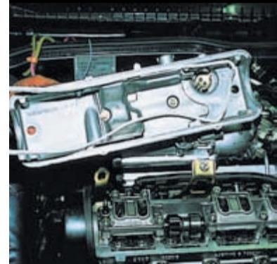
Снимаем крышку с прокладкой. Снимаем переднюю крышку ремня привода ГРМ (см. «Проверка натяжения и замена ремня привода газораспределительного механизма», с. 34). Порядок проверки и регулировки зазоров в механизме привода клапанов следующий.
