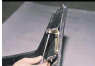
Крестообразной отверткой отворачиваем два самореза крепления к бамперу бокового кронштейна...
