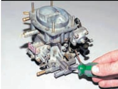
...крестообразной отверткой отворачиваем винт его крепления...
