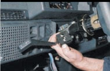
...и, сжав пальцами фиксаторы (сверху и снизу), снимаем левый подрулевой переключатель.
