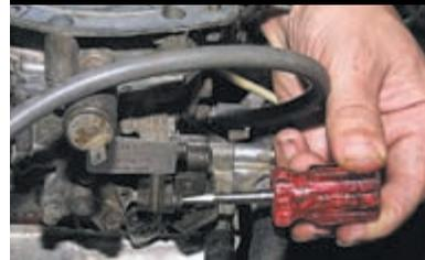
Отверткой отворачиваем четыре винта крепления крышки ускорительного насоса.
