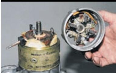
Снимаем заднюю крышку.
