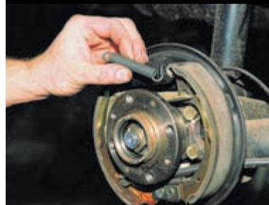
...и вынимаем пружину.
