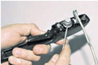
Поддев отверткой, снимаем пружину личинки.
