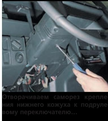
Отворачиваем саморез крепления нижнего кожуха к подрулевому переключателю...
