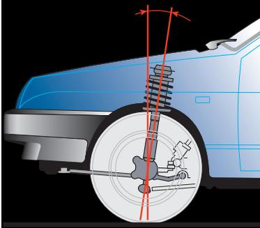
Рис. 1. Угол продольного наклона оси поворота колеса
