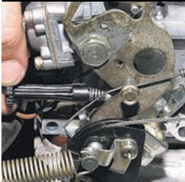
...выворачиваем и заменяем винт новым.
