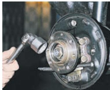
Головкой «на 30» отворачиваем гайку.
