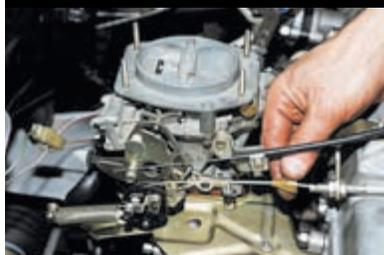
Сдвигаем защитный силиконовый колпачок вдоль троса.
