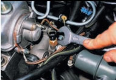
Ключом «на 19» отворачиваем датчик температуры охлаждающей жидкости.
