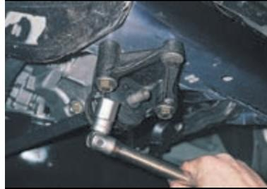
Для замены кронштейна крепления растяжки головкой «на 17» отворачиваем три болта...
