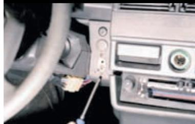
Крестообразной отверткой отворачиваем два винта крепления кронштейна рукоятки привода заслонки.
