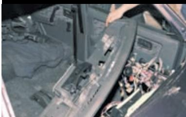
...и снимаем панель. Устанавливаем панель приборов в обратной последовательности.
