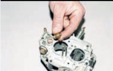
Вынимаем игольчатый клапан и уплотнительное медное кольцо. Снимаем электромагнитный клапан (см. «Снятие и проверка электромагнитного клапана», с. 74) и топливный фильтр (см. «Снятие топливного фильтра карбюратора», с. 74).
