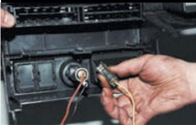
Для замены лампы подсветки прикуривателя сжимаем усики держателя патрона и снимаем его с прикуривателя.
