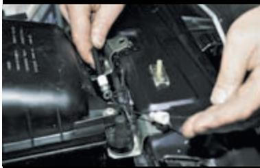
Выводим трос привода замка из крепления.
