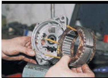
Статор от передней крышки также отделяем отверткой.
