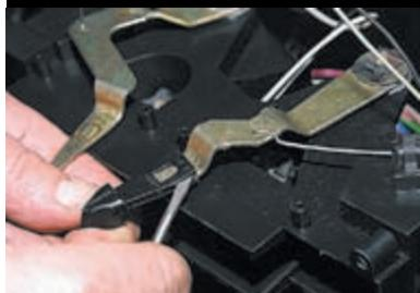
Вводим лезвие отвертки между рукояткой и рычагом со стороны, противоположной выступу на рукоятке.
