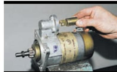
Вынимаем якорь тягового реле.
