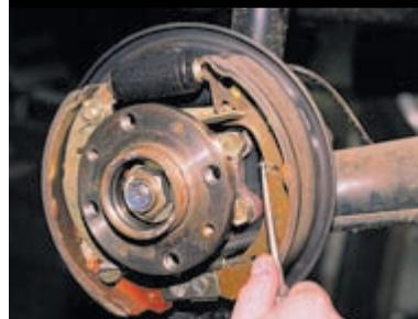
Отверткой выводим из зацепления с колодкой направляющую пружину.
