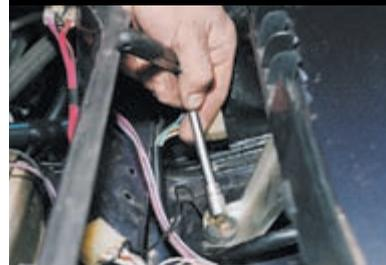
Головкой «на 10» отворачиваем болт крепления стеклоочистителя к кузову.
