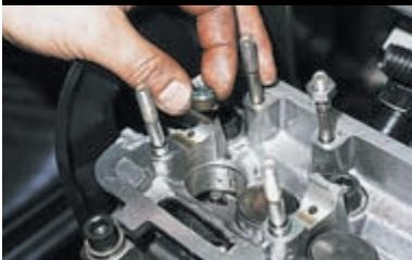
...снимаем маслоотражательный колпачок с направляющей втулки клапана.
