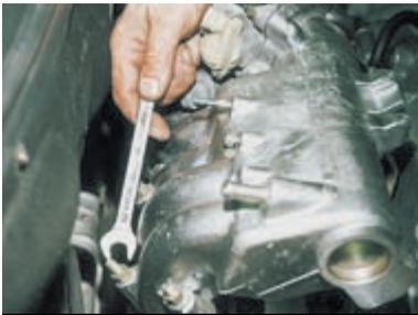
...и пять гаек крепления к впускному коллектору.
