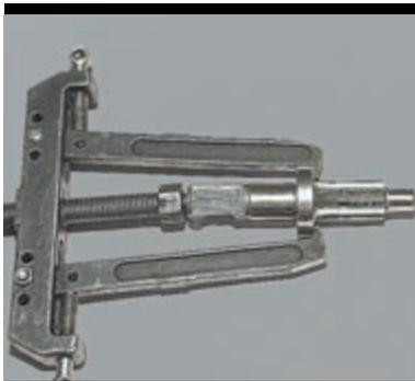
...и двухлапым съемником выпрессовываем шариковый подшипник.
