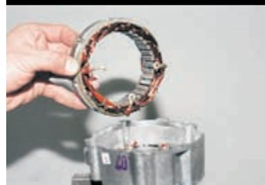
Поддеваем отверткой и снимаем статор.
