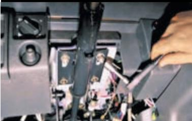
Головкой «на 13» отворачиваем две гайки заднего крепления кронштейна вала рулевого управления.
