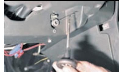
Вытянув на себя, отсоединяем рукоятку от троса привода воздушной заслонки карбюратора.
