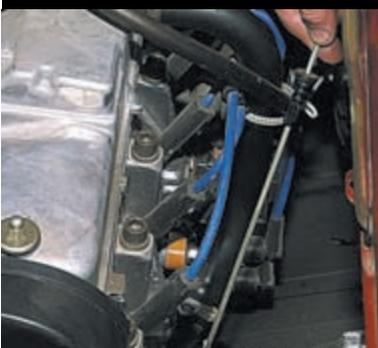
...извлекаем из направляющей трубки указатель уровня масла (щуп).
