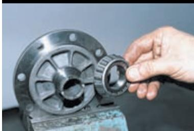
...спрессовываем подшипник. Сборку коробки передач проводим в обратной последовательности.
