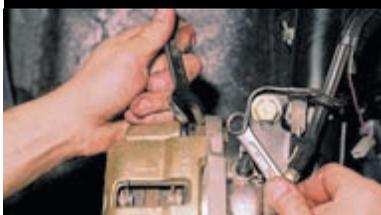
Для снятия колесного цилиндра расконтриваем и ключами «на 13» и «на 17» отворачиваем два болта крепления цилиндра к направляющим пальцам.
