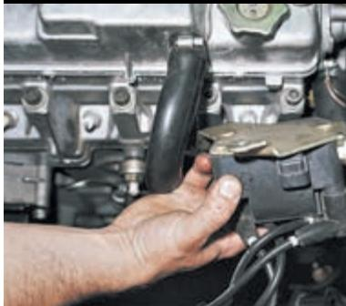
...и вынимаем модуль зажигания с высоковольтными проводами.
