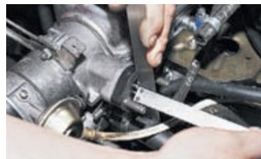
Перед установкой насоса измеряем минимальную величину выступания толкателя (при проворачивании коленчатого вала) от торцевой плоскости теплоизоляционной проставки.
