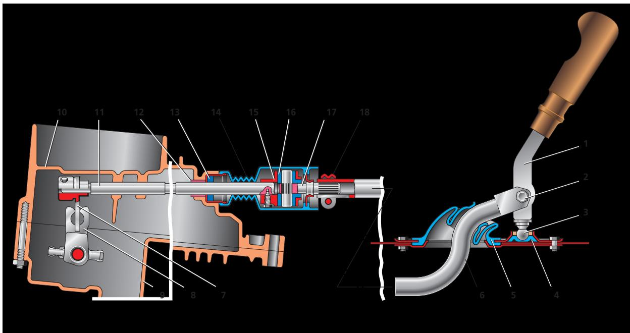
**Привод переключения передач:** 1 – рычаг переключения передач; 2 – ось рычага; 3 – палец рычага переключения передач; 4 – шаровая опора рычага; 5 – защитный чехол тяги; 6 – тяга привода переключения передач; 7 – рычаг штока выбора передач; 8 – рычаг выбора передач; 9 – картер коробки передач; 10 – картер сцепления; 11 – шток выбора передач; 12 – втулка штока; 13 – сальник штока; 14 – защитный чехол; 15 – корпус шарнира; 16 – втулка шарнира; 17 – наконечник шарнира; 18 – хомут
