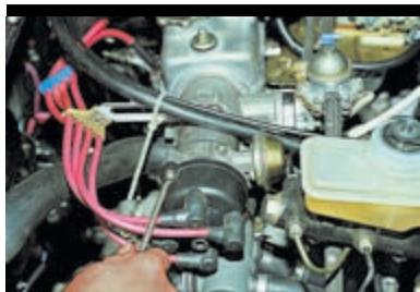
Крестообразной отверткой отворачиваем два винта крепления крышки...
