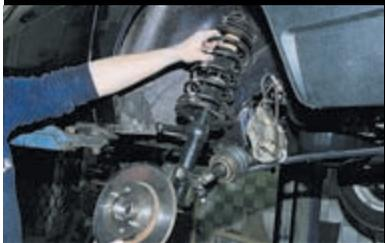
...и снимаем амортизаторную стойку вместе с поворотным кулаком.
