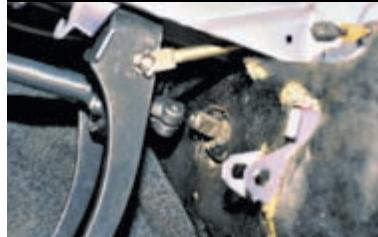
Стягиваем вал со шлицев приводной шестерни...
