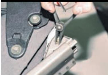
Снимаем стопорную шайбу втулки крепления внутренних салазок к сиденью.
