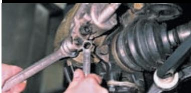
Придерживая рожковым ключом «на 17» направляющий палец, ключом «на 13» отворачиваем нижний болт...
