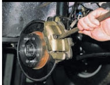
Опираясь подходящим металлическим стержнем (или монтажной лопаткой) о диск, вдавливаем поршень.
