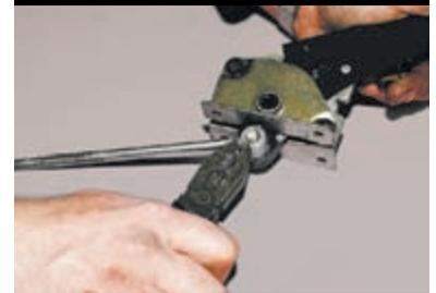
Расшплинтовываем ось регулировочной тяги.
