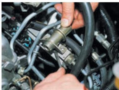
Поддеваем регулятор отверткой...
