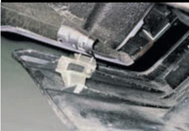
Выводим с обеих сторон шпильки кронштейнов бампера из отверстий кронштейнов кузова...
