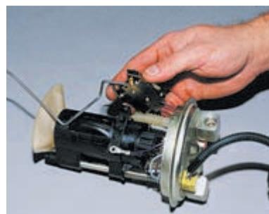
...и отсоединяем указатель уровня топлива.
