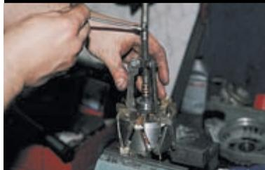
Подшипник спрессовываем съемником.
