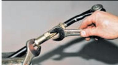
На снятой рулевой тяге ключом «на 27» отворачиваем контргайку внутреннего наконечника, удерживая муфту ключом «на 24» (резьба на внутреннем наконечнике правая).
