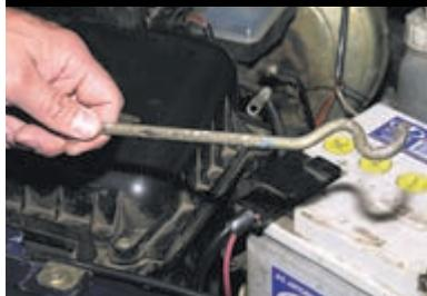
Поднимаем упор капота...
