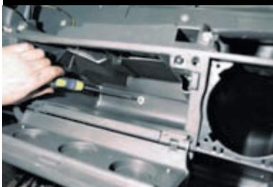
Открыв крышку вещевого ящика, крестообразной отверткой отворачиваем еще один саморез крепления панели приборов...
