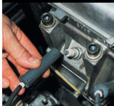
Снимаем наконечник высоковольтного провода со свечи зажигания.
