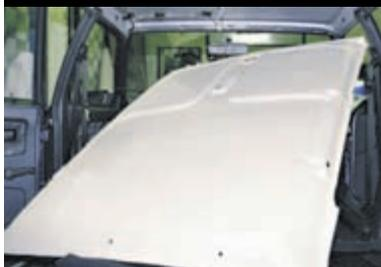
Выводим обивку из-под верхних накладок центральных стоек и вынимаем ее.
