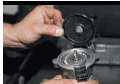
Снимаем защитный экран.
