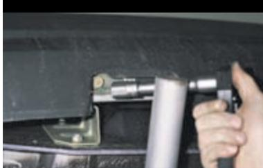
Головкой «на 17» отворачиваем снизу болты заднего крепления бампера с левой...
