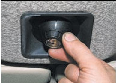
Поворотом тубуса вокруг оси включаем плафон индивидуального освещения.
