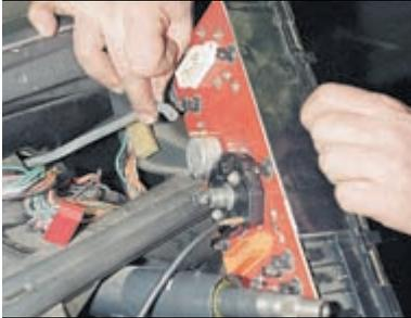
Снимаем шланг со штуцера спидометра.
