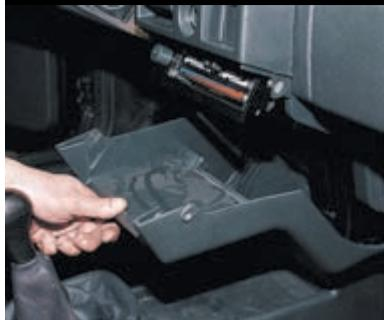
...и снимаем накладку.
