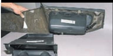
...и отсоединяем корпус нижнего вещевого ящика вместе с крышкой от панели приборов.
