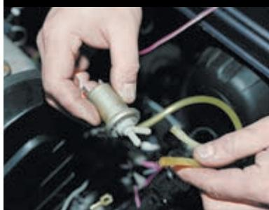
Снимаем с клапана трубки. Трубки стеклоомывателя удобно надевать на штуцеры, разогрев их пламенем зажигалки.
