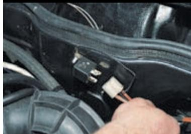
Отсоединяем разъем от реле.
