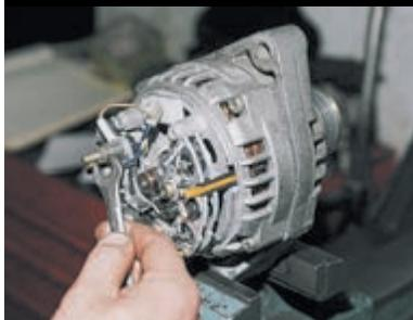
Ключом «на 10» отворачиваем гайку,
