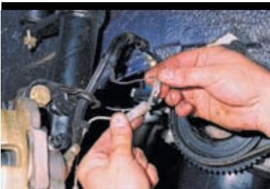
Отсоединяем от проводки автомобиля электрический разъем датчика.
