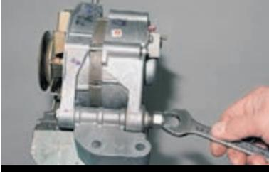
Ключом «на 19» отворачиваем гайку болта крепления генератора к кронштейну.
