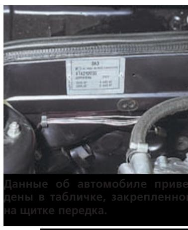
Данные об автомобиле приведены в табличке, закрепленной на щитке передка.
