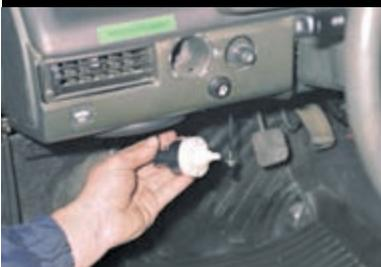
...извлекаем гидрокорректор из панели приборов.
