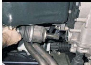
...выталкиваем корпус внутреннего шарнира из коробки передач.
