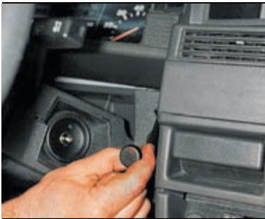
...и вынимаем его из гнезда панели приборов, пропустив по очереди разъемы проводов через отверстие.
