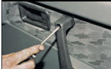
Крестообразной отверткой отворачиваем два винта крепления...
