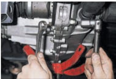
Немного опустив упор, ключом и головкой «на 19» отворачиваем гайки двух болтов крепления кронштейна опоры к коробке передач.
