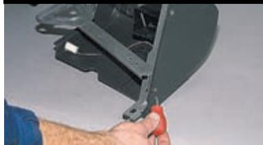
...и два самореза левого крепления поперечины.
