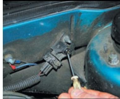
Вращая винт потенциометра, регулируем содержание СО (по показаниям газоанализатора).
