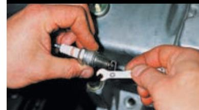
Круглым щупом проверяем зазор между электродами.
