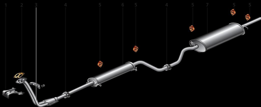
Система выпуска отработавших газов: 1 – кронштейн крепления приемной трубы; 2 – прокладка; 3 – приемная труба; 4 – хомут соединения труб глушителей; 5 – подушка подвески глушителей; 6 – дополнительный глушитель; 7 – основной глушитель
