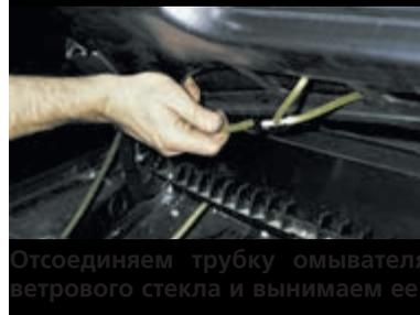
Отсоединяем трубку омывателя ветрового стекла и вынимаем ее.
