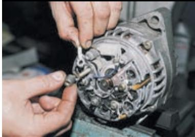
...снимаем втулку и провод конденсатора.
