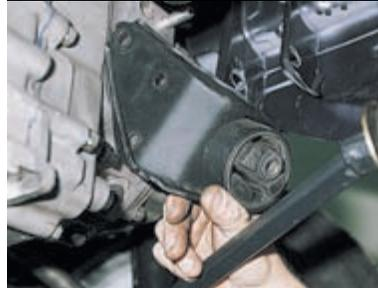
...и снимаем опору. Устанавливаем опору в обратной последовательности.
