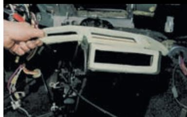
...снимаем отопитель в сборе с вентилятором.
