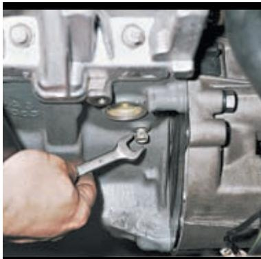
Ключом «на 13» отворачиваем пробку сливного отверстия на передней части блока цилиндров и сливаем в емкость жидкость из рубашки охлаждения двигателя. Для доступа к пробке на блоке цилиндров двигателя ВАЗ-2111 необходимо демонтировать модуль зажигания (см. «Снятие модуля зажигания двигателя ВАЗ-2111», с. 104). По окончании слива жидкости заворачиваем пробки.
