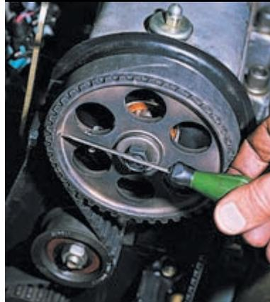
...до совмещения метки на зубчатом шкиве распределительного вала с установочным усиком на задней крышке привода ГРМ.
