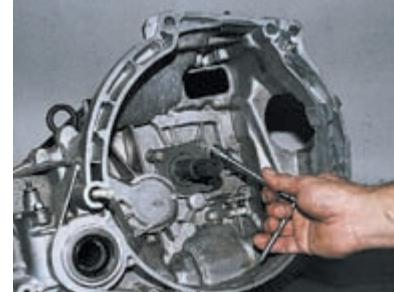
Головкой «на 10» отворачиваем три болта крепления направляющей втулки муфты выключения сцепления...
