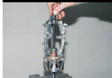
Подшипник демонтируем съемником, а новый напрессовываем подходящим отрезком трубы, передавая усилие через внутреннее кольцо.
