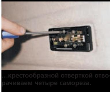
...крестообразной отверткой отворачиваем четыре самореза.
