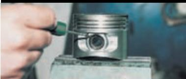
Поддеваем отверткой стопорное кольцо поршневого пальца и извлекаем его из кольцевой канавки поршня.
