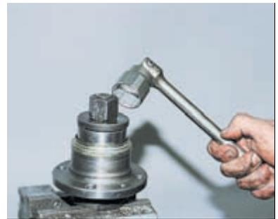
Новый подшипник в очищенную и смазанную ступицу запрессовываем съемником...
