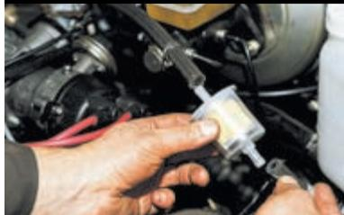
Снимаем топливный фильтр.
