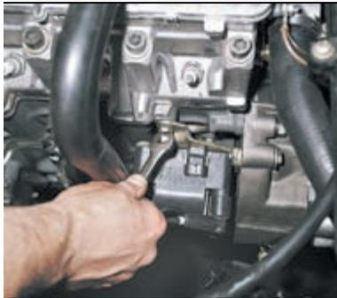
Ключом «на 13» отворачиваем болты крепления кронштейна модуля зажигания к блоку цилиндров...
