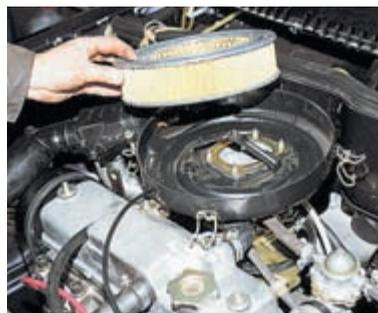
Вынимаем сменный элемент воздушного фильтра.
