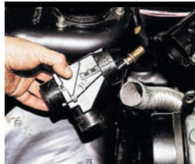
...и снимаем терморегулятор, отсоединив гофрированный шланг заборника горячего воздуха. Устанавливаем терморегулятор в обратной последовательности.
