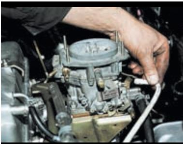
Снимаем шланг подвода разрежения к вакуумному регулятору опережения зажигания.
