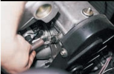
Отсоединяем провод от датчика.
