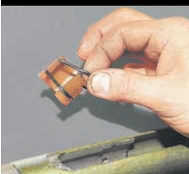
Перед установкой в картер новой опорной втулки надеваем на нее новые демпфирующие кольца так, чтобы тонкая их часть находилась против разреза втулки. Устанавливаем втулку, следя за тем, чтобы ее выступы вошли в отверстие картера.
