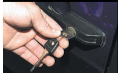
Для отпирания двери вставляем ключ в личинку замка и поворачиваем его вперед (по ходу автомобиля).
