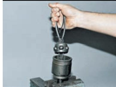
Вынимаем сепаратор с обоймой и шариками.
