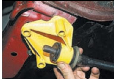
Надеваем кронштейн на растяжку... и крепим его болтами к нижней поперечине рамки радиатора.
