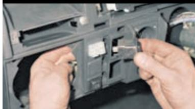
Отсоединяем разъемы от выключателей обогрева заднего стекла и заднего противотуманного света...
