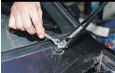
Ключом «на 10» отворачиваем гайку крепления поводка стеклоочистителя.
