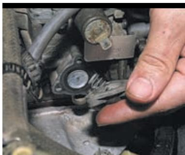
Снимаем крышку с пружиной.
