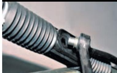
Вынимаем рулевые тяги.
