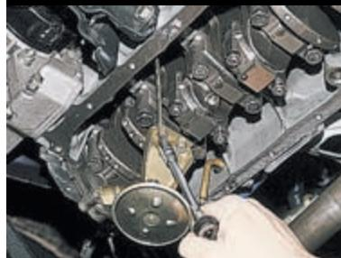
Головкой «на 10» отворачиваем два болта крепления маслоприемника ко второй коренной крышке.
