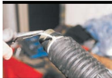
Устанавливаем на место защитный чехол и закрепляем его хомутами.
