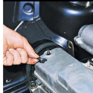
В отверстиях клапанной крышки установлены резиновые уплотнительные втулки.
