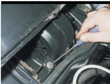
Крестообразной отверткой отворачиваем два винта крепления вентилятора к корпусу отопителя. Вытягиваем провода электродвигателя сквозь резиновый уплотнитель.
