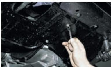
Отворачиваем два самореза, соединяющих левую и правую части брызговика двигателя.
