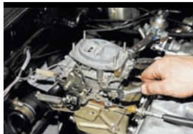
Ключом «на 8» ослабляем болт крепления прижимной скобы оболочки тяги...
