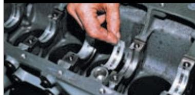
Вынимаем из опор в блоке цилиндров верхние вкладыши коренных подшипников коленчатого вала.
