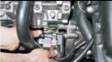
Поддев отверткой, отсоединяем разъем модуля зажигания.
