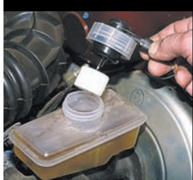
...не отсоединяя колодку проводов от датчика уровня тормозной жидкости, отворачиваем пробку заливной горловины (датчик уровня установлен в пробке) и снимаем ее вместе с поплавком.
