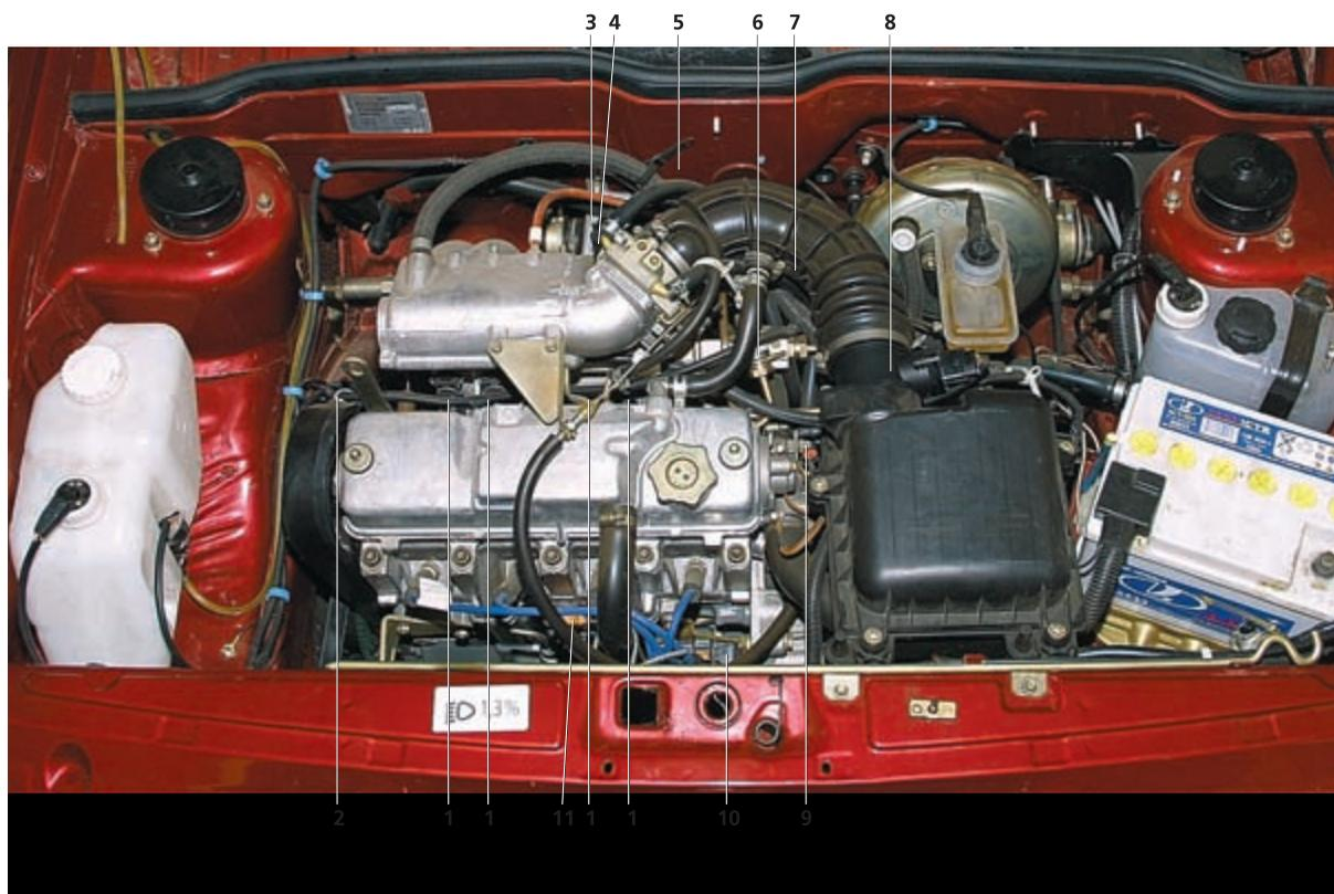
**Расположение элементов системы управления двигателем:** 1 — форсунка (не видна); 2 — датчик положения коленчатого вала (не виден); 3 — регулятор холостого хода (не виден); 4 — датчик положения дроссельной заслонки; 5 — датчик кислорода (не виден); 6 — регулятор давления топлива в топливной рампе; 7 — датчик скорости (не виден); 8 — датчик массового расхода воздуха; 9 — датчик температуры охлаждающей жидкости; 10 — модуль зажигания; 11 — датчик детонации
