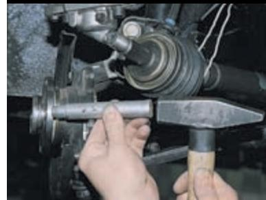
Поворачивая ступицу, через выколотку из мягкого металла выбиваем ее из поворотного кулака.
