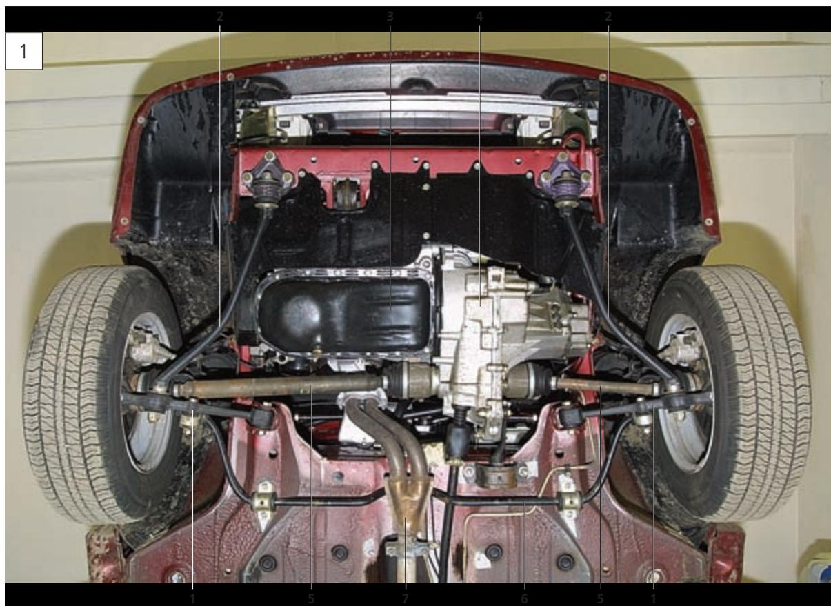
**Вид снизу на переднюю часть автомобиля:** 1 – рычаг передней подвески (ходовая часть); 2 – растяжка рычага (ходовая часть); 3 – двигатель (поддон картера с пробкой отверстия для слива масла); 4 – коробка передач; 5 – вал привода переднего колеса (приводы передних колес относятся к трансмиссии); 6 – стабилизатор поперечной устойчивости (ходовая часть); 7 – система выпуска отработавших газов (система выпуска)
