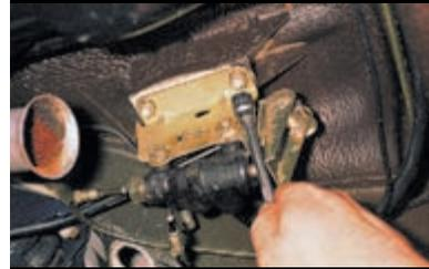
Для снятия регулятора с кронштейном отворачиваем головкой «на 13» две гайки крепления кронштейна к кузову.
