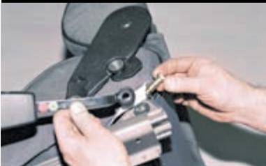
...и снимаем замок ремня безопасности.
