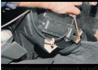
Крестообразной отверткой ослабляем затяжку хомутов крепления подводящего и отводящего шлангов радиатора отопителя...
