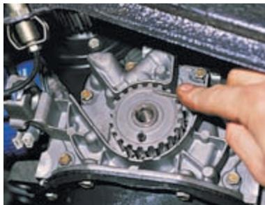
При снятом шкиве привода генератора положение коленчатого вала удобно контролировать по совмещению меток на зубчатом шкиве коленчатого вала и крышке масляного насоса (см. рис.).
