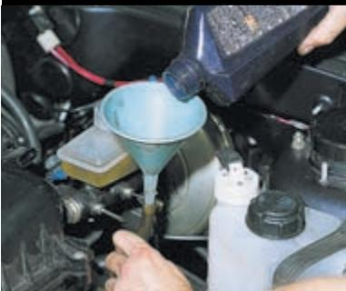
Масло заливаем через отверстие указателя уровня. Для удобства заливки в отверстие вставляем шланг с воронкой.
