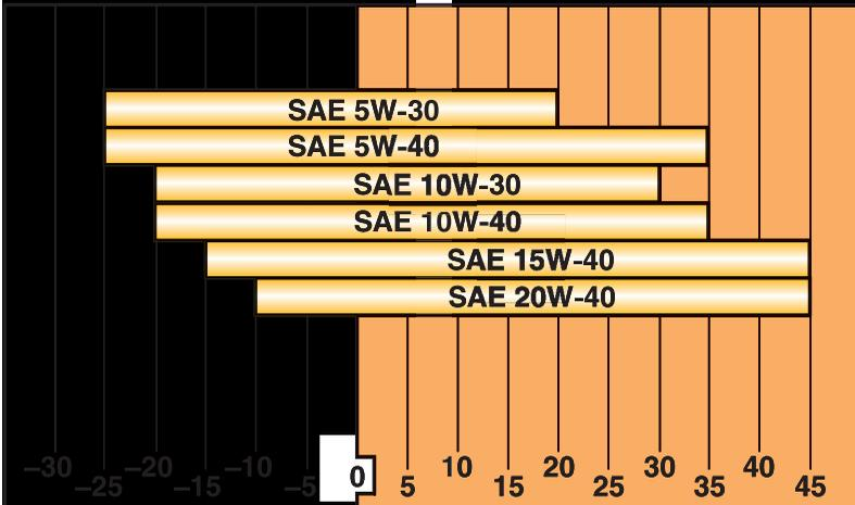
Рис. 1. Применение моторных масел разных классов вязкости по SAE в зависимости от температуры окружающего воздуха
