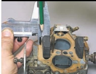
...отмеряем от наружной кромки прокладки со стороны рычага управления воздушной заслонкой 5,7 мм и острозаточенным карандашом делаем метку.
