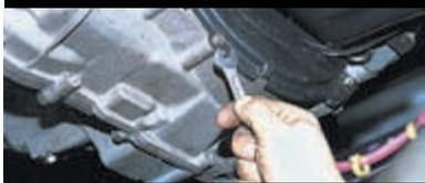
Ключом «на 10» отворачиваем три болта крепления нижней крышки картера сцепления...
