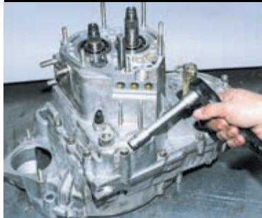
Головкой «на 13» отворачиваем тринадцать гаек и один болт крепления картера коробки передач к картеру сцепления.
