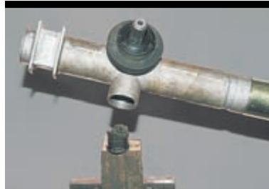
Ударом картера о деревянную подставку выбиваем упор рейки из гнезда. В кольцевой проточке упора установлено резиновое уплотнительное кольцо.
