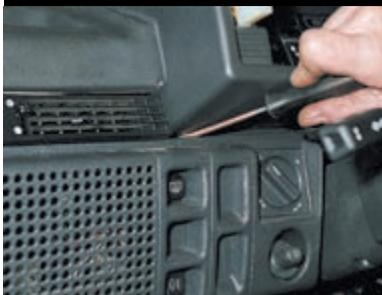
Отверткой освобождаем два пластиковых усика нижнего крепления щитка к панели приборов. Приподняв щиток, отжимаем третью пружинную скобу крепления.
