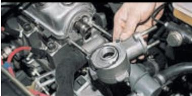
Снимаем корпус со шпилек.
