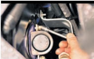
В моторном отсеке головкой «на 13» отворачиваем гайки крепления скоб рулевого механизма к передку кузова с правой...
