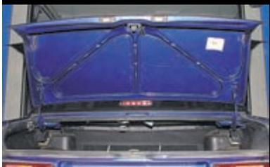
Крышка багажника автомобиля после отпираания замка удерживается в открытом положении тросионами (у ВА3-21099) или газонаполненными упорами двери задка (у ВА3-2108 и -2109).
