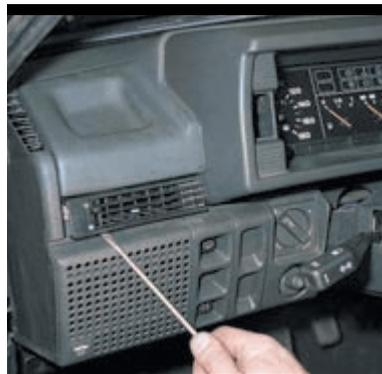
При демонтаже накладки в сборе с щитком с двух сторон панели снимаем боковые сопла системы вентиляции.
