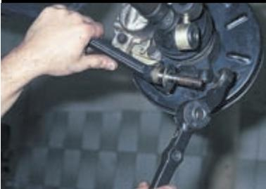
Снимаем с растяжки рычаг.
