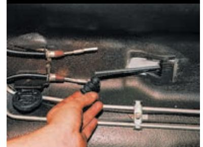
На регулировочную тягу не забудьте надеть пыльник.
