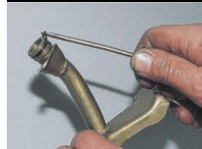
Поддев отверткой, снимаем уплотнительное кольцо трубки.
