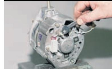
Ключом «на 10» отворачиваем гайку крепления клеммы конденсатора.
