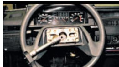
Головкой «на 24» отворачиваем гайку крепления рулевого колеса, но не до конца.
