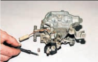
Снимаем винт и пружину.
