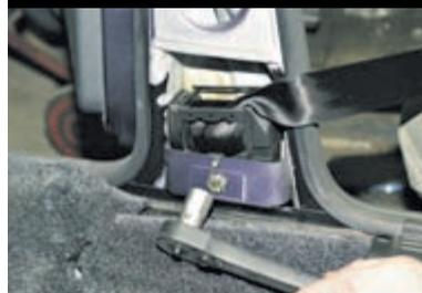
Головкой «на 17» отворачиваем болт крепления катушки ремня безопасности.
