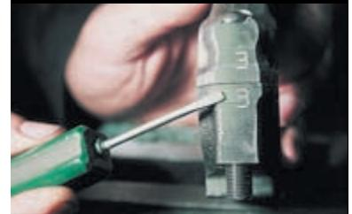
При установке крышки шатуна номера на шатуне и крышке должны располагаться с одной стороны.
