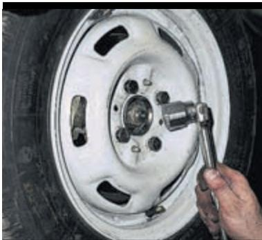
Головкой «на 30» ослабляем гайку подшипника ступицы.
