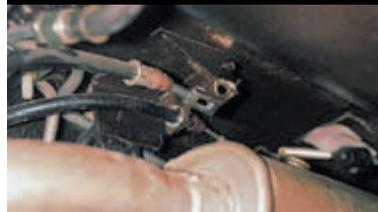
Вынимаем наконечник оболочки троса из кронштейна.
