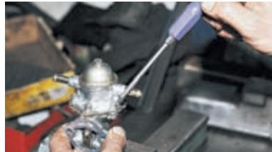
Крестообразной отверткой отворачиваем шесть винтов, соединяющих верхний и нижний корпуса насоса.
