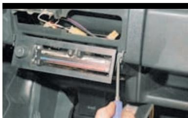
Крестообразной отверткой отворачиваем два самореза крепления к панели приборов кронштейна рычагов управления отопителем...
