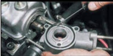
Стык корпуса и головки блока уплотняется резиновым кольцом, которое при сборке заменяем новым.
