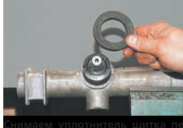
Снимаем уплотнитель щитка передка.
