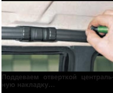
Поддеваем отверткой центральную накладку...
