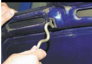
...и устанавливаем его в специальное гнездо в усилителе капота.
