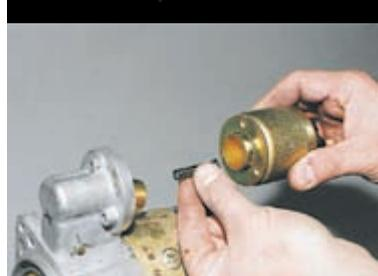
Снимаем тяговое реле и пружину.
