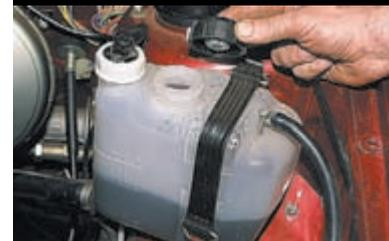
Отворачиваем пробку расширительного бачка.
