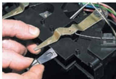
В пластмассе рукоятки выполнено отверстие, в которое входит усик рычага.
