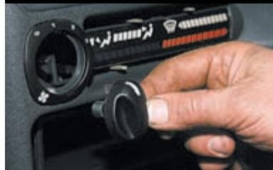
Снимаем рукоятку с переключателя вентилятора отопителя. Крестообразной отверткой отворачиваем:
