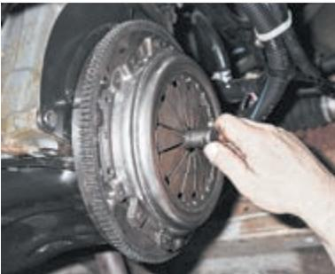
Вводим оправку в отверстие коленчатого вала и в этом положении закрепляем кожух сцепления, равномерно (по одному обороту за проход) затягивая болты. Дальнейшую сборку проводим в обратной последовательности.
