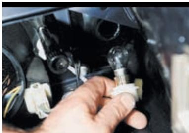
...и, повернув против часовой стрелки, вынимаем патрон из указателя поворота.
