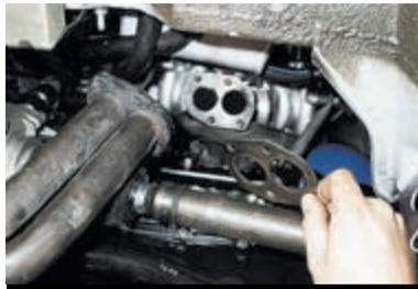
Снимаем приемную трубу и ее прокладку. При сборке заменяем прокладку и, желательно, гайки (на специальные — латунные или омедненные).
