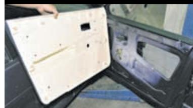
Поддеваем отверткой и снимаем обивку двери, она крепится восемью пистонами.
