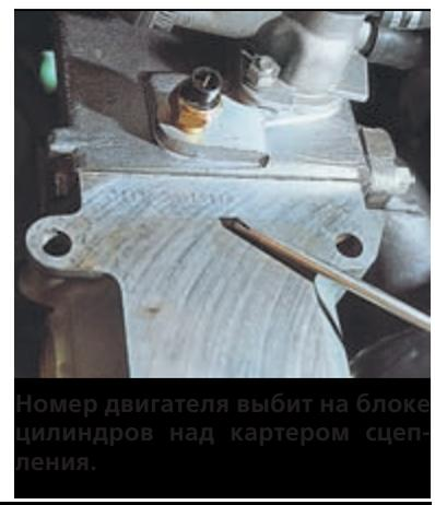
Номер двигателя выбит на блоке цилиндров над картером сцепления.
