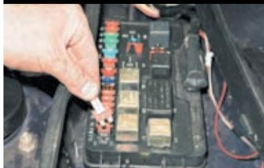
...и снимаем ими предохранитель.
