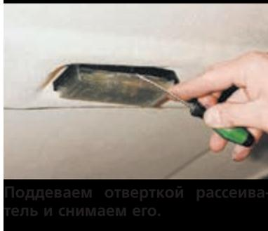
Поддеваем отверткой рассеиватель и снимаем его.
