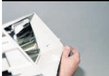
Зачищаем поверхность от старого герметика.
