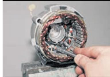
Головкой «на 8» отворачиваем три гайки крепления клемм статора к выпрямительному блоку.
