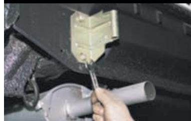
Ключом «на 13» отворачиваем две гайки крепления к кузову заднего кронштейна...
