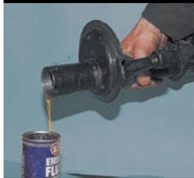
Сливаем амортизаторную жидкость.
