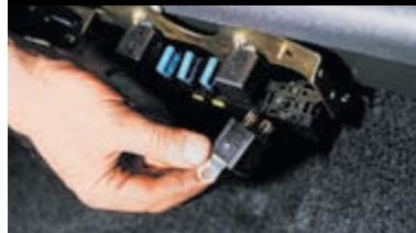
...и снимаем реле.
