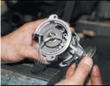
Снимаем вакуумный регулятор.
