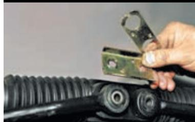
Снимаем стопорную и соединительную пластины.
