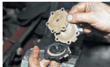
Вынимаем две рабочие диафрагмы.
