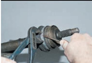
Раздвижными пассатижами сжимаем за выступы большой хомут, поддевая отверткой, разъединяем его.
