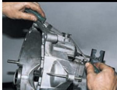
Двумя отвертками поддеваем втулку вала вилки выключения сцепления...
