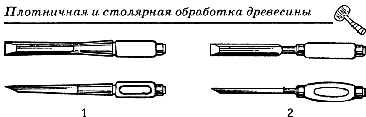
Рис. 22. Долота: 1 — плотничные, 2 — столярные
