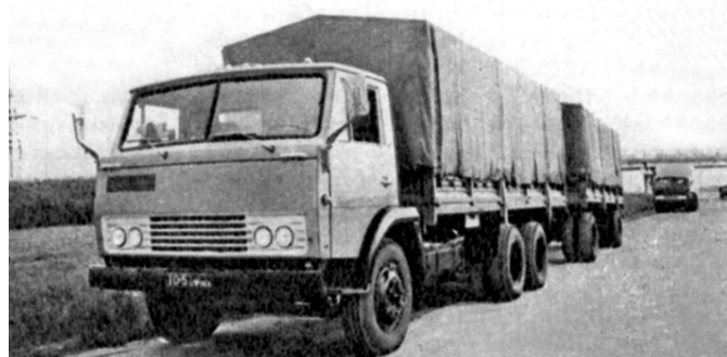
Фото 28. Опытный образец длиннобазного автомобиля КамАЗ-5320
