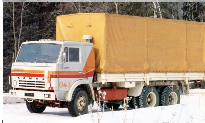
Фото 28. Опытный образец длиннобазного автомобиля КамАЗ-5320
