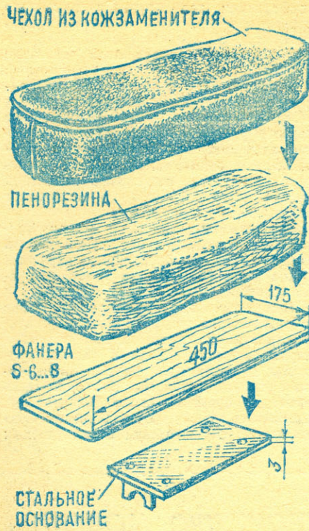
Рис. 3. Технология изготовления седла «диванного» типа.
