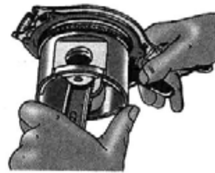
Рис. 4.1.50. Снятие поршневых колец с поршня съемником 6999-7675
