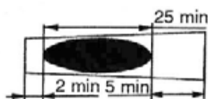
Рис. 5.36. Правильное расположение пятна контакта на ведомой шестерне
