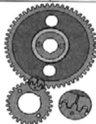
Рис. 4.1.7. Установочные метки на распределительных шестернях
