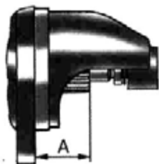
Рис. 8.1.23. Замер положения шестерни привода в выключенном состоянии
