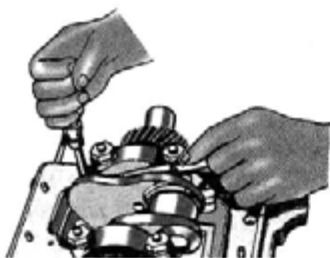
Рис. 4.2.15. Проверка осевого зазора коленчатого вала
