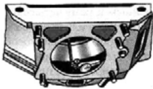
Рис. 4.1.53. Проверка концентричности отверстия картера сцепления с осью коленчатого вала приспособлением 24-У-114625
