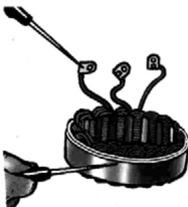
Рис. 8.1.6. Проверка на отсутствие замыкания катушек статора на корпус
