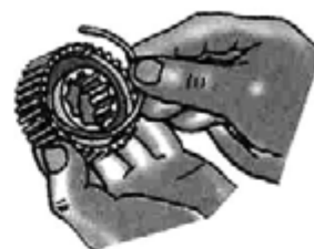
Рис. 5.18. Установка пружин синхронизатора
