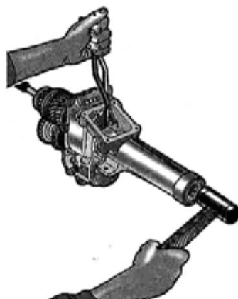
Рис. 5.17. Демонтаж комплекта валов и шестерен из заднего картера
