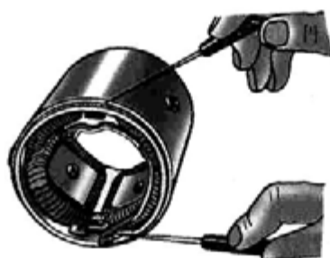
Рис. 8.1.19. Проверка катушек возбуждения стартера на короткое замыкание с корпусом
