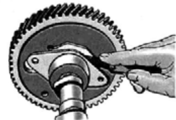
Рис. 4.1.64. Проверка осевого зазора распределительного вала
