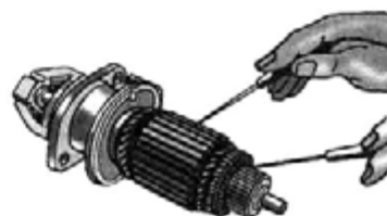
Рис. 8.1.22. Проверка обмотки якоря стартера на короткое замыкание с магнитопроводом
