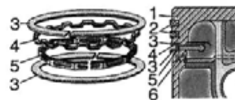
Рис. 4.2.11. Установка колец на поршне:
