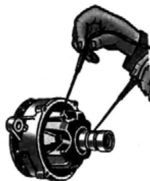
Рис. 8.1.9. Проверка ротора на отсутствие замыкания обмотки на корпус
