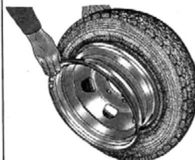
Рис. 6.18. Первоначальная установка обода колеса в шину
