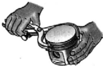
Рис. 4.1.57. Очистка нагара в канавках поршней с помощью приспособления 5-У-27691
