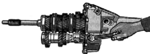
Рис. 5.16. Отворачивание болта крепления оси промежуточной шестерни заднего хода на заднем картере
