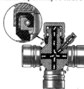
Рис. 5.26. Схема смазки подшипников карданного шарнира
